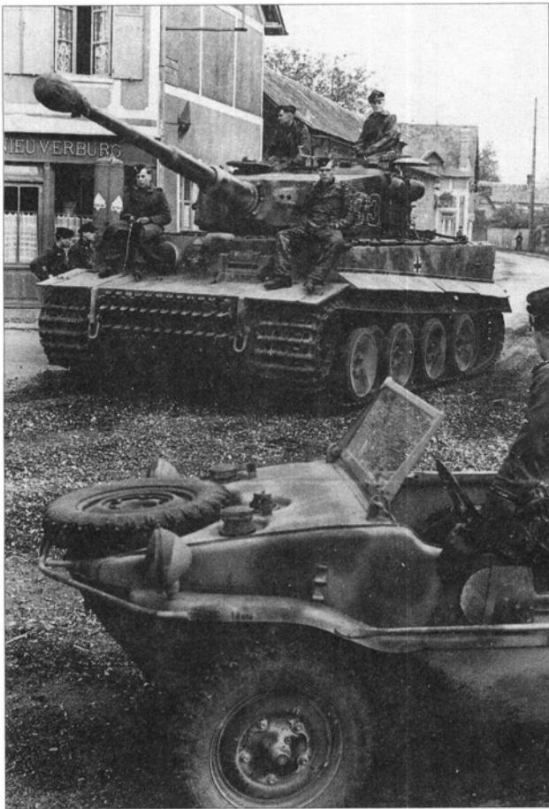
«Тигр» примерно среднего периода производства (бинокулярный орудийный прицел и обрезиненные опорные катки, но более поздняя командирская башенка) из состава 101-го тяжелого танкового батальона. Здесь он запечатлен в момент переброски в Нормандию примерно 10 июня 1944 г. Многие из танков батальона сломались по дороге и прибыли в район назначения позднее, чем ожидалось.
