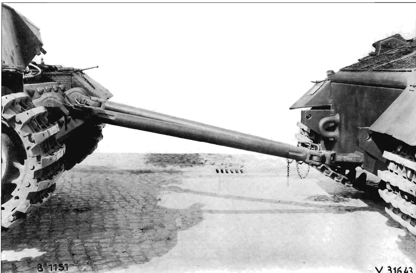
После участия в сравнительных испытаний в Берка, этот «Тигр» Порше (№ 150013) был доставлен на полигон в Куммердорфе, где его доработали для «буксирных» испытаний истребителя танков «Элефант». Ширина передних подкрылков «Тигра» 750 мм, задних - 700 мм, подкрылки выступают от бортов на 200 мм. Гусеницы шириной 640 мм. Ведущие колеса ленивцы с четырьмя спицами.
