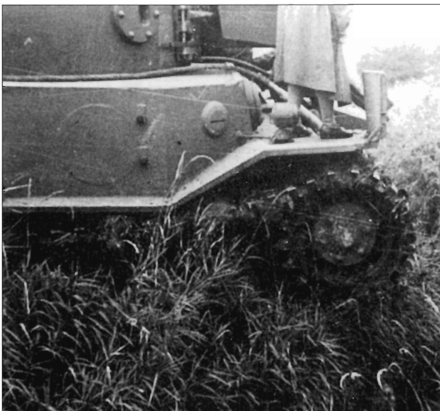
Один из Truppenübungsfahrzeuge (учебно-тренировочные машины) с башней № 7. Танк принадлежит 503-му танковому батальону, Дюллерсхейм. Шасси из второй партии (пять экземпляров) с подкрылками шириной 700 мм (выступают от бортов корпуса на 200 мм) и гусеницами шириной 600 мм. Серия снимков демонстрирует плохую проходимость танка на заболоченной местности.
