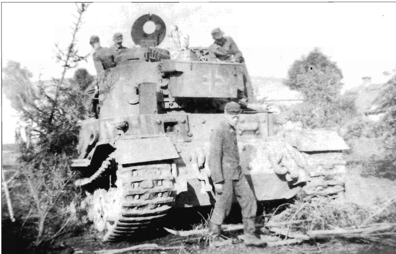
Panzerbefehlswagen VI (P) (Fgst.Nr. 150013) с накладной броней в лобовой части и циммеритом; машина доработана под установку двигателей Майбах HL-120TRM и гусениц шириной 640-мм. Снимок сделан на Восточном фронте в 653-м батальоне тяжелых истребителей танков в апреле 1944 г. Устройством Rauchsignalkorb за командирской башенкой была оборудована только башня № 14.
