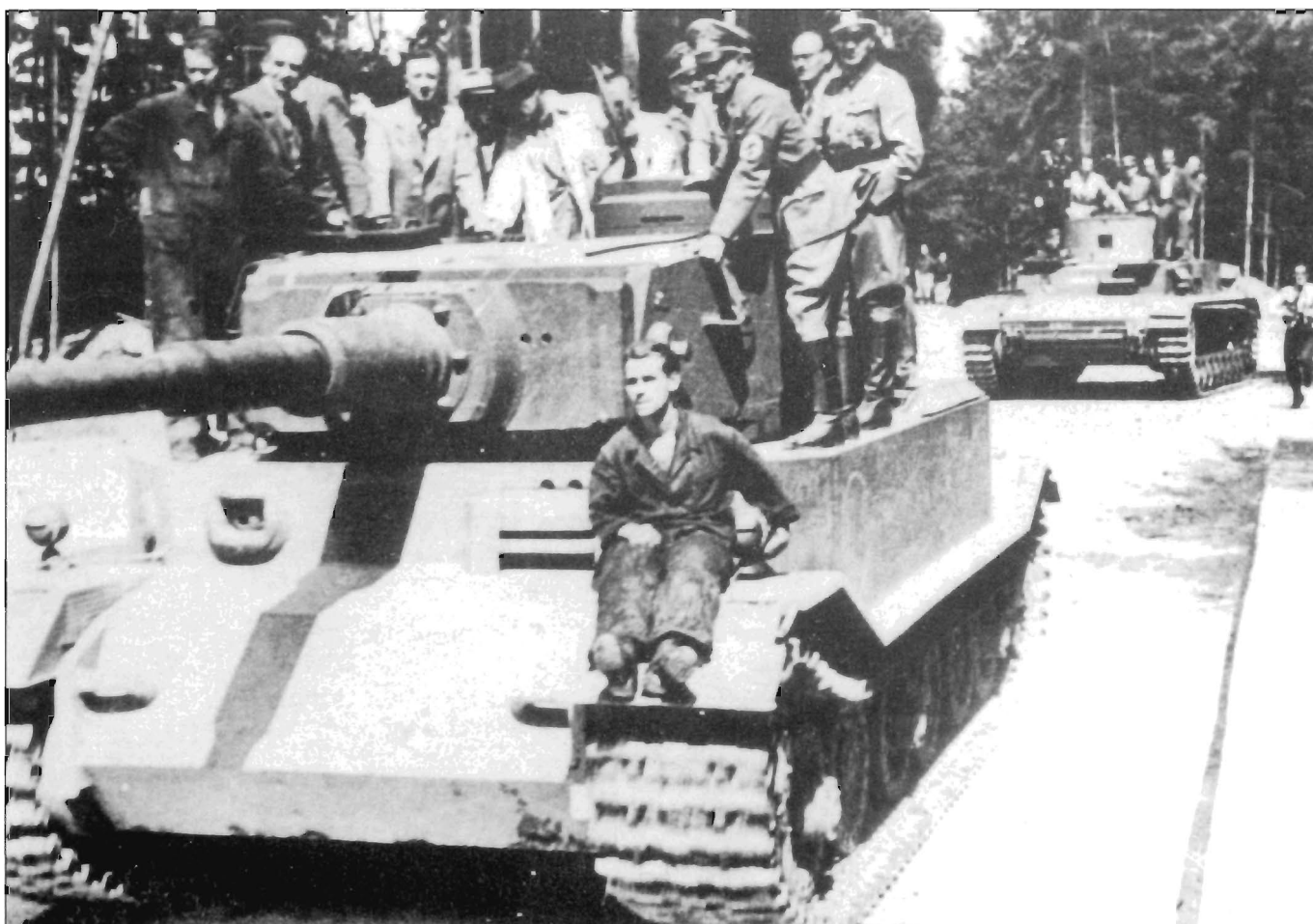
Редчайший снимок «Тигра» Порше с башней № 11 или № 12 (башни с высокой крышей). На крыше башни установлен вентилятор, в левом нижнем углу маски пушки сделан вырез. Ширина подкрылков шасси 700 мм, ширина гусениц 600 мм.
