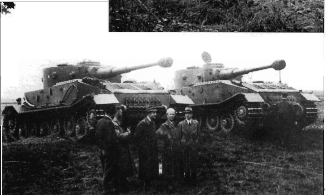
Еще два Truppenübungsfahrzeuge - с башнями № 5 и № 6, 503-й танковый батальон, Дюллерсхейм. Два «Тигра»! пытаются вытащить один «Тигр», который завяз в грязи. Инструмент на этих трех танках размещен по-разному, но все шасси - одной серии с подкрылками шириной 700 мм и гусеницами шириной 600 мм.
