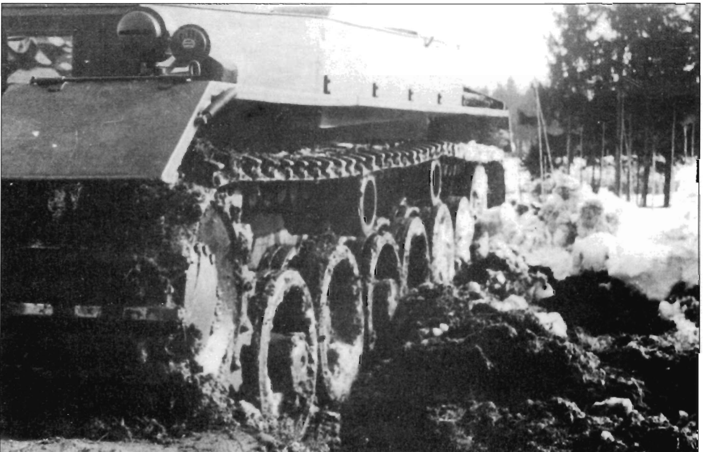
Детализовка элементов ходовой части единственного шасси Порше тип 100. Опорные катки снабжены резиновыми бандажами, диаметр опорных катков 700 мм. Ширина трактов 500 мм, шаг трактов в гусенице 160 мм.
