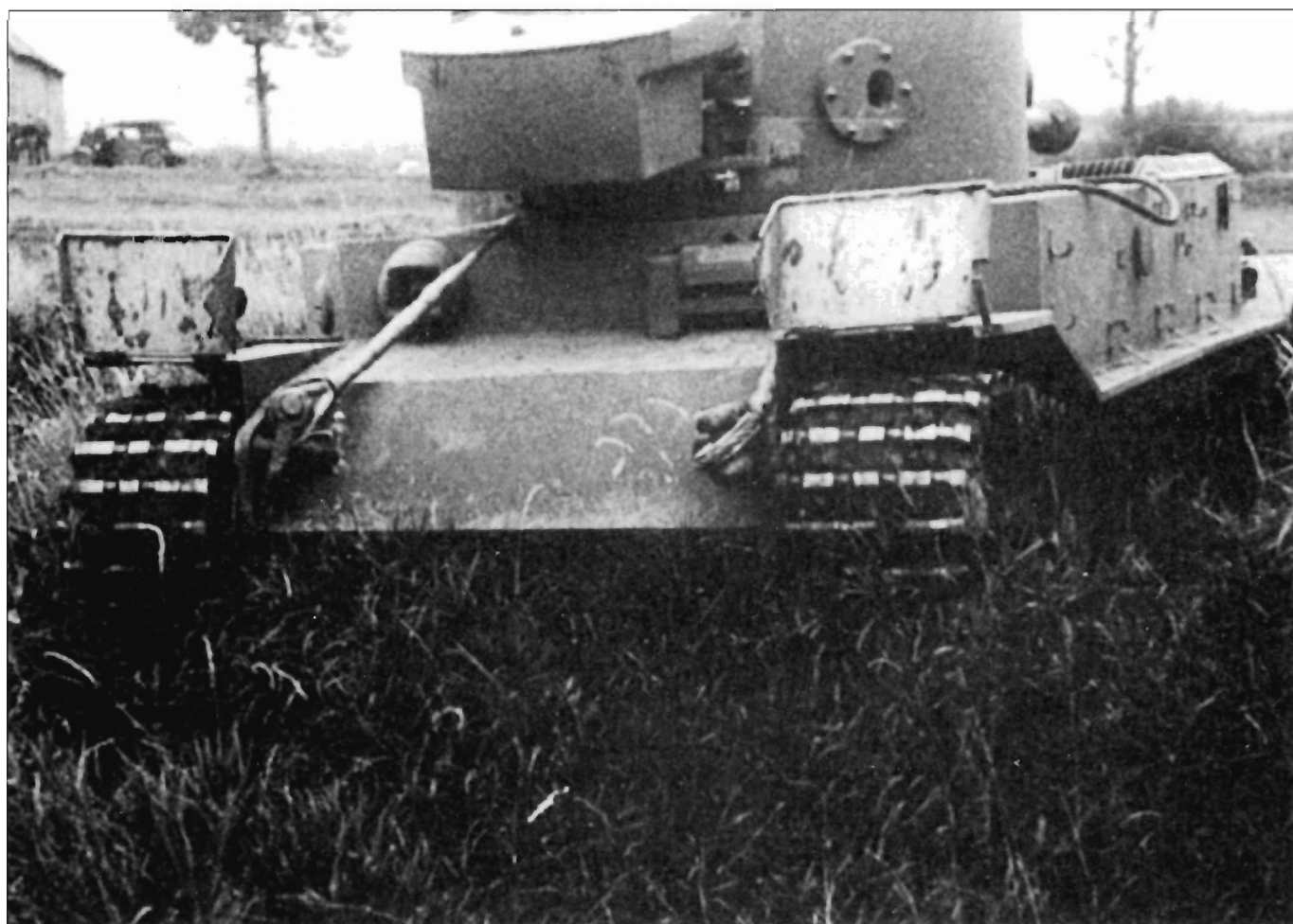
Один из Truppenübungsfahrzeuge (учебно-тренировочные машины) с башней № 7. Танк принадлежит 503-му танковому батальону, Дюллерсхейм. Шасси из второй партии (пять экземпляров) с подкрылками шириной 700 мм (выступают от бортов корпуса на 200 мм) и гусеницами шириной 600 мм. Серия снимков демонстрирует плохую проходимость танка на заболоченной местности.
