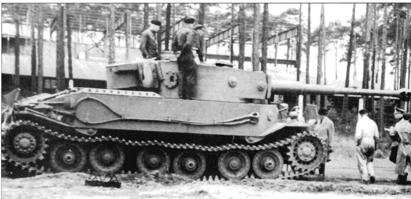
Второй «Тигр» Порше был снабжен башней № 3. Машину осмотрели 3 - 4 июня 1942 г. перед отправкой на полигон Куммерсдорф. Машина получила полный комплект инструмента и оборудования согласно перечню от февраля 1942 г. Шасси одно из пяти первых построенных, с подкрылками шириной 600 мм и гусеницами с траками Kgs. 62/600/130. Крышка люка командира откинута назад в крайнее положение на угол 110 град.
