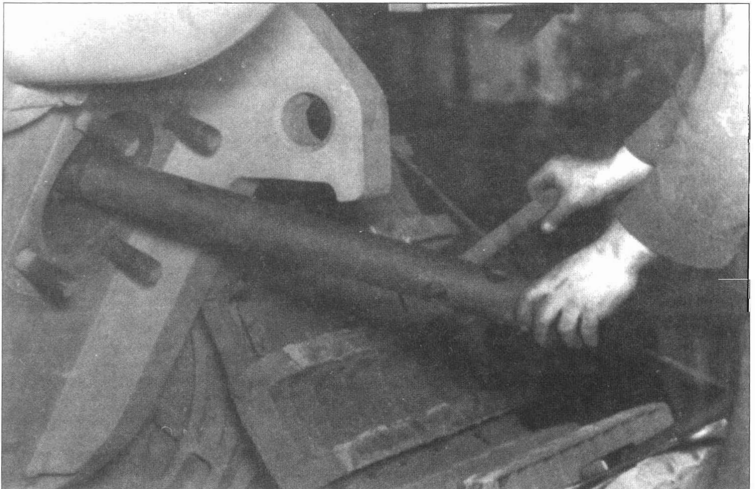
Регуляция положения опорных катков проходила через люки в кормовой бронеплите с помощью специального ключа.
