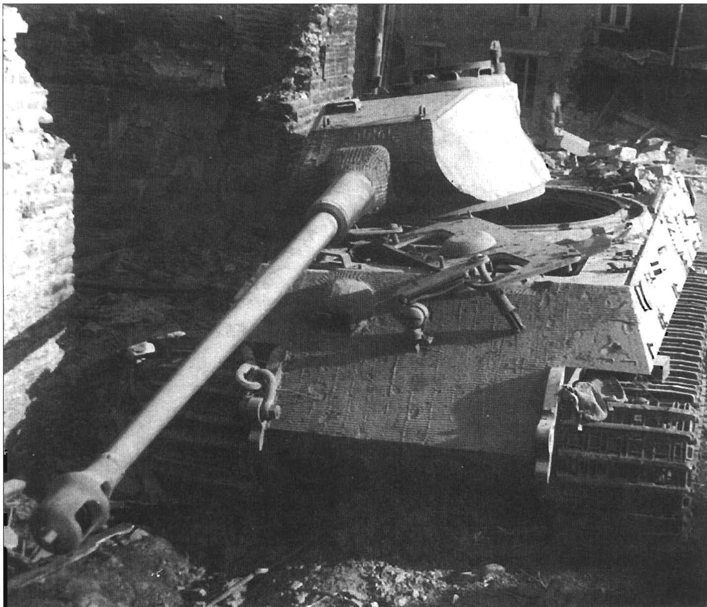
31-й «Королевский Тигр» подорван и брошен экипажем. Машина выпущена фирмой Хеншель в мае 1944 г. Пушка выполнена моноблоком, основание башни защищено бронировкой.
