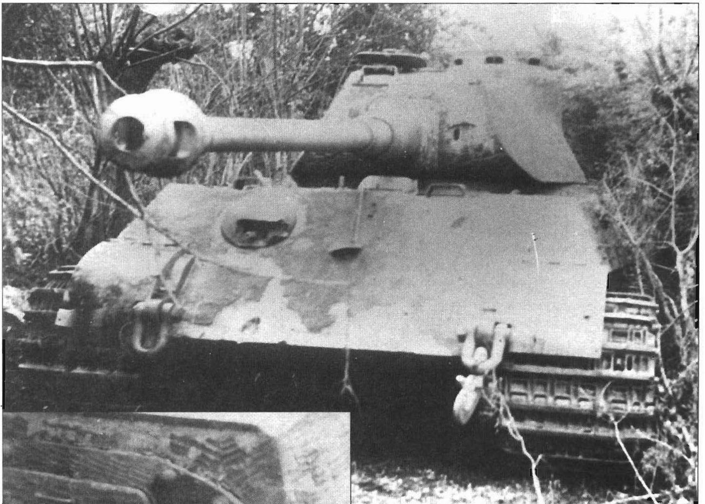
На фото представлены «Королевские Тигры» с башней Порше. Машины выпуска апрель-май 1944 г. из 1-й роты 503-го тяжелого танкового батальона. Обратите внимание на составной ствол орудия, монокулярный прицел наводчика и боевые гусеницы Gg 26/800/300. Торсион кормового башенного люка защищен полукруглыми броневыми накладками, которые тоже покрыты циммеритом.
