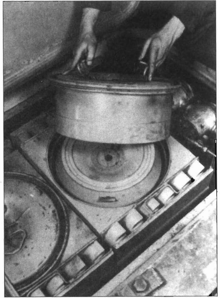
Воздушный фильтр Kombinations-Verbrennungs-Luftfilter с 12 рабочими элементами Zyklon.
