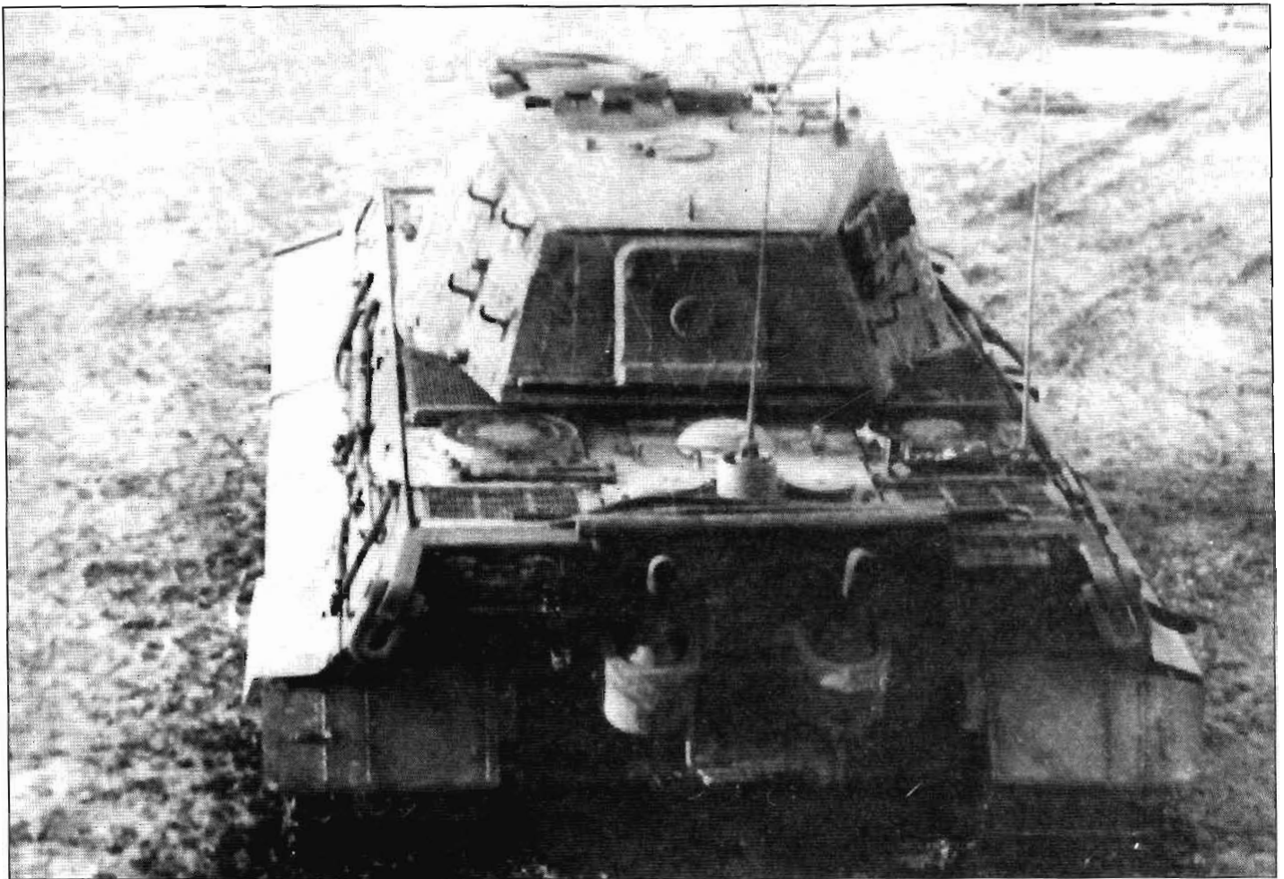
PzBefWg Tiger Ausf. B («502») из штаба sPzAbt 501. На верхней кромке кормовой бронеплиты виден цилиндрический контейнер для удлинителей антенны.
