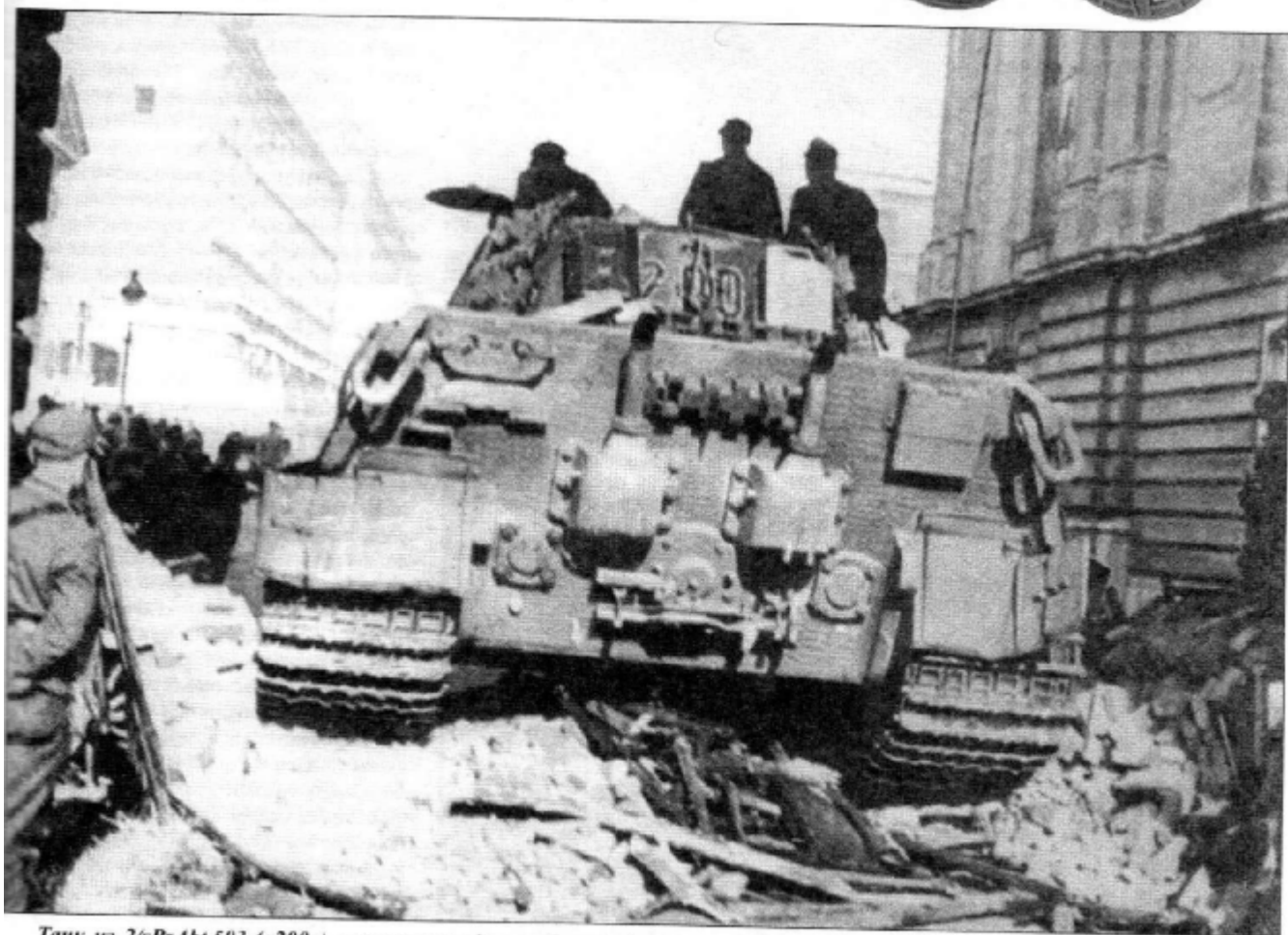
Танк из 2/сРzАbt 503 («200»), разрушает одну из баррикад в центре Будапешта. Держатели для канистр на задней стенке башни установлены в полевой мастерской батальона.
