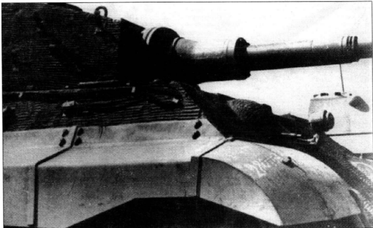
«Тигр» Ausf. В с серийной башней (Fgst 280100, номер указан на крыле). Танк демонстрировался Адольфу Гитлеру. На заднем плане «Пантера» Ausf. F с башней Schmalturm.
