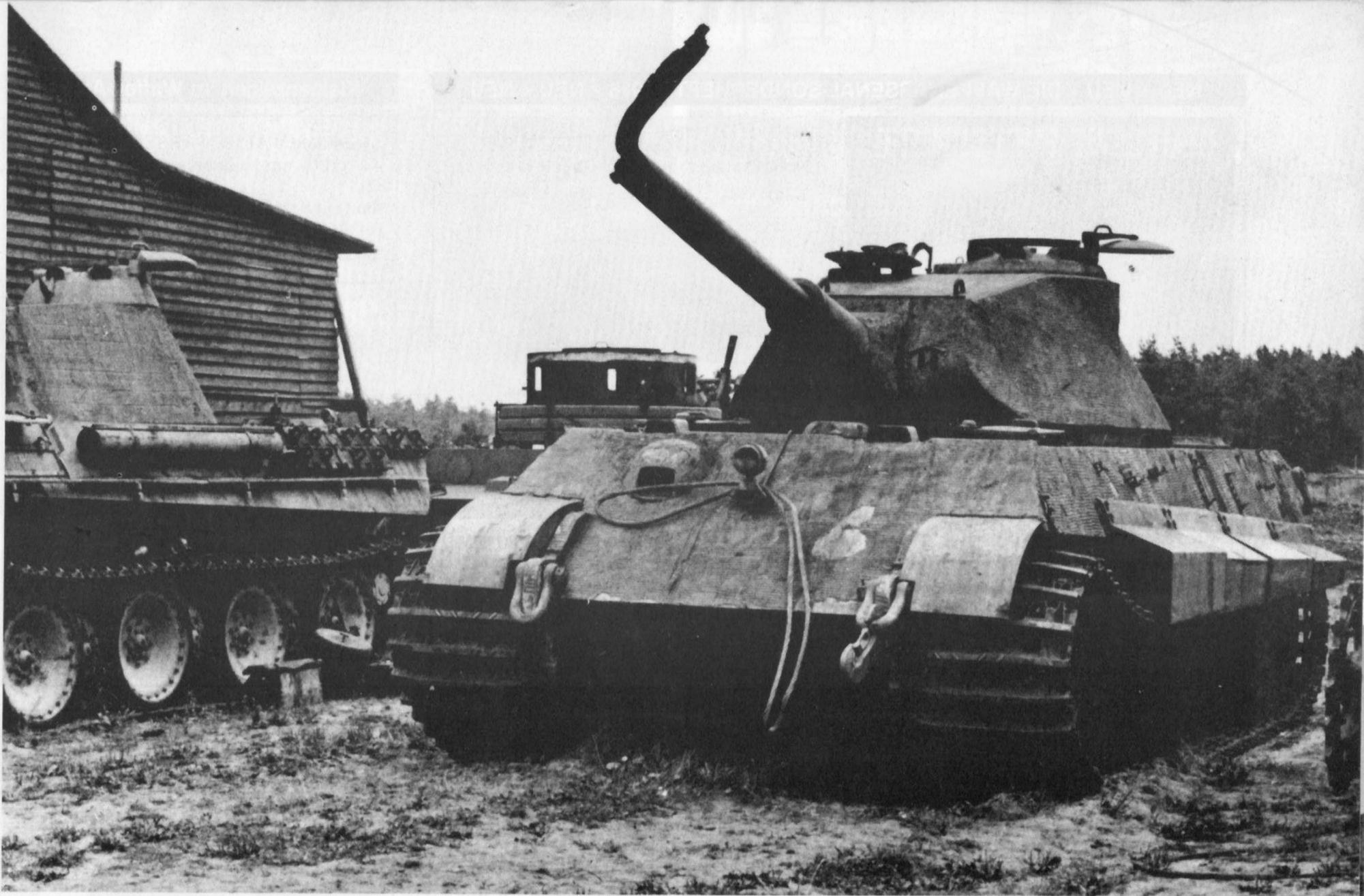
Das Ende: Ein durch eine Rohrsprengung unbrauchbar gemachter, auf dem Gelände der Panzerabteilung 500 in Paderborn zurückgelassener Tiger (mit Porscheturm) wartet auf seine Verschrottung. Rechts vom Panzer steht ein Pzkw V Panther, schräg dahinter ist das Turmgewicht zu sehen, das auf dem VK 4501 (H) aufgesetzt war.
