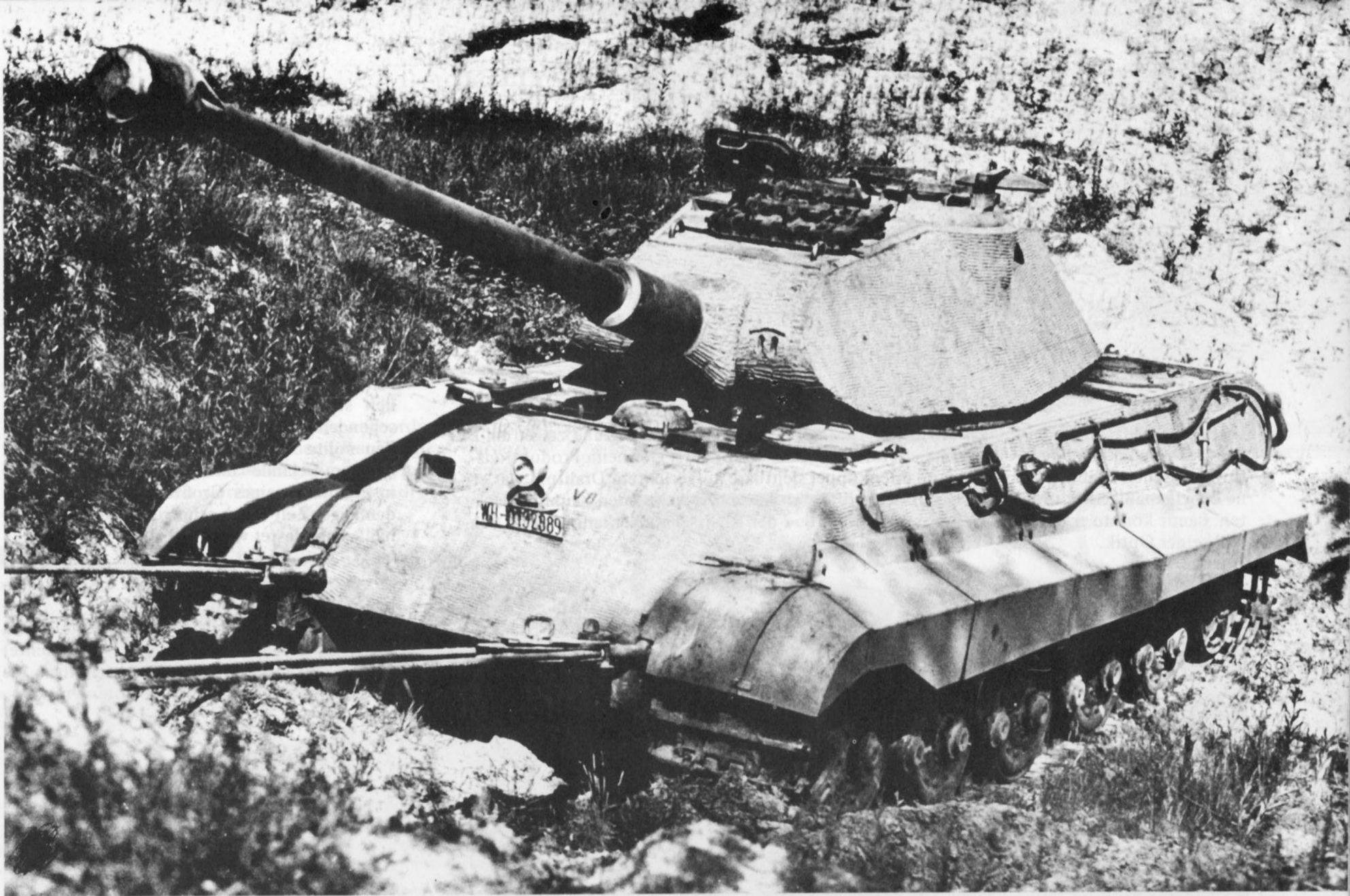
Eine Reihe von Panzern diente der Erprobung. Das Foto zeigt den V 8 in Kummersdorf bei einem Bergemanöver. Beachte das – im Gefecht nicht gebräuchliche – Nummernschild auf der Bugplatte.
