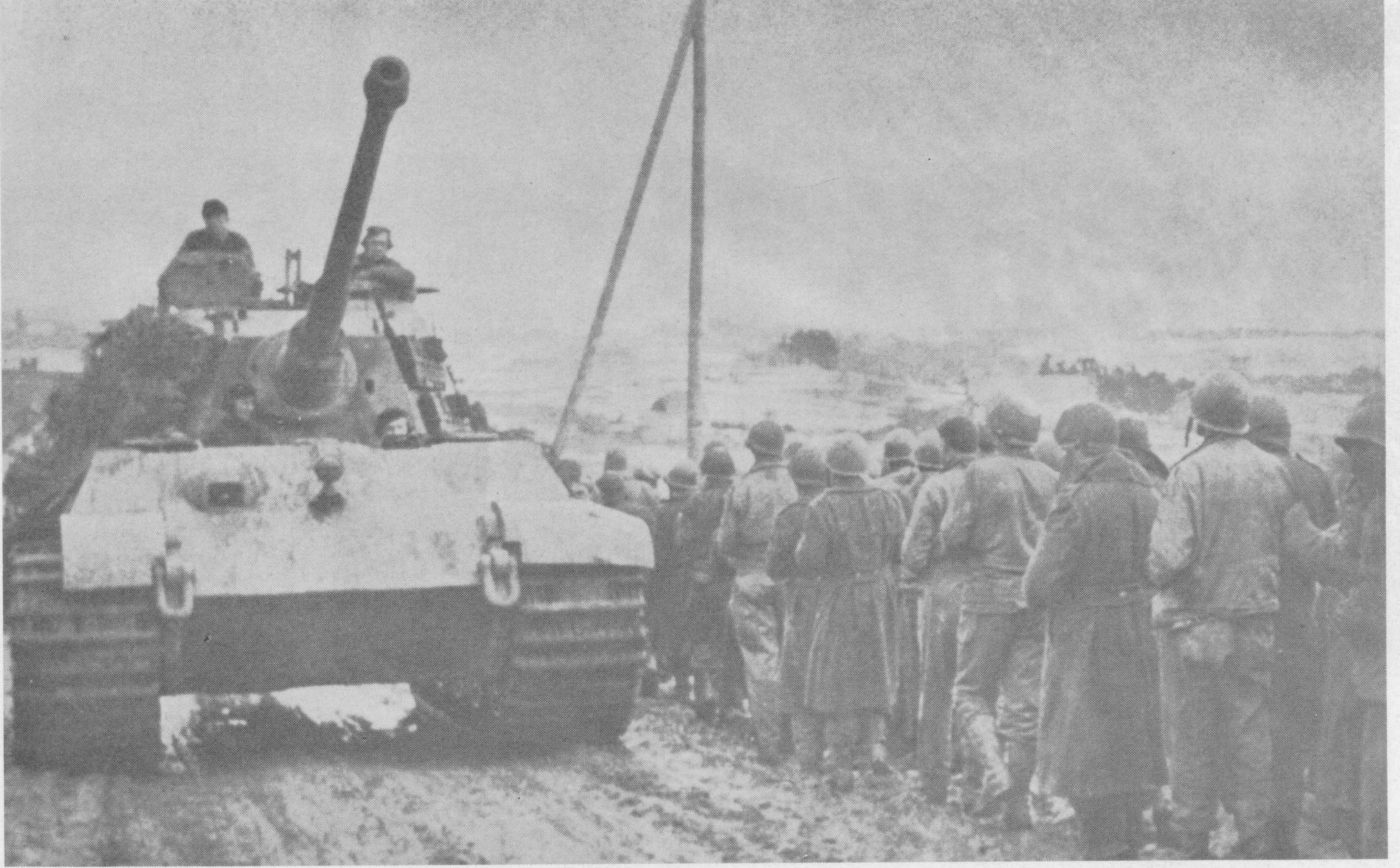
Unten: Auch der "Königtiger" nutzte Reservekettenglieder als zusätzlichen Schutz. Unter der Kanone schaut der Bug-MG-Schütze (gleichzeitig Funker) aus seiner Einstiegluke. Hierzu konnte er seinen Sitz höherstellen: übrigens ein Zeichen, daß sich dieser Tiger II zur Zeit nicht im Gefecht befindet.
