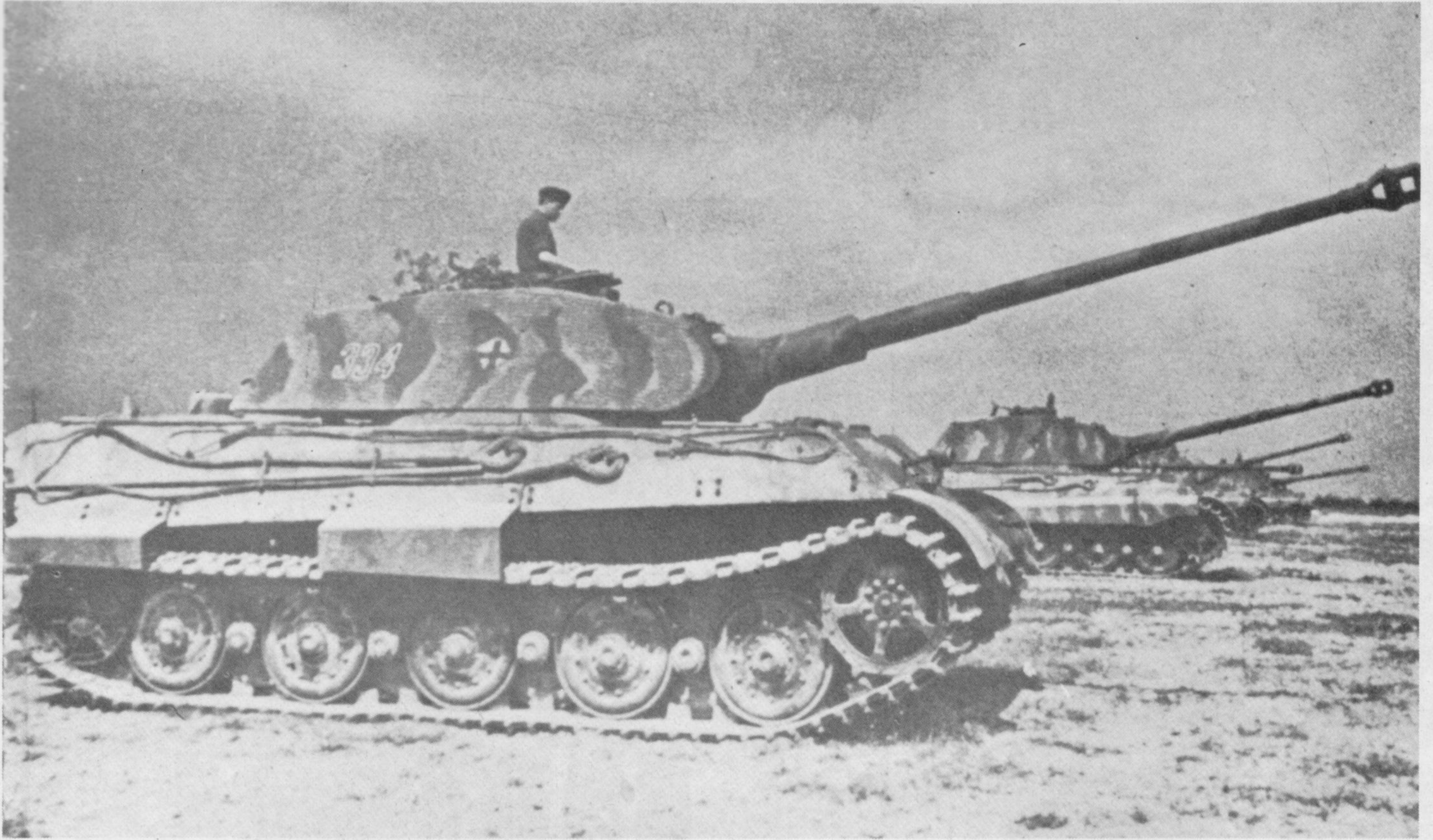
Oben: Fünf Tiger II (Ausführung B) mit Porscheturm bei Schießübungen. Der vordere Panzer hat Teile seiner Kettenabdeckung verloren. Er zeigt ein zweiteiliges Rohr.
