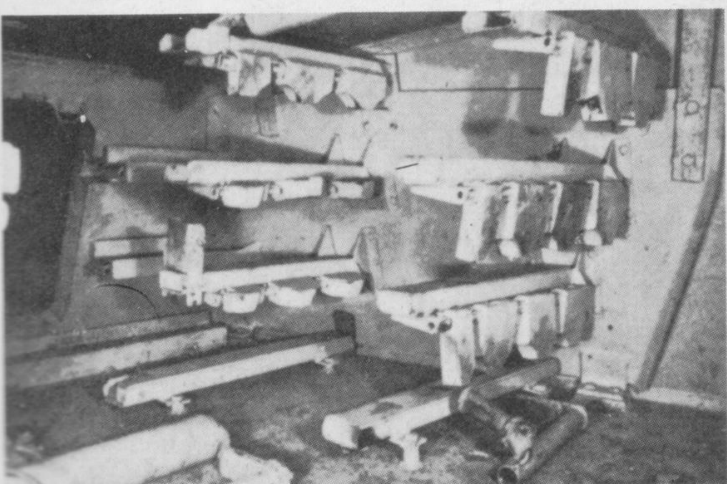
Unten: Das Foto zeigt die Halterungen der Patronengranaten im linken hinteren Turmteil.
