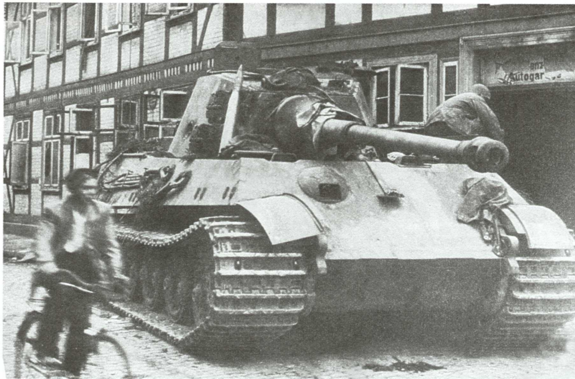
«Тигр-II», захваченный американскими войсками в Остенроде. Обращает на себя внимание сквозная пробоина в борту башни, сделанная уже после захвата танка
