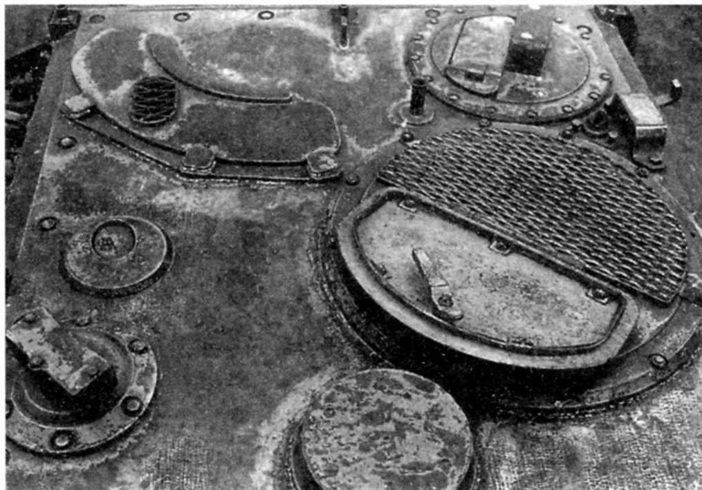
Крыша рубки «Ягдтигра». Вверху справа — командирская башенка с лючком для стереотрубы, перед ней — посадочный люк командира, вверху слева — дугобразная амбразура перископического прицела
