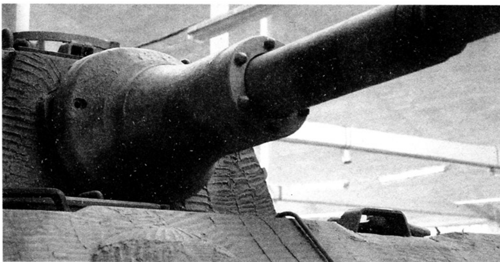
Маска пушки танка с башней «типа Хеншель». Во фланце маски — амбразура спаренного пулемета
