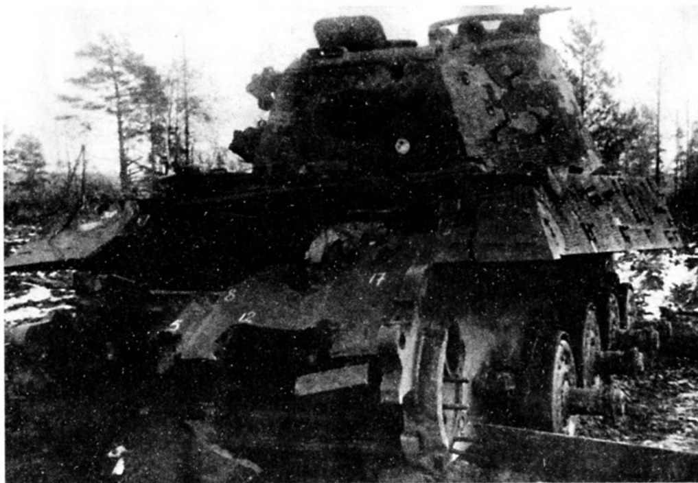
«Королевский тигр» № 102 после испытаний обстрелом
