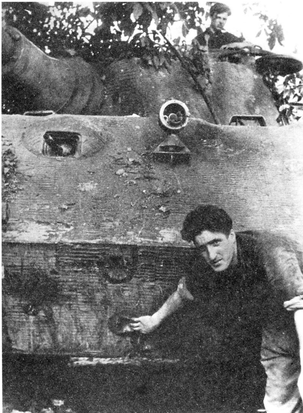
Немецкий танкист демонстрирует вмятины на нижнем лобовом листе корпуса «Королевского тигра». 75-мм английские и американские снаряды не причиняли этому танку никакого вреда
