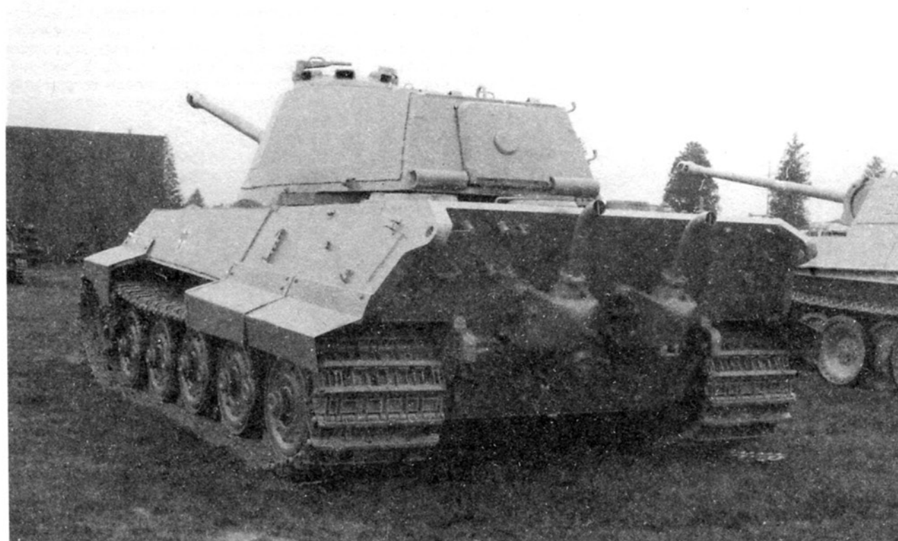
«Королевский тигр» в экспозиции военного музея на Абердинском полигоне. На фотографиях видно, что вместо срезанных листов брони приварены листы простой листовой стали. Снимки сделан в конце 1980-х годов
