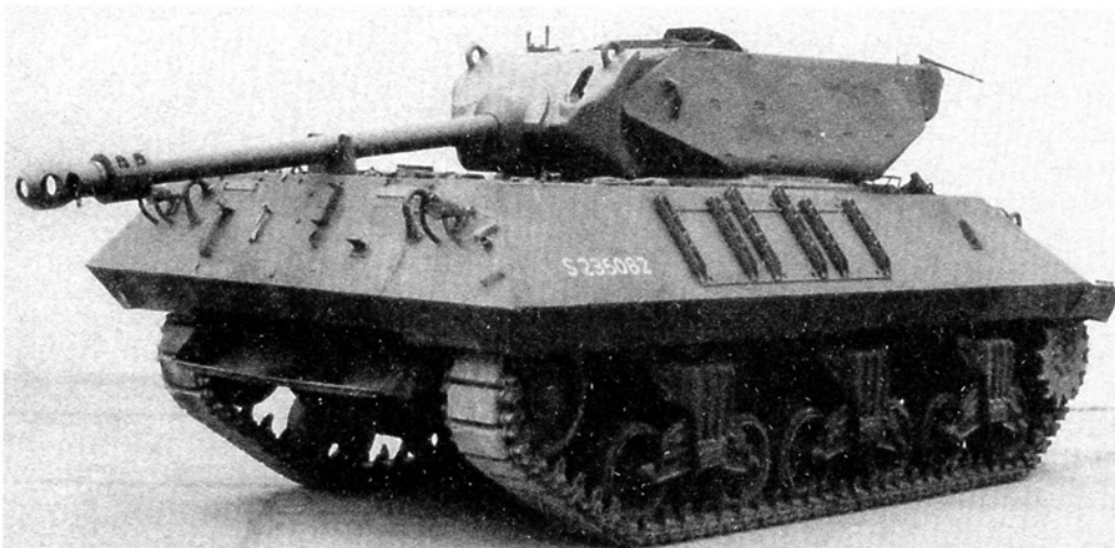
Английские САУ — истребители танков, вооруженные 17-фунтовыми пушками: «Ахиллес» (на фото слева) и «Арчер» (внизу)
