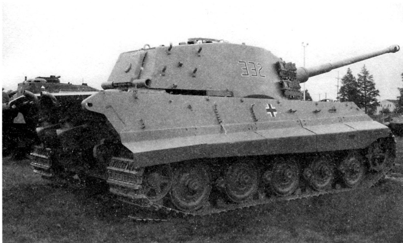
«Королевский тигр» в экспозиции военного музея на Абердинском полигоне. На фотографиях видно, что вместо срезанных листов брони приварены листы простой листовой стали. Снимки сделан в конце 1980-х годов
