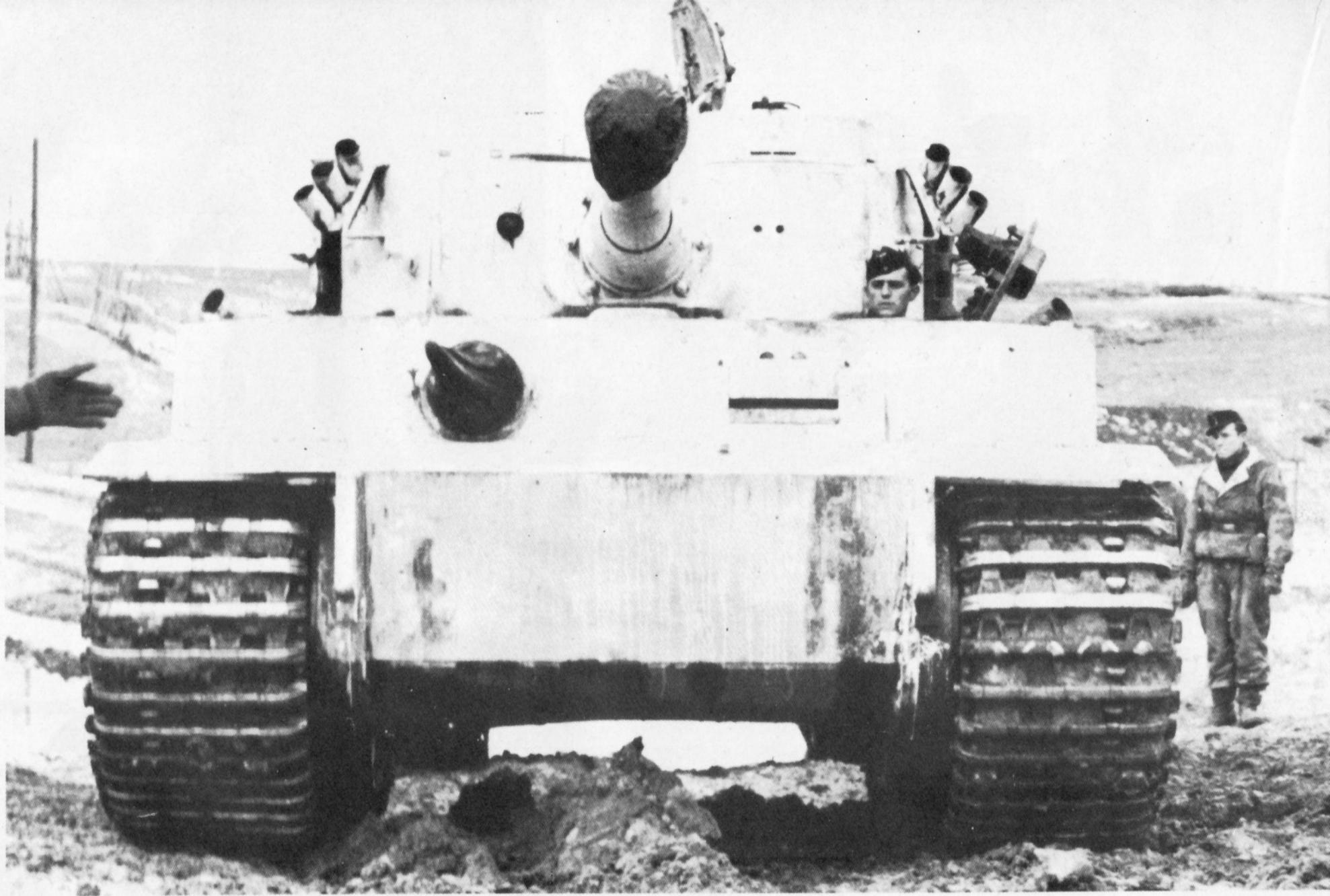
Ein gut getarnter Tiger. Seine Kettenbreite betrug 72,5 cm. Nach den Wurfbechern auf dem Wannendeck, den fehlenden Verdickungen an der Optik und der Kommandantenkuppel zu urteilen, ist es ein Tiger früherer Bauart. (BA)
