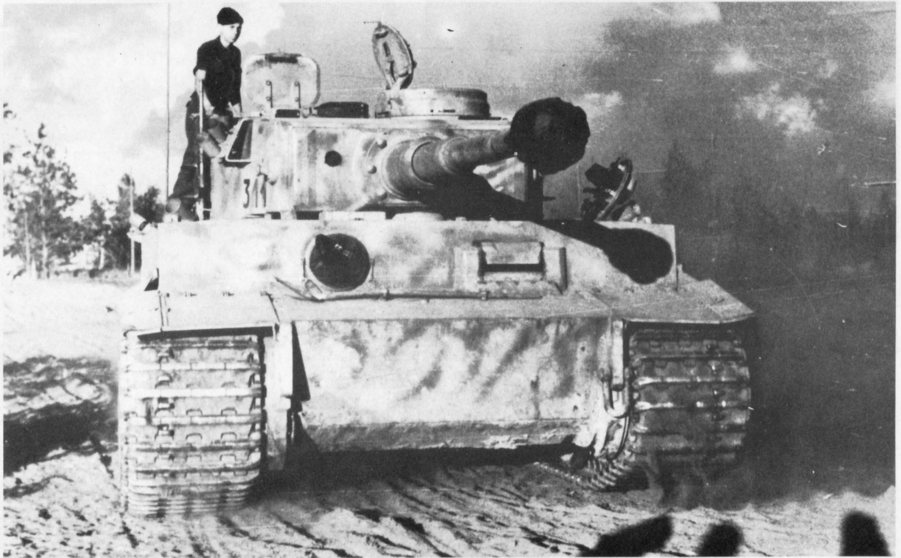
Ein älterer Typ – erkennbar an dem hochgestellten Turmdeckel der zylindrischen Kommandantenkuppel. Er zeigt Wurfbecher an den Ecken des Wannenaufbaues – sie entfielen später. Alle Waffen sind noch unter Staubschutz. (BA)
