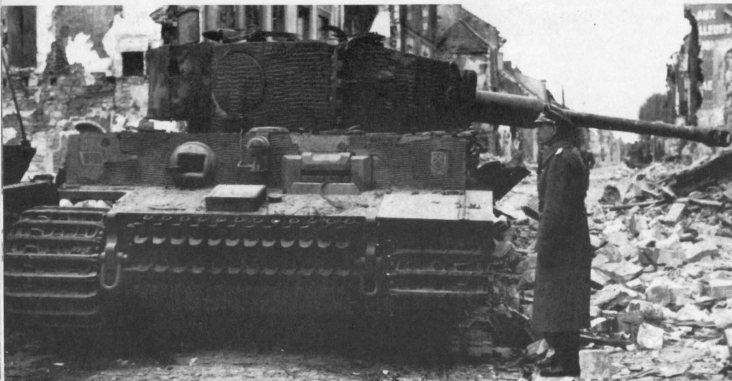
Zerstört durch Fliegerbomben an der Invasionsfront. Die seitliche Ausstiegsluke (die allerersten Tiger hatten noch keine) an dem hinteren Teil der rechten Turmseite ist trotz Zimmitbewurf gut zu erkennen. Sie diente auch zum Aufmunitionieren;
