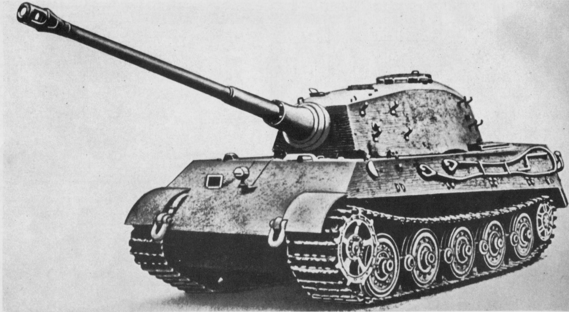
Die etwas kräftigere Form mit einer kreisrunden Rohrblende kennzeichnet den Produktionsturm von Krupp.
