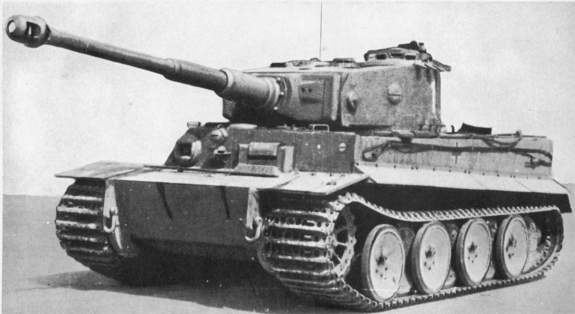
Er zeigt die spätere Kuppel und den späteren Verstärkerwulst um die beiden Optiköffnungen der Kanonenblende. Auf dem ähnlichen Bild der Seite 7 ist es umgekehrt (frühere Kuppel und frühere Blende).
