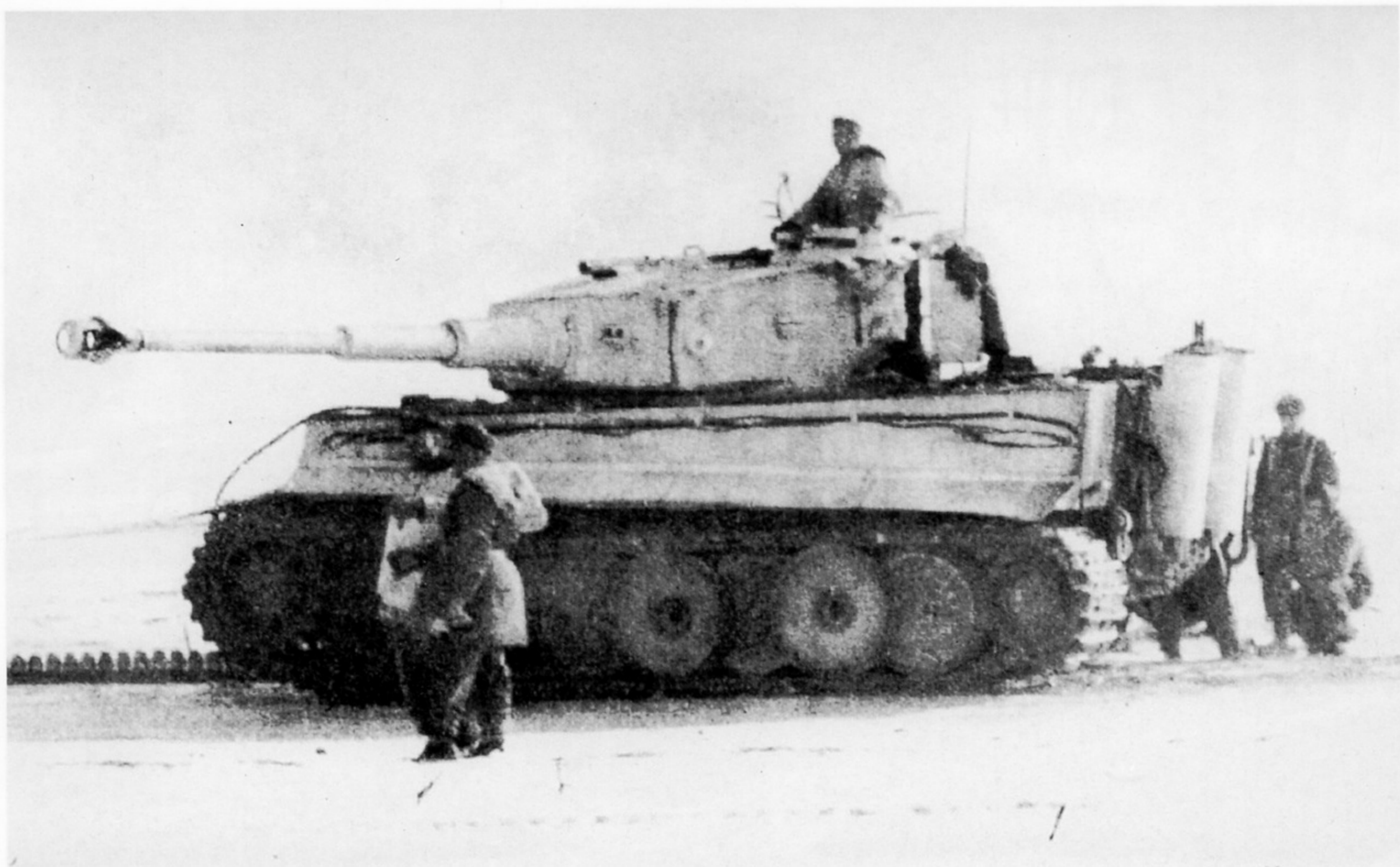
Dieser Kampfwagen hat die Kette geworfen; die Besatzung ist bemüht, den Schaden zu beheben. Angesichts des Gewichts der Geländekette keine leichte Aufgabe. Aufnahme vom Südabschnitt der Ostfront, März 1944.
