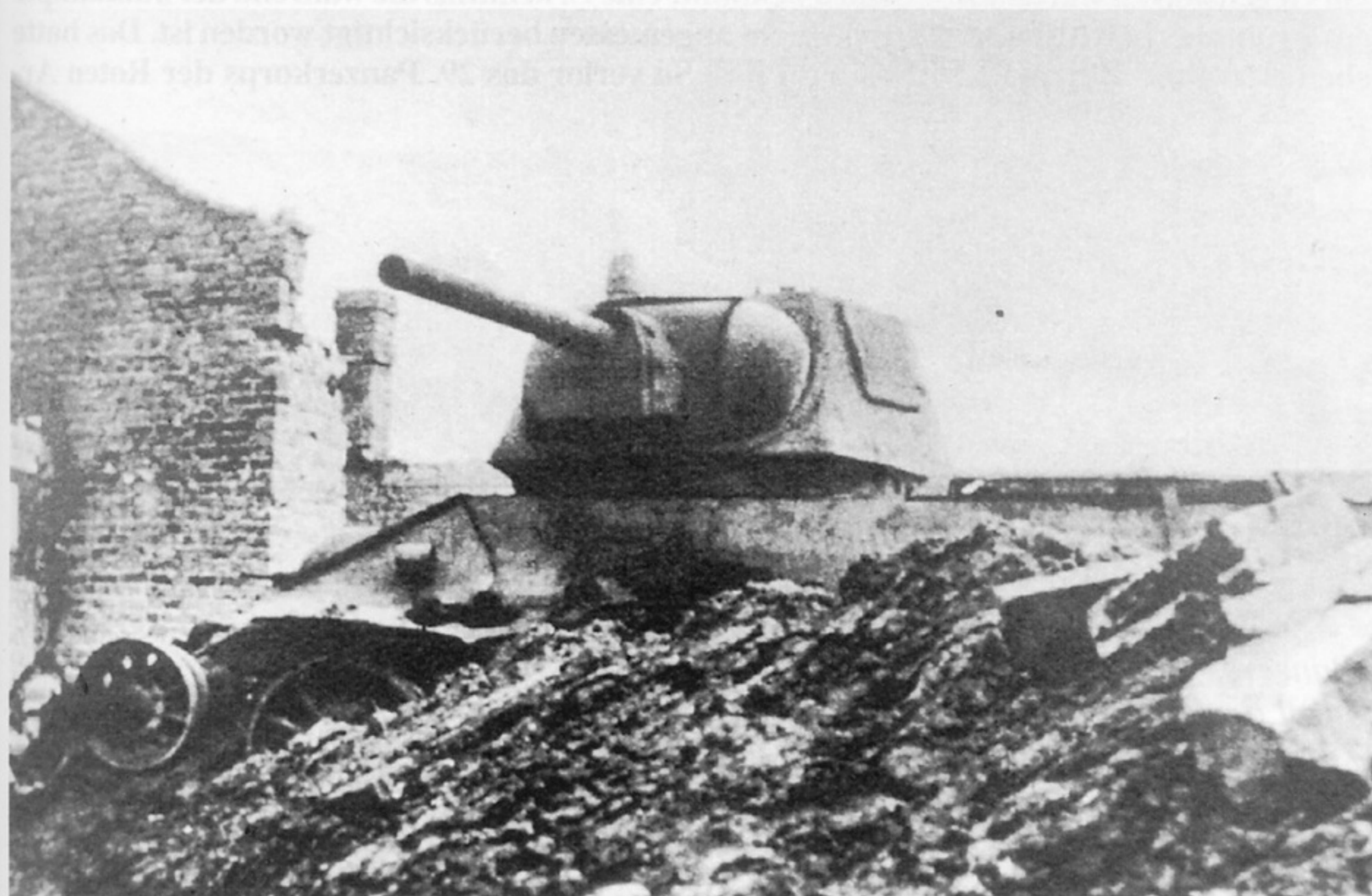
Im Jahr 1943 erhielt die Rote Armee insgesamt 15 812 mittlere Panzer des Typs T-34. Hier im Bild wieder die Ausführung mit verstärkter Frontpanzerung und mit der 76,2-mm-Kampfwagenkanone F-34 (Modell 1942). Das Geschütz erreichte mit der Panzergranate auf 500 m eine Durchschlagsleistung von 69 mm Panzerstahl; mit der Unterkalibergranate waren es 92 mm.
