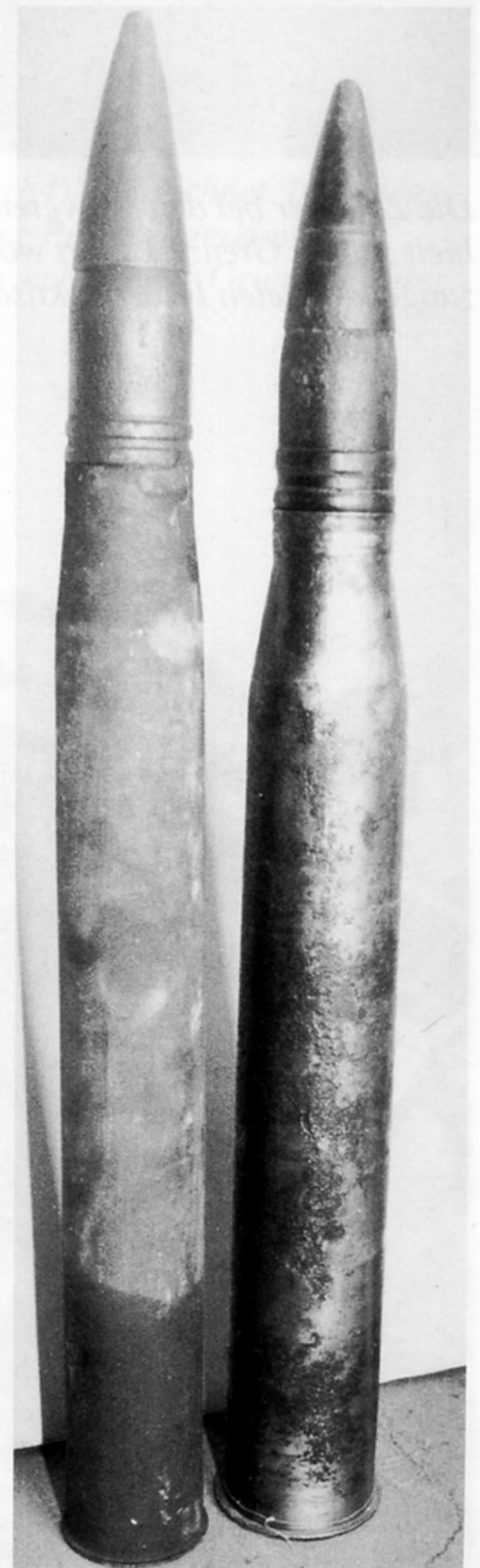
Die 8,8-cm-Panzergranatpatrone 39 für die 8,8-cm-Fliegerabwehrkanone 41 (im Bild links) und die 8,8-cm-Panzergranatpatrone 39 für die 8,8-cm-Kampfwagenkanone 43. Auf 1000 m wurden 158 bzw. 165 mm Panzerstahl durchschlagen.
