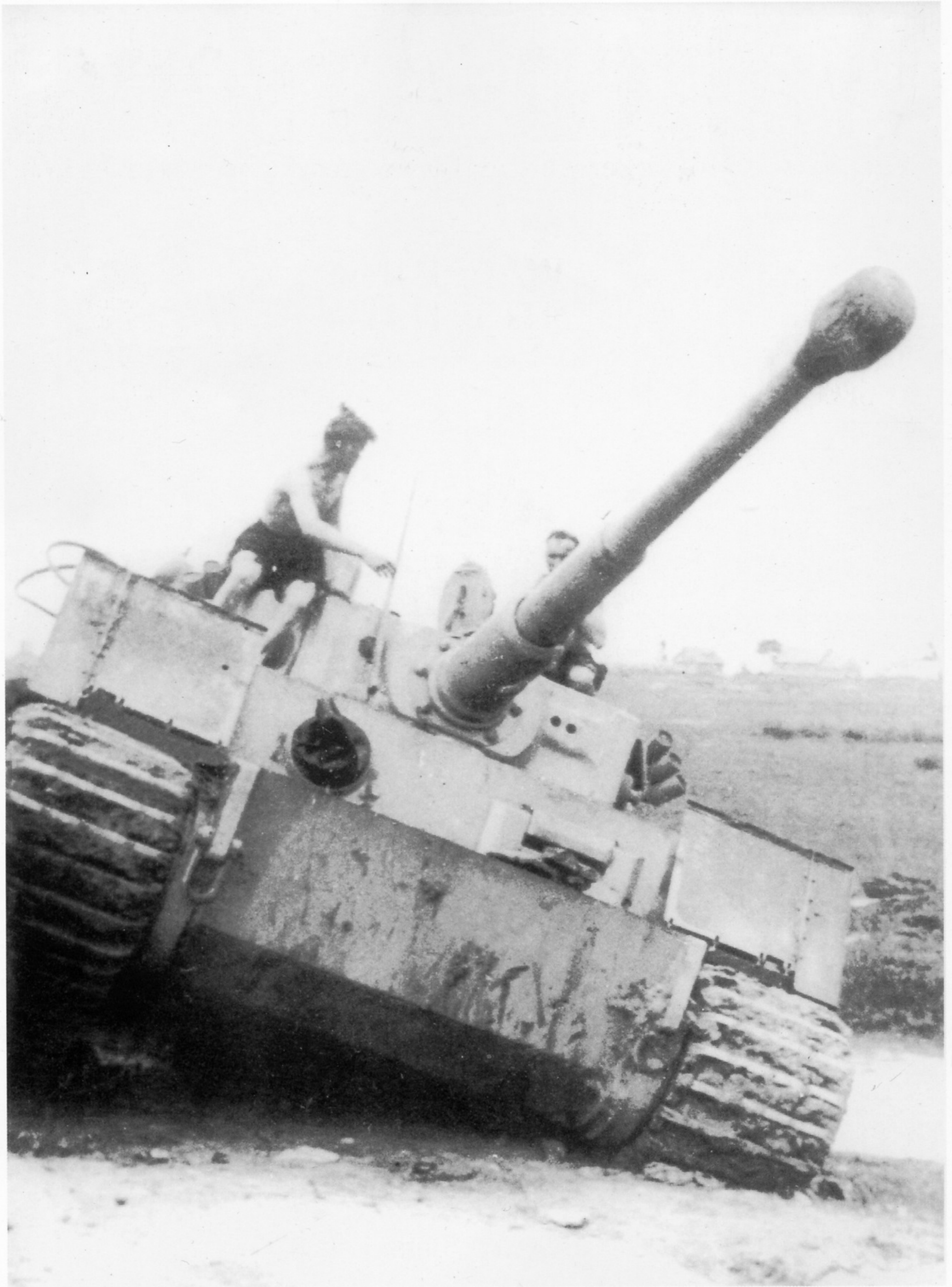
Frontansicht eines Panzerkampfwagen VI „Tiger“ (Sd. Kfz. 181). Ein imponierendes Bild gepanzerter und motorisierter Feuerkraft. Um die Beweglichkeit des 55 t schweren Kolosses war es weniger gut bestellt.
