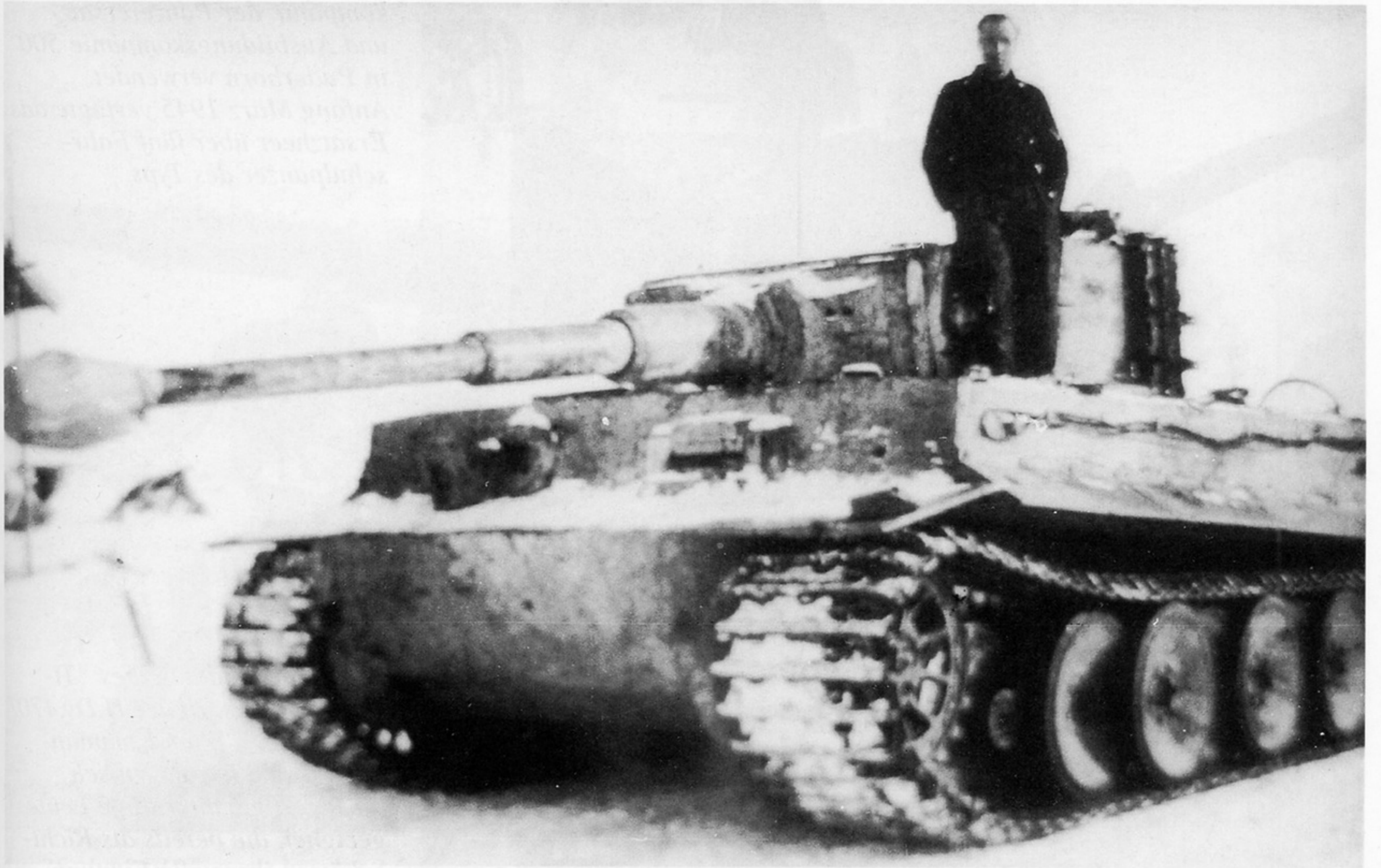
1942 wurden 83 "Tiger"-Panzer ausgeliefert. 1943 waren es 649 und 1944 623 Fahrzeuge des Typs. Im August 1944 verließen die letzten sechs Panzerkampfwagen VI "Tiger" (Sd.Kfz.181) das Henschel-Werk in Kassel. Das hier im Bild gezeigte Fahrzeug verfügt über die Panzerführerkuppel (neuer Bauart), die ab Juli 1943 eingebaut wurde.
