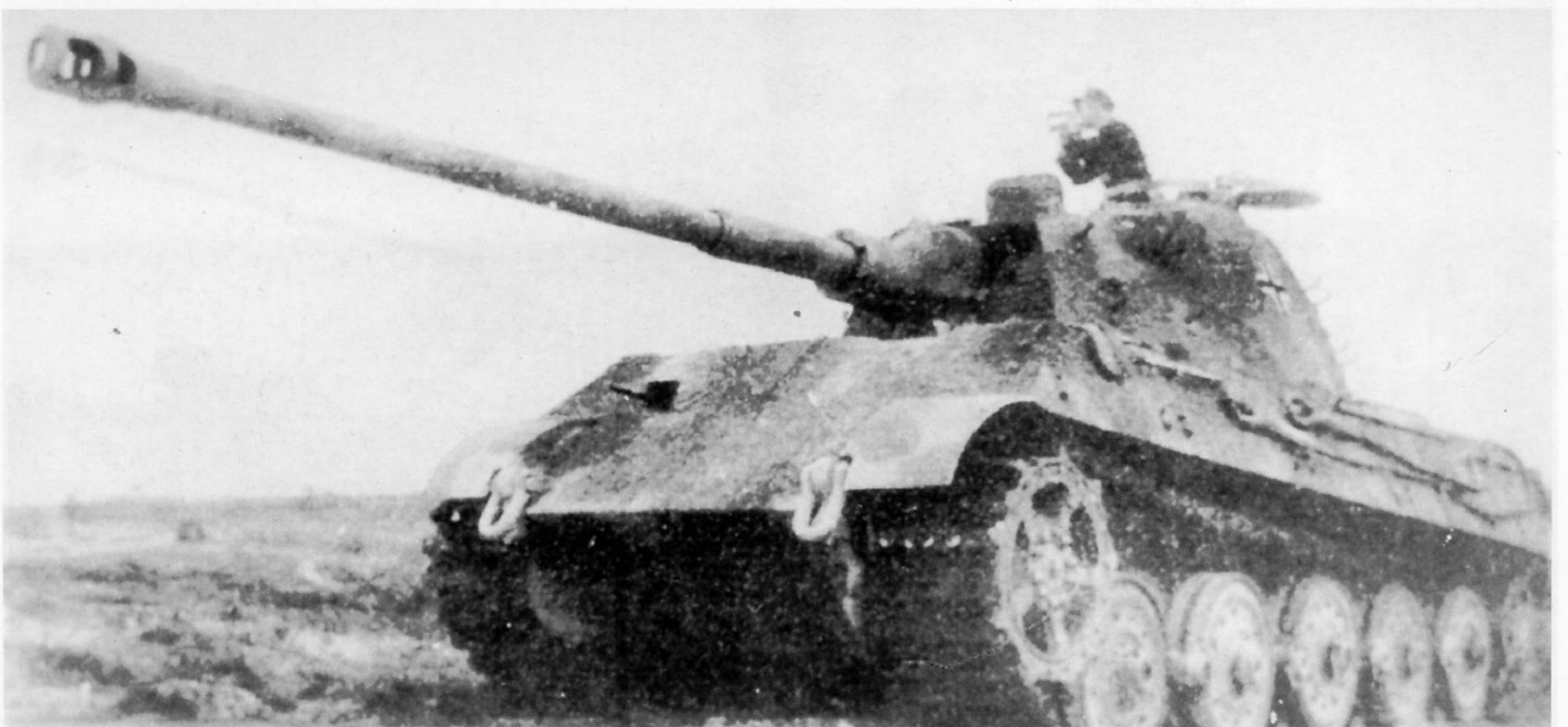
Ein "Tiger"-Panzer mit der Verladekette (Breite 0,66 m, Gewicht einer Kette 1,8 t). Die Aufnahme entstand im Herbst 1944 während der Verbandsausbildung einer schweren Panzerabteilung.
