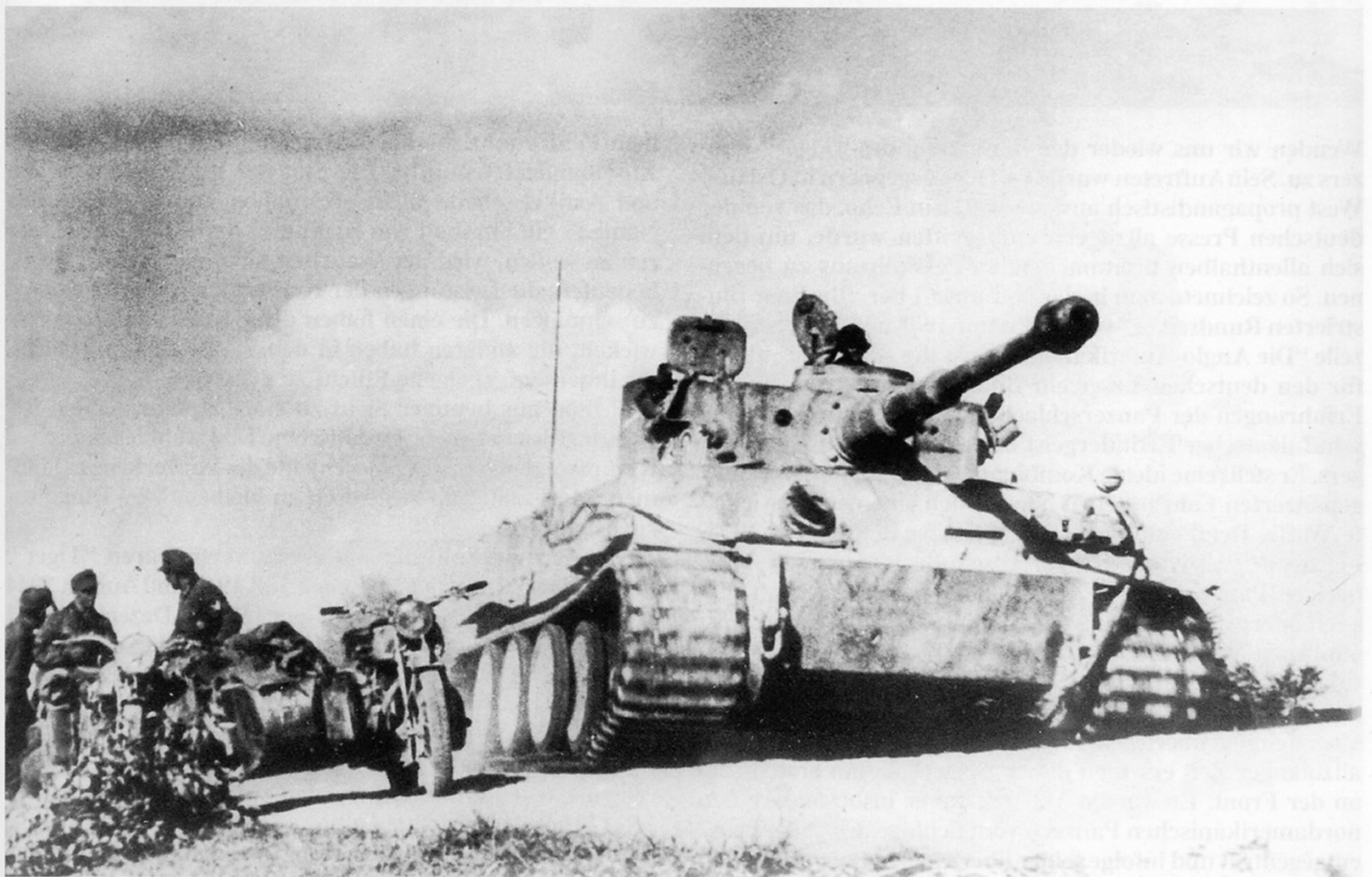
Um die Antriebsanlage des Panzerkampfwagen VI "Tiger" (Sd.Kfz.181) zu schonen, sind die Fahrer angewiesen worden, falls es das Gelände und Feindlage es gestatteten grundsätzlich mit 15 bis 20 km/h zu fahren (H.Dv.470/5 f "Ausbildungsvorschrift für die Panzertruppe" vom 15. August 1943.
