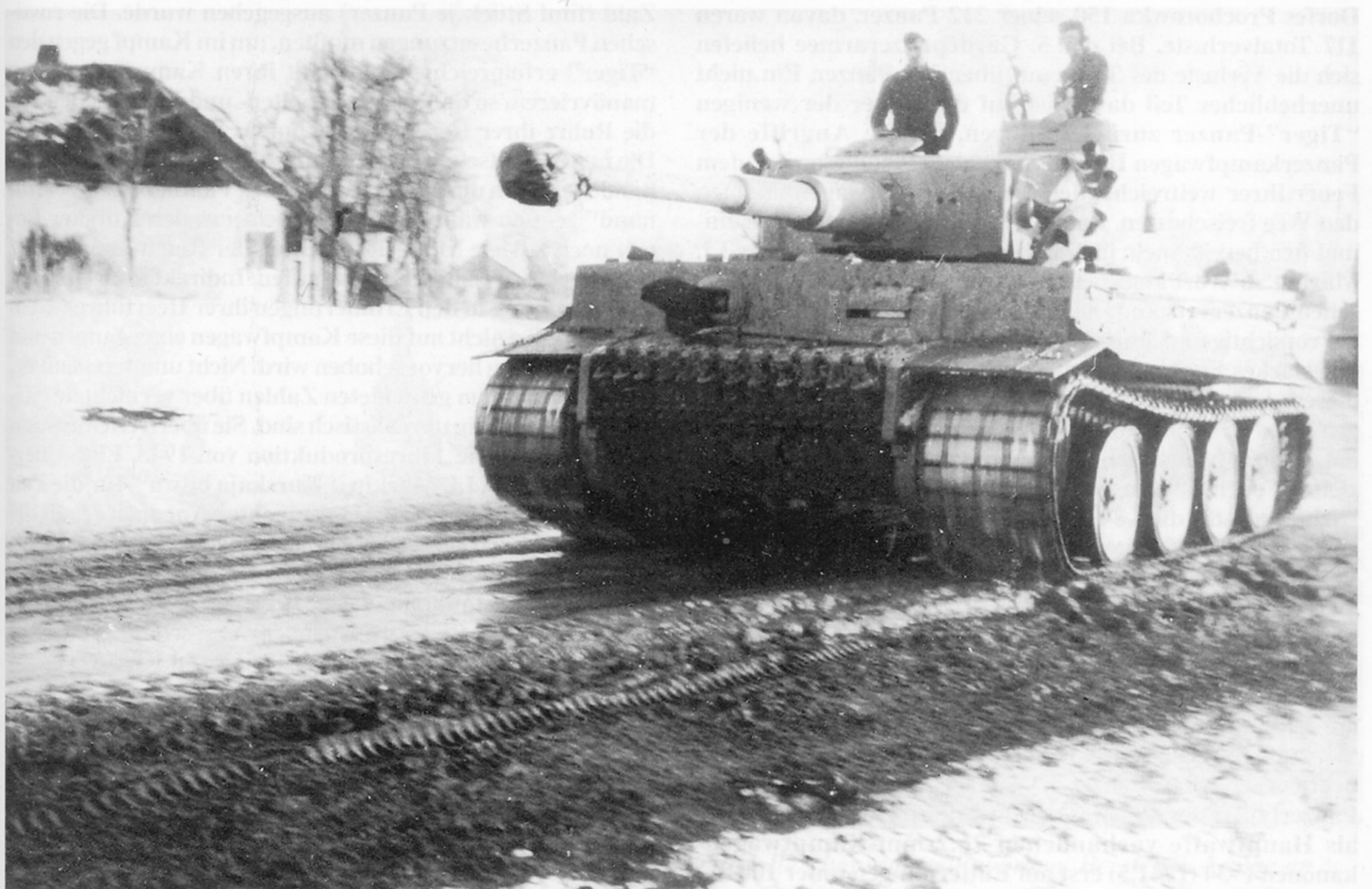
Im Frühjahr 1943 an der Ostfront. Trotz seines beachtlichen Gewichtes ließ sich der Panzerkampfwagen VI "Tiger" (Sd.Kfz.181) auch bei hoher Geschwindigkeit leicht lenken.
