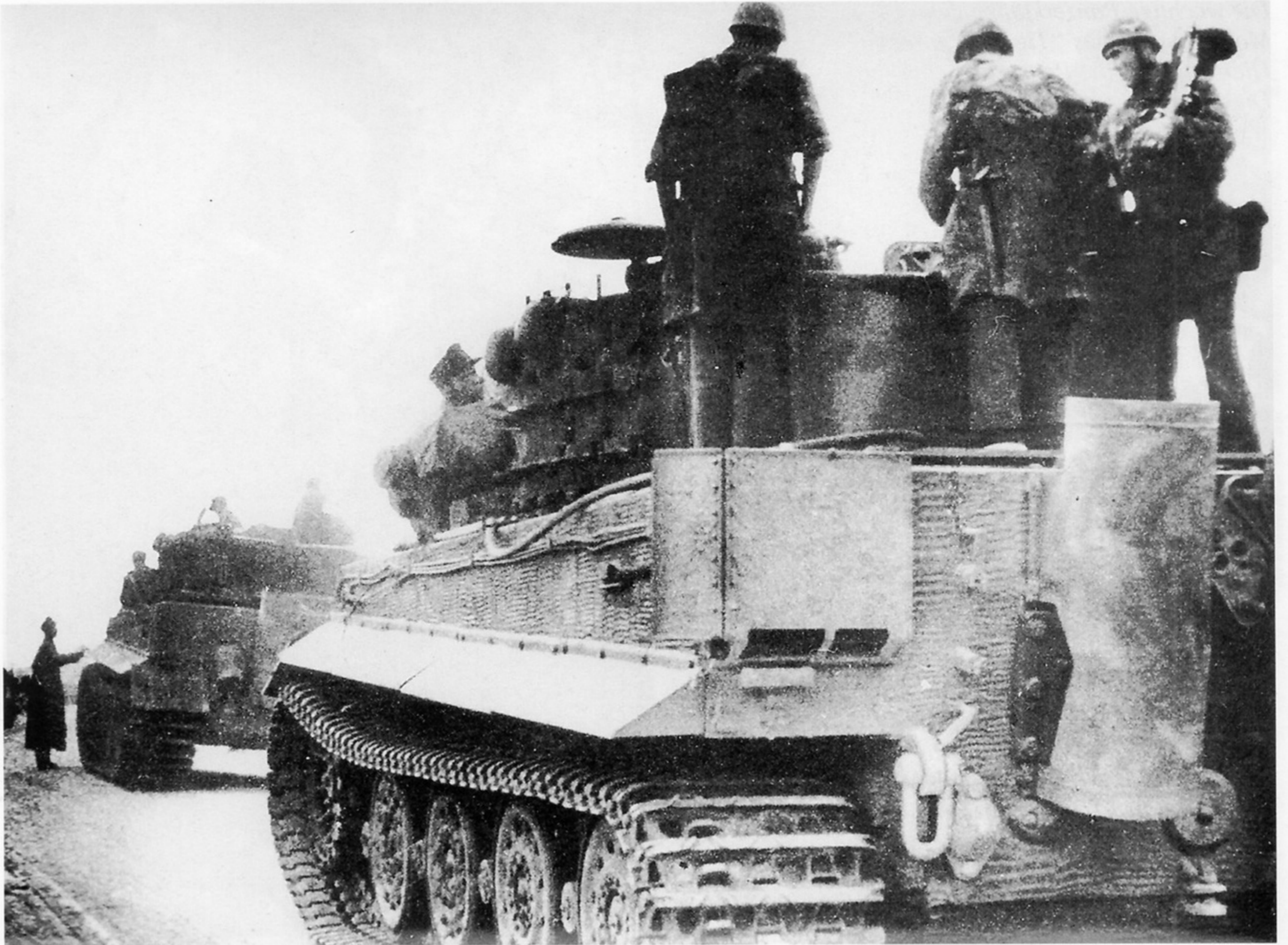
“Tiger”-Panzer der Abschlußausführung mit der Panzerführerkuppel (neuer Bauart) und dem Laufwerk mit gummisierenden Stahllaufrollen. Davon sind ab März 1944 noch einmal über 500 Stück zur Auslieferung gekommen. Die Abbildung unten zeigt ein solches Fahrzeug bei der schweren Panzerabteilung der Panzergranadierdivision “Großdeutschland” nördlich von Mitau. Aufnahme vom September 1944.
