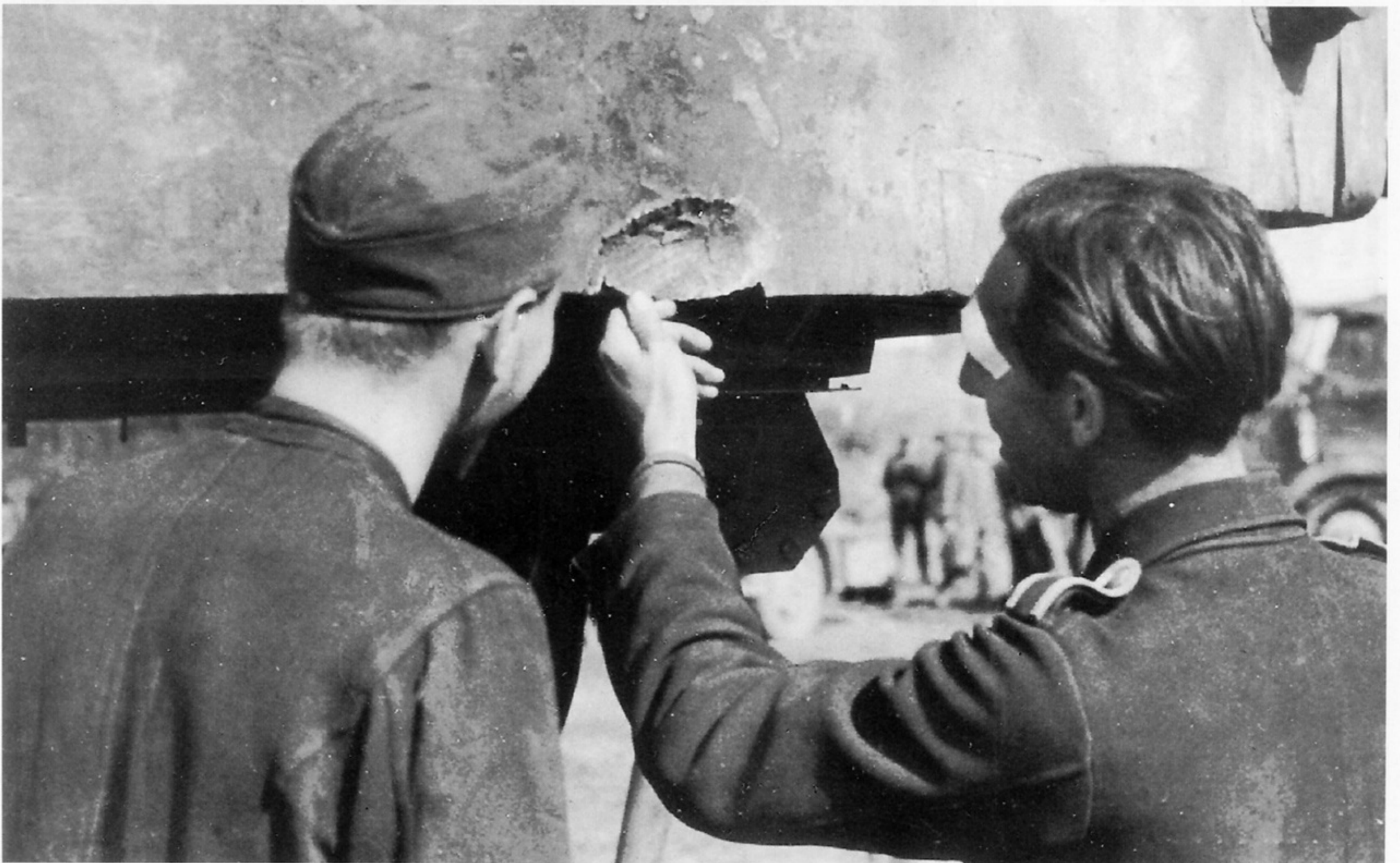
Für die Qualität der Panzerung des "Tiger" sprach der in der D 656/27 "Die Tiger-Fibel" vom 1. August 1943 abgebildete Kampfwagen. Er hatte während der Kämpfe im Kursker Bogen im Juli 1943 innerhalb von sechs Stunden 227 Panzerbüchsen- und 25 Artillerietreffer erhalten und war trotz zahlreicher Schäden im Laufwerk mit eigener Kraft noch 60 km weit gefahren.
