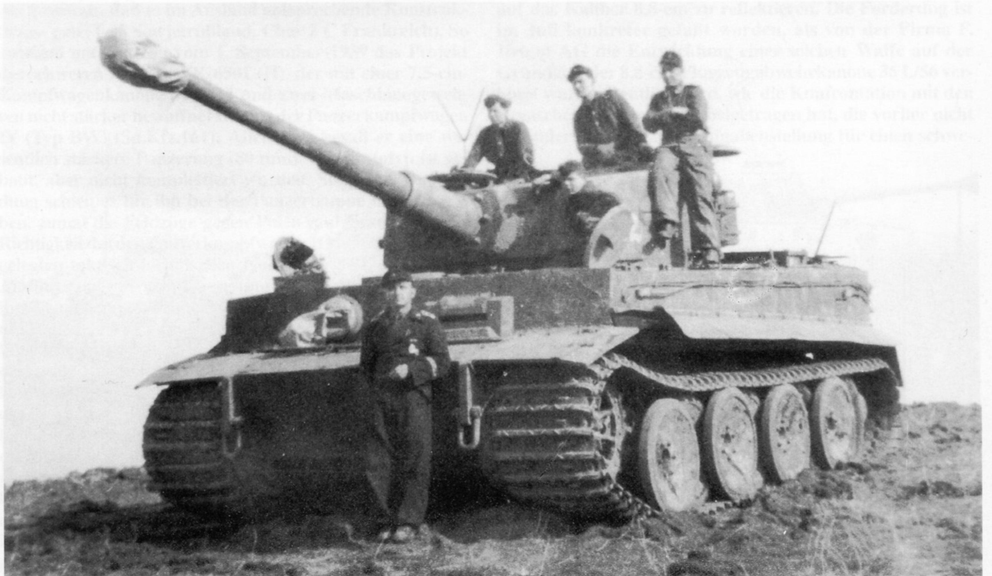
Rund ein Fünftel vom Gesamtgewicht des 56 t schweren Panzerkampfwagen VI "Tiger" (Sd.Kfz.181) entfielen auf den Drehturm mit der 8,8-cm-Kampfwagenkanone 36 L/56. Die Waffe selbst wog 1,31 t. Für das Geschützrohr ergab sich eine durchschnittliche Lebensdauer von 6000 Schuß.
