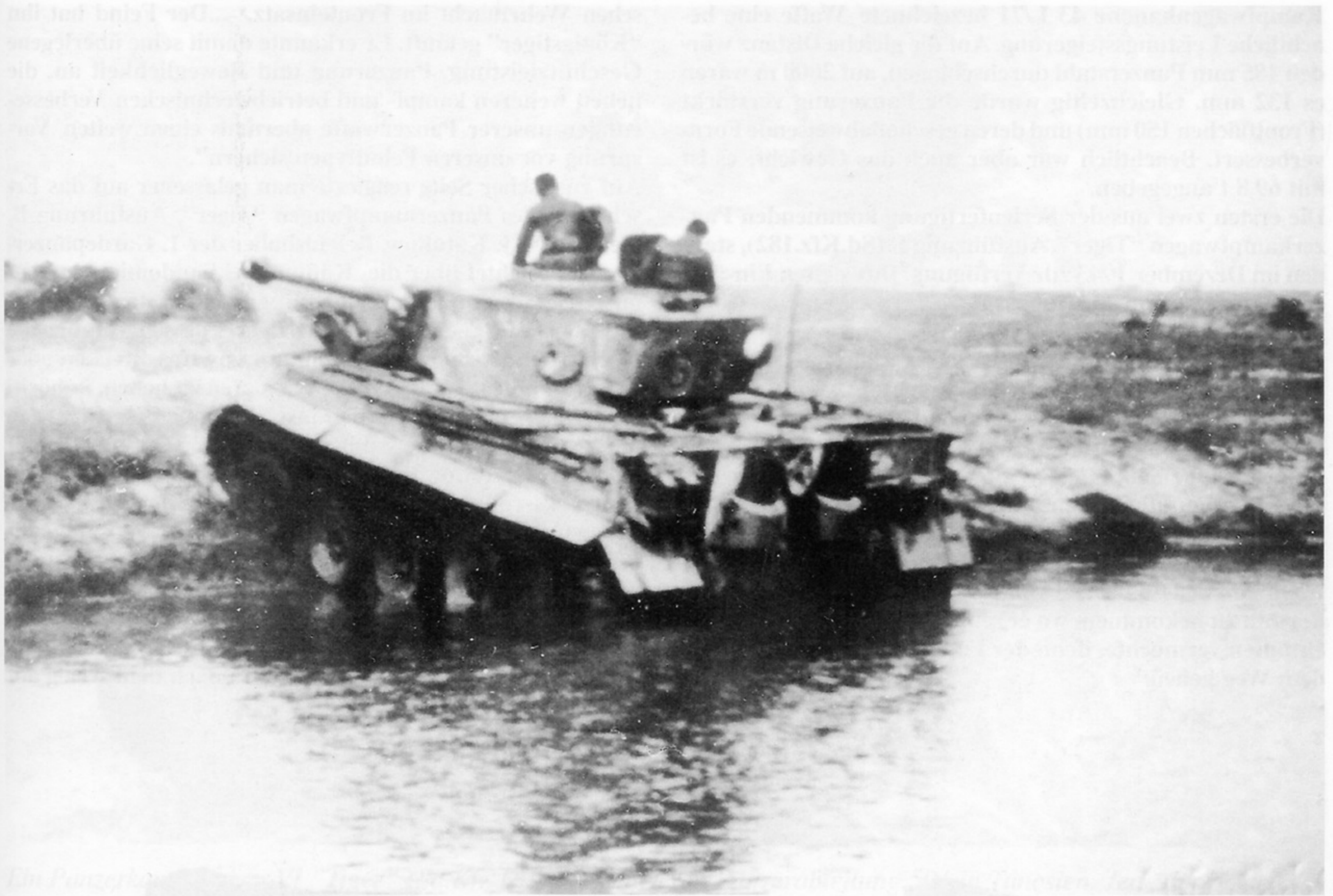
In der D 656/27 vom 1. August 1943 wurde den Besatzungen von "Tiger"-Panzern empfohlen, mit ihren Kampf- wagen Flüsse zu durchfurten. Voraussetzung dafür war ein harter, fester Untergrund.
