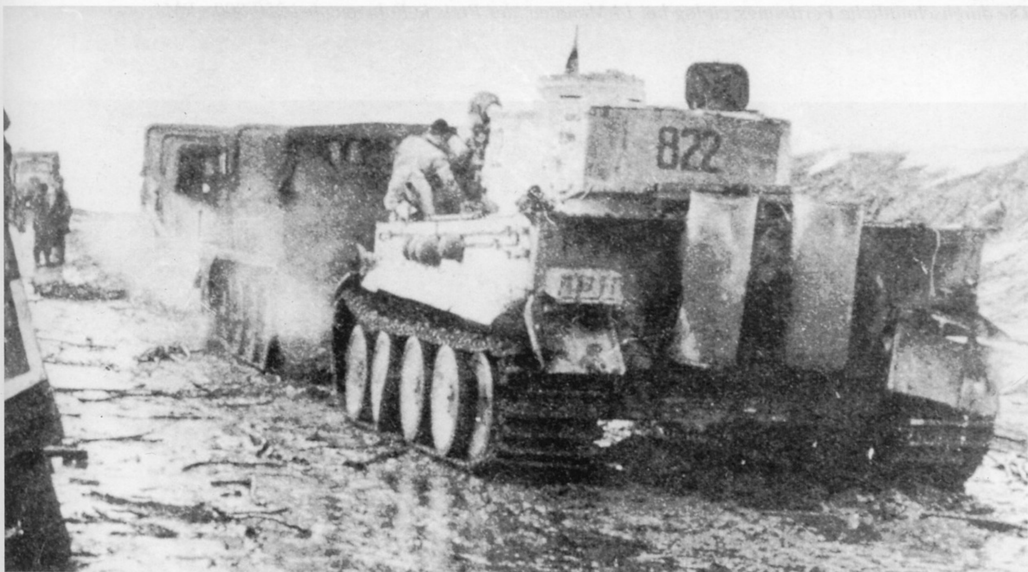
Ein "Tiger"-Panzer wird von drei schweren Zugkraftwagen 18 t (Sd.Kfz.9) in die Werkstatt geschleppt. Die Aufnahme entstand Mitte März 1943 im Abschnitt bei der SS-Panzer Grenadierdivision "LSSAH". Während der Kämpfe südostwärts Krutaja Balka ist die I./Panzerregiment "LAH" von einer "Tiger"-Kompanie unterstützt worden (Divisionsbefehl Nr. 7 vom 5. März 1943).
