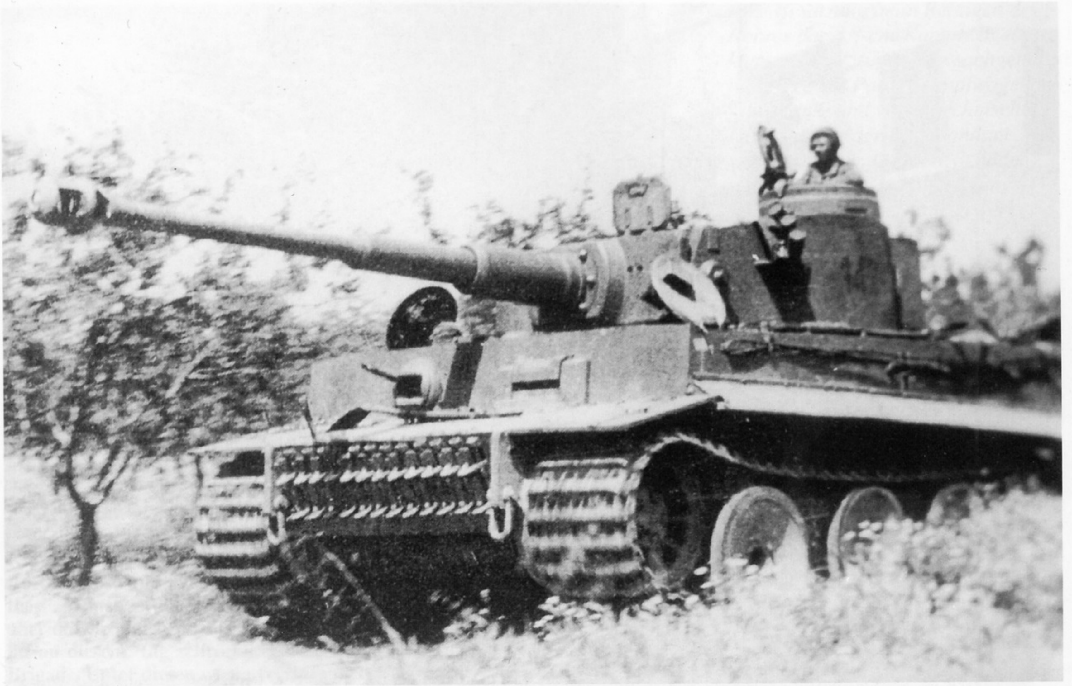
Während des Marsches wurde zur Schonung der Richtmaschine der Turm durch Seitzuzurrung (zwölf Uhr) und die Kanone durch die Höhenzurrung am Turmdach festgelegt.
