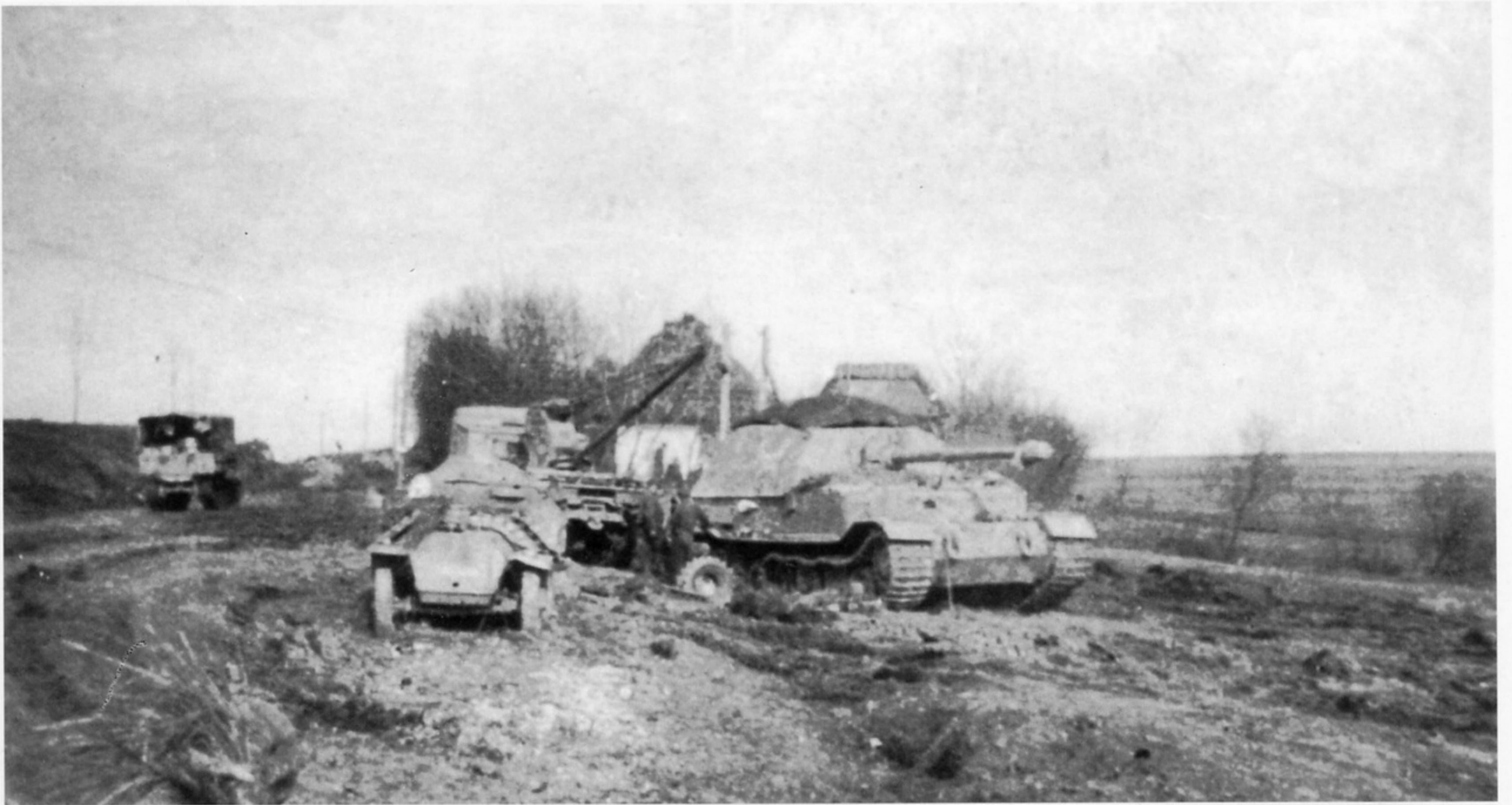
Die schweren Jagdpanzer "Ferdinand" erwiesen sich im Einsatz als sehr störanfällig. Nachteilig machte sich weiterhin der geringe Kampfsatz (55 Granatpatronen) und das Fehlen einer Nahverteidigungswaffe bemerkbar. Letztere wurde später nachgerüstet.
