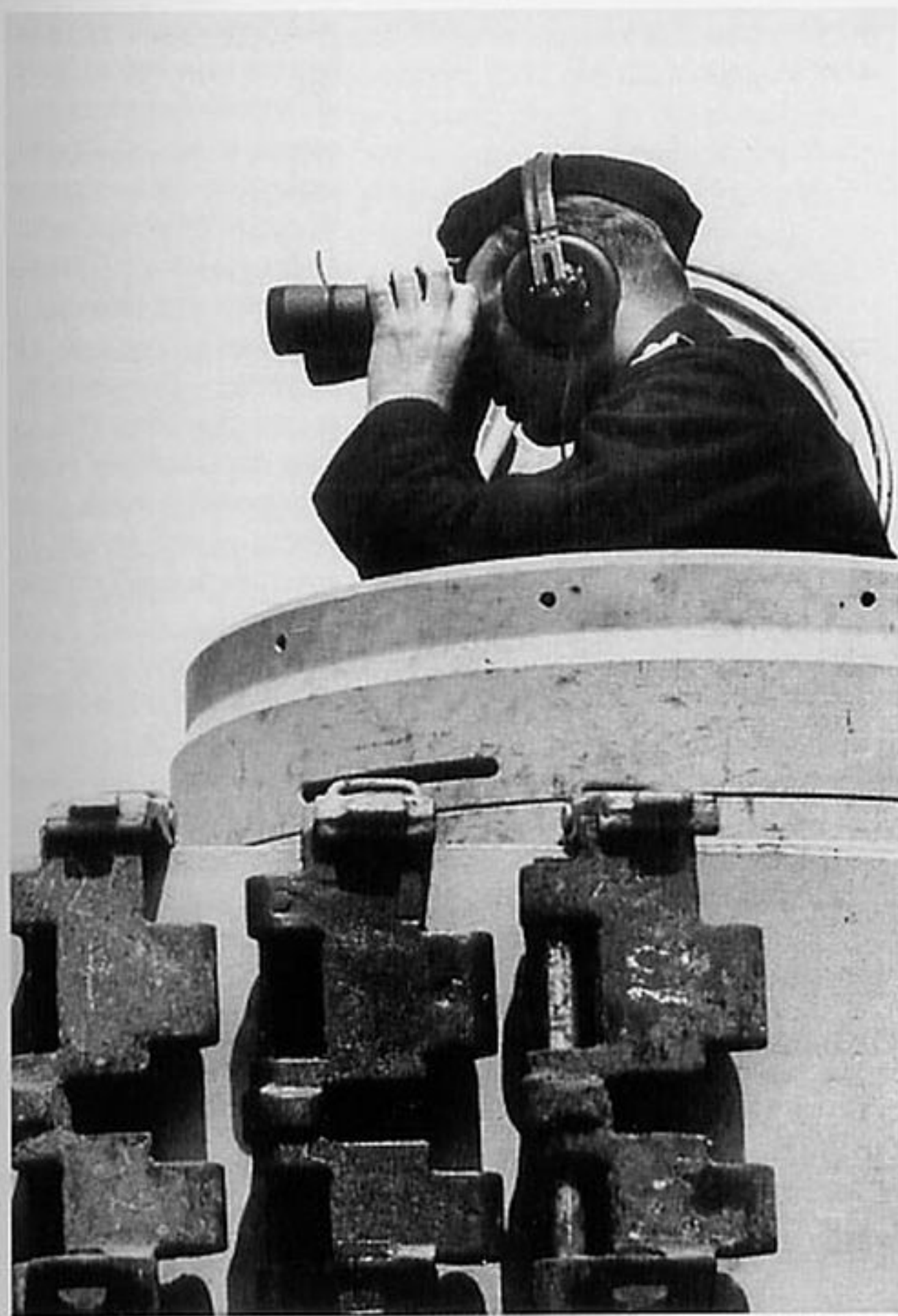
▲ Dowódca Tygrysa poszukuje przez lornetę kolejnej ofiary. Widać szczeliny obserwacyjne wieżyczki dowódcy oraz pojedyncze zapasowe ogniwa gąsienicy na boku wieży / via Hideya Ando
