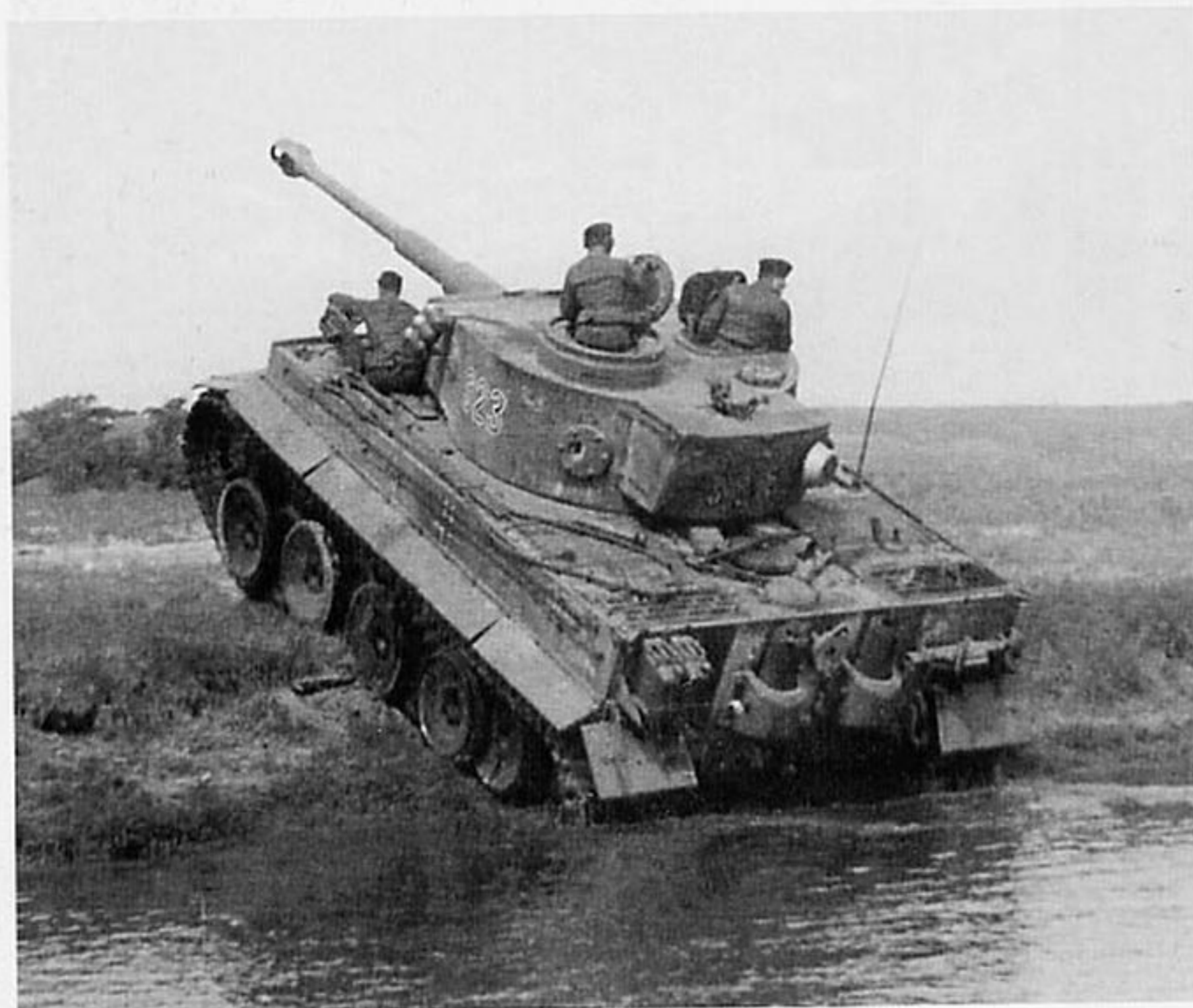
◀ Tygrys z 2. plutonu 3. kompanii 503. batalionu czołgów ciężkich kilka tygodni przed operacją „Zitadelle”, w czasie szkolenia załóg. Zwracają uwagę zdjęte osłony rur wydechowych / via Hideya Ando
