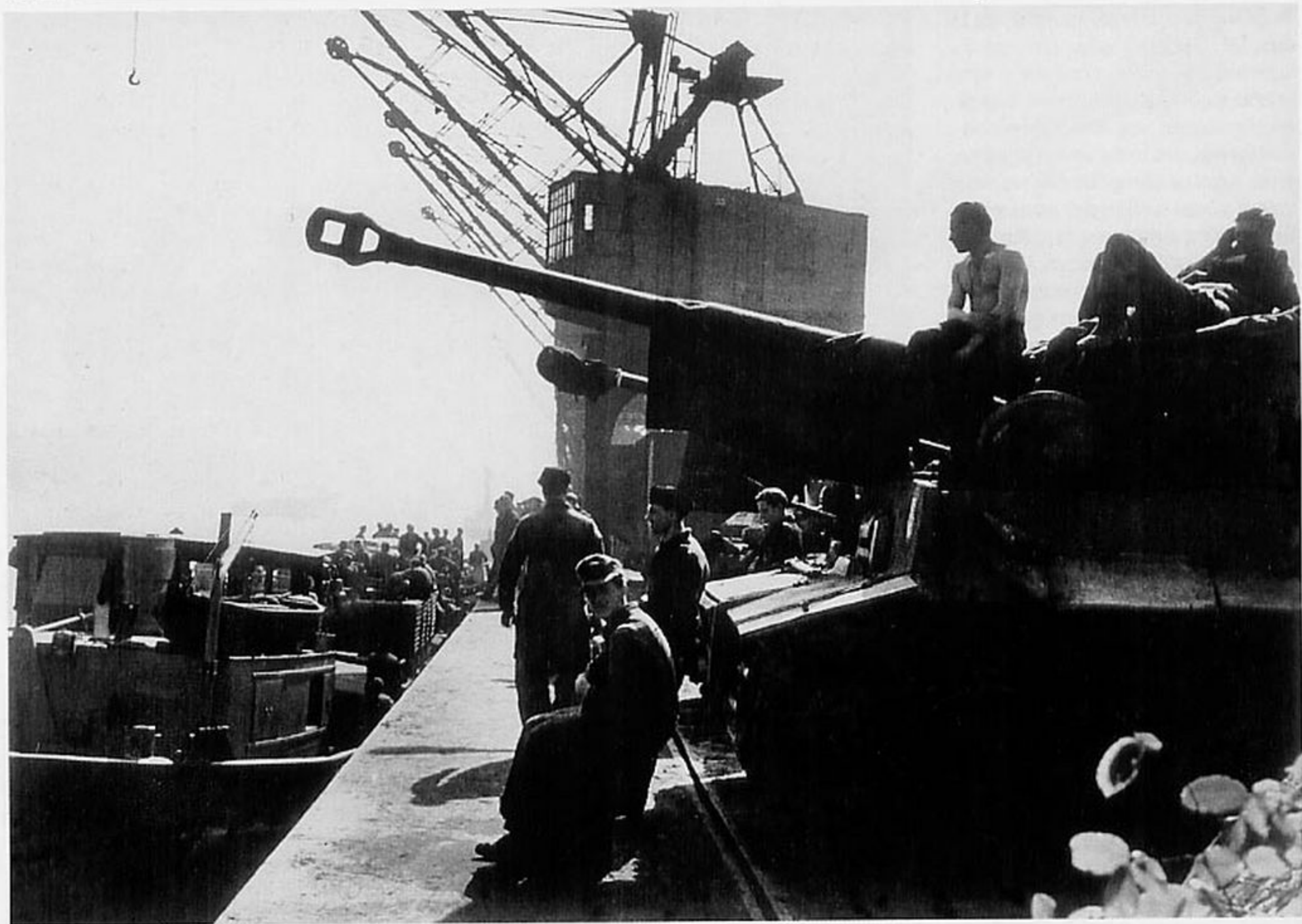
▲ Czołgi Tygrys wczesnej wersji produkcyjnej oczekują na załadunek do transportu morskiego. Zwracają uwagę zdemontowane zewnętrzne koła jezdne i założone gąsienice transportowe / via Hideya Ando
