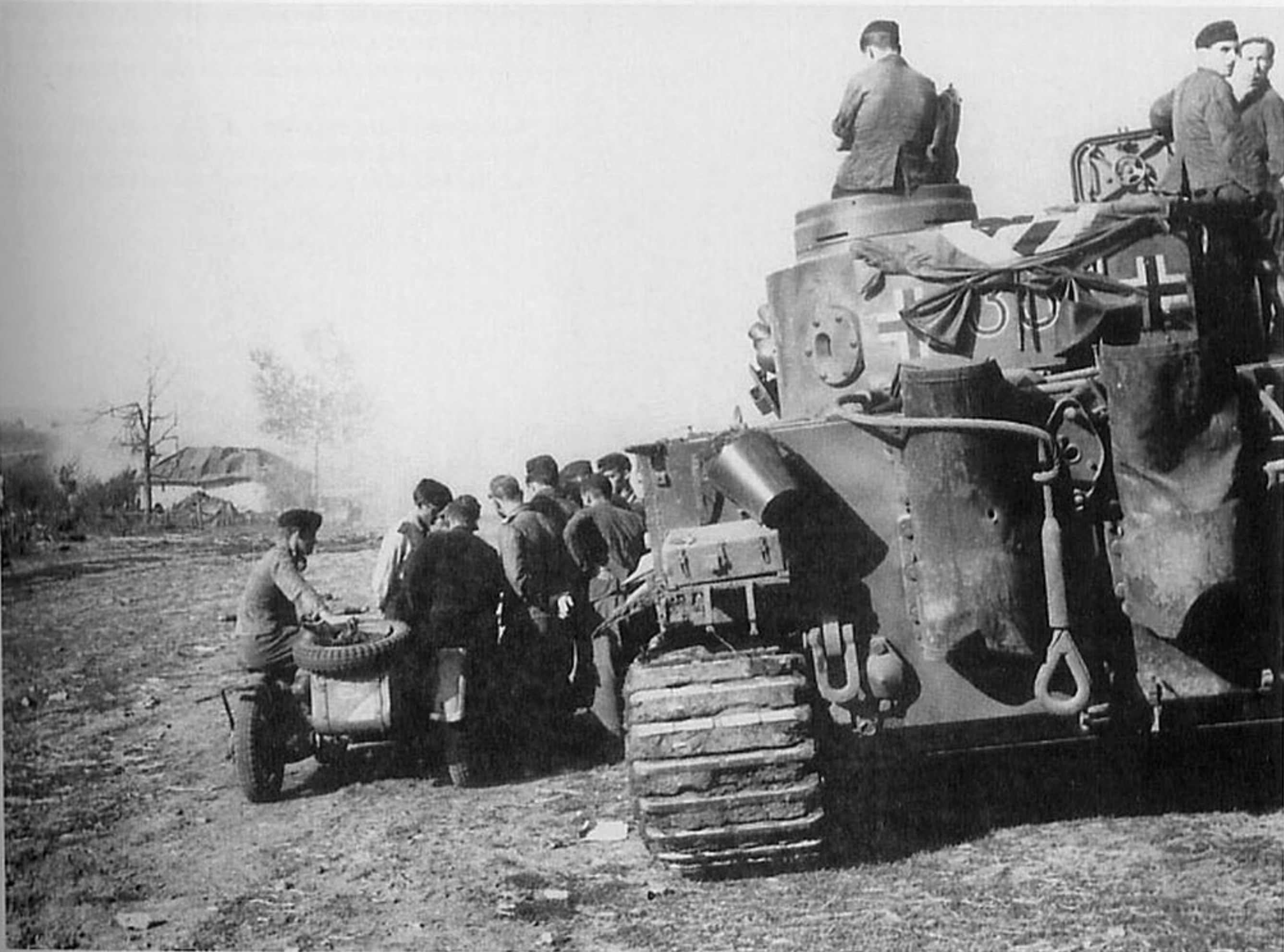
▲ Wczesny Tygrys z 3. plutonu 3. kompanii 503. batalionu czołgów ciężkich w czasie bitwy na łuku Kurskim. Zwraca uwagę rozłożona na dachu wieży flaga — znak rozpoznawczy dla lotnictwa — oraz zdemontowane filtry Feifel i niestandardowe ułożenie liny holowniczej / via Hideya Ando
