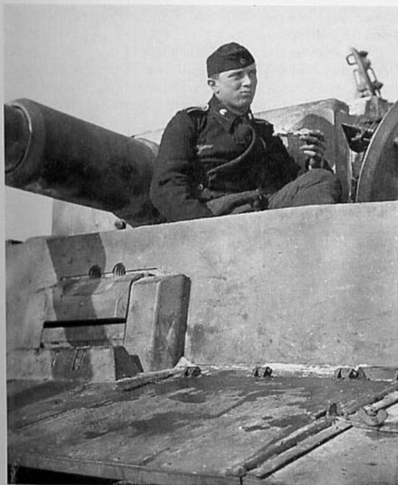
▲ Przednia płyta przedziału kierowania Tygrysa wczesnych serii z otworami peryskopu kierowcy KKF2 nad żaluzją przyrządu obserwacyjnego. W toku eksploatacji peryskopy usunięto, a ich otwory zaślepiono / via Hideya Ando
