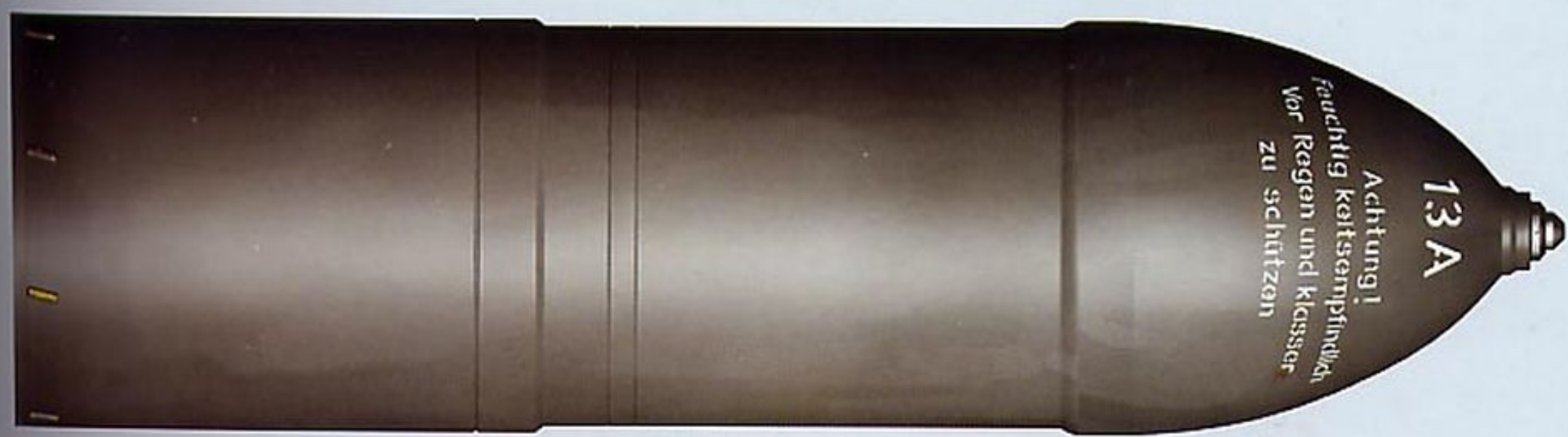
▼ Pocisk raketowy 38 cm Raketen-Sprenggranatpatrone 4581 do moździerza RW 61 pojazdu Sturmtiger widziany z boku
