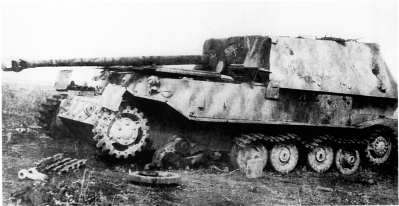
«Фердинанд» 653-го батальона, подорвавшийся на mine. Июль 1943 года. От взрыва сорвало опорные катки левой передней тележки (АСКМ).
