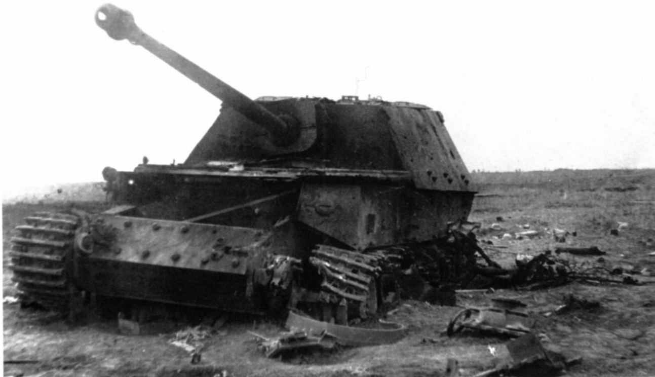
«Фердинанды», испытывавшиеся обстрелом 20 – 21 июля 1943 года. Хорошо видны многочисленные снарядные попадания и пробоины (АСКМ).
