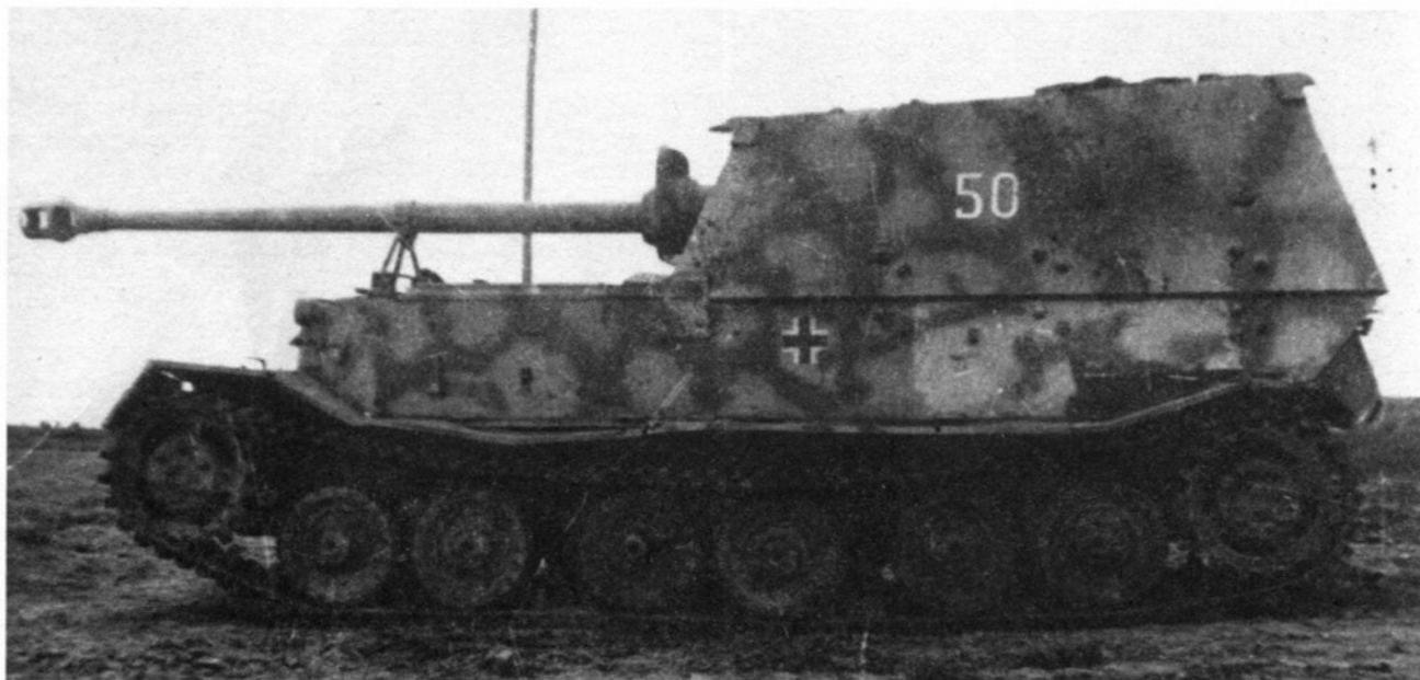
Вид слева на «Фердинанд» № 501. НИБТ полигон, 1943 год. Хорошо виден след от попадания осколочно-фугасного снаряда в борт рубки (АСКМ).
