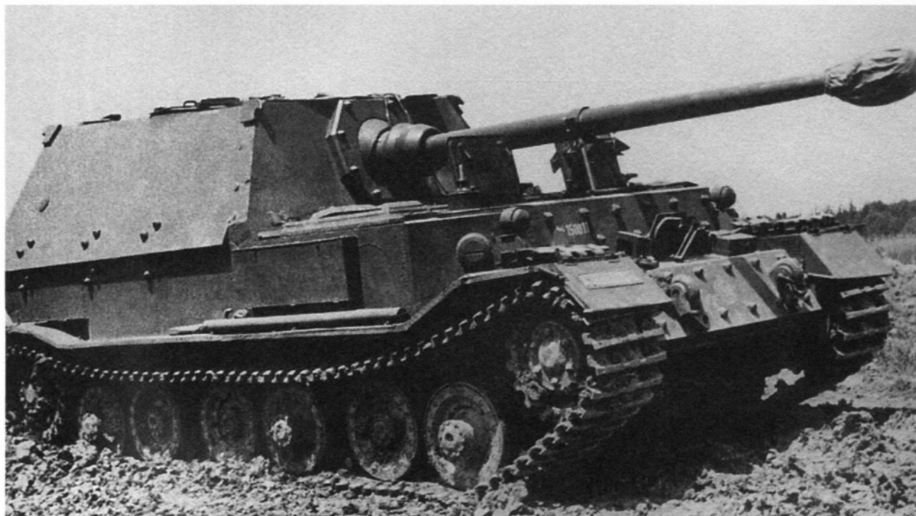
Испытание «Фердинанда» (шасси № 150011) на полигоне в Куммерсдорфе, весна 1943 года. На правом борту машины хорошо виден заваренный эвакуационный люк, доставшийся «фердинандам» в наследство от «Тигра» Порше.
