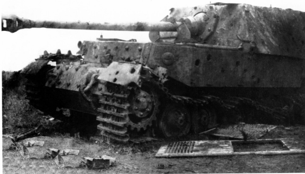
«Фердинанды», испытывавшиеся обстрелом 20 – 21 июля 1943 года. Хорошо видны многочисленные снарядные попадания и пробоины (АСКМ).
