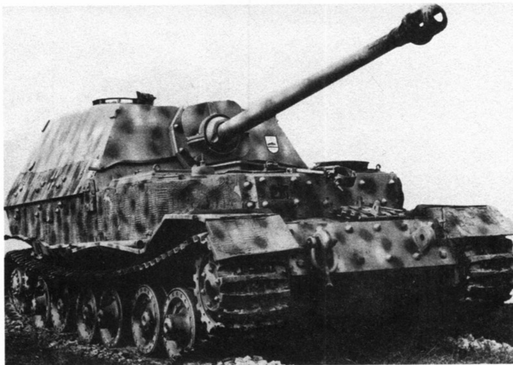
Общий вид «Элефанта из состава 1-й роты 653-го батальона. Весна 1944 год. Обратите внимание на погнутые желобки для стока дождевой воды и эмблему на лобовом листе рубки (АСКМ).
