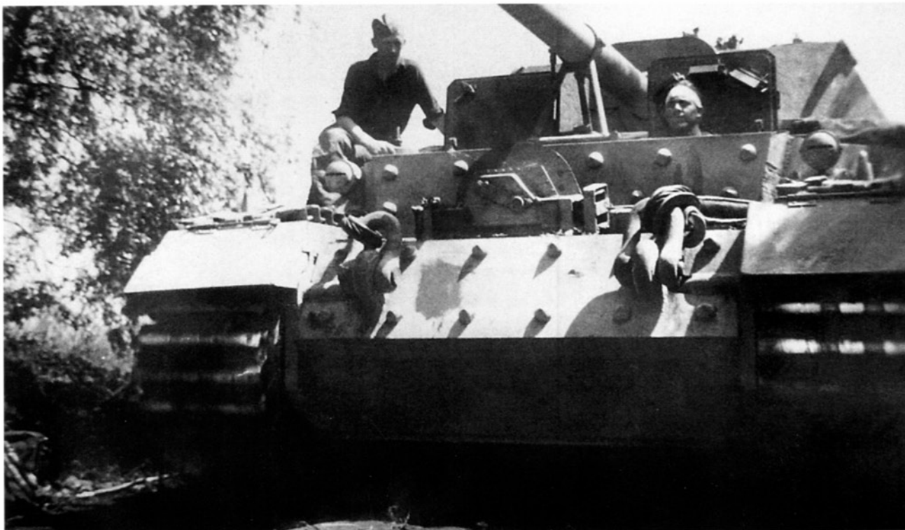
«Фердинанд» меняет позицию. Июль 1943 года. На лобовом листе хорошо видно крепление домкрата (ИП).
