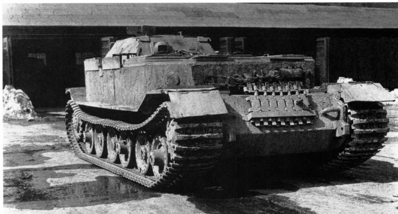
«Берге-Элефант» после ремонта. Апрель 1944 года. Машина покрыта циммеритом, на лобовом листе закреплены запасные траки, на рубке виден щиток для установки второго пулемета (ИП).
