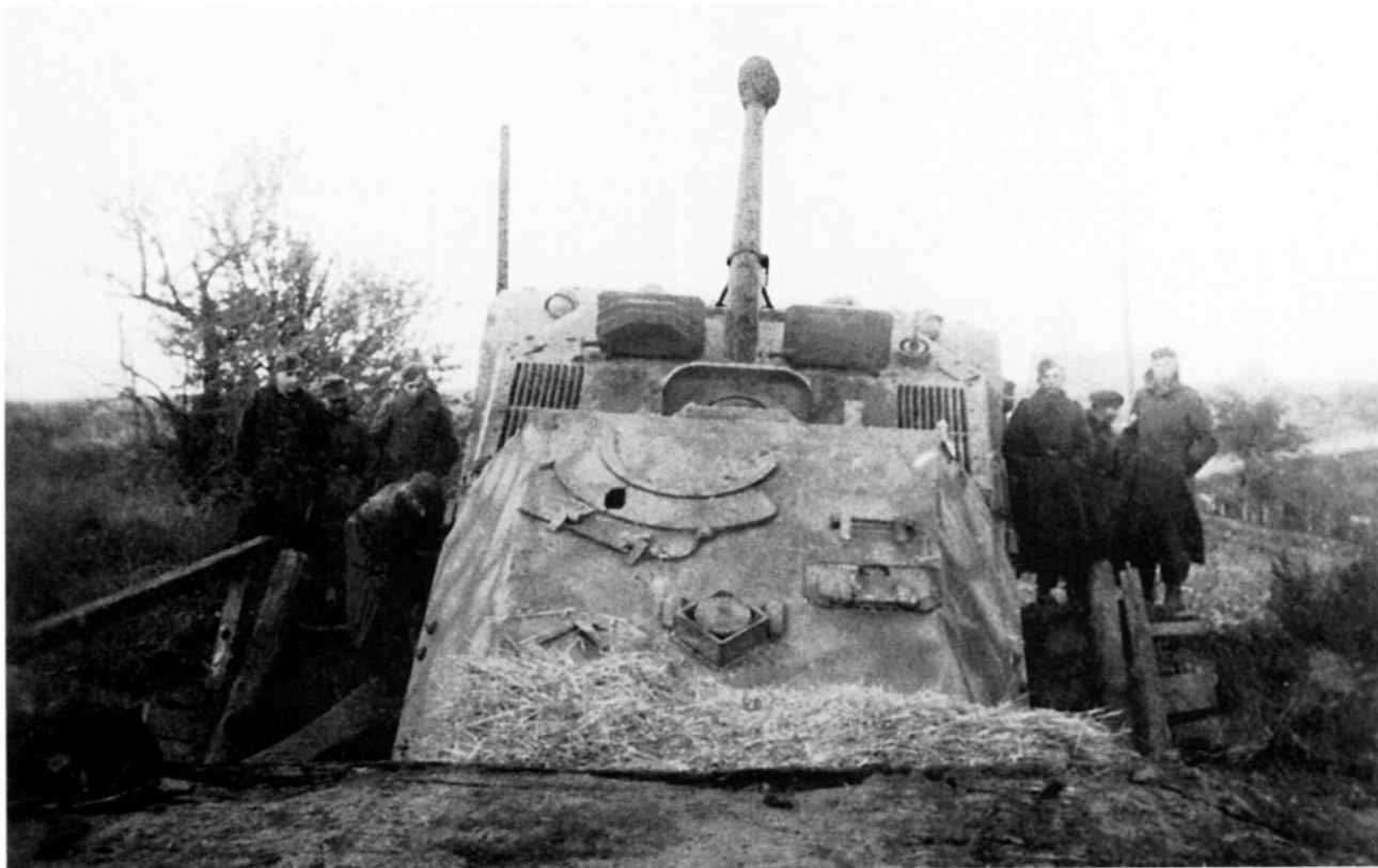
Далеко не каждый мост мог выдержать 65-тонную машину. Но благодаря этому есть хорошее фото, на котором хорошо видно крышу «Фердинанда». Район Никополя, октябрь 1943 года (ИП).
