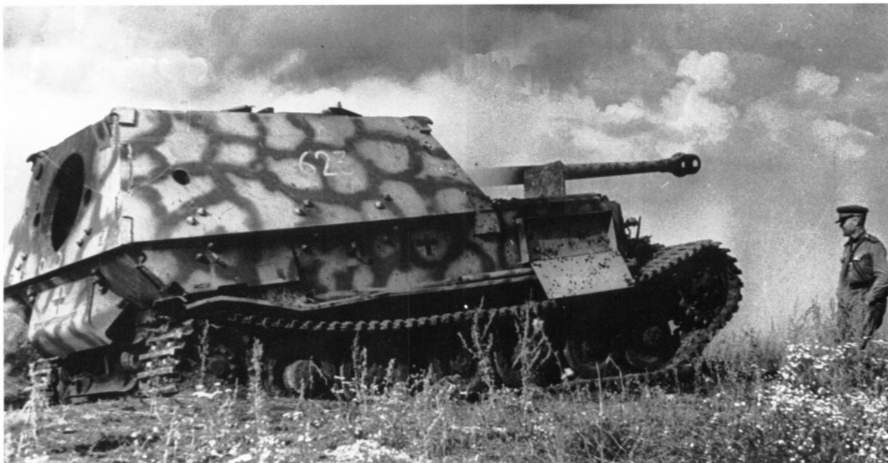
Офицер Красной Армии у «Фердинанда» № 623 6-й роты 654-го батальона тяжелых истребителей танков. От внутреннего взрыва разошлись сварные швы рубки. Июль 1943 года (АСКМ).
