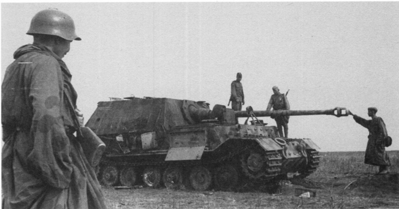
Красноармейцы осматривают подбитый «Фердинанд» (предположительно из состава 653-го батальона). Июль 1943 года. Машина имеет снарядную пробоину во втором опорном катке правого борта, на борту видны остатки второго, нештатного, ящика для инструментов (РГАКФД).
