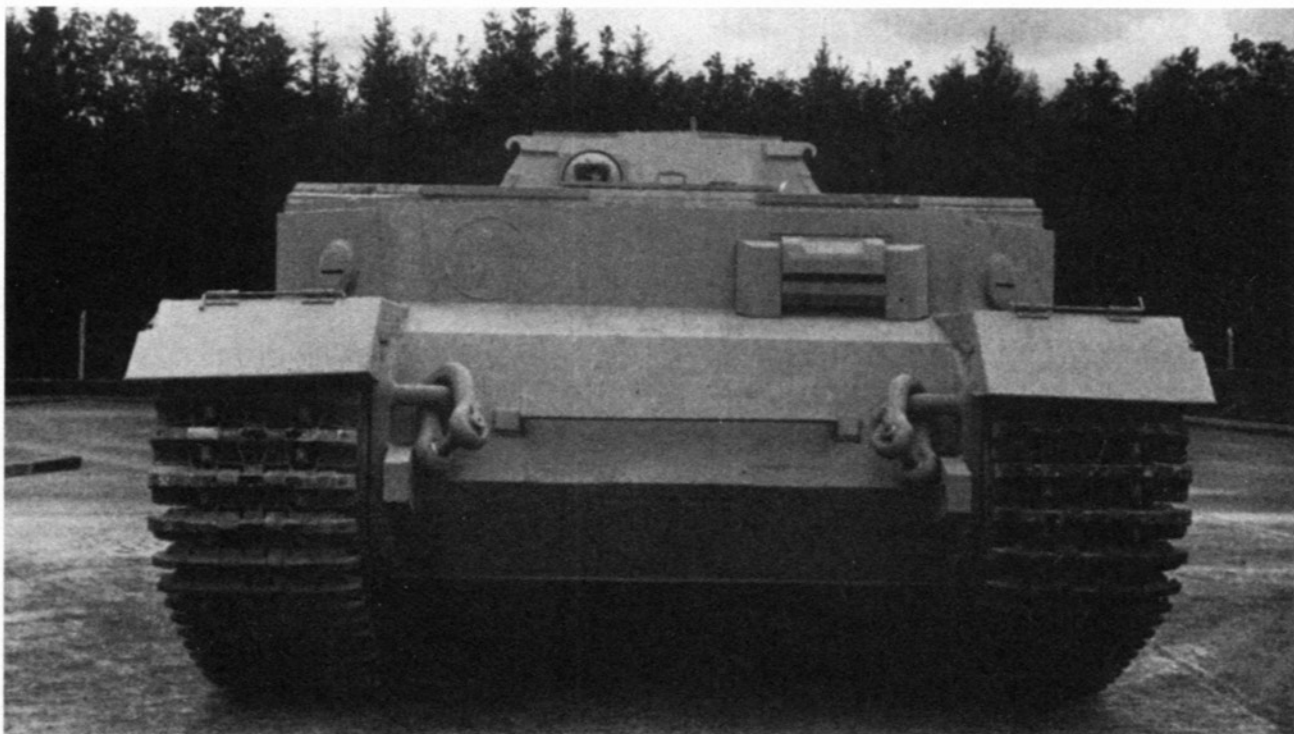
«Берге-Фердинанд» – машина для эвакуации «фердинандов», изготовленная на шасси танка VK 4501 (P), вид спереди. «Нибелунгенверке», август 1943 года. Хорошо видна заваренная пулеметная установка в лобовом листе корпуса (ВШ).
