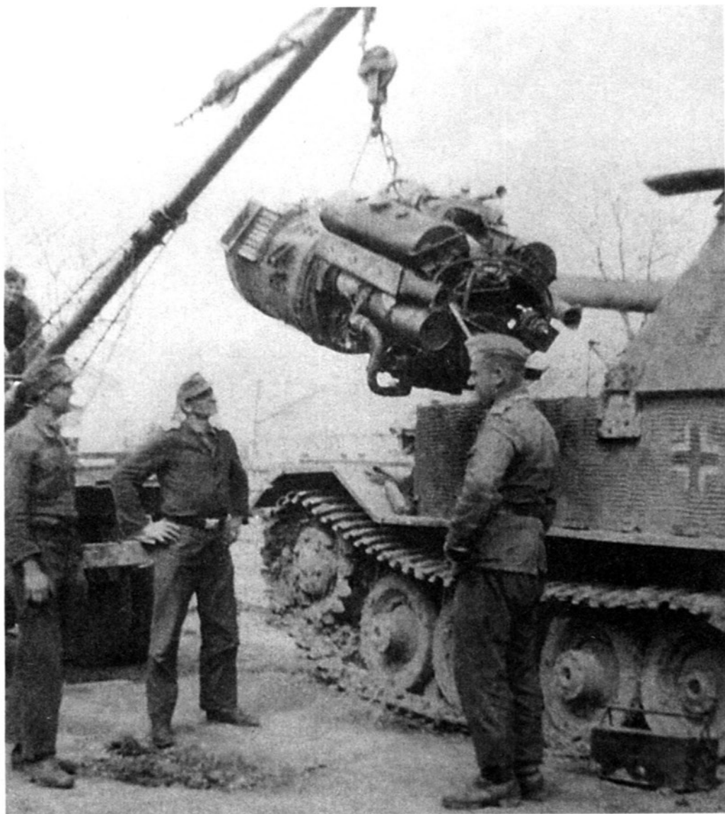
Ремонтники демонтируют неисправный двигатель «Майбах» с генератором. Апрель 1944 года, район Тернополя (ИП).
