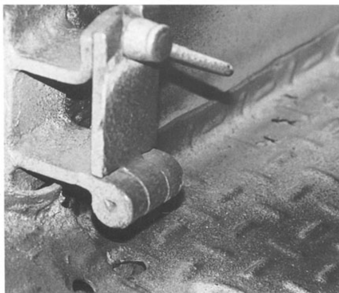
„Ferdinand“. Przedni zaczep służący do mocowania liny holowniczej i błotnik. Front catch for towing rope and details of the mudguard. [ASKM]
