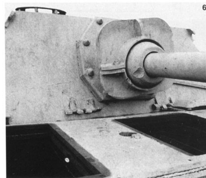
„Elefant“. 4 – przednie kadłubowe stanowisko karabinu maszynowego MG 34, 5 – wentylator i wieżyczka obserwacyjna dowódcy, 6 – jarzmo armaty. 4 – hull MG 34 machine gun station, 5 – ventilator and commander's observation coupola, 6 – gun yoke. [ASKM]
