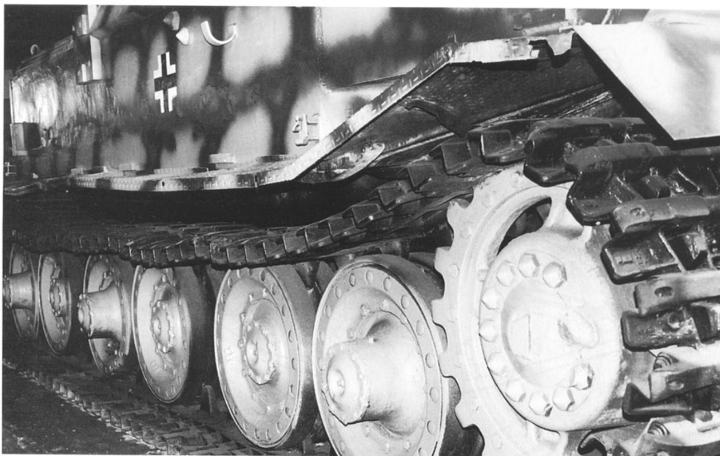
Działo samobieżne Jagdpanzer „Tiger“ (P) „Ferdinand“ w muzeum w Kubince – widok koła napinającego i kół jezdnych. A Jagdpanzer “Tiger” (P) “Ferdinand” SP gun preserved in Kubinka, Russia. Idler wheel and road wheels. [ASKM]
