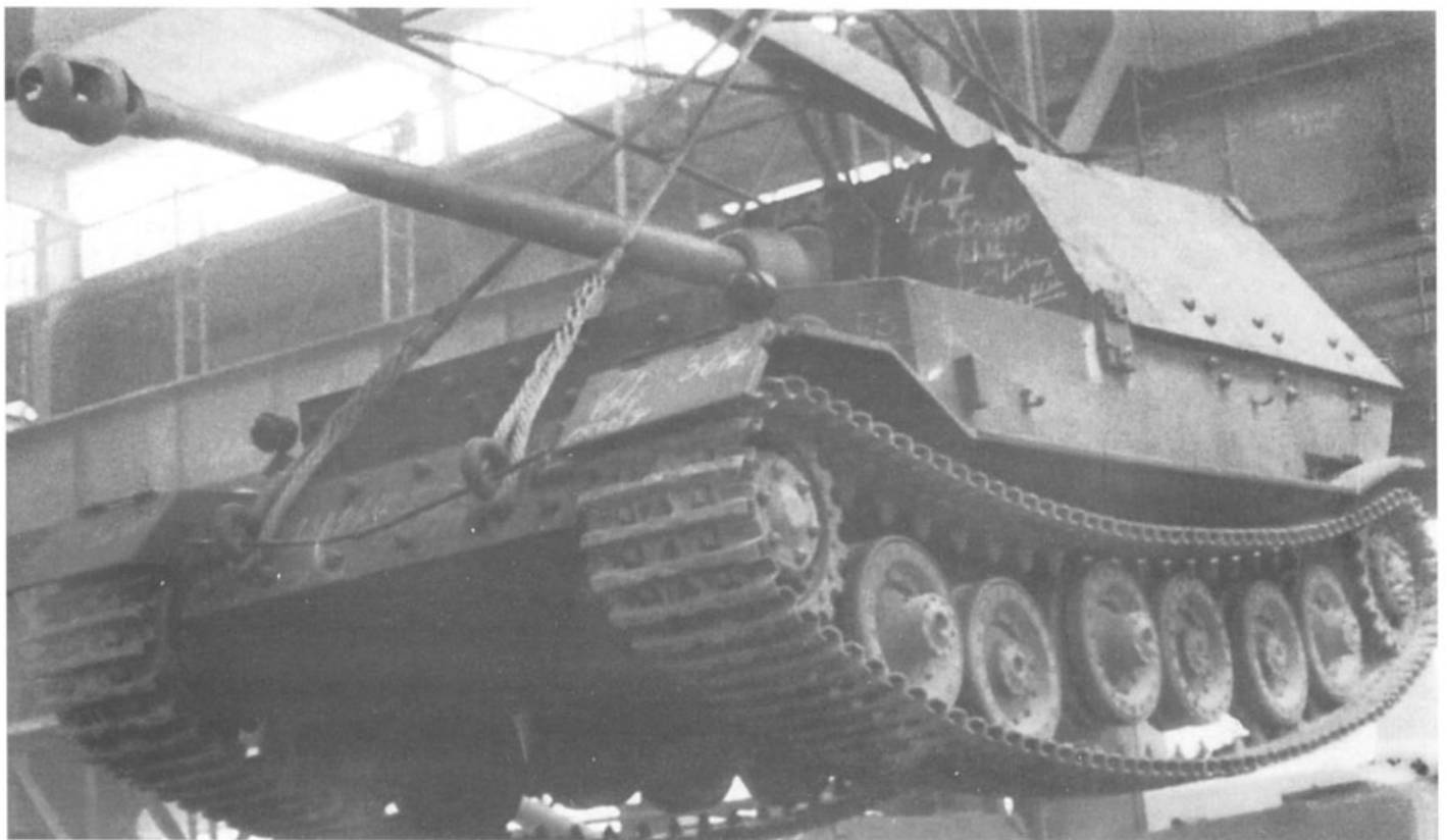
Działa samobieżne Jagdpanzer „Tiger“ (P) „Ferdinand“ w czasie produkcji w Nibelungenwerk w St. Valentin w 1943 roku. U góry montaż gąsienic i opancerzenia przedziału silnikowego, powyżej transport pojazdu na suwnicy. Top. A final assembly of the tracks and engine compartment armour of the “Tiger”(P) “Ferdinand” SP gun, Nibelungenwerk in St. Valentin. Above. Transport of vehicle on the crane. [ASKM]
