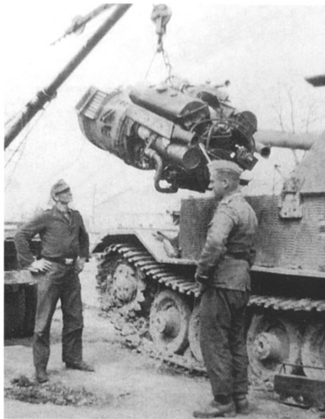
Montowanie nowego zespołu napędowego: generatora i silnika Maybach HL 120 TRM . Installing a new power plant generator and Maybach HL 120 TRM engine. [ASKM]
