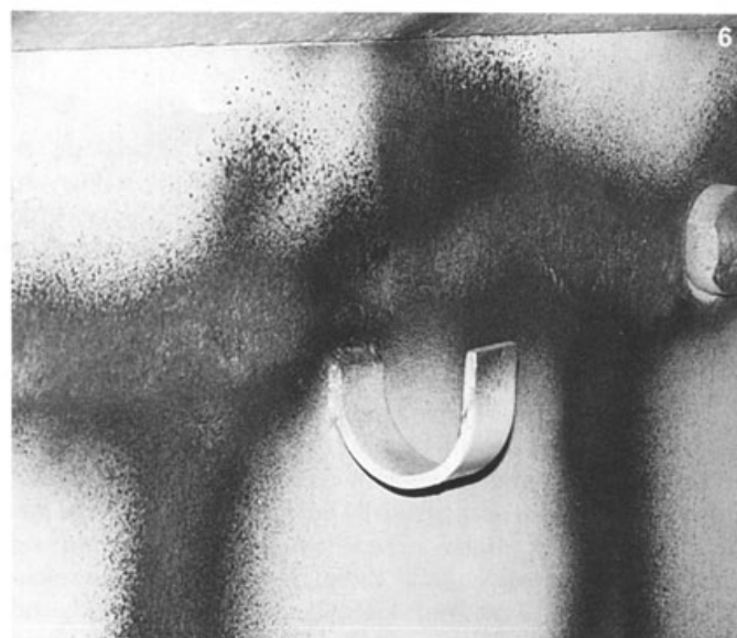
„Ferdinand“ 4 – przedni hak holowniczy i śruby mocowania pancerza, 5 – tylne śrubowe połączenie kadłuba i nadbudowy, 6 – zaczep kadłubowy mocowania liny holowniczej. 4 – front towing hook and armour screw mount, 5 – rear screw joint of hull and superstructure, 6 – rear hulls towing rope hook. [ASKM]
