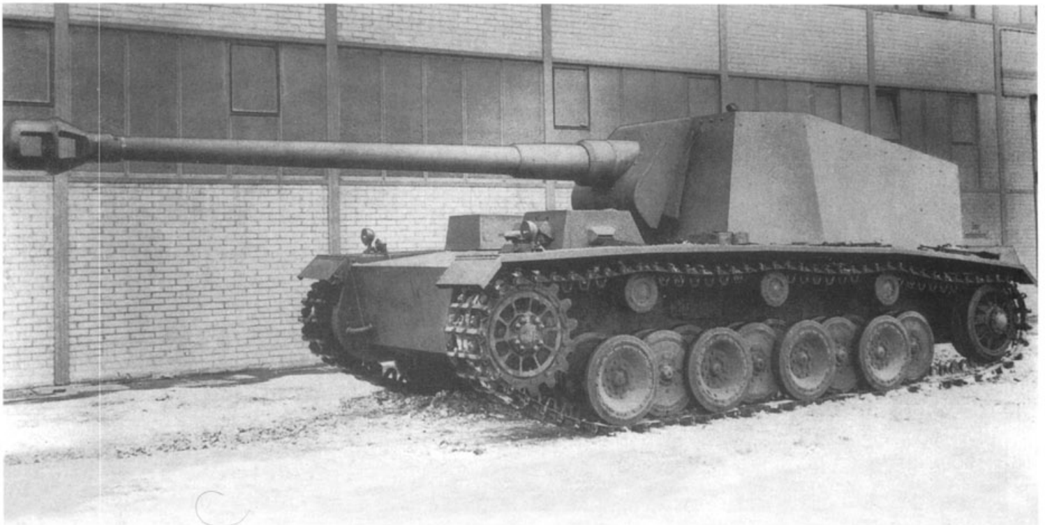
Działo samobieżne 12,8 cm L/61 Sfl VK 3001 (H) – PzFgst V, pojazd w fabryce Henschla przed przekazaniem do jednostki bojowej, 1942 rok. Widoczne przedłużone podwozie pojazdu między kołami jezdnyymi a kołem napinającym. An 12.8 cm L/61 Sfl VK 3001 (H) – PzFgst V SP gun seen in the Henschel factory prior acceptance in 1942. Note lightened chassis of the vehicle. [Ground Power]
