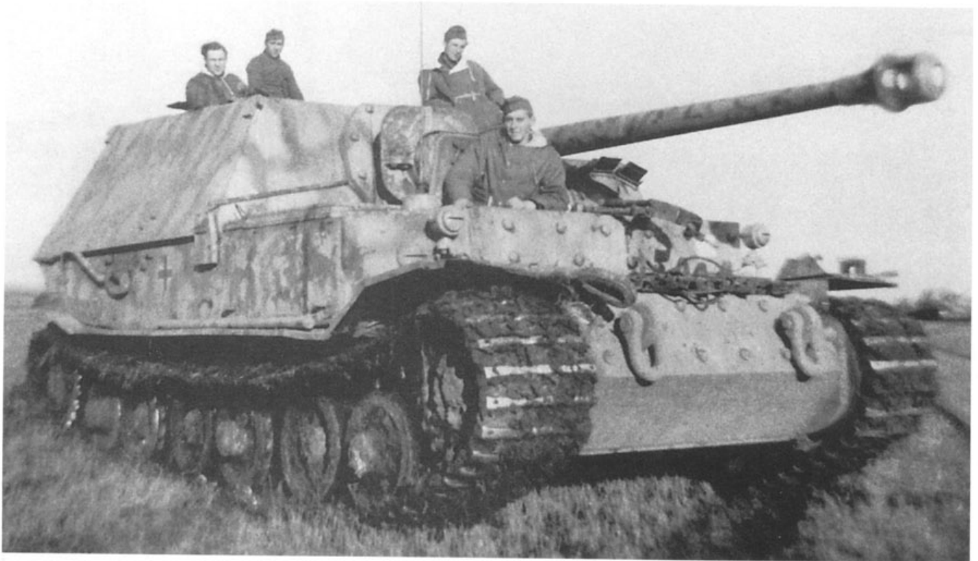
„Ferdinand“ z 3. kompanii 653. schwere Panzerjäger Abteilung na froncie pod Nikopolem w listopadzie 1943 roku. Pojazd posiada rynienki do odprowadzenia wody deszczowej na płycie czołowej nadbudowy. A “Ferdinand” SP gun of the 3rd Company 653rd schwere Panzerjäger Abteilung in Nikopol area in November 1943. Note vehicle fitted with rain gutters on the forward superstructure side. [ASKM]
