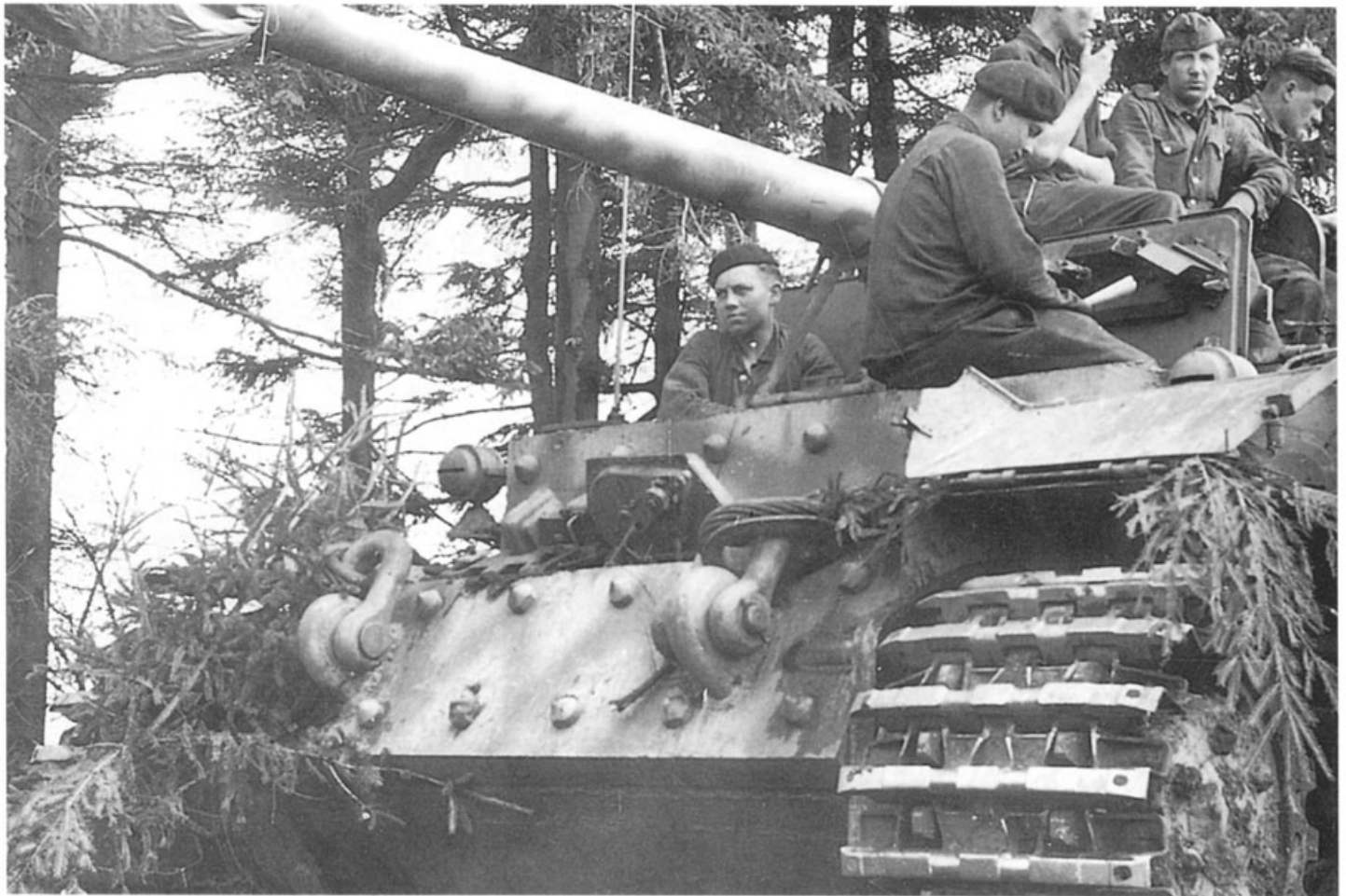
„ Ferdinad ” wczesnej serii produkcyjnej, bez dodatkowej osłony jarzma armaty z 654. schwere Panzerjäger Abteilung , lato 1943 roku. An early production “ Ferdinand ” SP gun without additional gun yoke cover of the 654th schwere Panzerjäger Abteilung , Summer 1943. [RGAKFD]
