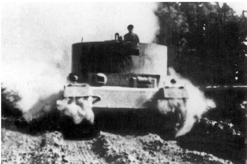
◀ Próby terenowe prototypu czołgu VK4501(P) Tiger. Masę brakującej na razie wieży Kruppa zastępuje symulująca ją betonowa nadbudowa z dwiema szczelinami obserwacyjnymi z przodu / via Hideya Ando
