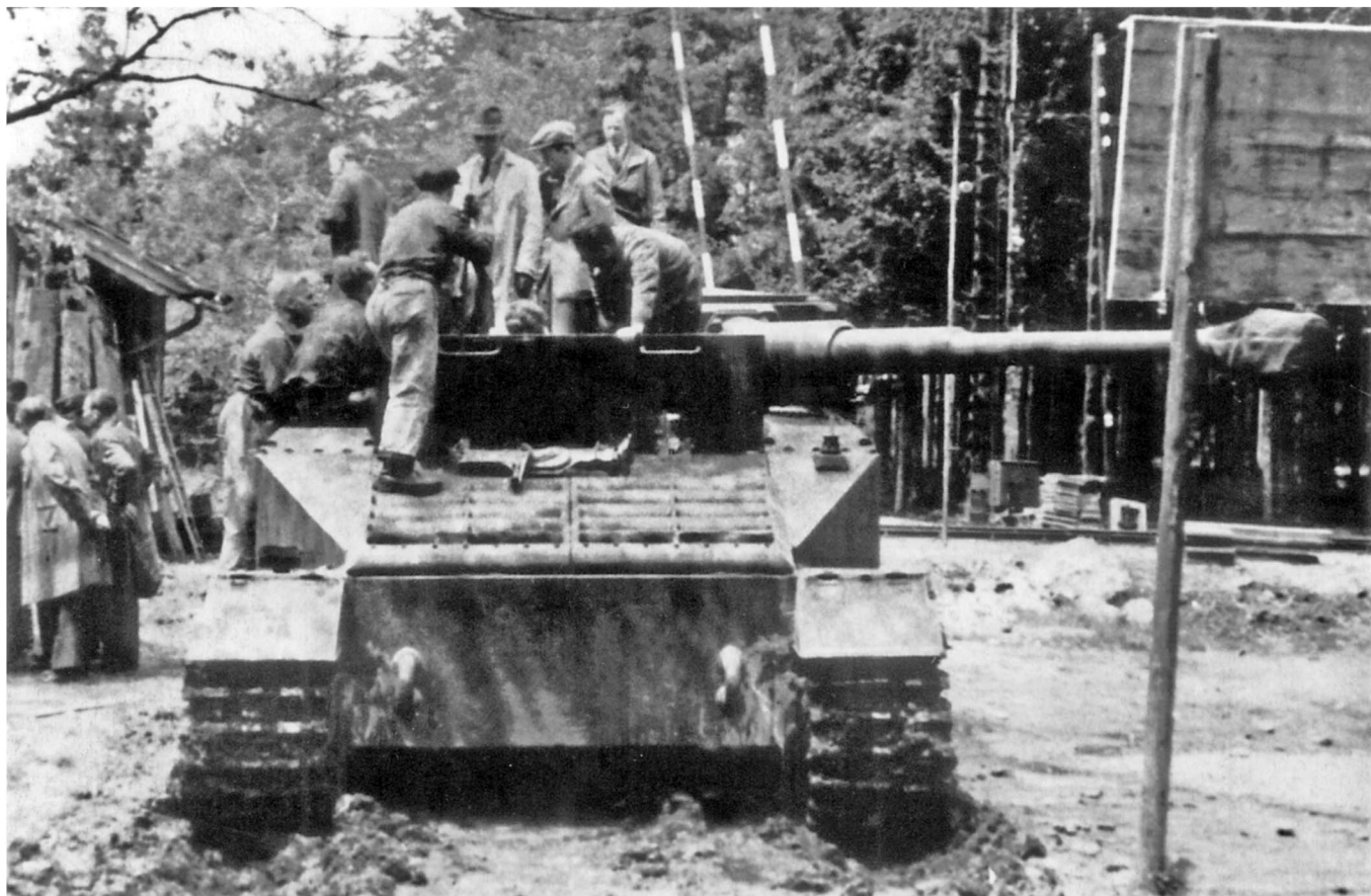
▲ Prototyp czołgu VK4501(P) Tiger , który w zakładach Nibelungenwerke nosił też oznaczenia Typ 101 i Sonderfahrzeug II, widziany od tyłu. Zwracają uwagę wielkie żaluzje wlotów powietrza na pokrywie przedziału silników spalinowych / via Hideya Ando
