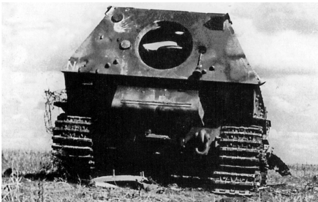
◀ Ferdinand z 3. kompanii II/656 (654) batalionu (symbol taktyczny N3 w dolnym lewym rogu nadbudówki przedziału bojowego) wypalony po wewnętrznej eksplozji, która wyrzuciła tylny właz. Wewnątrz widać wyrwane pokrywy szczeliny peryskopu celowniczego, a po prawej stronie przedziału siła wybuchu wyrwała oba „grzybki” zamykające strzelnice na boku i tyle nadbudówki / RGAKFD
