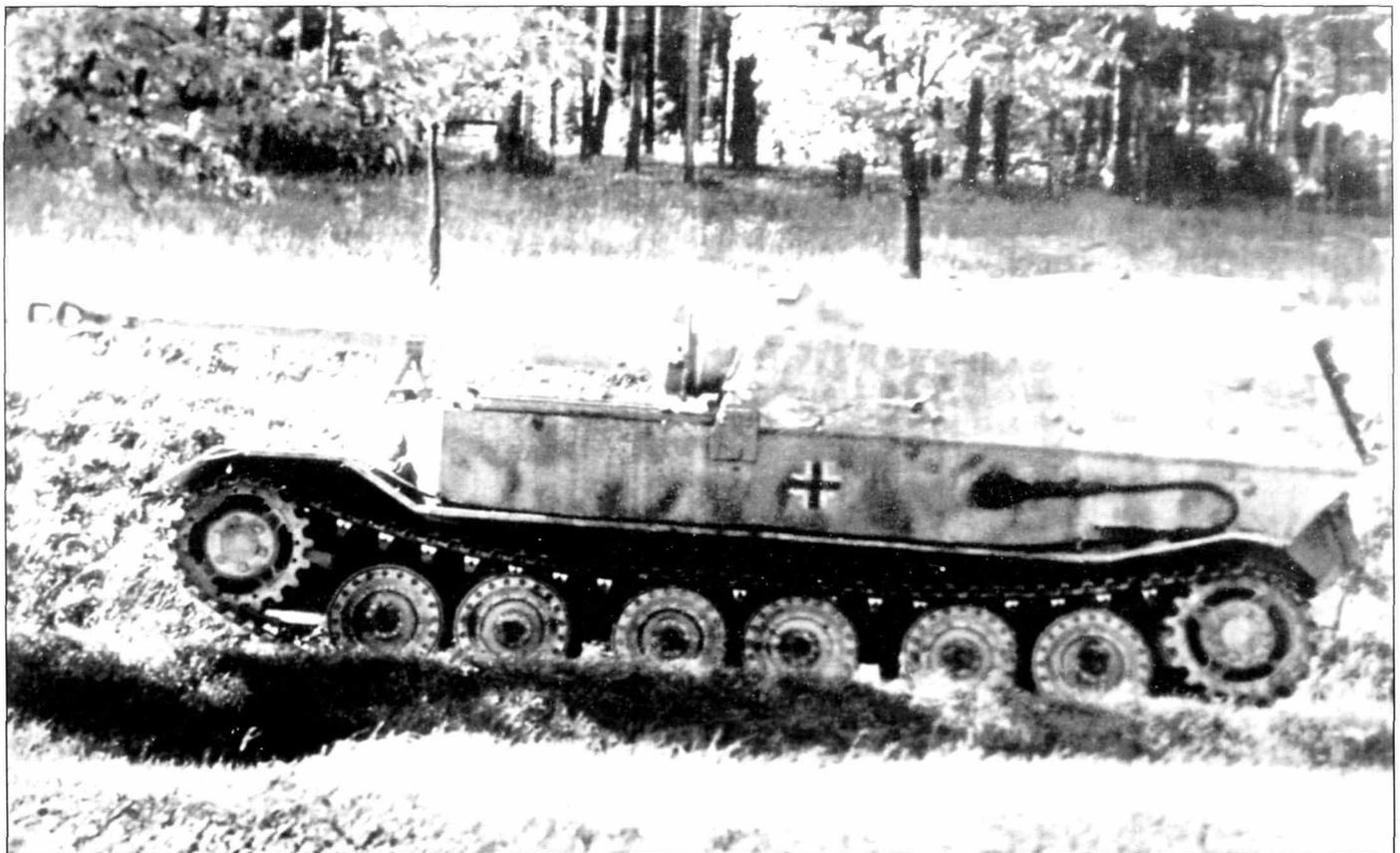
*«Фердинанд» из 653-го батальона частично модернизированный в Никополе в конце 1943 г. Машина покрыта циммеритом, щиток маски развернут ребрами жесткости наружу, запасные траки перенесены на корму рубки, но командирская башенка не установлена. Модернизация в Никополе предшествовала более серьезным доработкам, проведенным Нибелунгенверке в начале 1944 г.*
