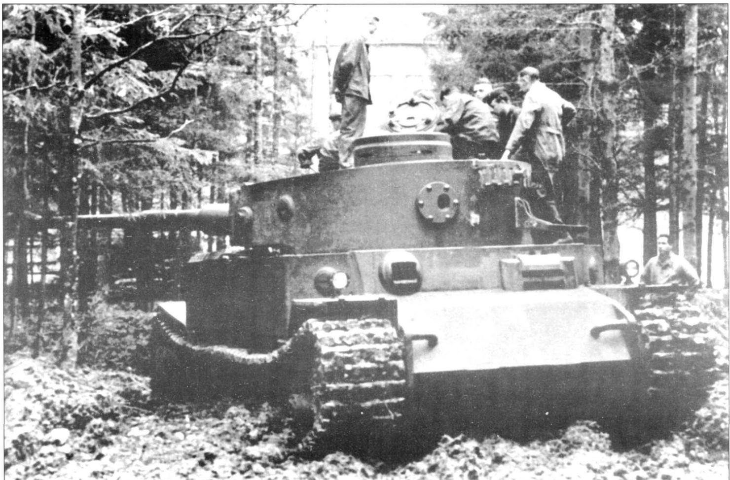
*Вид спереди прототипа танка VK4501 (P) «Тигр». Обратите на конфигурацию лобовой части корпуса и шаровую пулеметную установку, а также на стандартный для танков «Тигр» смотровой блок.*
