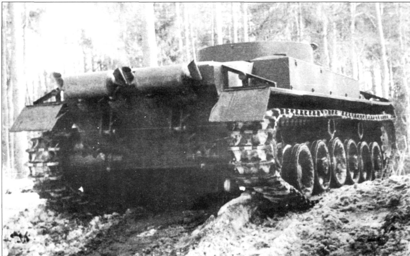
*Вид сзади прототипа танка VK3001 (P) с имитатором башни, равным по массе башне танка Pz.Kpfw. IV. Решение вооружить танк 88-мм пушкой поставило крест на проекте, из-за недостаточных для установки столь мощной пушки геометрических размеров «Леопарда».*
