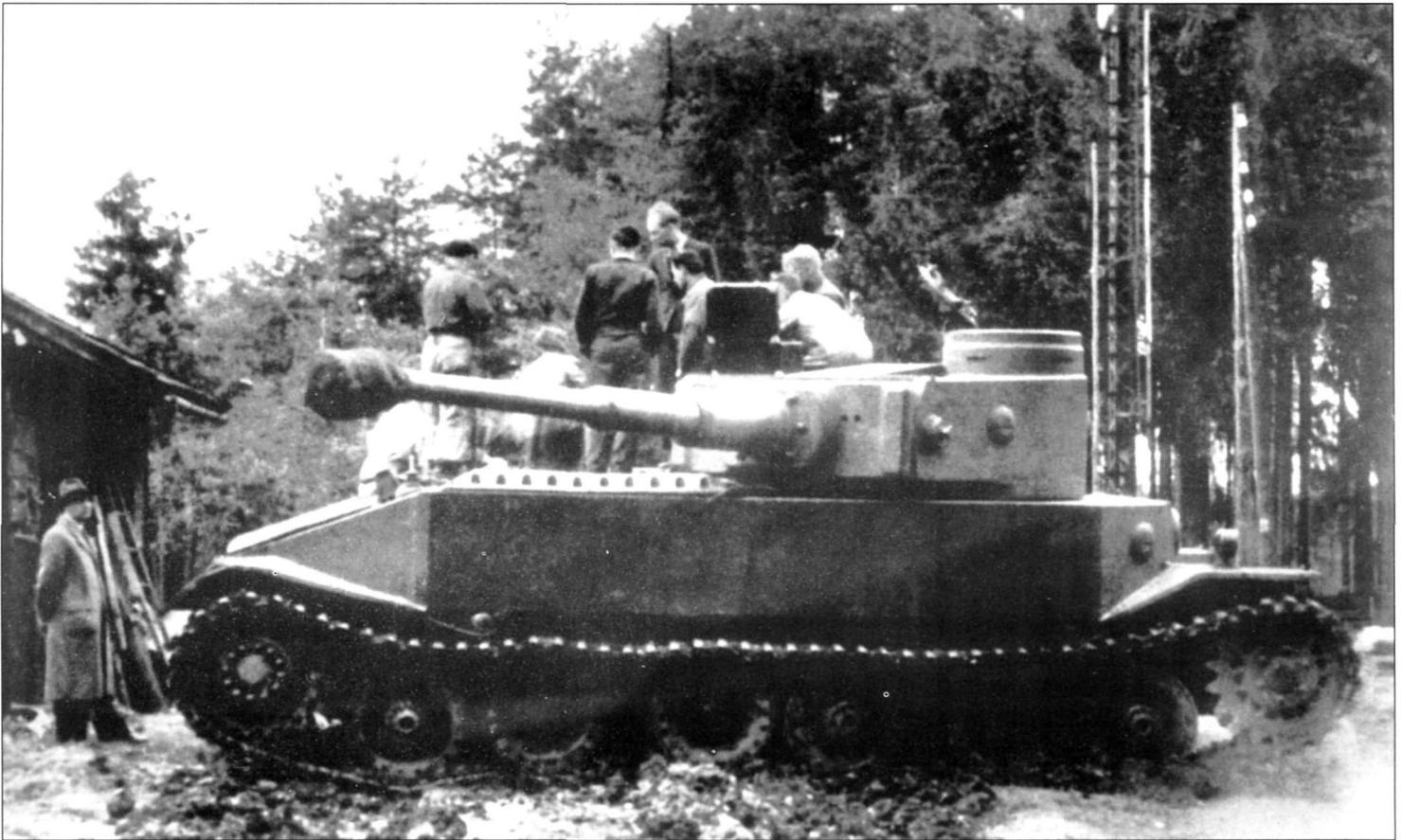
*Вид справа прототипа танка VK4501 (P) «Тигр». Форма корпуса на самоходках «Фердинанд» не сильно изменилась. Хорошо видна детализовка ранней башни фирмы Круп под 88-мм пушку с длиной ствола 56 калибров.*
