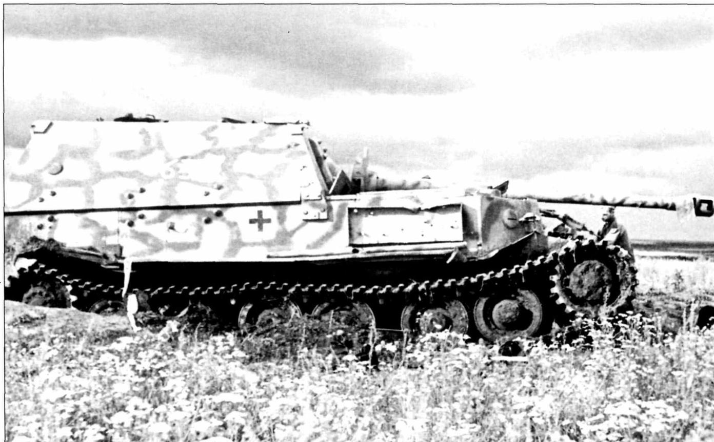
*«Фердинанд» с бортовым номером «634», из 4-го взвода 2-й роты 654-го батальона. Машина лишилась хода после подрыва на mine. Крышка инструментального ящика сорвана. В конечном итоге инструментальный ящик перенесли в корму корпуса. Снимок отлично передает характерный для самоходок батальона Ноака рисунок камуфляжа и бортовой номер белого цвета.*
