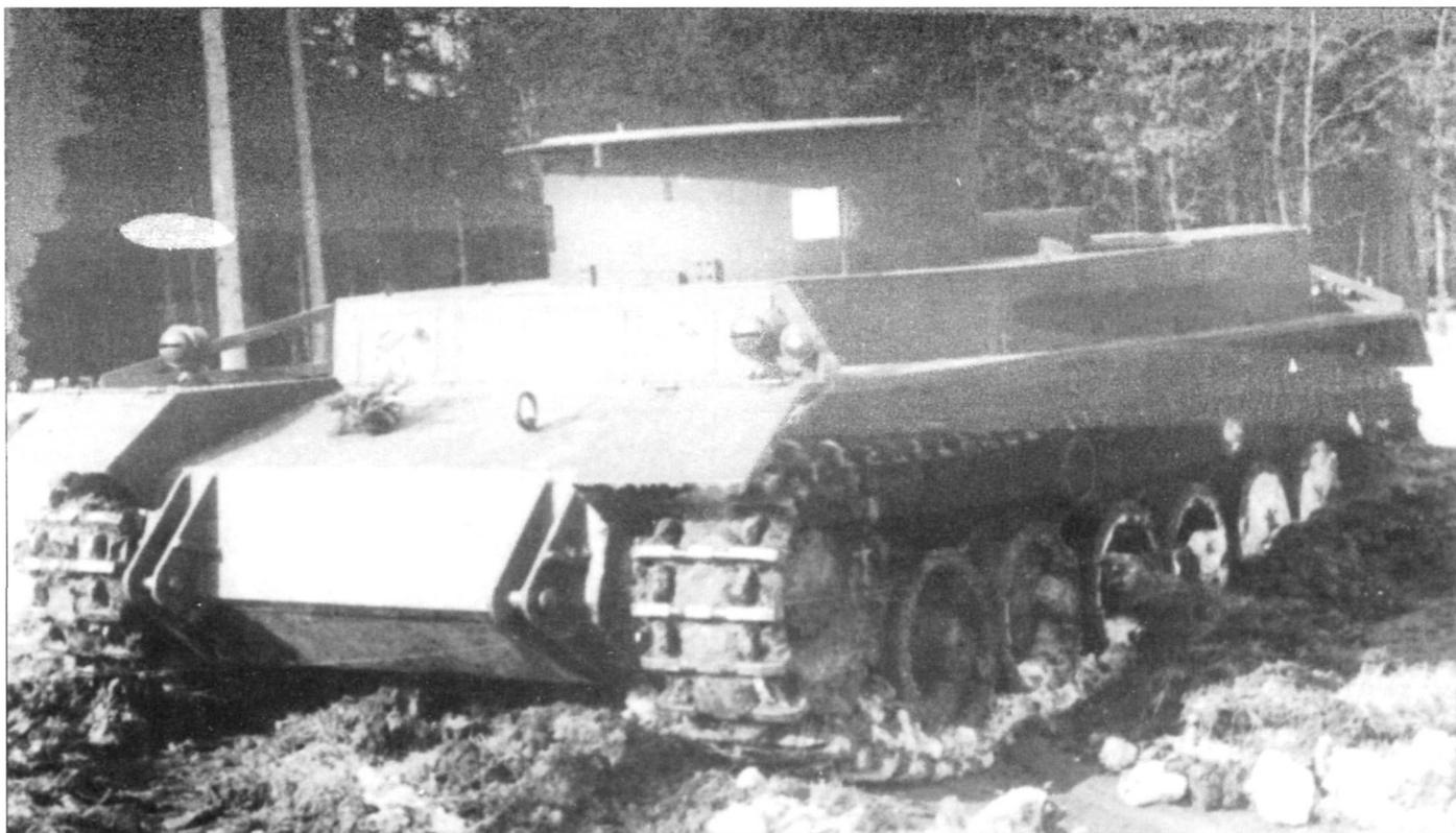
*Прототип танка VK3001 (P) «Леопард» на полевых испытаниях. Революционную конструкцию профессора Порше воплотила в металл фирма Нибелунгенверке.*
