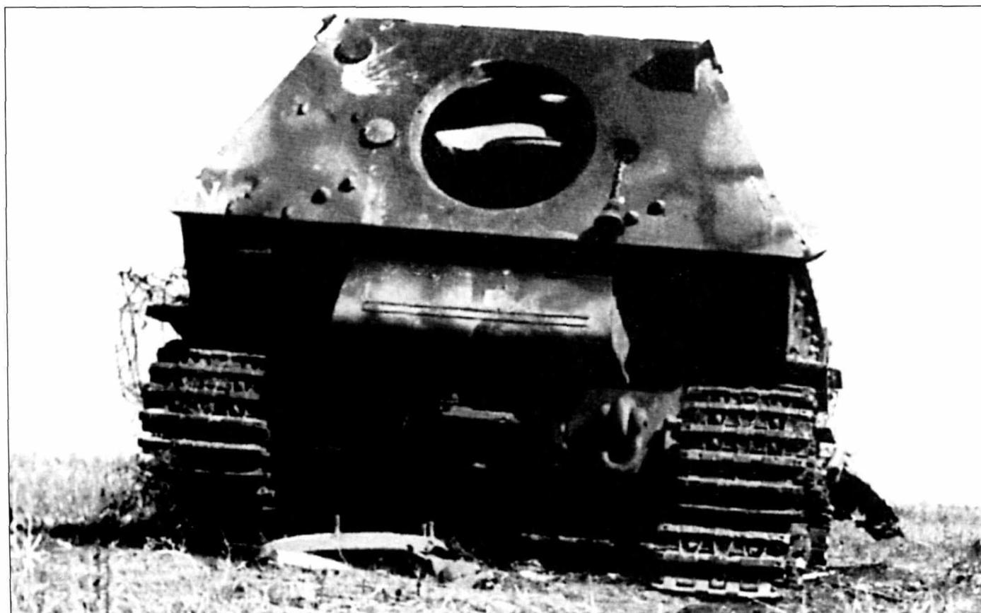
*Сожженный и взорванный «Фердинанд» из 3-й роты 654-го батальона (в левом углу рубки написано N 3). Внутренним взрывом вырвало кормовой рубочный люк и заглушки пушечных амбразур в правой части комового бронелиста, провало крышу рубки.*
