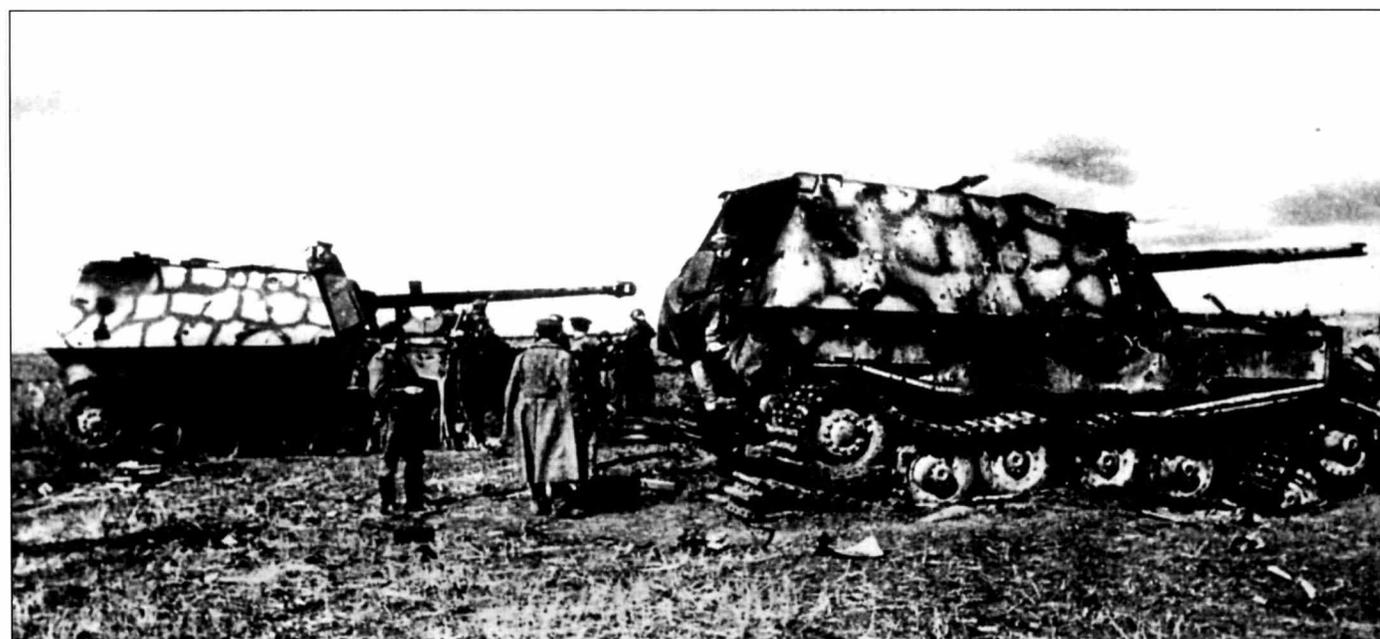
Сожженные и подорванные «Фердинанды» - машины с бортовыми номерами «723» и «702» (ближайший к камере - Fgst.Nr. 150 057). Обе машины покрашены в типичный для 654-го батальона камуфляж. Ближайший к камере самоход («792») лишился дульного тормоза. Обе машины не имеют щитков масок - возможно щитки сорваны взрывами.
