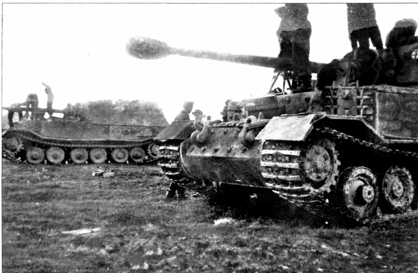
Два «Элефанта» из 653-го батальона, Рабка, Южная Польша, осень 1944 г. Хорошо видна новая эмблема батальона. В круге отсутствует номер, значит самоходка принадлежит штабу батальона. В центральной части лобового листа корпуса установлена дополнительная бронеплита, на которой белой краской написан заводской номер шасси. Из-за низкого качества фотоснимка прочесть номер не удалось.
