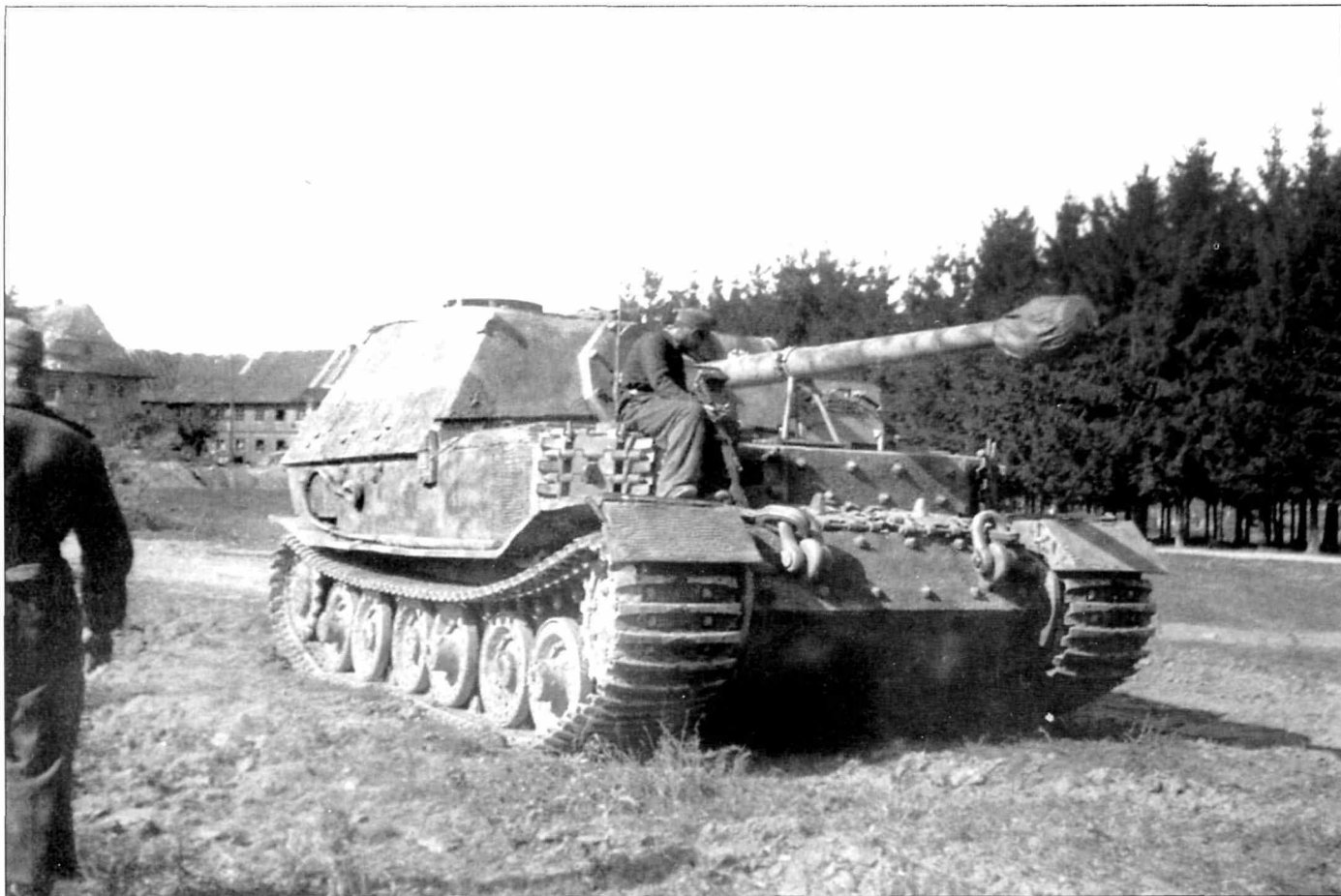
«Элефант» из 653-го батальона тяжелых истребителей танков, осень 1944 г., Рабка, южная Польша. Защита лобовой части корпуса усилена траками. Циммерит нанесен даже на брызговики. Дульный тормоз закрыт брезентовым чехлом.
