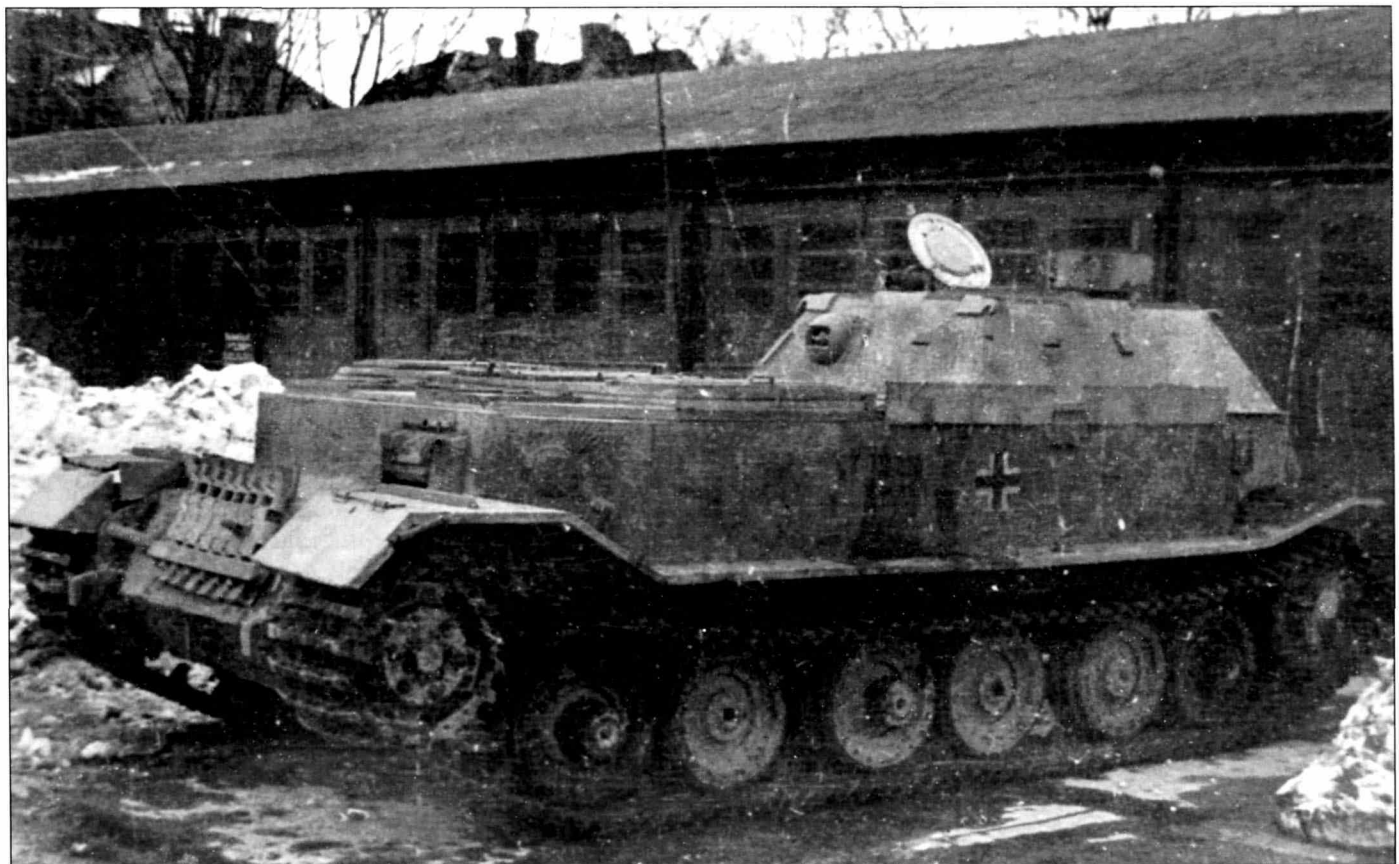
Ремонтно-эвакуационный «Элефант» сфотографирован в конце марта 1944 г. Машина покрыта циммеритом. На крыше рубки смонтирована дистанционно управляемая пулеметная установка с MG 34. Таки установки использовались на поздних самоходках StuG III и Hetzer.
