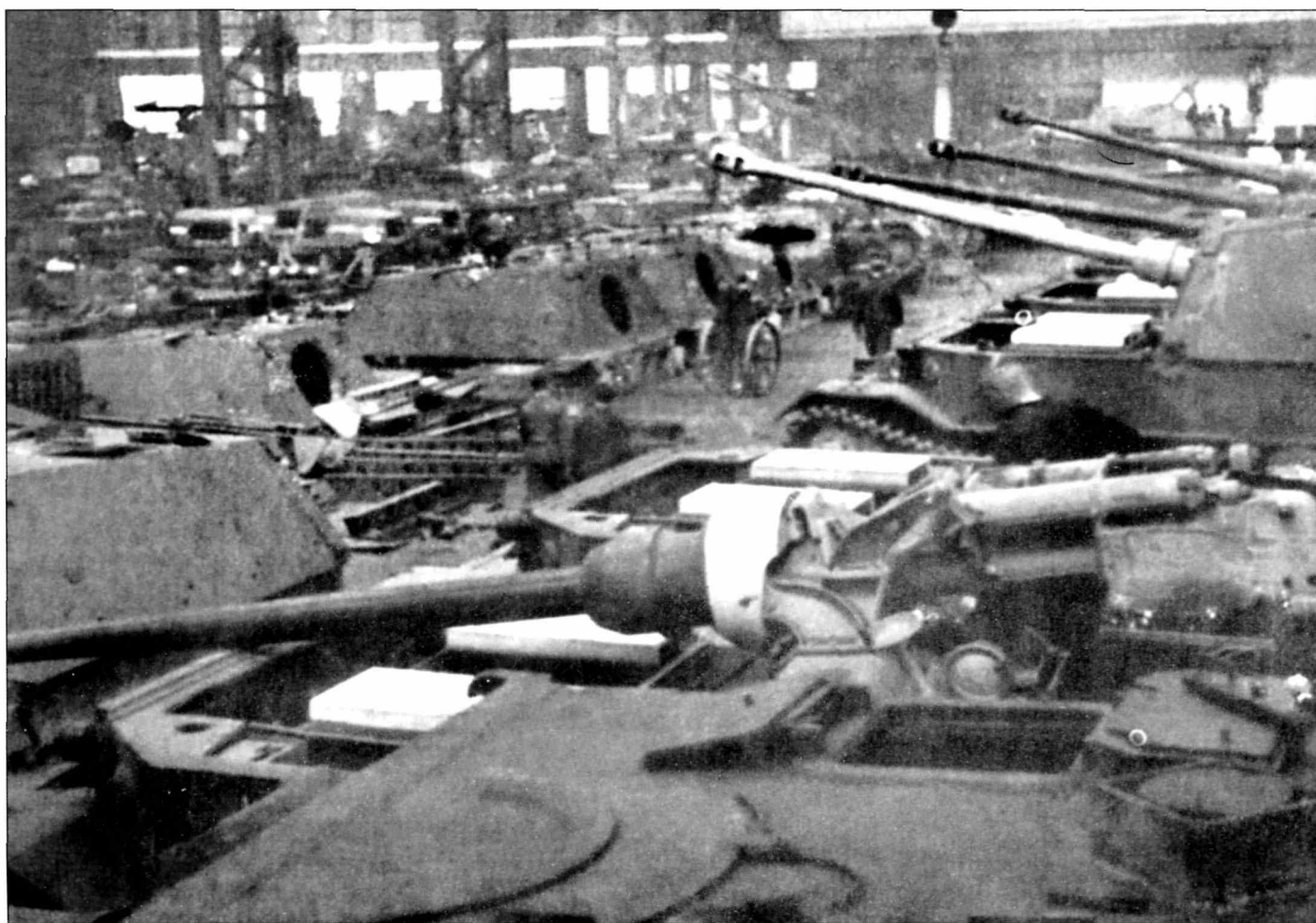
Сборочная линия тяжелых истребителей танков «Фердинанд». На переднем плане хорошо видна противотанковая пушка Pak-43/2.
