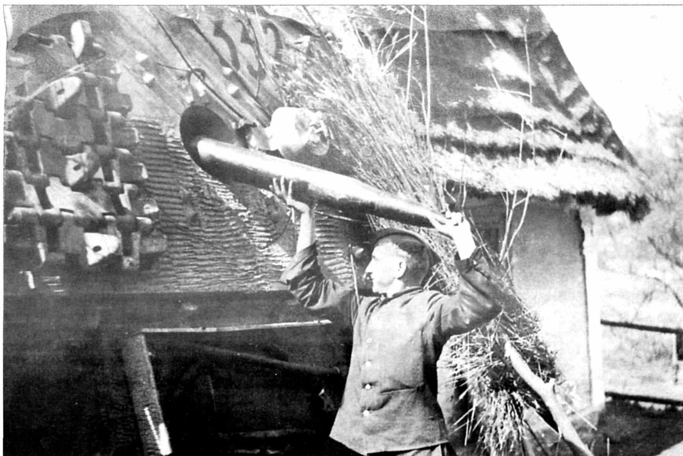
«Элефант» с бортовым номером «332» из 4-го взвода 2-й роты. Погрузка боекомплекта. Снимок хорошо передает размеры снаряда Pz.Gr.-39/43 к пушке Pak-43/2. Циммерит нанесен на стенки инструментального ящика, закрепленного на корме корпуса ниже обреза рубки.
