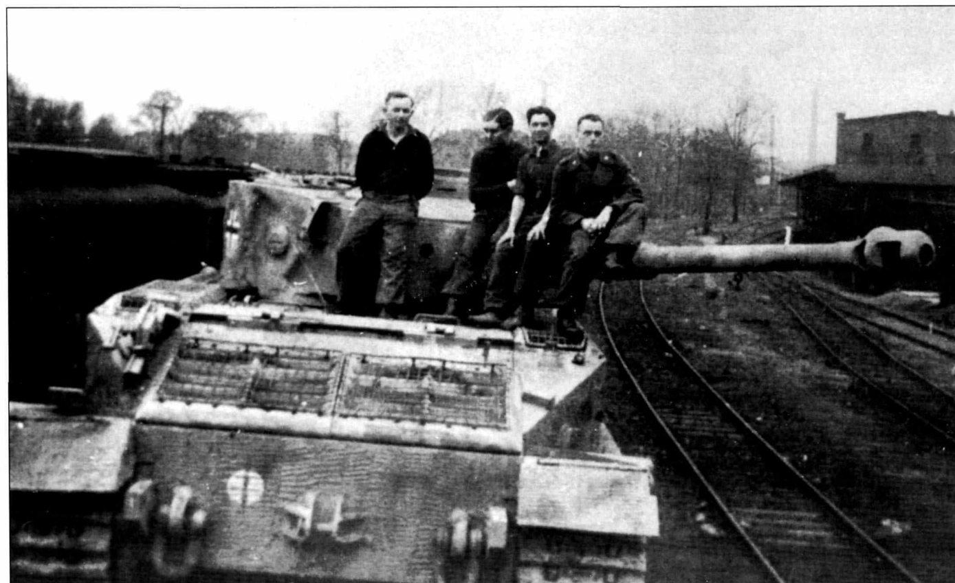
Два снимка командирского «Тигра» Порше. Танк покрыт циммеритом. Хорошо видна эмблема батальона. Вентиляционные жалюзи закрыты проволочной сеткой.
