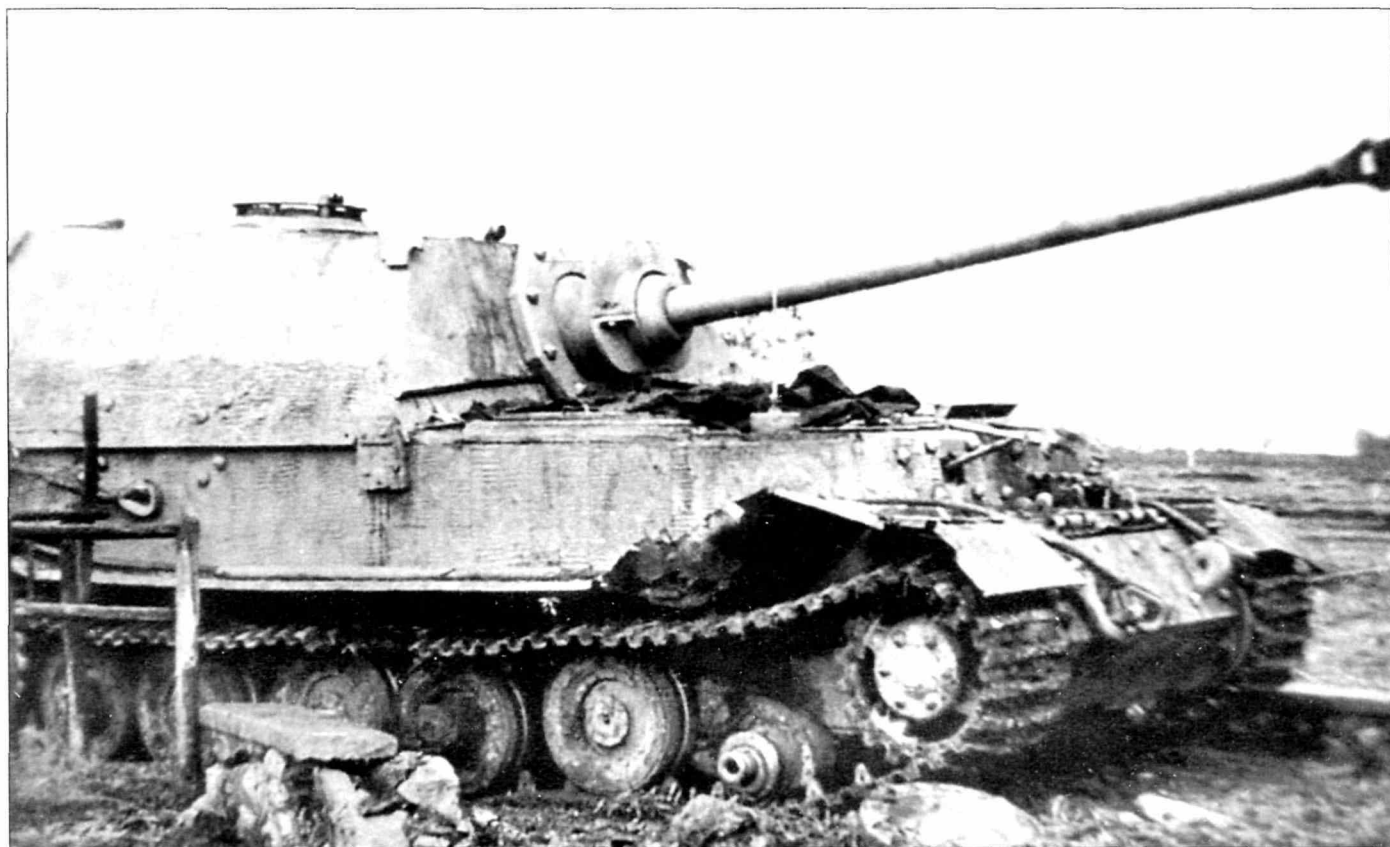
«Элефант» обер-фельдфебеля Коса подорвался на mine 29 февраля 1944 г. в ходе атаки плацдарма американцев под Анцио. На снимке хорошо видны повреждения, причиненные взрывом мины: оторван первый опорный каток, деформировано крыло. Отбуксировать поврежденную машину не удалось. Ночью немцы подорвали самоходку.
