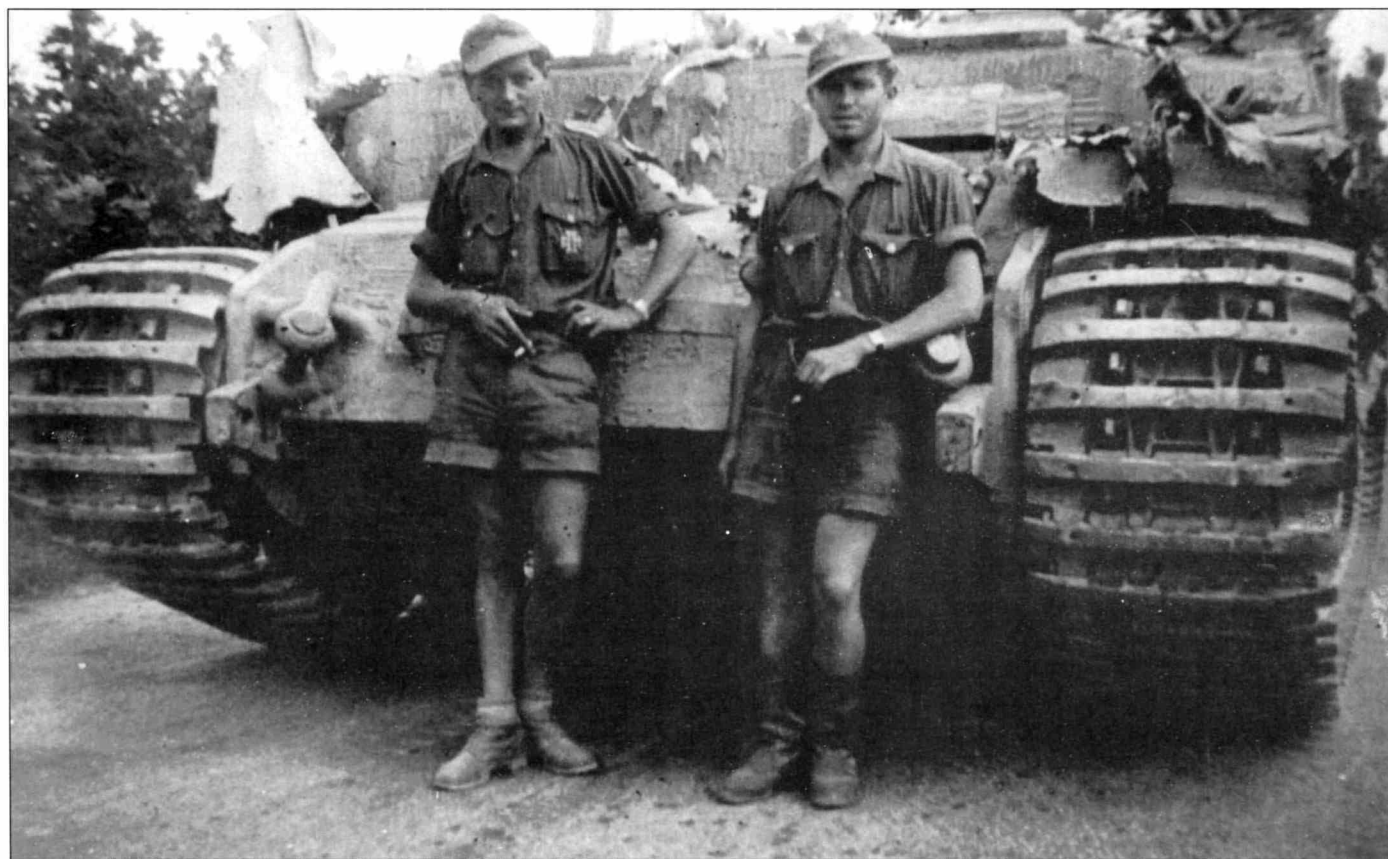
Ремонтно-эвакуационные «Элефанты» больше нравились своим экипажам, чем сами самоходки. БРЭМ были легче, поэтому более подвижны и реже ломались. На фото хорошо видны широченные гусеницы машины. Слева стоит командир танка - унтерофицер Эдгар Шелер, кавалер Железного креста 1-го класса. В 653-м батальоне «Берге-Фердинанд» использовался не только для эвакуации подбитых танков, но и для подвоза боеприпасов и вывоза раненых.
