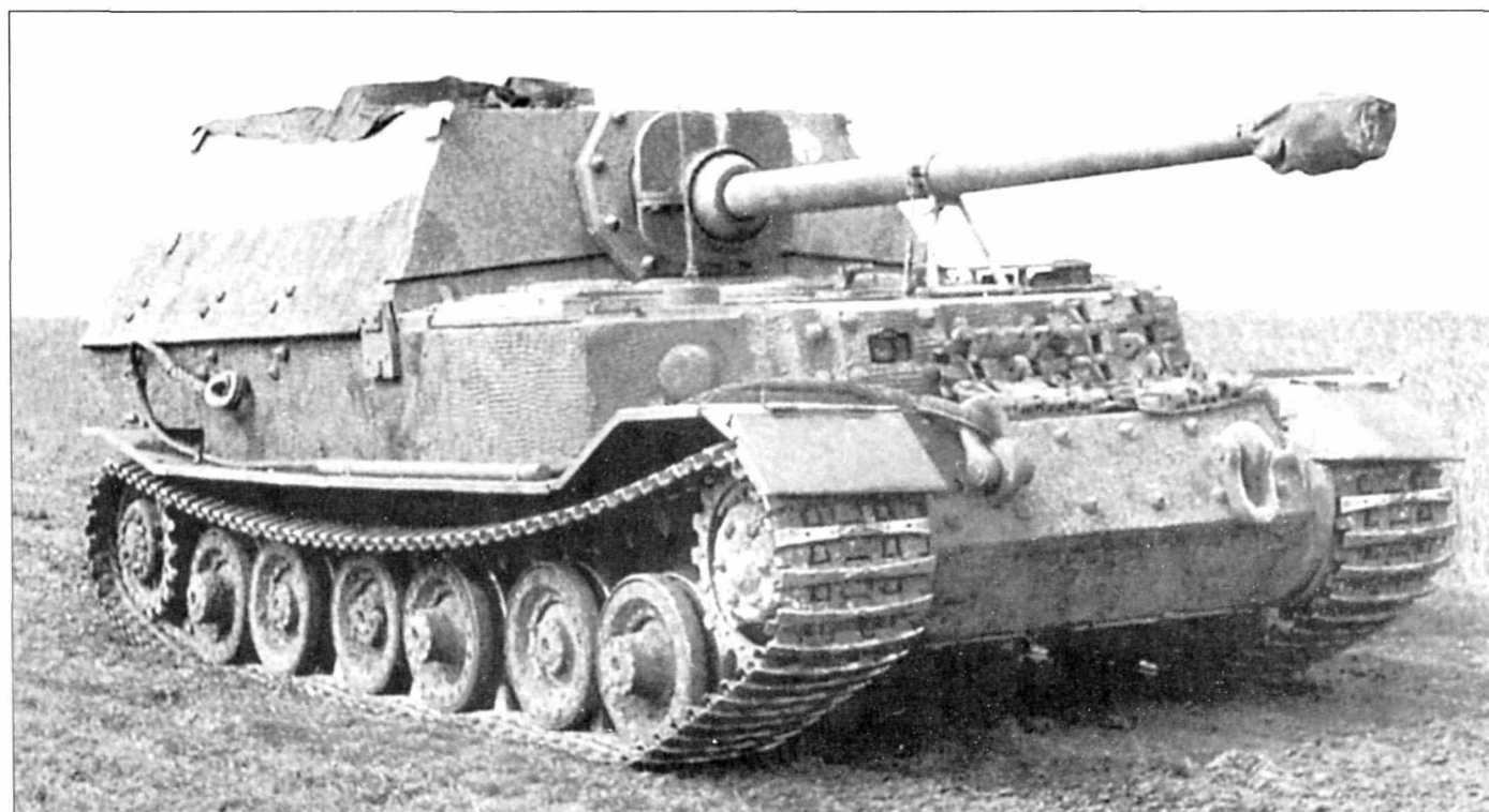
Модернизированный «Элефант» из 3-й роты 653-го батальона тяжелых истребителей танков. На рубке левее оружейной маски нарисована новая эмблема в виде круга с мечом Нибелунгов. Рубка покрыта цинкером наполовину высоты.
