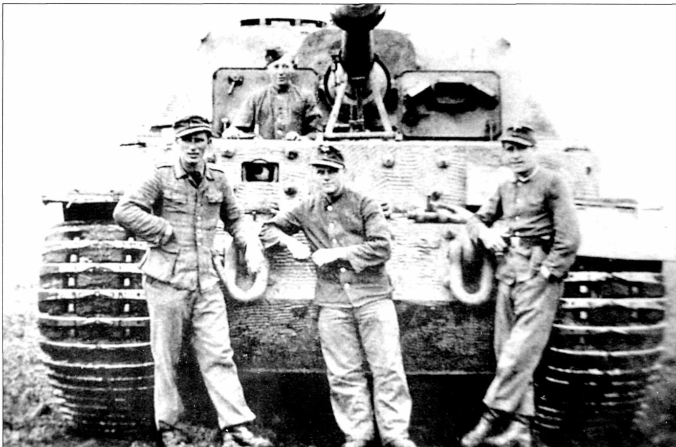
Экипаж «Элефанта» 3-й роты 653-го батальона, Польша, конец 1944 г. Просматривается командирская башенка на крыше рубки – еще одна отличительная черта «Элефанта». На «Элефантах» ставились гусеницы, набранные из траков Kgs-64/640/130 шириной 64 см. В верхнем углу рубки над открытой крышкой люка механика-водителя видна новая эмблема в виде круга с мечом Нибелунгов. Из своего люка высовывается стрелок-радист Гельмут Крейнхаген.
