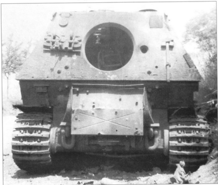
Подорванный «Элефант», вид сзади. Хорошо видно крепление запасных трактов и кувалды. Крышка ящика ЗИП откинута вниз, эвакуационный люк сорван взрывом.
