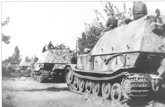
«Фердинанд» на марше. На кормовом листе рубки закреплена канистра с водой (белый крест обозначает, что канистра заполнена водой, а не бензином). На этой машине отсутствует крепление кувалды на левом борту корпуса.
