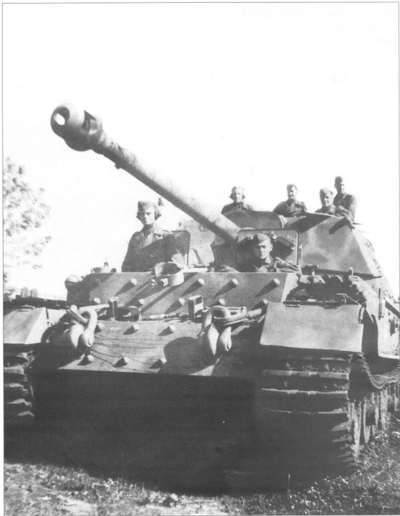
САУ «Фердинанд» выдвигается к линии фронта. Лето 1943 года. Домкрат на верхнем лобовом листе корпуса отсутствует, хотя крепление для него есть.
