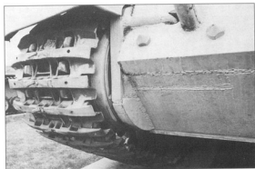
Стык передних и бортовых листов корпуса.
