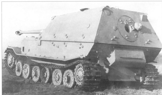
Боевая подготовка «фердинандов» перед отправкой на фронт, июнь 1943 года. На верхнем фото хорошо видна укладка инструмента в ящике ЗИП на правом борту машины, а на нижнем фото — открытый лючек для загрузки боеприпасов.
