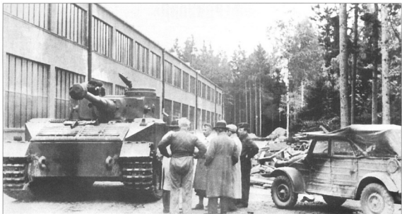
Танк «Тигр Порше» (VK 4501 (P)) во дворе завода перед прохождением испытаний. Апрель 1942 года. Машина оснащена башней конструкции фирмы «Порше».
