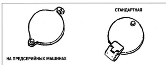
Лючек горловины для заливки воды в радиатор.
