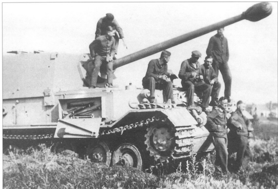
Боевая подготовка «фердинандов» перед отправкой на фронт, июнь 1943 года. На верхнем фото хорошо видна укладка инструмента в ящике ЗИП на правом борту машины, а на нижнем фото — открытый лючек для загрузки боеприпасов.
