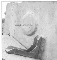
Заваренный смотровой прибор механика-водителя и дополнительное крепление крыла.
