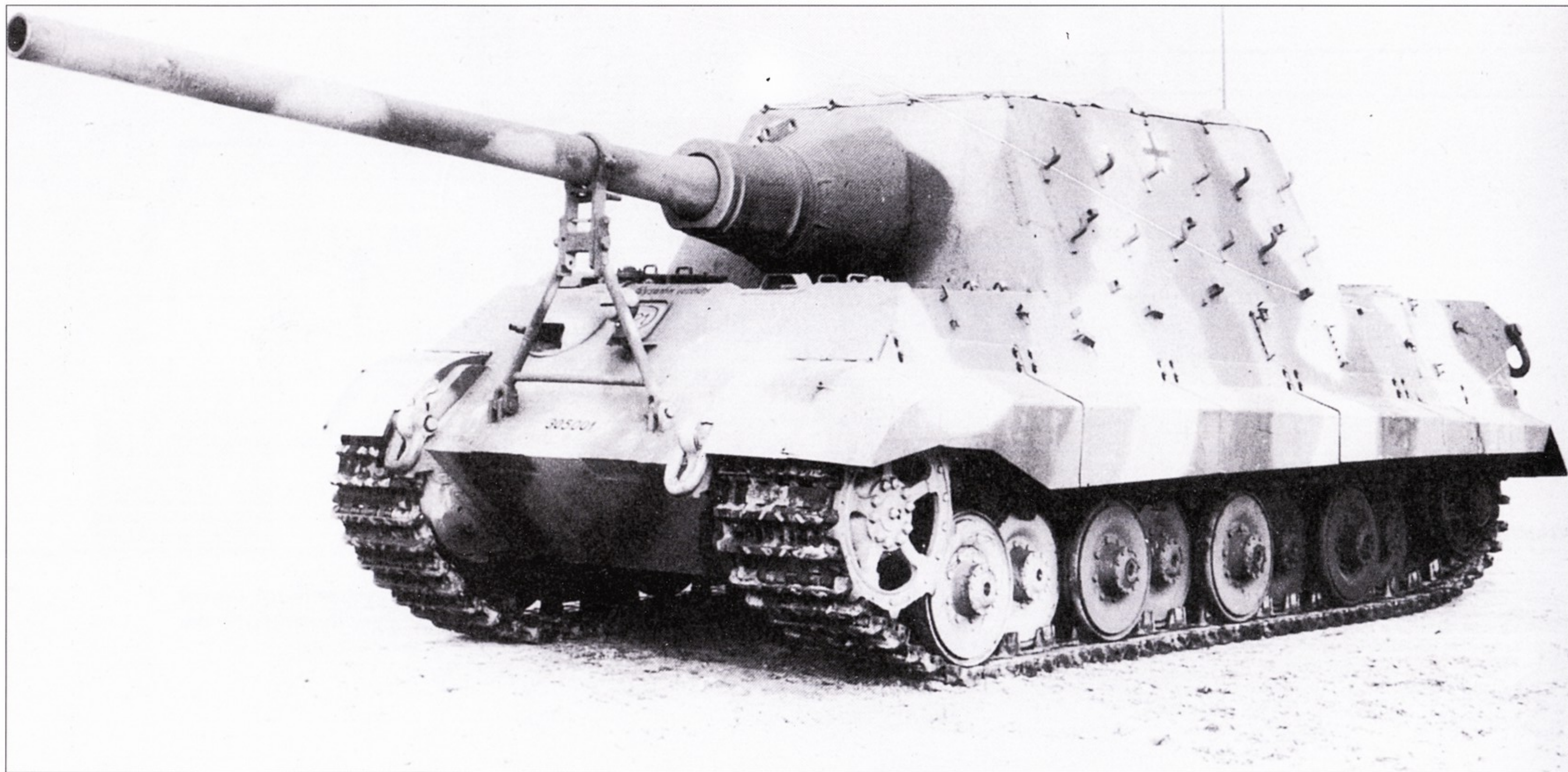
Самоходный истребитель танков 12,8 см Pak 44 auf Panzerjaeger «Tiger» SdKfz 186 «Jagdtiger», машина на шасси типа Porsche (Fgst 305001) после выполненной в декабре 1944 г. модернизации. Единственная сфотографированная самоходка на шасси Порше с 9-зубцовыми ведущими колесами. Самоходка окрашена в камуфляжную окраску, обута в транспортные гусеницы - машину готовят к отправке на фронт. Обратите внимание, что циммерит отсутствует. Ствол зафиксирован в транспортном положении.
