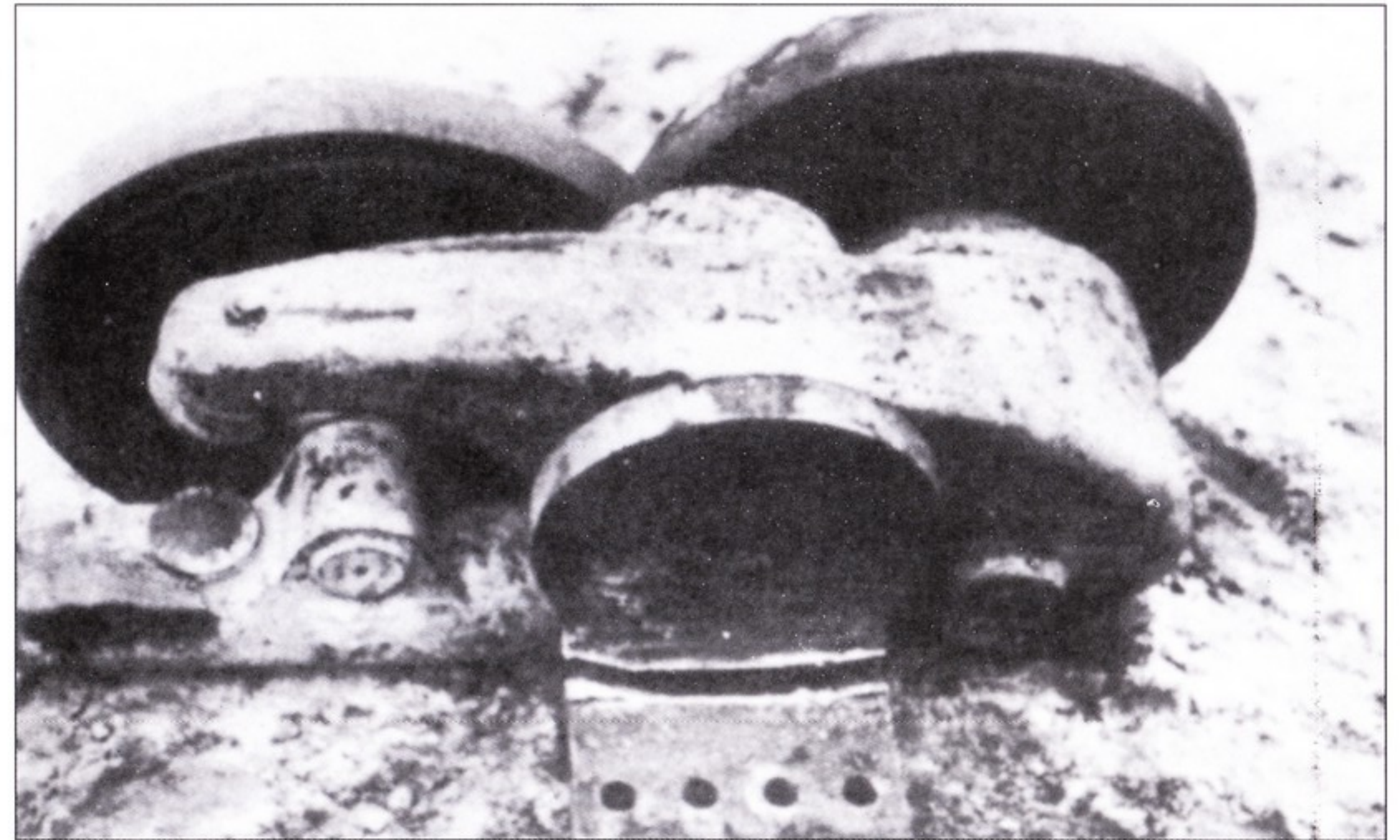
Поломанная тележка типа Порше от самоходки шасси № 305004. Ходовая часть Порше часто ломалась, «Ягдтигры» с шасси Порше состояли на вооружении 653-го батальона тяжелых истребителей танков.
