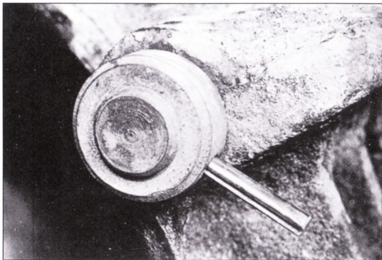
Контрольная шайба и шплинт пальца трака. На фото справа - регулировка натяжения гусеницы.
