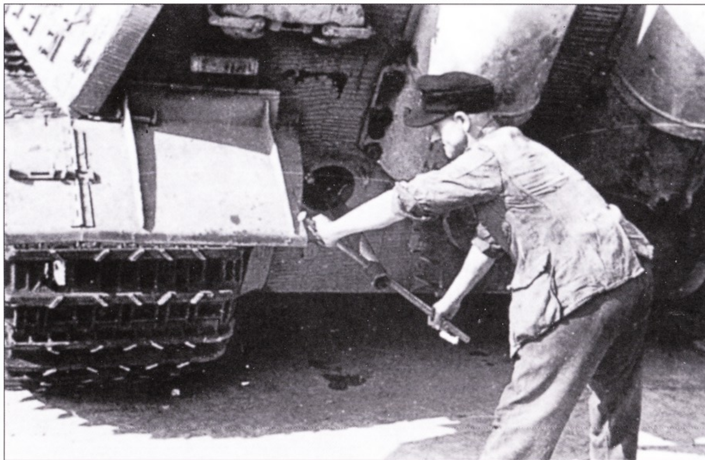
Без молотка и зубила никак! Посредством молотка и зубила бронекрышка механизма регулировки натяжения гусеницы снята.
