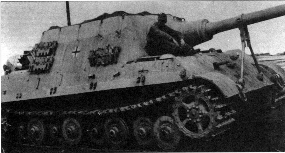
Вверху – «Ягдтигр» с подвеской КБ «Порше АГ» (шасси № 305009) с транспортными гусеницами и без фальшбортов, подготовленный к перемещению железной дорогой. Внизу – та же машина после схода с железнодорожной платформы. Слева от «Ягдтигра» видны солдаты, сгружающие фальшборта. Идет подготовка к «переобуванию» САУ на широкие 800 мм гусеницы. Осень 1944 года.
