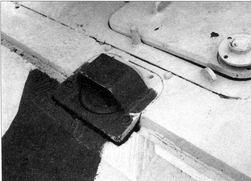
Бронировка оптического прибора наблюдения механика-водителя. Виды сверху и спереди. Абердинский полигон, 2002 год.
