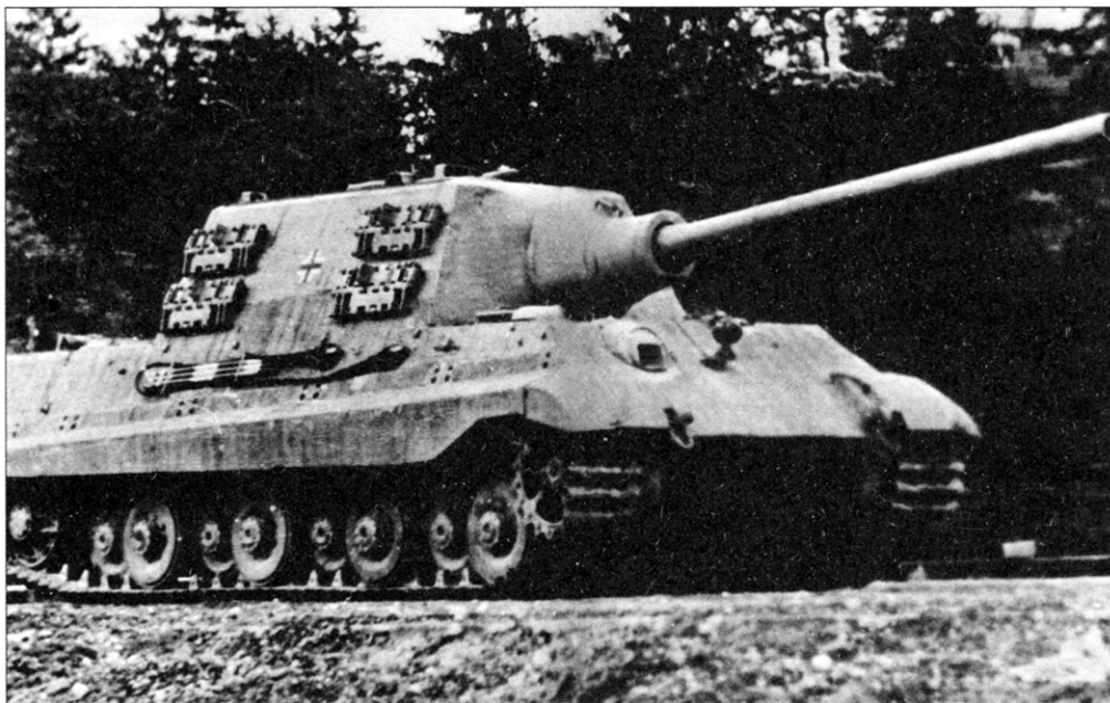
Тяжелый истребитель танков «Ягдтигр» первых серий (шасси № 305003) с ходовой частью конструкции Порше перед отправкой в учебную часть. Машина частично покрыта «циммеритом» и окрашена темно-желтой краской Dunkel Gelb. 1944 год.
