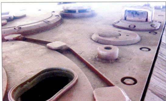
На снимках представлены характерные отличия поздней модификации Sd.Kfz.186 (см. с. 44-49 книги). Справа внизу новое «место» гнезда для установки штанги зенитного пулемета.
