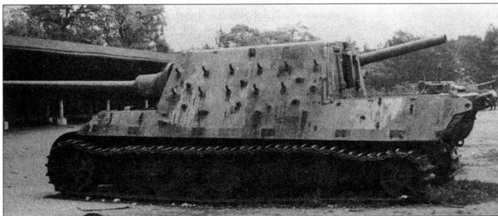
Та же машина, вид сбоку. Хорошо видно, что кронштейны для навешивания запасных траков занимают весь борт рубки, что характерно именно для последней серии тяжелых истребителей танков «Ягдтигр». Германия, Зеннелягер, 1953 год.
