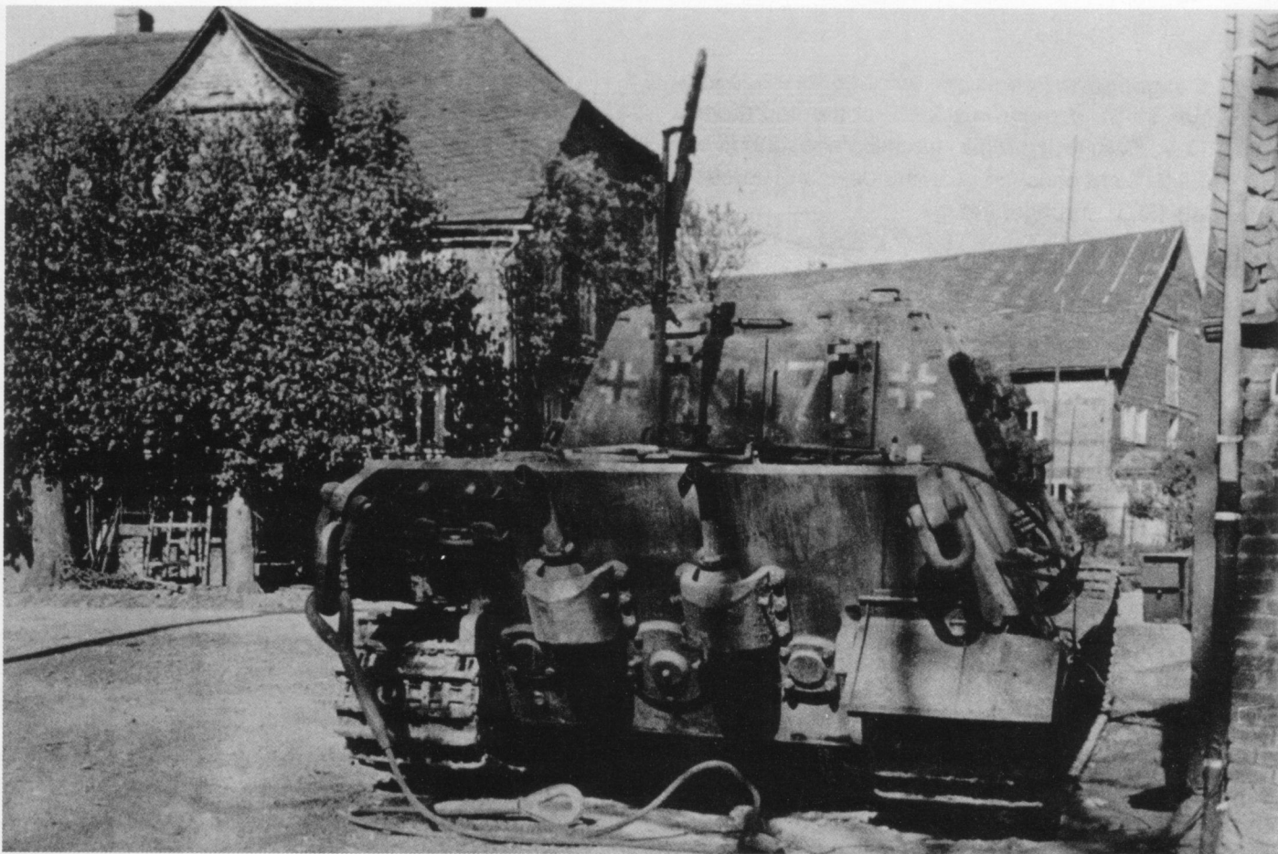
Вид с кормы на машину, изображенную на стр. 24 внизу. Хорошо видна оригинальная установка зенитного пулемета MG 42.
