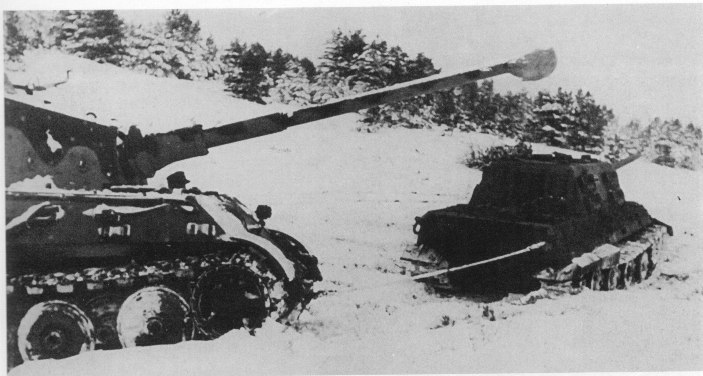
Фотография иллюстрирует процесс транспортировки «Ягдтигром» танка «Тигр II». Буксировка ведется по бездорожью, что опровергает мнение некоторых исследователей, считающих, что «Ягдтигр» с трудом мог передвигаться сам (и то лишь по хорошей дороге), но не тянуть себе подобных.
