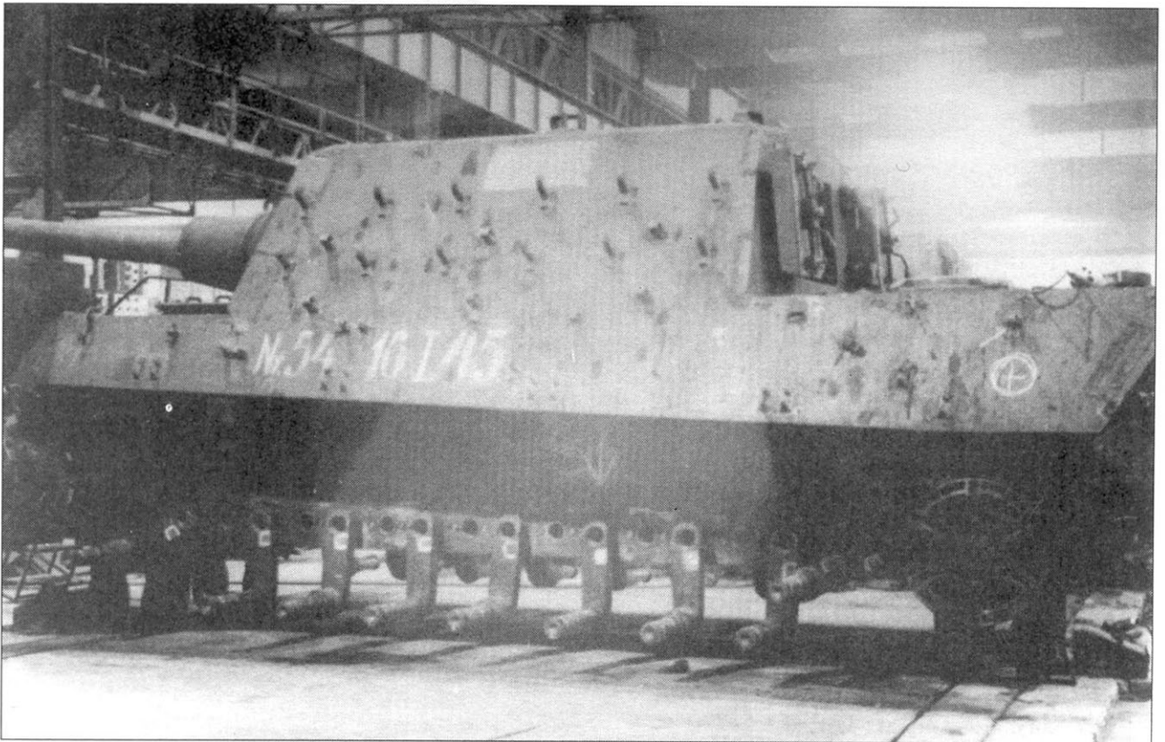
Идет сборка Ягдтигров на заводе фирмы Werk Nibelungen GmbH в Сент-Валентине. На переднем плане - 54-й серийный Ягдтигр. Хорошо видна дата снимка - 16 января 1945 г. Видны отличительные особенности поздних машин: сглаженные углы рубки, 9-ти зубовое ведущее колесо, дополнительные скобы на рубке для запасных траков.
