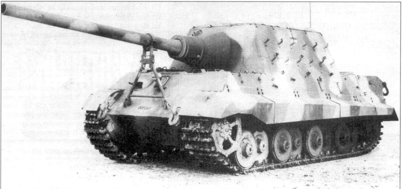
Ягдтигр №1 уже покрашен в трехцветный камуфляж и готов к отправке на фронт. Машина оснащена транспортными гусеницами, на лобовом бронелисте виден номер шасси - 305001.
