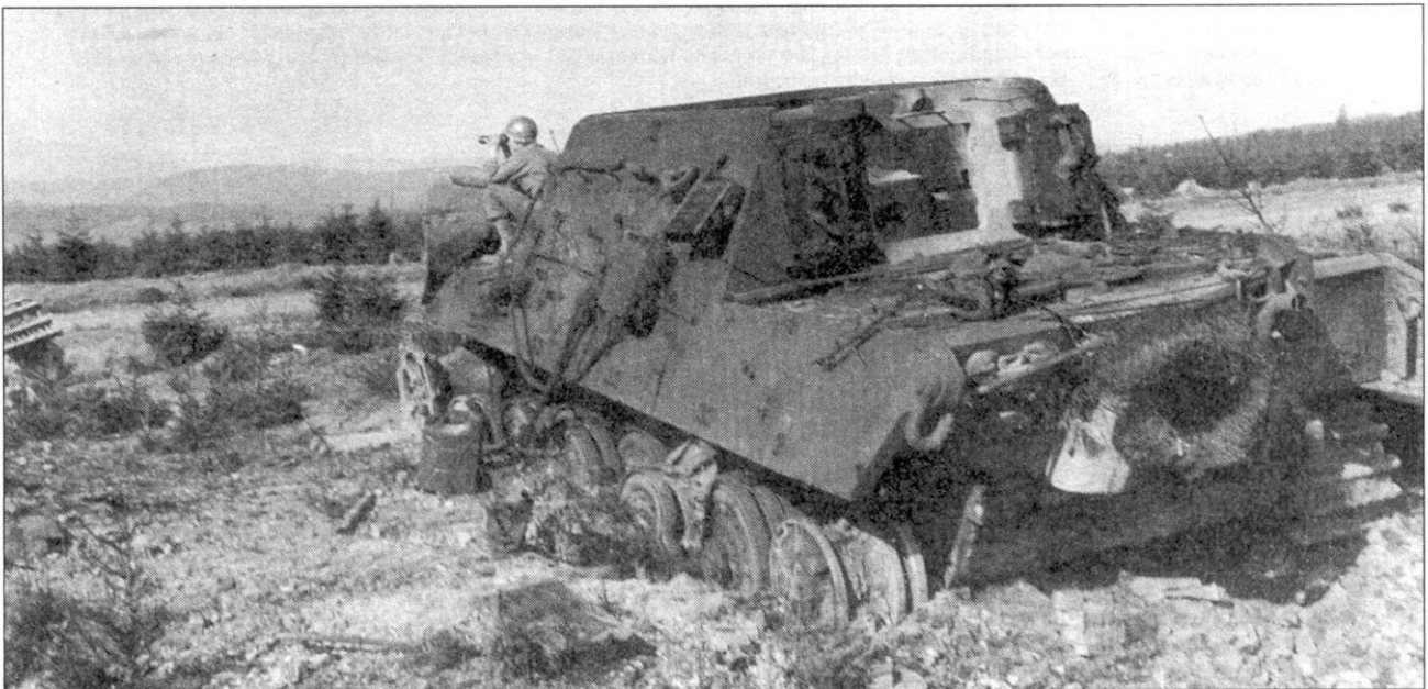
Американские солдаты осматривают подорванный немцами при отступлении Ягдтигр из 512-го батальона истребителей танков, март 1945 г. Перед нами машина позднего выпуска. Это видно по наваренным креплениям для 2-х тонного крана и дополнительным крюкам для траков на стенке рубки. Рядом с танком валяется скрученная транспортная гусеница, по-видимому экипаж менял гусеницы на боевые когда ему пришлось подорвать и бросить Ягдтигр. Обратите внимание, что крыша рубки сорвана, гусеница снята только с левого борта.
