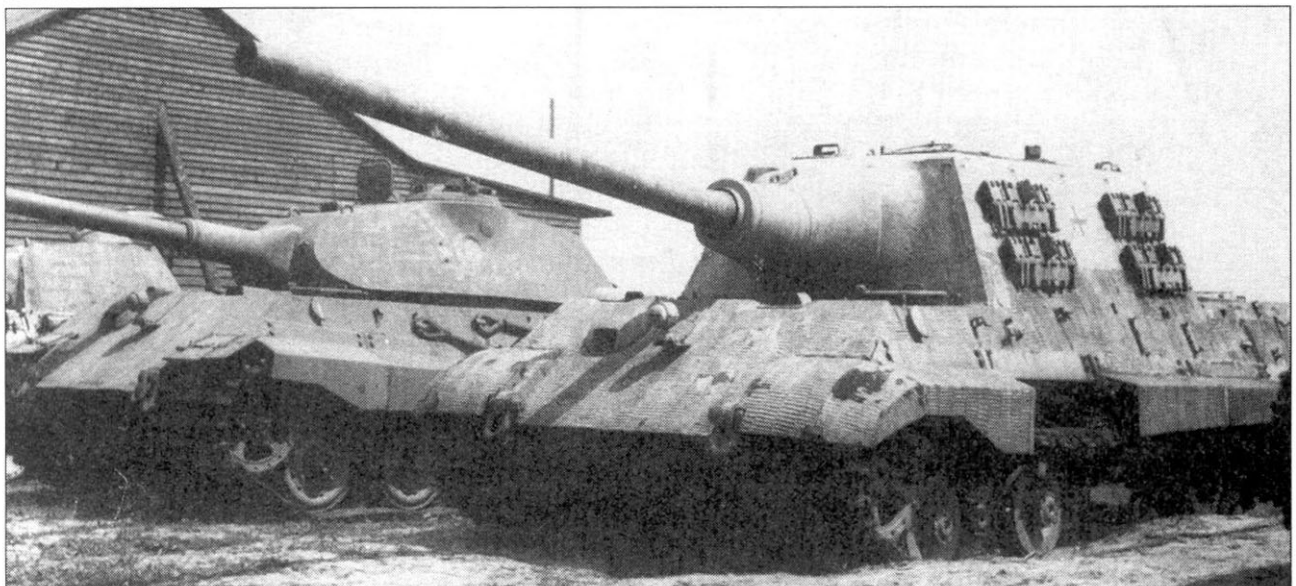
Снимки Ягдтигра шасси номер 305004 до того как он попал в Бовингтон. Машина покрыта циммеритом и не несет никаких тактических номеров. Бортовые экраны позже будут демонтированы. Ягдтигр перевозят на трейлере фирмы Гота грузоподъемностью 80 тонн.
