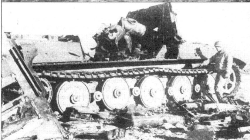
Взорванный «Ягдтигр» «134» (Henschel Fgst 305024) из 1-й роты 653-го батальона, Эльзас, 9 января 1945 года. Сначала машина была повреждена американским истребителем танков М 36, а затем взорвана своим экипажем. Большинство «Ягдтигров» было потеряно из-за мелких поломок и нехватки топлива.
