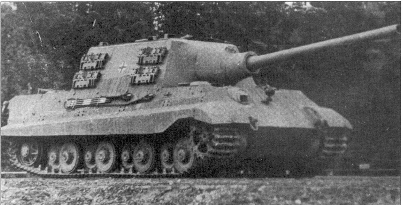
Третий по счету произведенный Ягдтигр оснащался гусеницами от «Фердинанда». Машина имела шасси типа Porsche.
