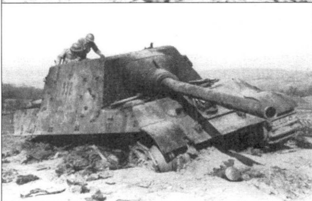
«Ягдтигр» «332» (Henschel) из 3-й роты 653-го батальона, брошенный и взорванный экипажем в районе Морброн-ле-Бэн. Машина раннего типа, несет трехцветный камуфляж. От внутреннего взрыва сорвало крышу рубки и надоторную бронеплиту. Бортовые экраны отсутствуют.
