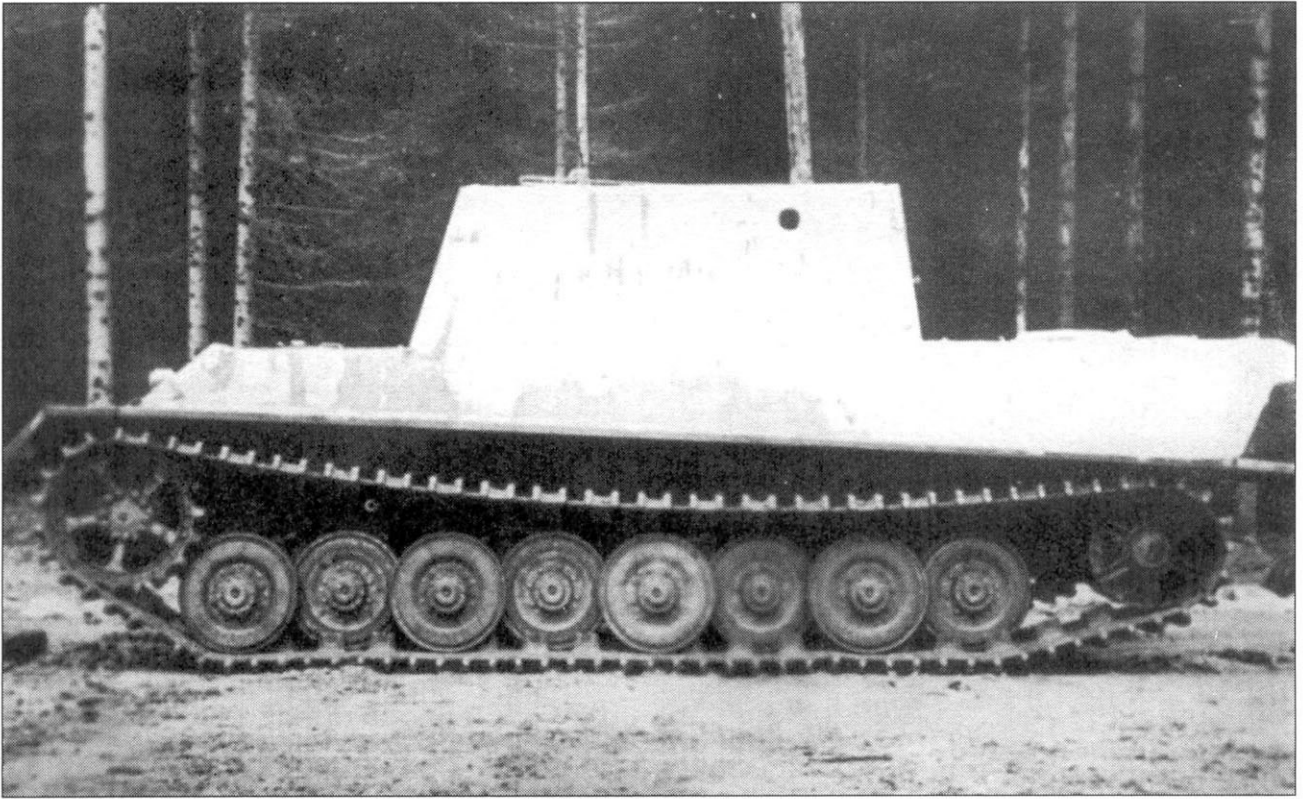
Ягдтигр на шасси типа Porsche (Fgst 305001)- катки и гусеницы уже установлены, а пушка - пока нет.
