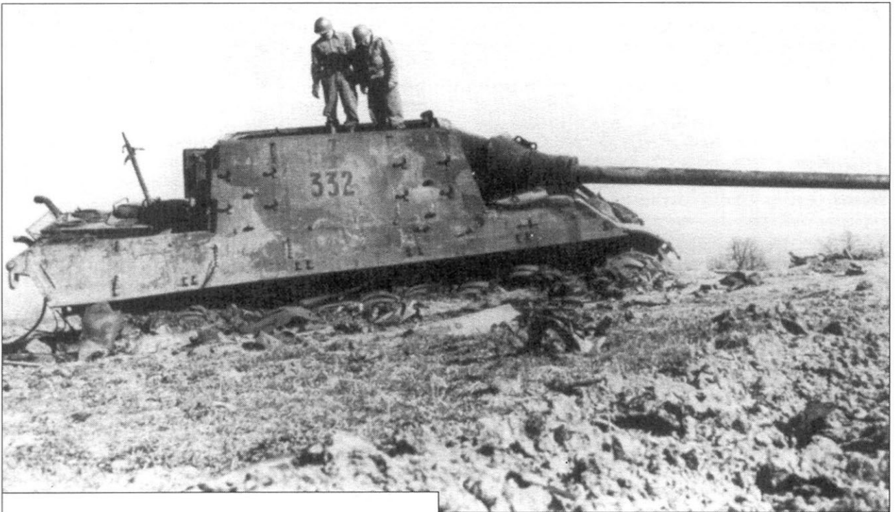
«Ягдтигр» «332» (Henschel) из 3-й роты 653-го батальона, брошенный и взорванный экипажем в районе Морброн-ле-Бэн. Машина раннего типа, несет трехцветный камуфляж. От внутреннего взрыва сорвало крышу рубки и надоторную бронеплиту. Бортовые экраны отсутствуют.
