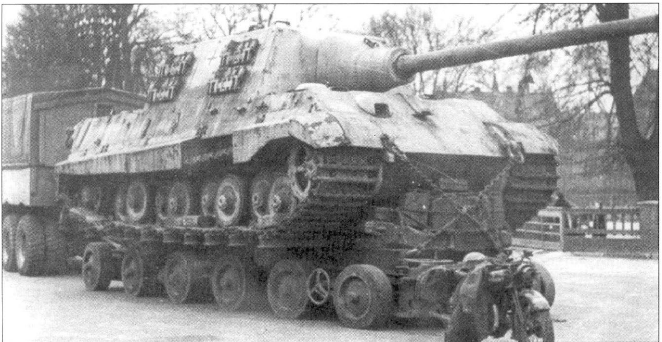
Снимки Ягдтигра шасси номер 305004 до того как он попал в Бовингтон. Машина покрыта циммеритом и не несет никаких тактических номеров. Бортовые экраны позже будут демонтированы. Ягдтигр перевозят на трейлере фирмы Гота грузоподъемностью 80 тонн.
