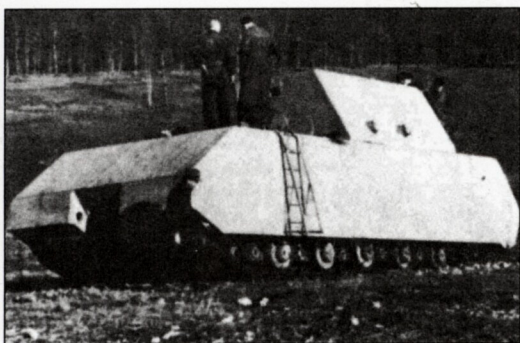
Заводские испытания опытного образца сверхтяжелого танка «Маус» (Объект 205/1) с нагрузочной литой башней.
