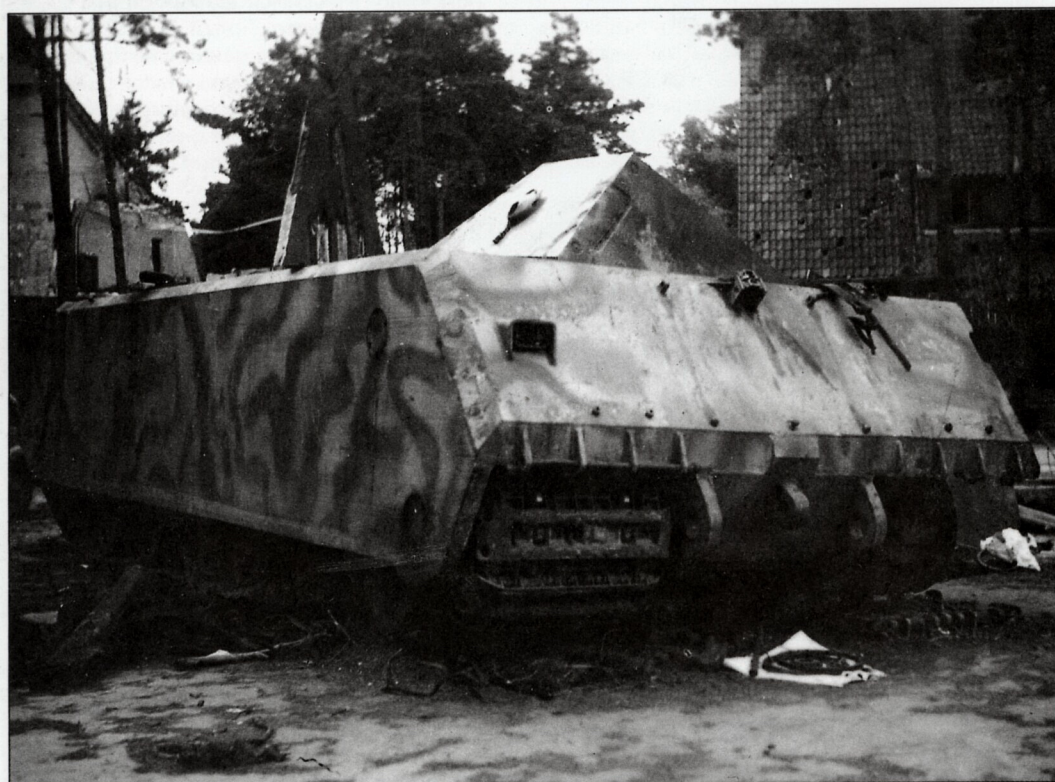
Опытный образец танка «Маус» (Объект 205/2), обнаруженный на Куммерсдорфском артиллерийском полигоне. Танк подорван немцами при отступлении.
