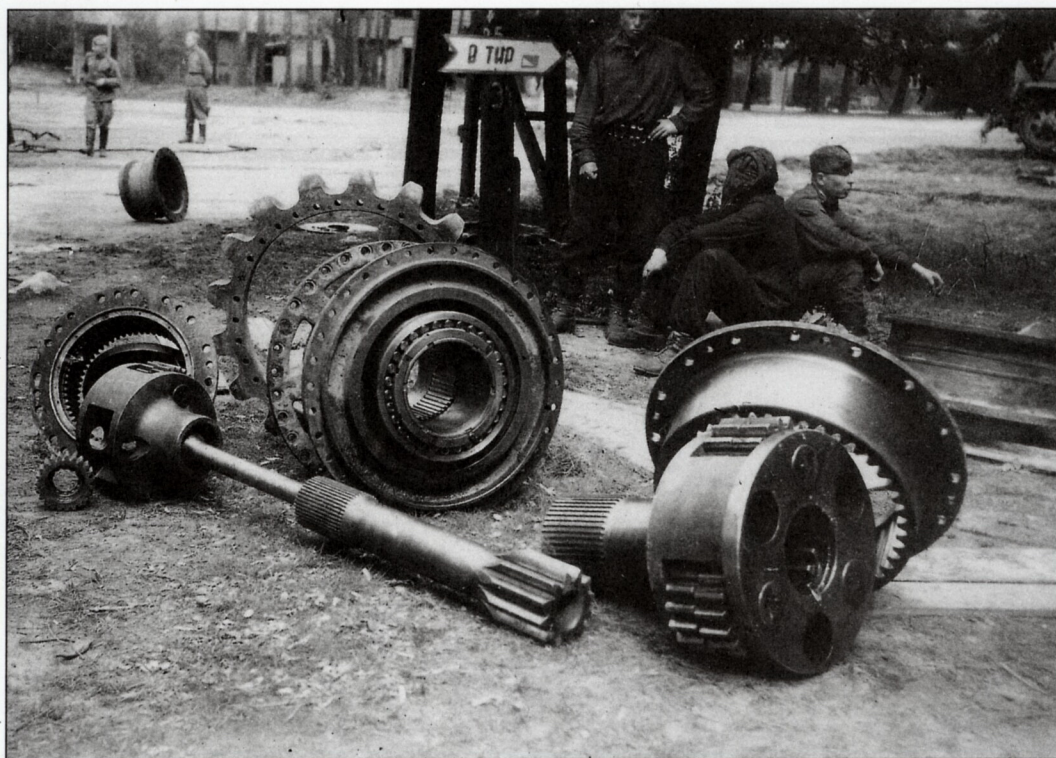
Детали планетарных передач уложены в том порядке, как они устанавливаются на танке. Левый (первый) планетарный редуктор. Ведущее колесо. Правый (второй) планетарный редуктор.
