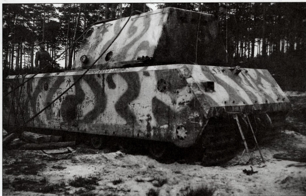
Опытный образец танка «Маус» (Объект 205/1), обнаруженный на Куммерсдорфском артиллерийском полигоне. Показана подготовка танка к эвакуации.
