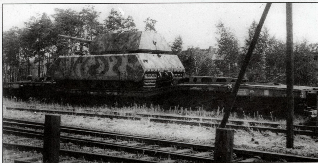
Танк «Маус», собранный из двух разрушенных машин и установленный на специальной железнодорожной платформе перед отправкой в СССР.
