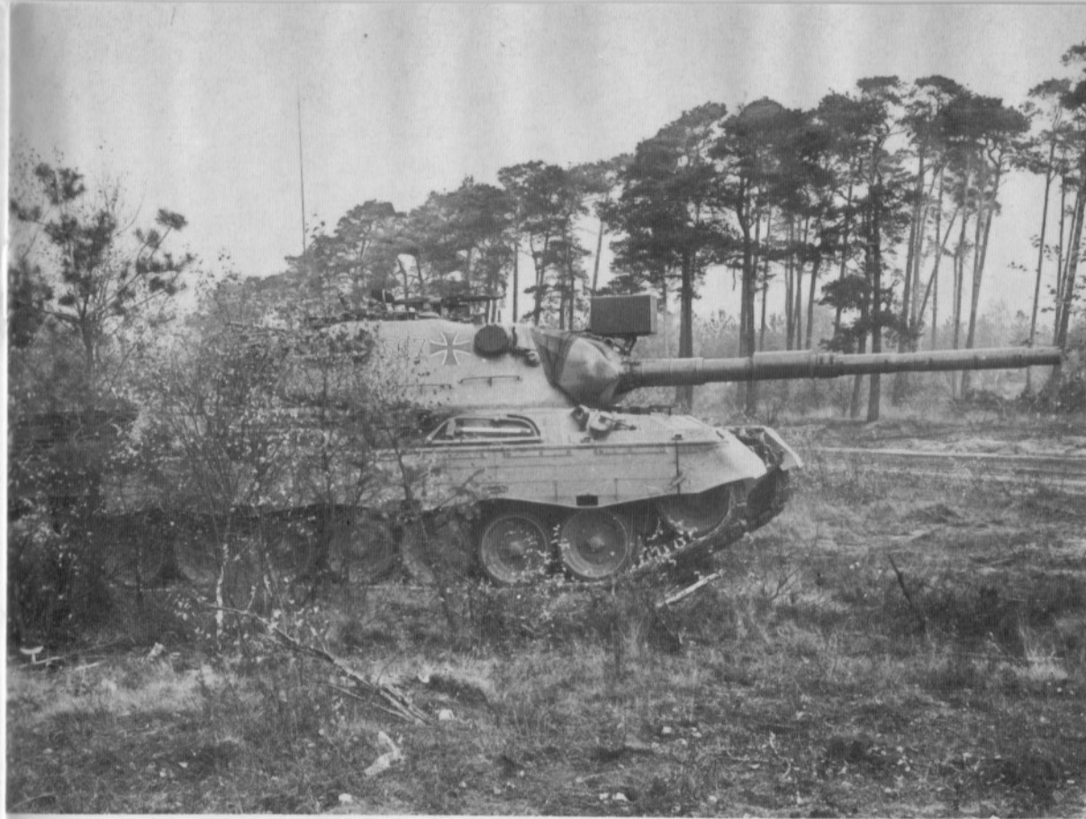
Ein Leopard A2 in Stellung. Durch die Blendenöffnung unterhalb des Infrarot-/Weißlicht-Schießscheinwerfers feuert das koaxiale Blenden-Maschinengewehr.
