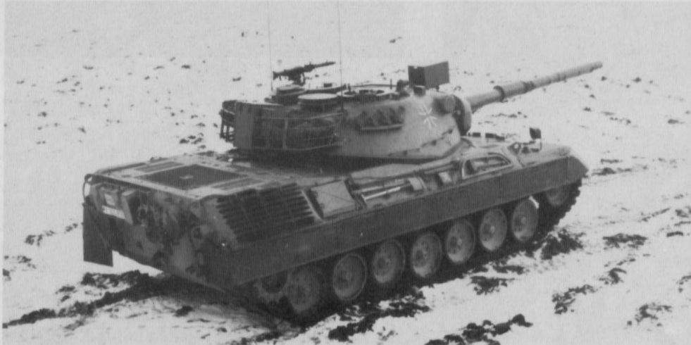
Leopard 1 (3. Baulos) mit Seitenschürzen als Truppenversuch.
