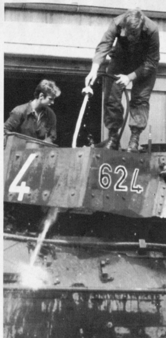
Zusätzlich gepanzert wurde nur in der Senkrechten, der Turmkorb blieb an der Unterseite offen.
