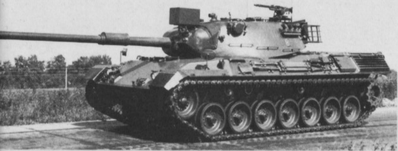
Die niederländische Version eines Leopard 1 (4. Baulos). Die Unterschiede in der Werkzeugunterbringung, der Anordnung der Nebelmittelwurfanlage und der äußeren Anbringung der Antennenabstimmgeräte sind offensichtlich.
