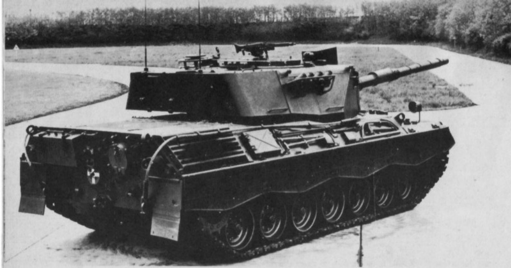
Leopard A3 mit in das Turmgehäuse integrierter Heckablage.
