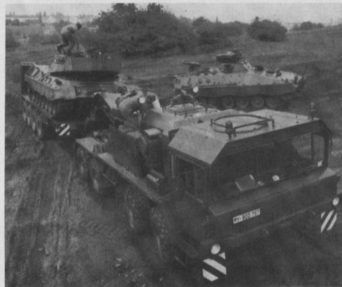
KPz Leopard A1A1 verladen auf dem Schwerlast-Transporter Faun SLT 50-2.
