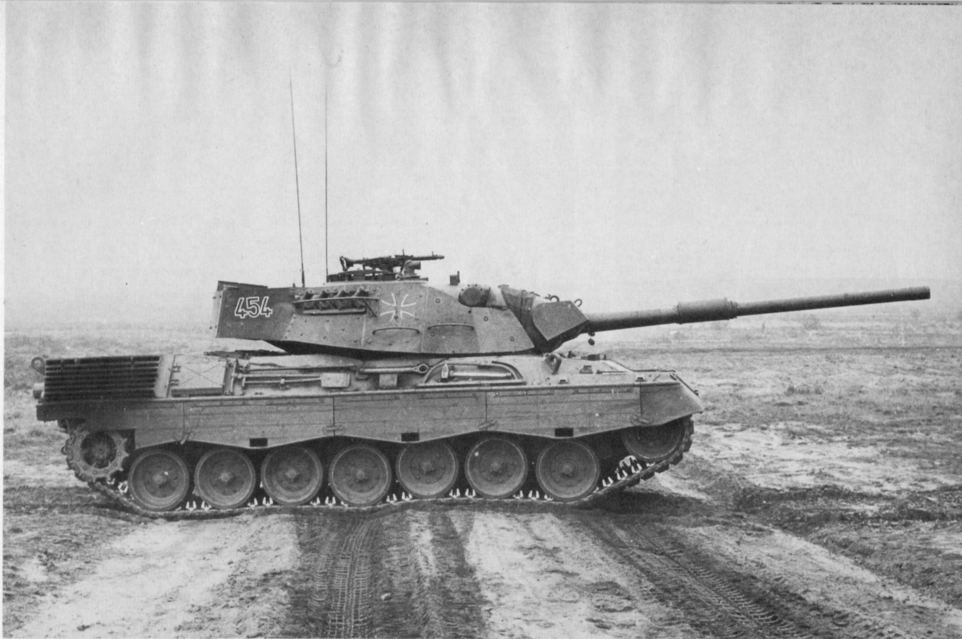
Lediglich die keilförmige Zusatzpanzerung an der Blende besteht aus Vollmetall. An diesem Fahrzeug nicht aufgebaut: Die Wärmeschutzhülle und der Infrarot-/Weißlicht-Schießscheinwerfer.
