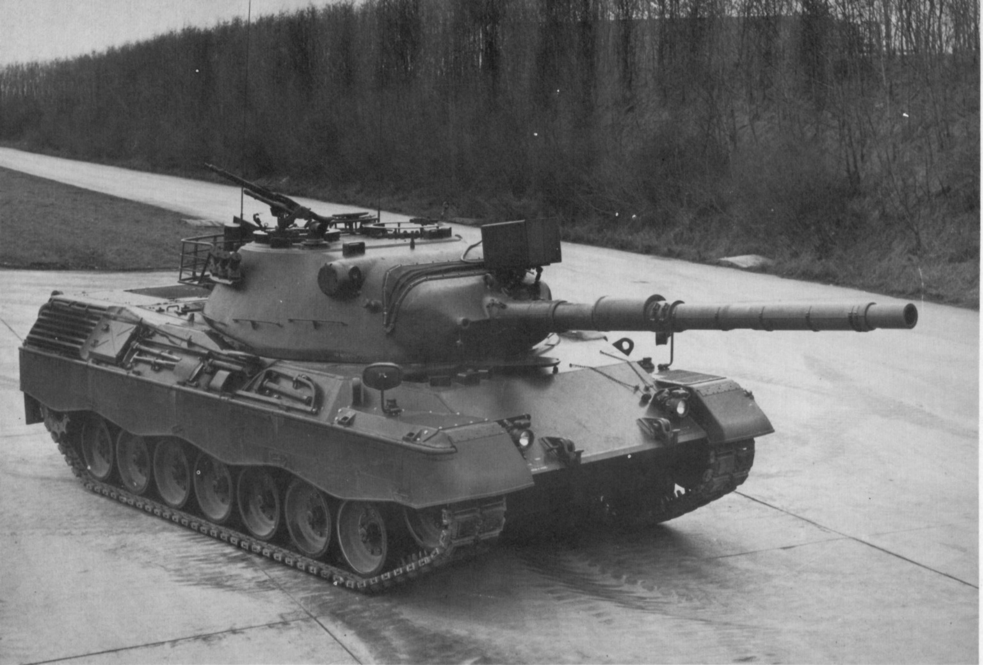
Ein fabrikneuer Leopard A2; das kleine kreisförmige Loch in der Turmblende links neben der Bordkanone ist die Ausblicköffnung des Turmzielfernrohres.
