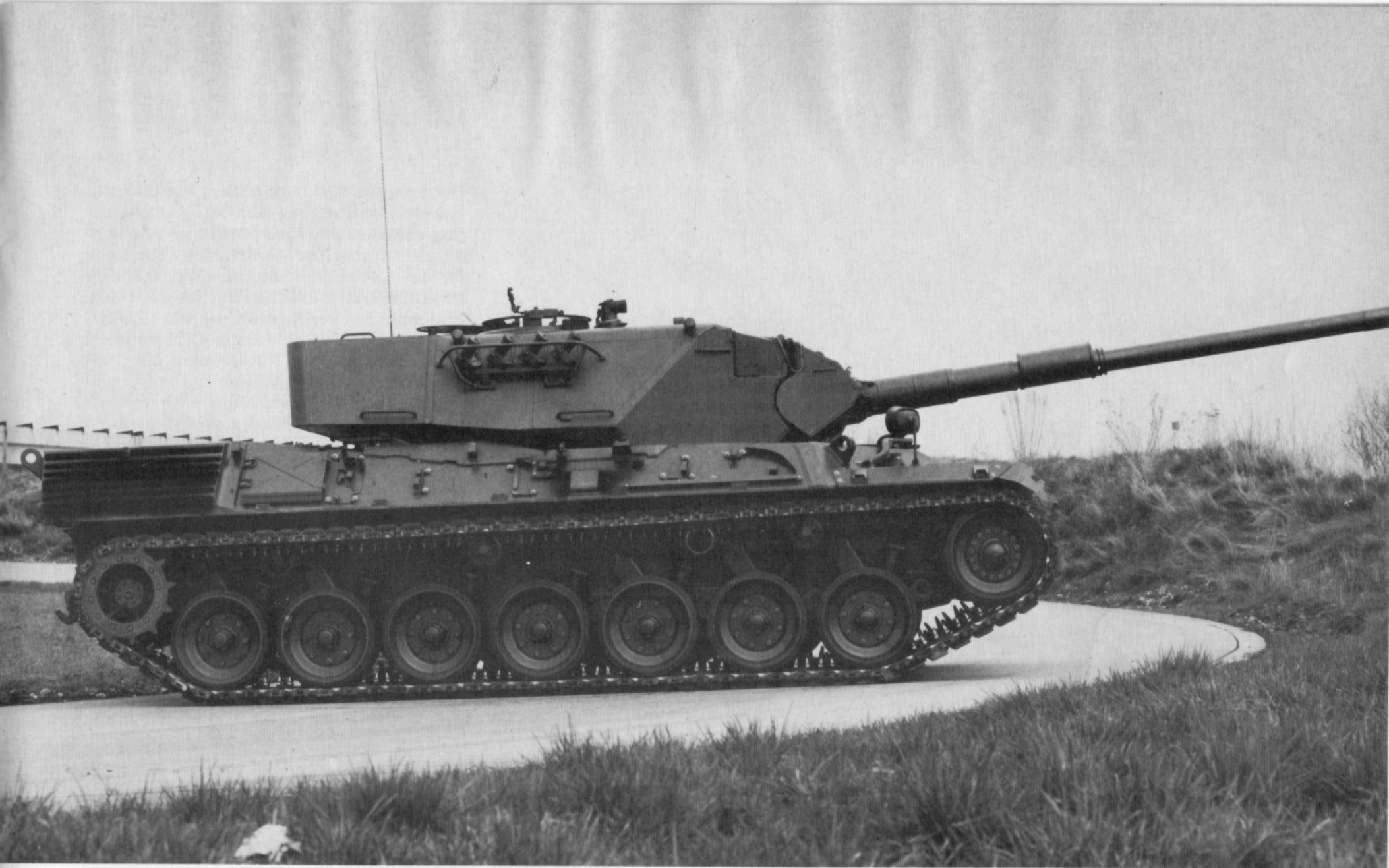
Ein Leopard A3 DK (Dänemark), der in Form und Ausrüstung dem A3 entspricht, jedoch mit folgenden Abweichungen: Winkelspiegel- Wisch- und Waschanlage, automatische Getriebeschaltung, Anbauvorrichtung an unterer Bugplatte für eine Räum- schaufel mit elektro- hydraulischer Höhenverstellung.
