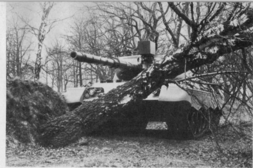
Ein Leopard A2 in Stellung. Durch die Blendenöffnung unterhalb des Infrarot-/Weißlicht-Schießscheinwerfers feuert das koaxiale Blenden-Maschinengewehr.
