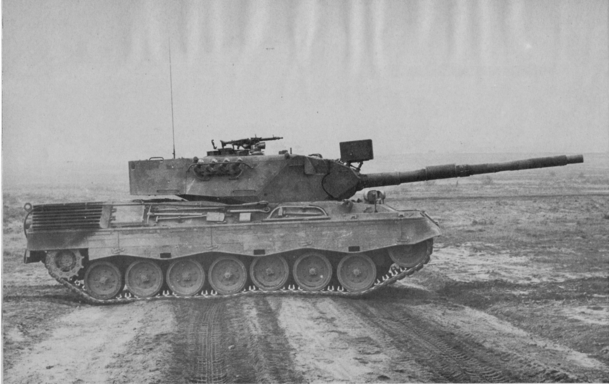
Seitenansicht eines Leopard A3; interessant die Anbringung der Abschleppseile, die von einer Halterung in der Mitte der Wannenseite über die Auspuffgrätings zu den Abschleppschäkeln am Fahrzeug geführt werden.
