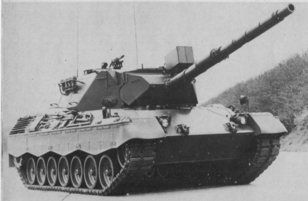
Leopard A3 mit in das Turmgehäuse integrierter Heckablage.
