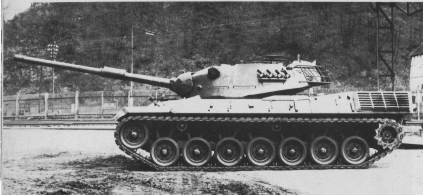
Äußerlich unterscheidet sich dieser Vorserien-Leopard von der Serienfertigung vornehmlich durch die geneigte Heckablage (Turmkorb) und den symmetrischen Aufbau des Auspuffgrätings.
