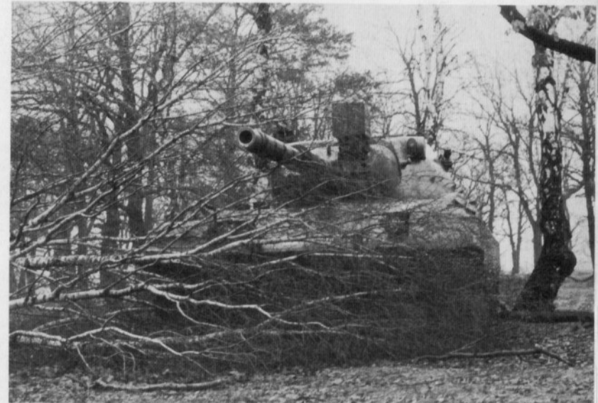
Leopard A2 in versteckter Stellung. Die geschlossenen Luken, der eingeführte Stopfen in der Blenden-MG-Öffnung und die fehlende Tarnung am Fahrzeug lassen eine kurz zuvor gegebene Atomwarnung vermuten.
