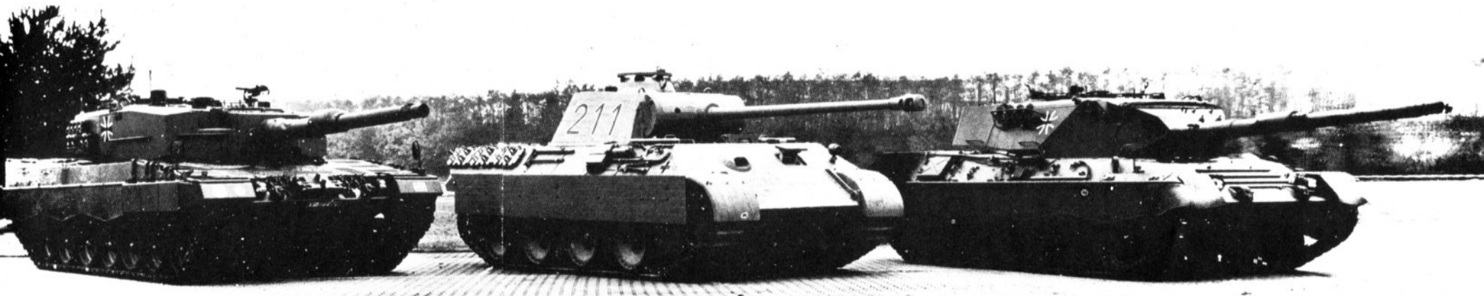
Kampfpanzer Leopard A 3 (mit geschweißtem Turmgehäuse)
