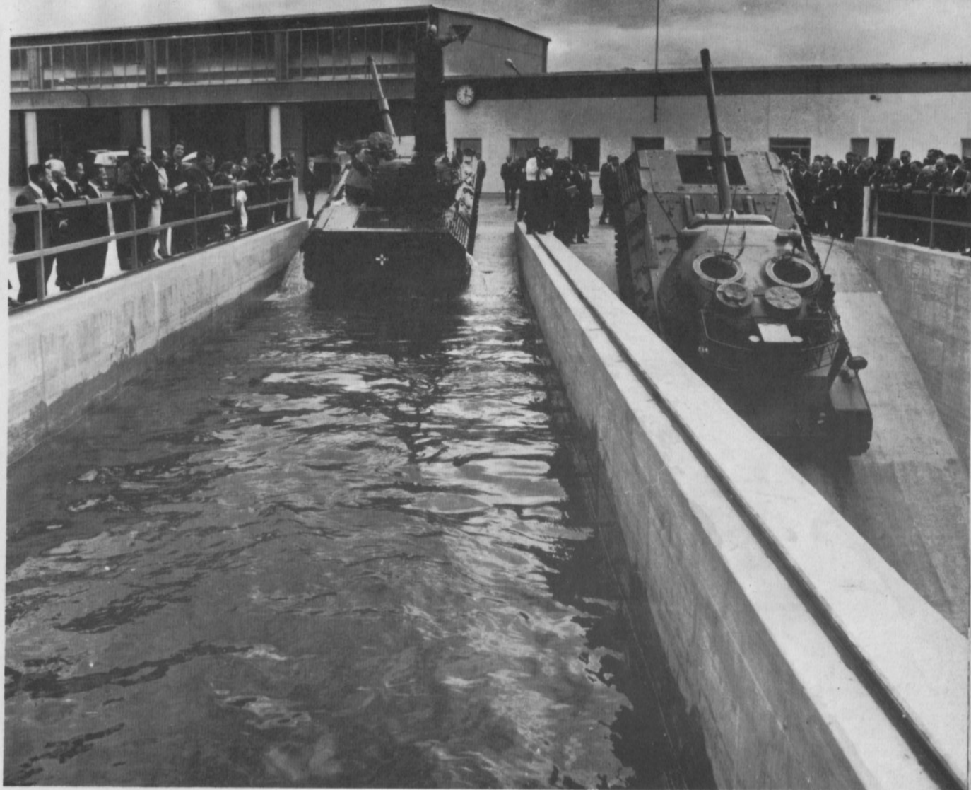
Dichtigkeitsprüfung und Leistungsermittlung auf dem Werksgelände der Firma Krauss-Maffei. Nach geringer Vorbereitungszeit überwindet der Leopard 1 mit aufgebauter Unterwasserfahr-Zusatzausstattung Gewässerhindernisse bis 4 Meter Tiefe.
