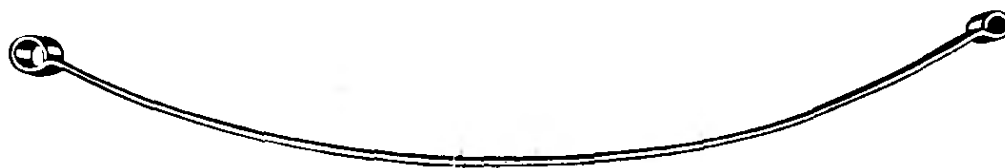
Рис. 2.76. Асимметричная однолистовая рессора, используемая в задней подвеске легкового автомобиля. Длина рессоры L = 1590 мм, жесткость подвески c_{2h} = 21 Н/мм, статическая нагрузка F_w = 4 кН
