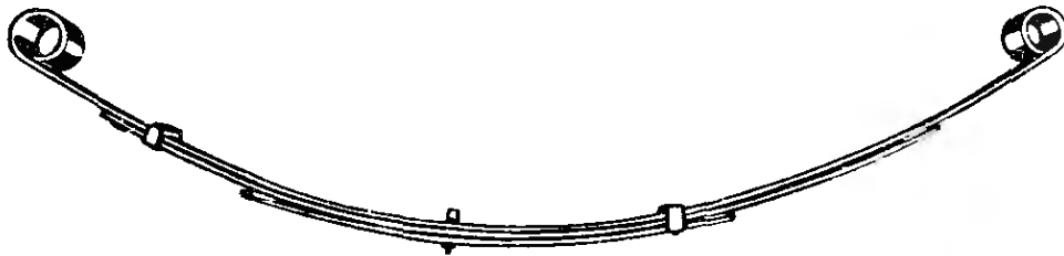
Рис. 2.83. Трехлистовая рессора задней подвески легкового автомобиля с короткими пластмассовыми проставками по концам листов. Эта рессора имеет следующие показатели: L = 1194 мм, B = 51 мм, h_1 = 6,35 мм, c_{2h} = 15,4 Н/мм, F_w = 2,18 кН, \sigma_v = 610 МПа
