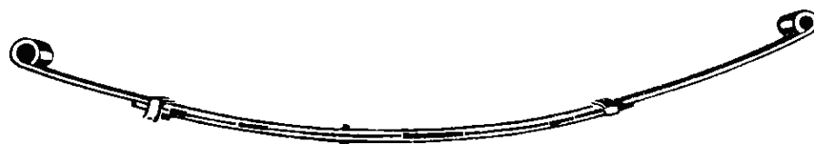
Рис. 2.82. Двухлистовая рессора задней подвески легкового автомобиля со сплошной полимерной проставкой, имеющая следующие параметры: расстояние между ушками L = 1590 мм, ширина листа B = 70 мм, толщина листа h_1 = 9,7 мм, жесткость подвески c_{2h} = 18 Н/мм, статическая нагрузка F_w = 37 кН, напряжения изгиба при этой нагрузке \sigma_\theta = 702 МПа
