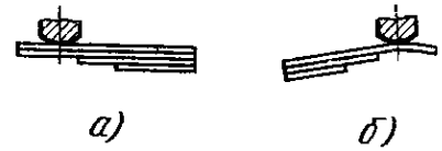
Рис. 2.94. Двухступенчатая параболическая рессора нового поколения для грузовых автомобилей, имеющая прокладки между листами по кочкам и в зоне центрального стяжного болта
