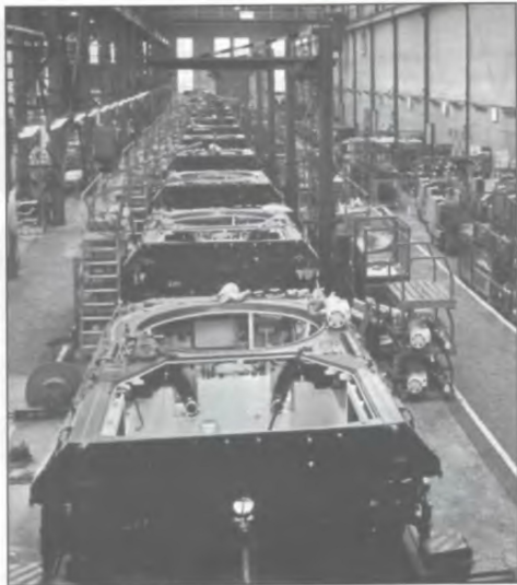
■ Сборочная линия танков «Леопард»
