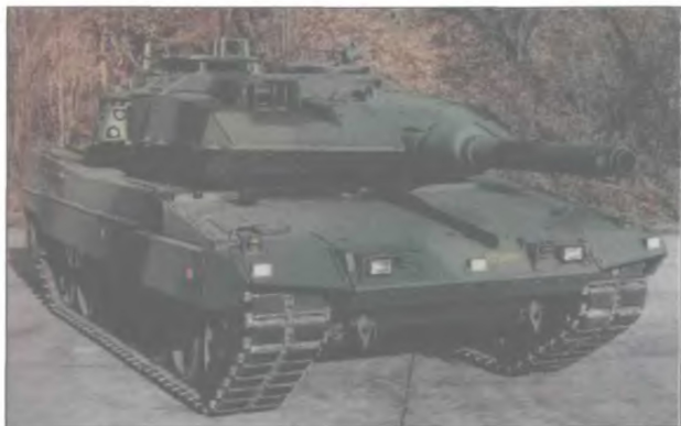
■ Шведский танк Strv-122, представляющий собой модификацию основного танка «Леопард-2А5»
