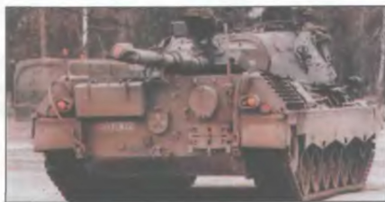
■ «Леопард-1» с развернутой башней (вид сзади)
