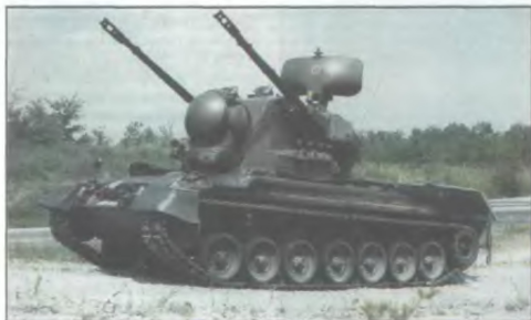
■ Спытная ЗСУ на базе «Леопарда-1»
