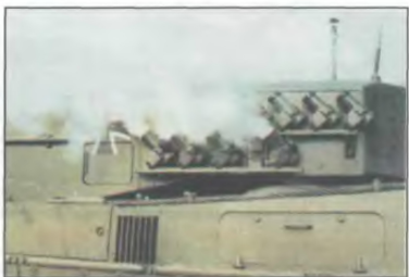
■ Блок дымовых гранатометов на башне танка «Леопард-2»
