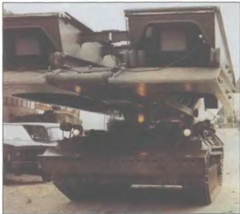
■ Мостоукладчик «Бибер» на базе танка «Леопард-1» канадской армии
