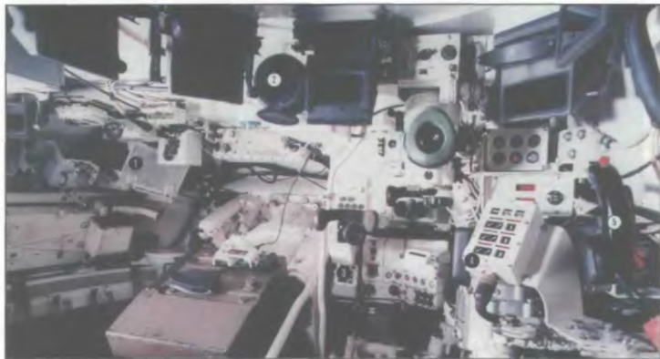
■ Башня танка «Леопард-1» армии Бельгии после модернизации: 1 — радиатор электронного блока системы управления огнем фирмы SABCA; 2 — экран системы ночного видения командира; 3 — пульт управления системы ночного видения наводчика; 4 — пульт управления системы ночного видения командира; 5 — управление лазерным дальномером
