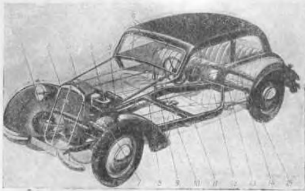
Фиг. 72. Расположение механизмов на шасси автомобиля ДКВ Фронт (F-8):
