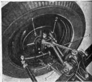
Фиг. 80. Подвеска передних колёс автомобиля ДКВ Зондерклассе: 1 — головка регулировочного эксцентрика тормозов; 2 — цилиндр гидротормоза; 3 — шарнирное звено; 4 — амортизатор; 5 — рессора; 6 — предохранитель кронштейна шкворня.
