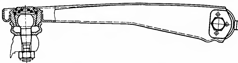
Рис. 3.54. Удобная в изготовлении нерегулируемая тяга для уже не выпускающегося автомобиля «Рено-12». Вместо трубы здесь использована штампованная из листа деталь, в которую запрессован внешний шарнир, не требующий ухода. Недостатком такой конструкции является большой требуемый для нее объем
