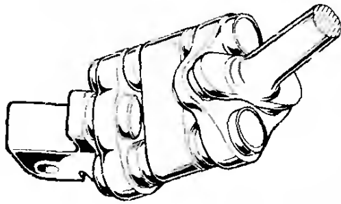
Рис. 3.117. Гомокинетический шарнир фирмы ЗГФ, состоящий из жесткой средней части и двух упругих дисков. Шарнир обеспечивает равенство угловых скоростей вала рулевого колеса и вала рулевого механизма
