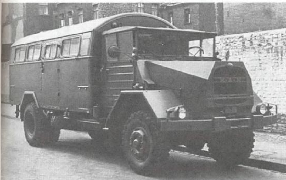
Грузовой автомобиль повышенной проходимости 5 т MAN 630 L 2 А с кузовом-фургонном. Задние колеса со сдвоенными шинами
