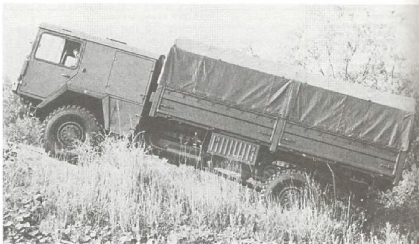
Грузовой автомобиль повышенной проходимости 5 т (4 x 4) MAN N 4510 с бортовой платформой с 1977 г.
