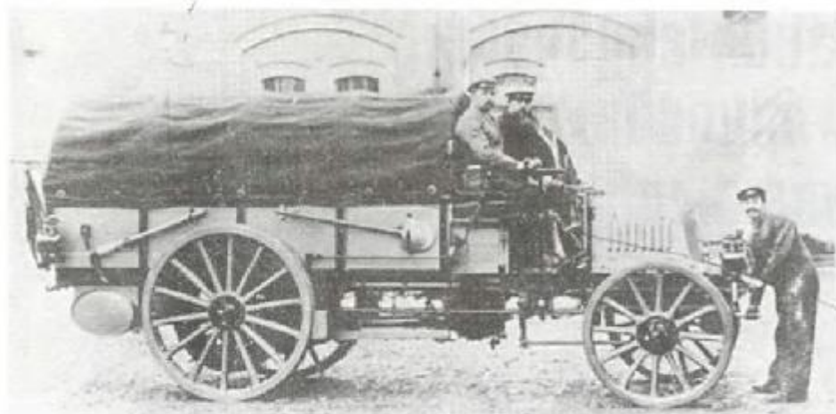
Военный грузовой автомобиль фирмы «Даймлер» 1904 г. с четырехцилиндровым двигателем 12 л. с., с четырехступенчатой коробкой передач, шестеренным приводом, стальными шинами. При собственном весе 2700 кг полезная нагрузка его составляет 2250 кг. Максимальная скорость – 10 км/ч. Он способен преодолевать при полной нагрузке подъем в 20%.
