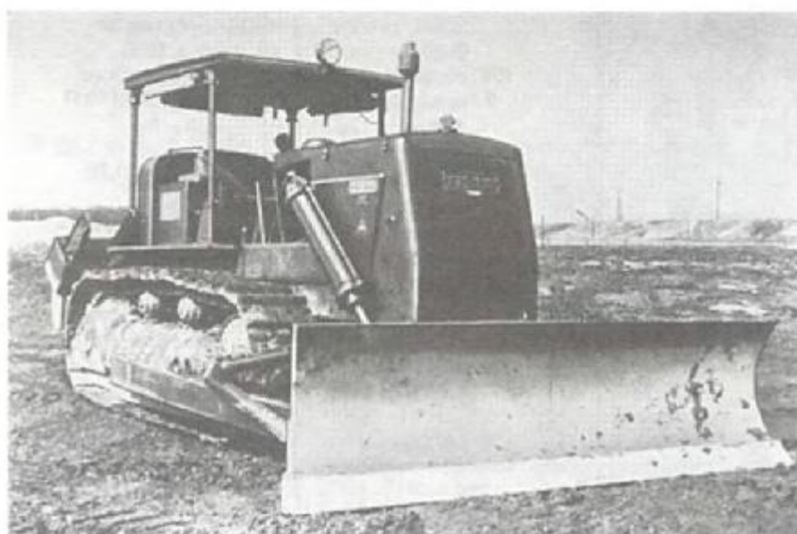
Используемый в инженерных войсках тяжелый бульдозер на низкорамном прицепе 25 т, буксируемом грузовым автомобилем. Бульдозер применяется на земляных работах для перемещения грунта на расстояние до 50 м и для грубого разравнивания почвы. Характеристики: дизель 160 л. с., габаритные размеры 5970 x 4180 x 3200 мм, вес 20 500 кг, скорость движения 8 км/ч.
