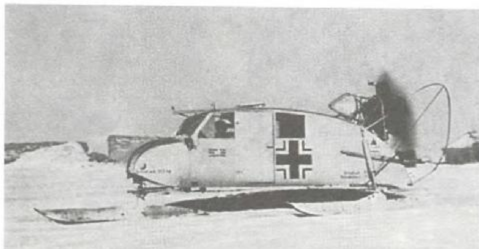
Вермахт, и прежде всего люфтваффе, охотно пользовались во время русской зимы подобными мотосанями. Автомобили с тремя полозьями, двигателем в 35 л. с. и пропеллерным приводом были сконструированы достаточно просто, но весьма целесообразно. Это были русские мотосани, которые вермахт захватил в качестве трофеев в первую зиму 1941/42 гг.
