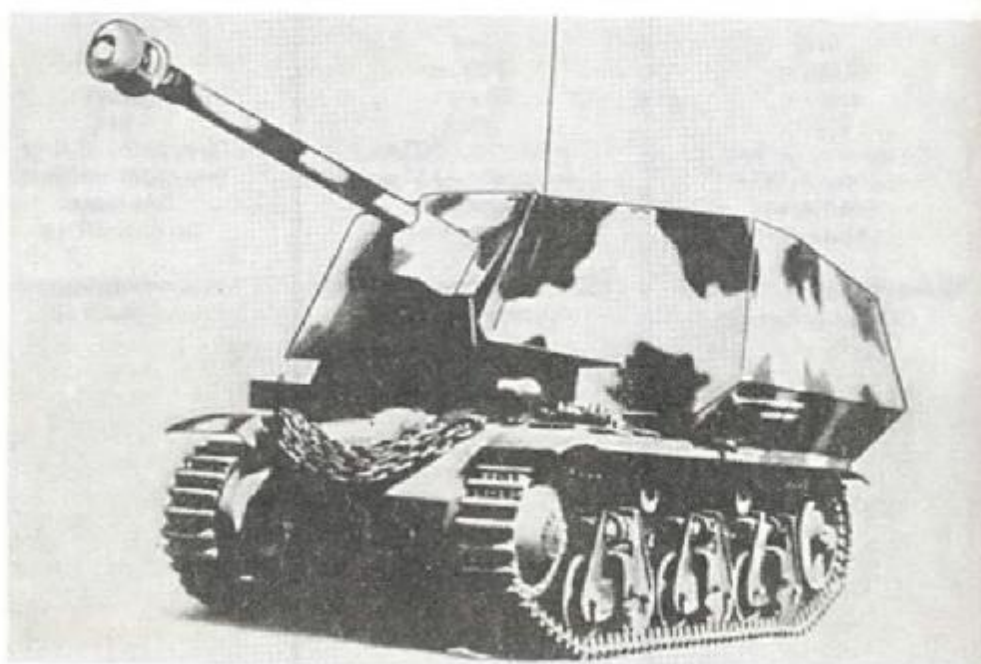
75-мм пушка 7,5cm Pак 40 L/46 на шасси танка «Гоч- кисс» H 39 (Франция)
