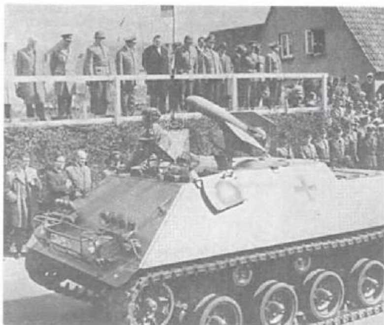
Ракетный истребитель танков HS 30 в момент пуска противотанковой управляемой ракеты SS-11.
