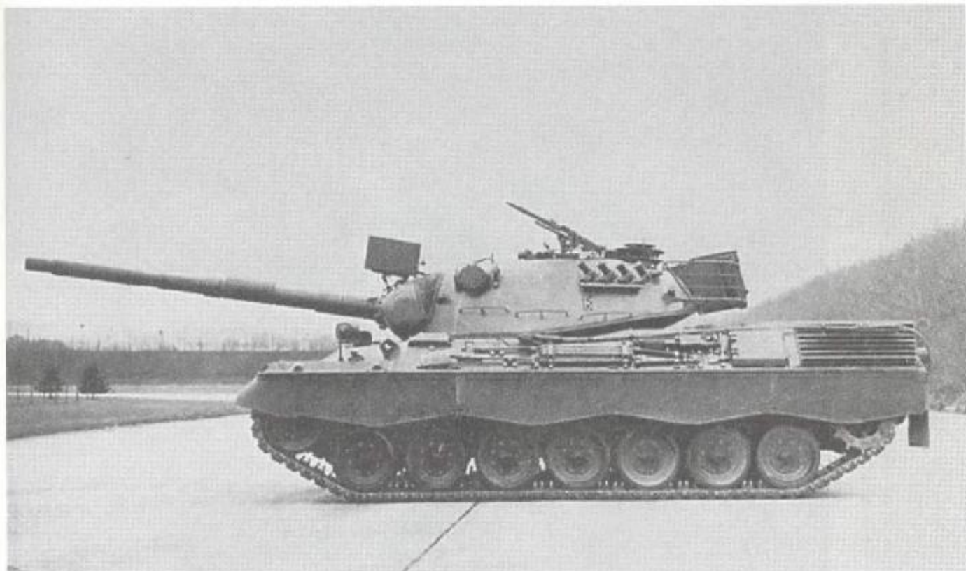
Основной боевой танк «Леопард 1 А 2». Серия 1972–1973 гг. (усиленная бронезащита литой башни)
