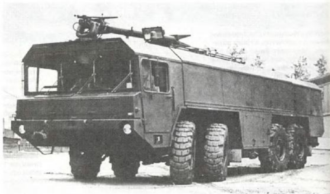
Пожарный автомобиль 8000 «Фаун» 8 х 8, с двумя ВО дизелями «Дойц». 320 л с., 8000 л воды, 900 л пенообразующего средства. Кузов и оборудование: «Кроненбург» (Голландия).
