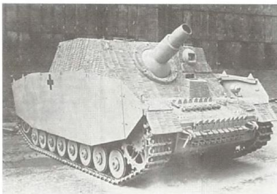
«Брумбэр» – штурмовой танк IV (штурмовая гаубица L/12 калибра 150 мм)
