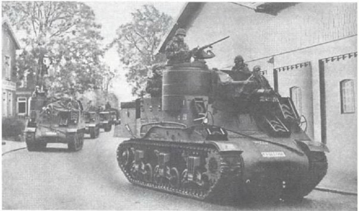
Самоходная 105-мм гаубица М-7 В 2 Боевая масса 42 500 кг Размеры: 6300 х 2890 х 2600 мм Запас топлива 635 л Расход топлива 340 л/100 км
