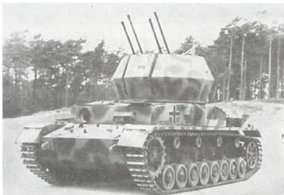
ЗСУ «Вирбельвинд» – на шасси танка Pz IV (20-мм четырехствольная установка)
