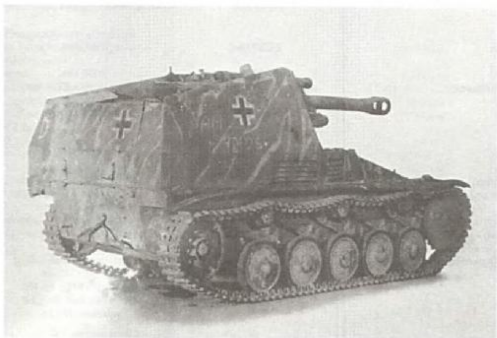
«Веспе» – 105-мм легкая полевая гаубица на шасси танка Pz II
