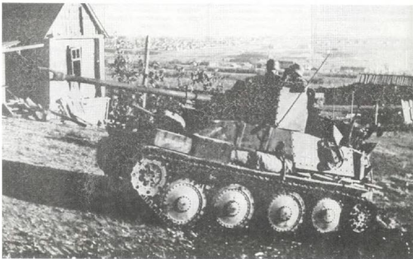
«Мардер III», 76,2-мм ПТП (р) на шасси Gw. 38 (t)
