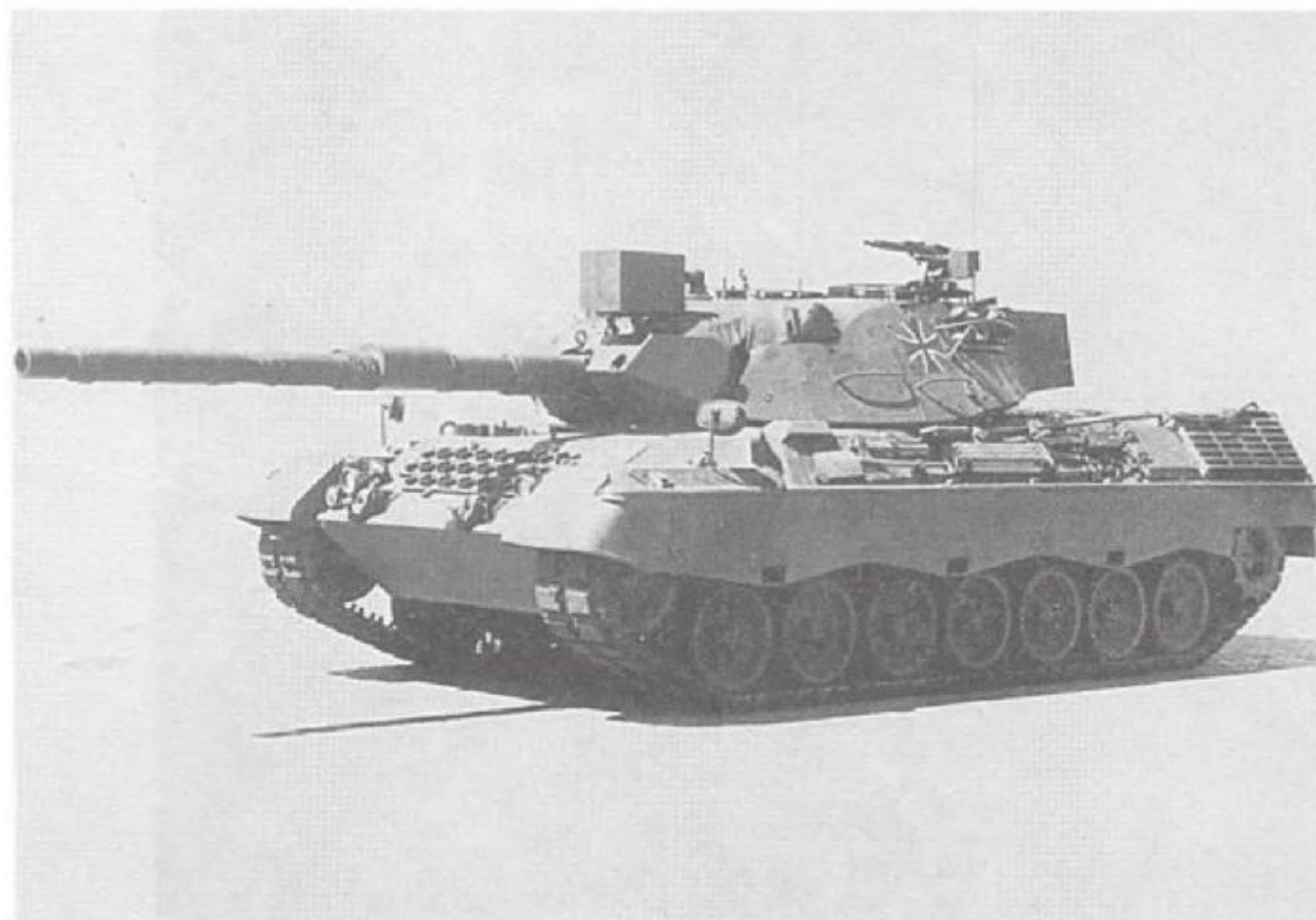
Основной боевой танк «Леопард 1 А1 А1». Переоборудование 1975–1977 гг. (дополнительная бронезащита башни)
