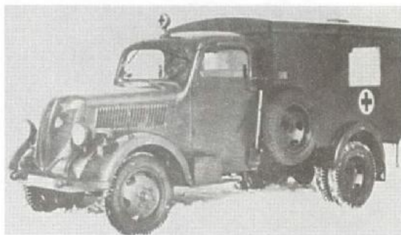
«Феномен Гранит» 1500 S или также «Гранит» 1500 А, – более новая конструкция санитарного автомобиля вермахта категории Kfz. 31, выпускавшаяся с 1940 по 1944 г.
