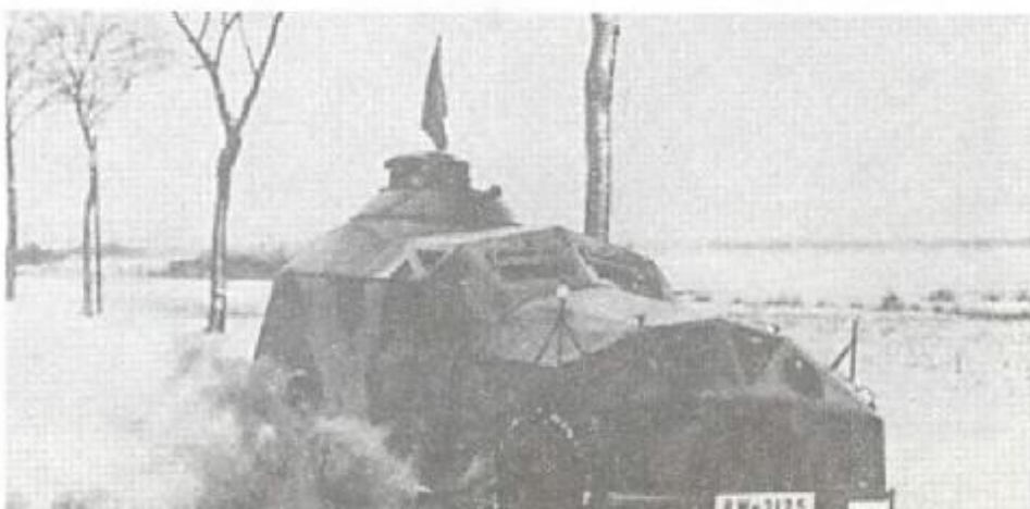
С 1929 г. рейхсвер располагал моделью «Дикси» 3/15 л. с. с ма- кетом танка. На снимках пока- заны эти машины во время уче- ний в условиях пересеченной местности, а также при уста- новке съемного кузова.
