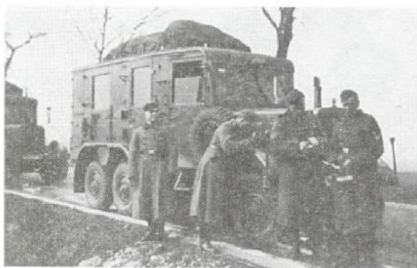
«Типовой дизель» в качестве автомобиля с звукозаписывающим, звукорасшифровывающим и светорасшифровывающим устройством (категория машин 62) подразделений наблюдения за танками противника.
