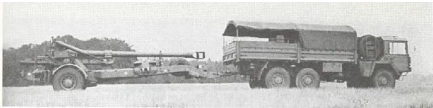
Грузовой автомобиль повышенной проходимости 7 т MAN N 4520 в качестве тягача полевой гаубицы 70
