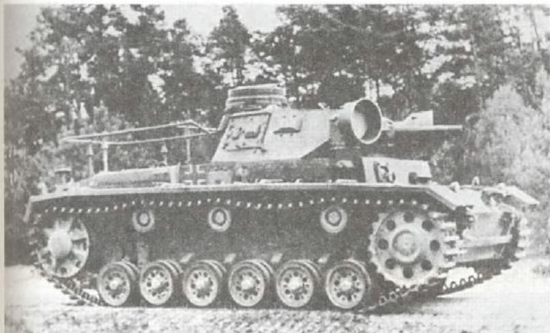
Командирский танк Pz III с громкоговорителями для «активной пропаганды про- тив врага»
