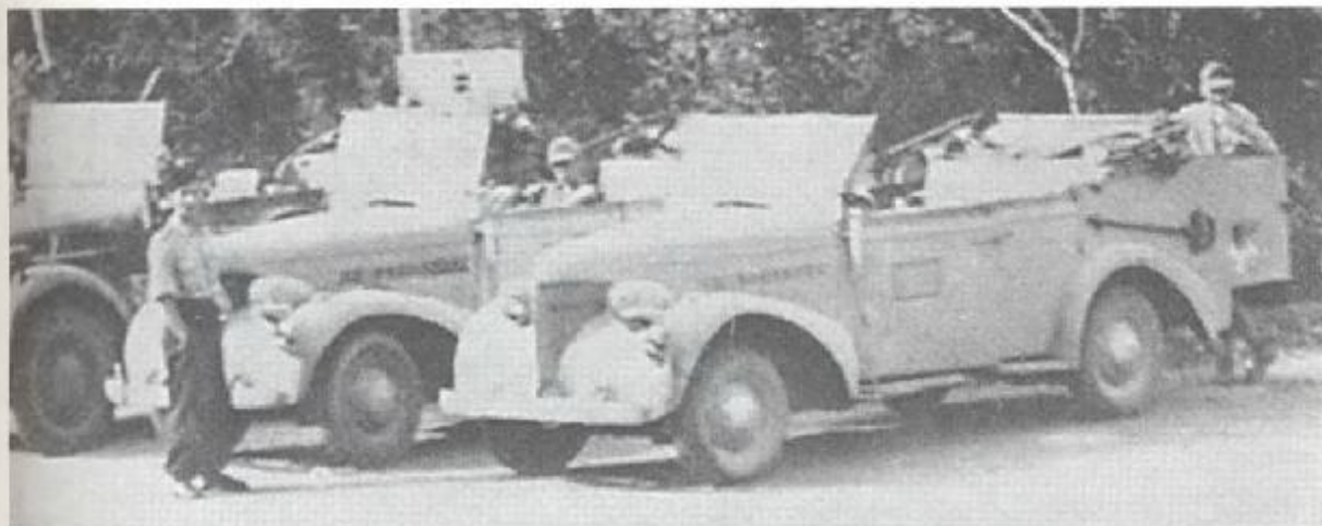
На Балканах, а также и в других местах трофейные четырехдверные лимузины (с кузовом седан) марки «Шевроле» (Chevrolet) были переоборудованы в открытые машины категории Kfz. 15 с ящиками для оборудования и продолжали использоваться на месте. На фото: Греция, 1945 г.
