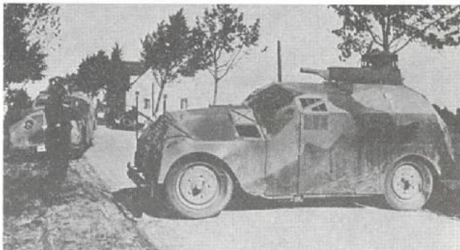
Макет танка на шасси «Гано- маг», 2/10 л. с. (1927 год)
