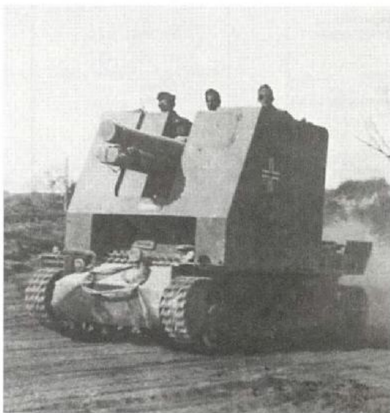
Тяжелое 150-мм пехотное орудие 15cm sIG33 на шасси танка Pz IV.
