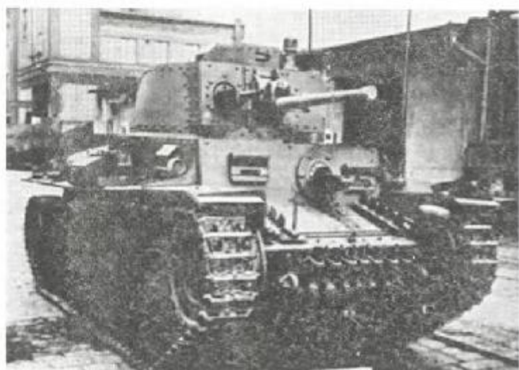
Танк Pz 38 (t). Новая машина для вермахта, впереди слева на машине видна фара со светомаскировочным устройством.
