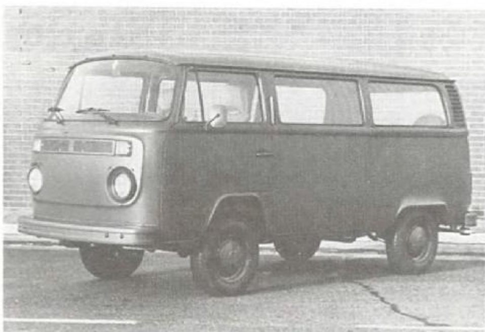
Восьмиместный легковой авто- мобиль «Фольксваген» тип 2 с кузовом универсал 1,6 л Модель с 1972 по 1979 гг.
