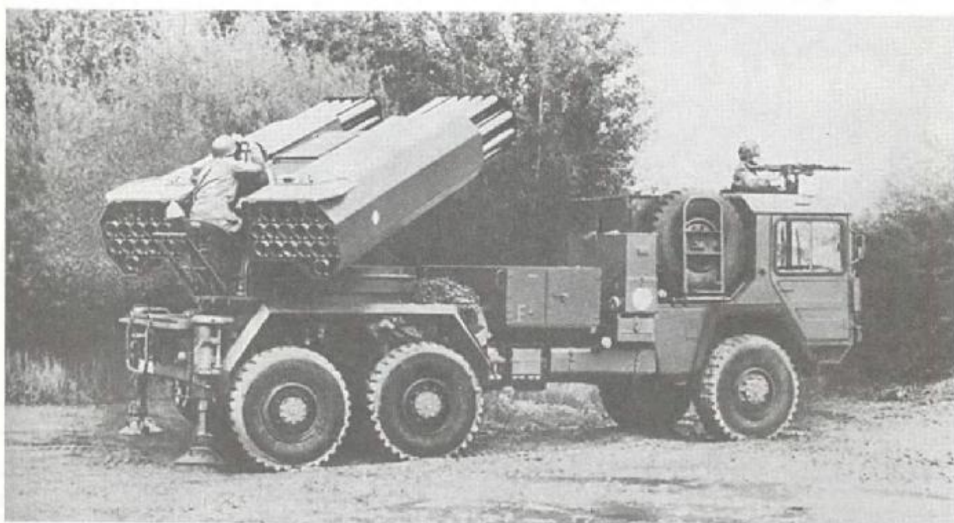
Грузовой автомобиль повышенной проходимости 7 т в качестве самоходного лафета для РСЗО 110 (LARS-2)
