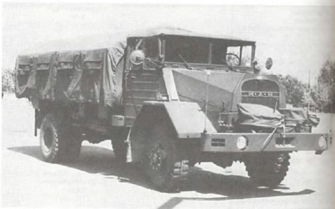
Грузовой автомобиль повышенной проходимости 5 т MAN 630 L 2 A с лебедкой. Сдвоенные шины на задних колесах
