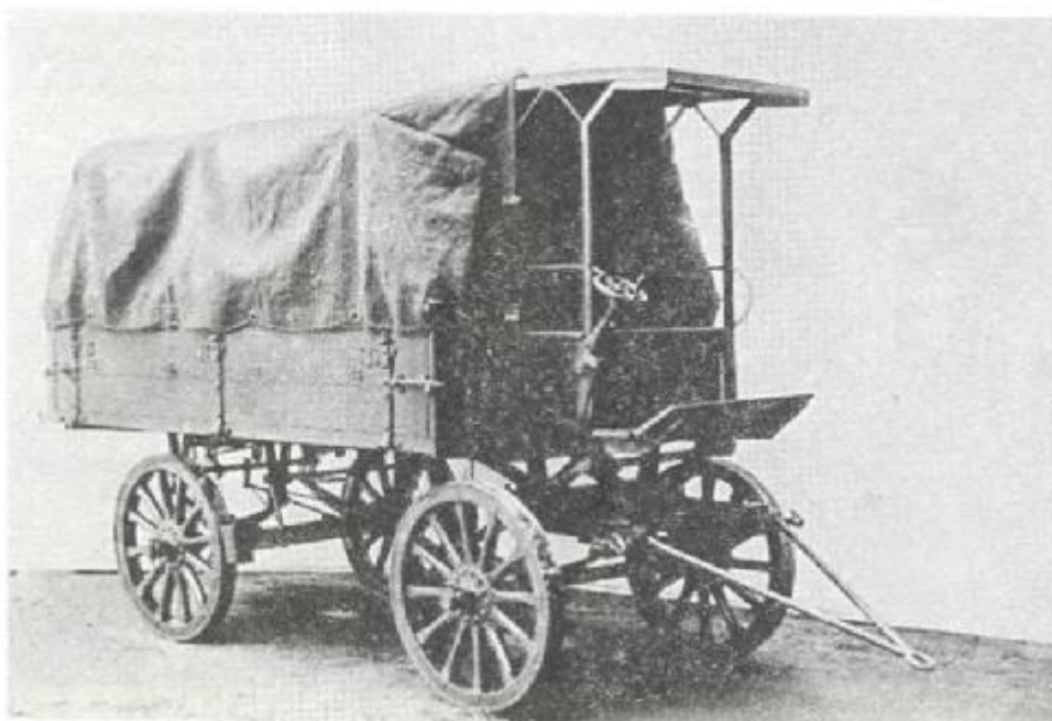
Прицеп с местом для водителя и брезентом («Магирус»)
