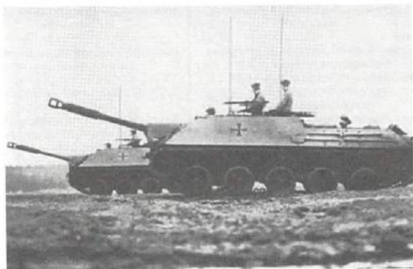
Пушечный истребитель танков (пушка 90 мм) 1966–1967 гг.
