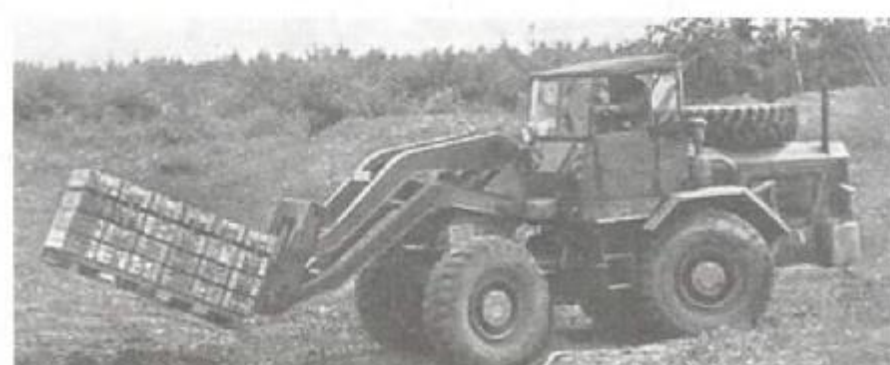
Из-за своего разностороннего применения довольно высоко ценится в бундесвере машина для полевых работ, называвшаяся прежде полевой машиной для перевалочных работ. Речь идет о погрузчике с поворотной стрелой SL 225 фирмы «Гатра» (Любек). Погрузчик поступил в бундесвер в 1961 г. Было приобретено около 300 машин. Для привода погрузчика служит дизель «Дойц» мощностью 130 л. с. с воздушным охлаждением. Погрузчик с поворотной стрелой весит более 14 т, он развивает усилие подъема 4 т и толкающее усилие в 11 т. Полный привод, рулевое управление всеми колесами, скорость 55 км/ч. На неровных дорогах, особенно на старых автобанах, во время движения машину раскачивает, и раскачивание это может достигать угрожающих размеров. Поэтому при длительных маршах погрузчик по возможности стараются перевозить на низкорамном прицепе.
