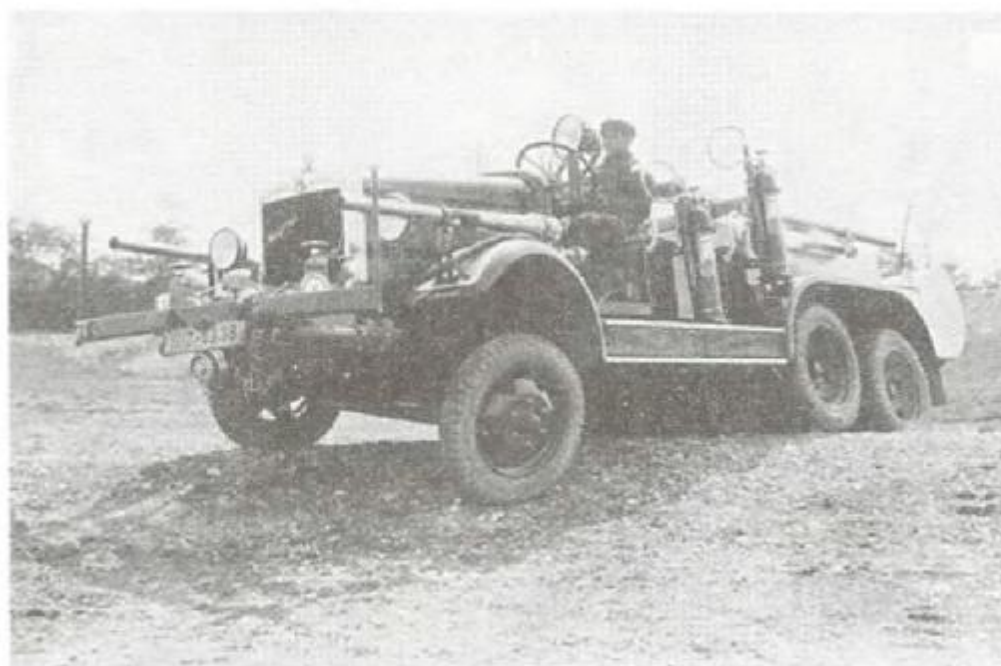
Первый германский аэродромный пожарный автомобиль: «Магирус» М 206 (с дизелем) в качестве автомобиля-топливозаправщика. Транспортно-летная школа в Нойгаузене.
