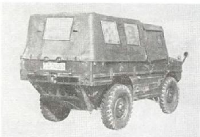
Грузовой автомобиль повышенной проходимости, обладающий плавучестью, грузоподъемность 0,5 т, прототип 1971 г., разработка на трехсторонней основе группой фирм: «Гочкисс», «Лянча», «Бюссинг»
