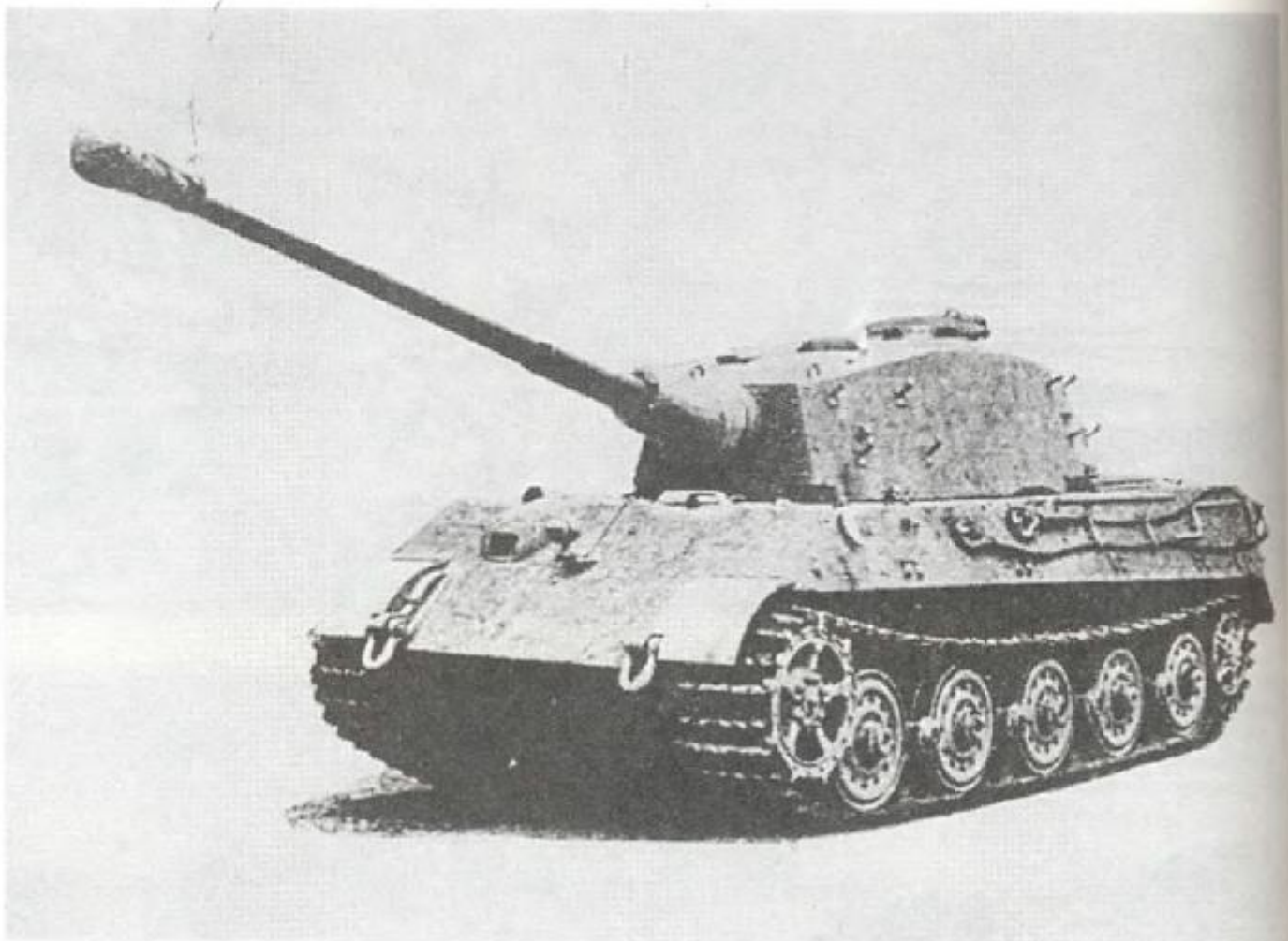
Танк «Королевский Тигр» («Тигр II» модификации В) с орудием KwK 43 L/71 и с башней производства фирмы «Хеншель».
