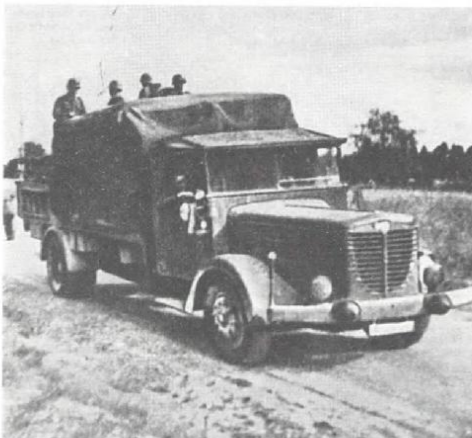
«Бюссинг-NAG» из далеких предвоенных времен, переоборудованный как грузовой автомобиль с бортовой платформой с типовой кабиной водителя. На двух нижних снимках изображен «Бюссинг-NAG» тип 4500 А-1 (Модель 1942/43 гг.).
