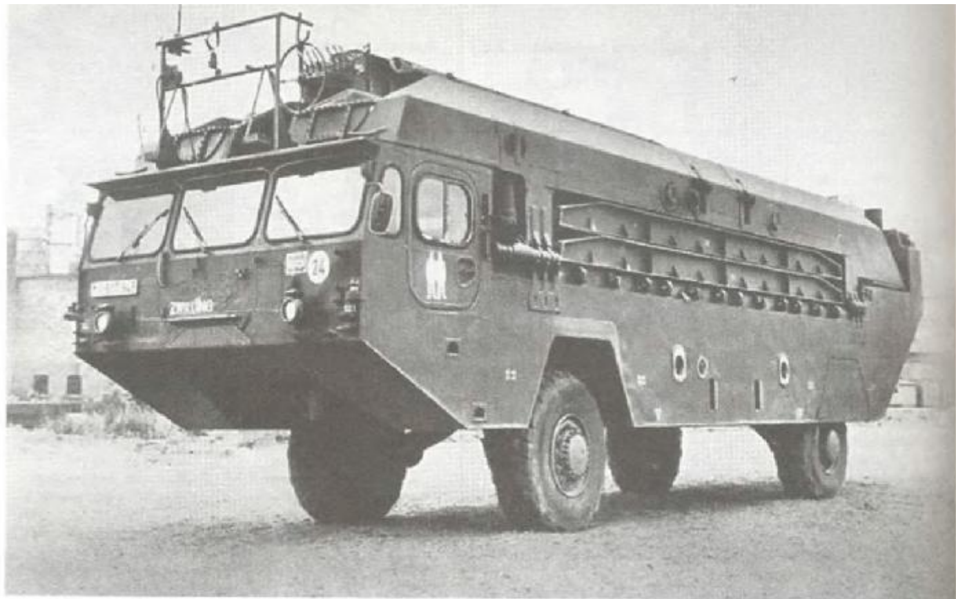
Автомобиль-амфибия модели М-2 для наводки мостов и переправ
