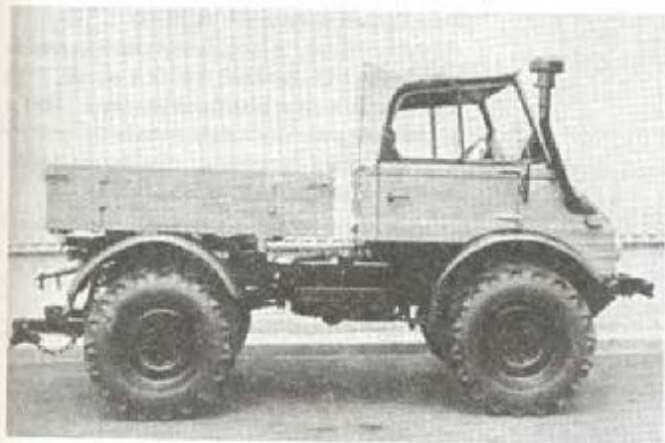
Фото сверху слева: легкий тягач «Мерседес-Бенц Унимог» U 600. Дизельный двигатель 52 л. с., 6-ступенчатая коробка передач, полный привод, вес 2850 кг.
