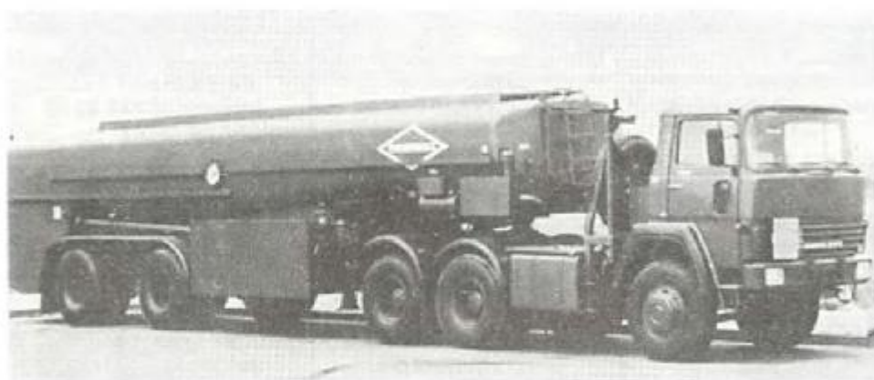
Аэродромная автоцистерна 24 000 л. «Магирус» 6 x 4 + 4 x 0. Автопо- езд в составе седельного тяга- ча с полуприцепом и прицепа (цистерны)
