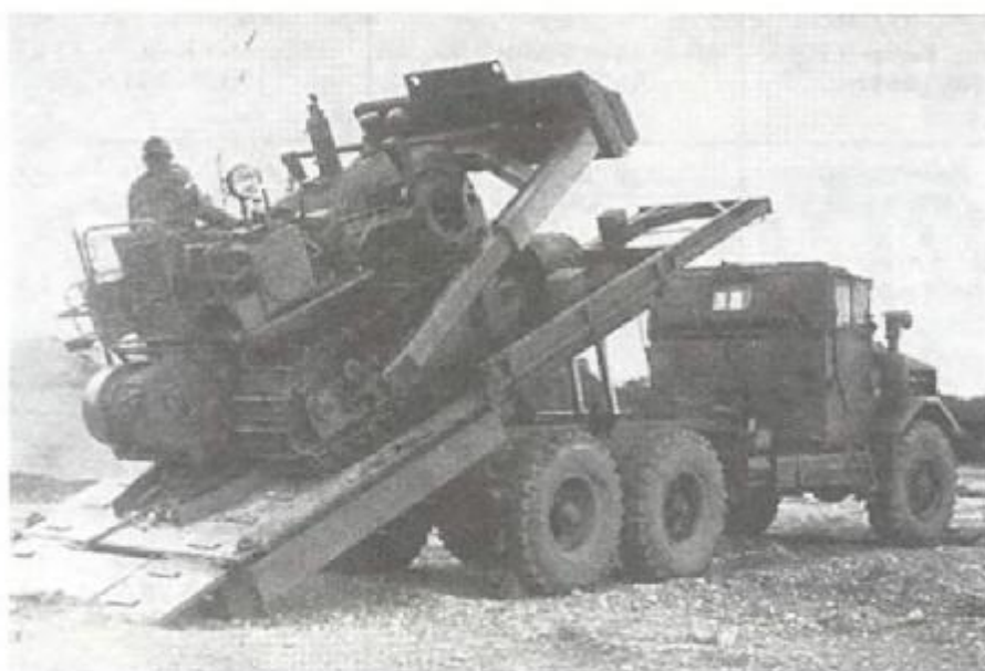
Легкий бульдозер 60 л. с. на самоходном шасси со спускаемой на дорожное полотно платформой.
