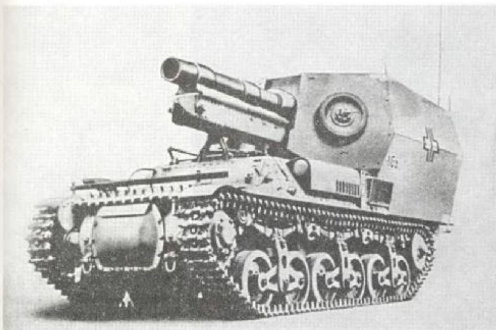
150-мм тяжелая полевая гаубица 13 на гусеничном шасси тягача «Лоррэн» (Франция)
