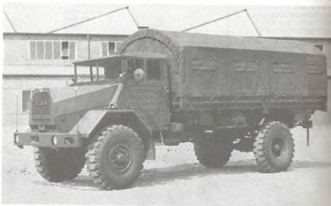
Грузовой автомобиль повышенной проходимости 5 т MAN 630 L 2 AE. Все колеса с одинарными шинами
