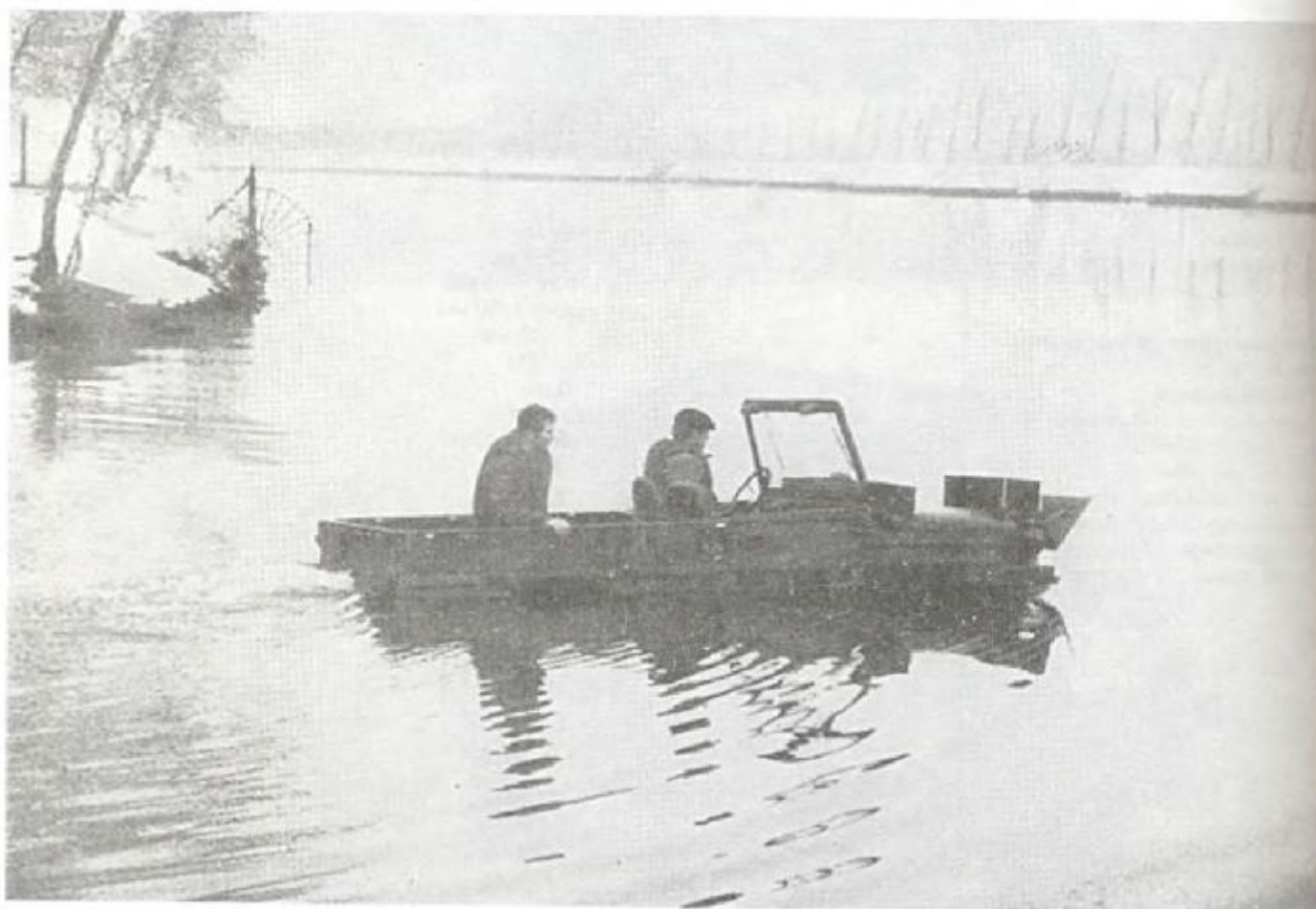
Грузовой автомобиль повышенной проходимости, обладающий плавучестью, грузоподъемность 0,5 т, прототип 1971 г., разработка на трехсторонней основе группой фирм: «Гочкисс», «Лянча», «Бюссинг»
