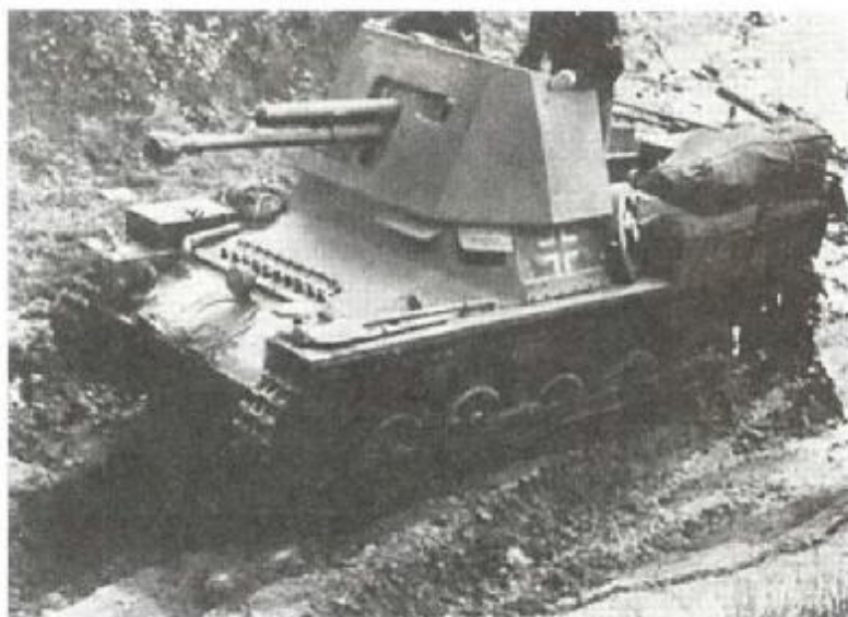
Противотанковое орудие (чешское) калибра 47 мм на шасси танка Pz IV
