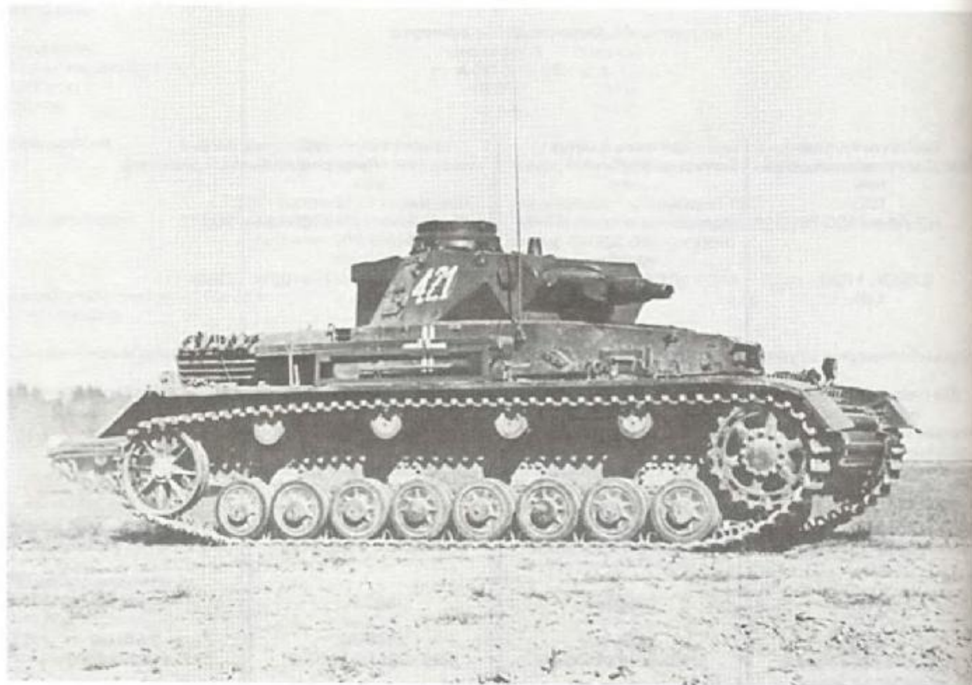
Танк Pz IV В с короткой пушкой калибра 75 мм
