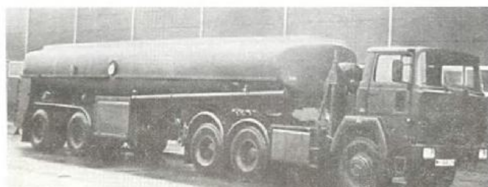
Поливо-моечная машина 30 000 л. «Магирус» 6 x 4 + 4 x 0. Автопо- езд в составе седельного тяга- ча с полуприцепом и прицепа (цистерны)
