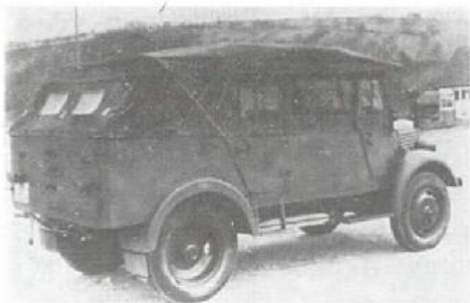
«Мерседес-Бенц» тип L 1500 A (1941–1943 гг.) Автомобиль для перевозки войск (1 + 6 человек).
