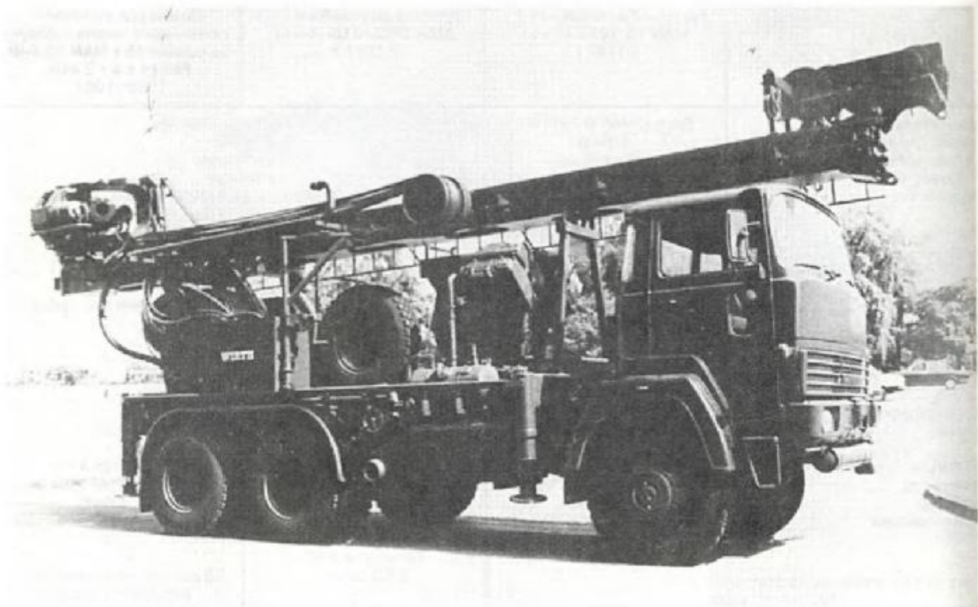
С помощью буровой установки В 3 А, установленной на автомобиле «Магирус-Дойц» (6 х 6), саперы могут во всех горных породах бурить скважины глубиной до 25 м.
