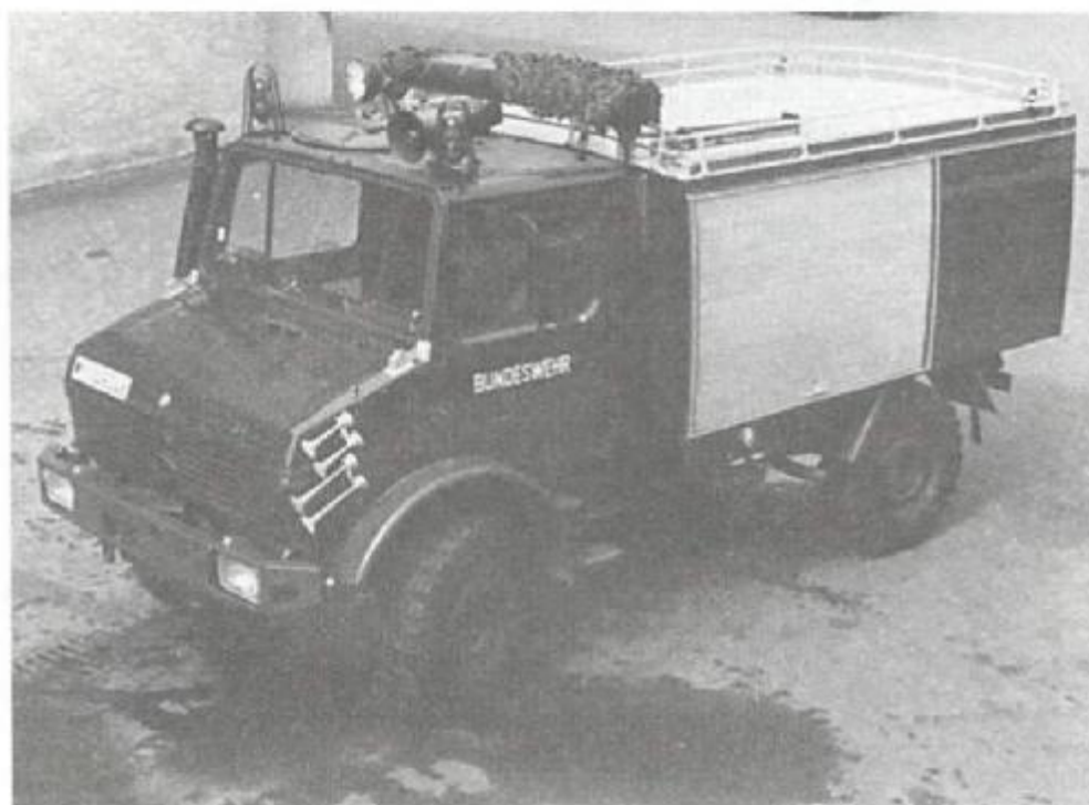
Грузовой автомобиль повышенной проходимости 2 т «Унимог» 1300 L. Пожарный автомобиль 1000. Кузов фирмы «Мец»
