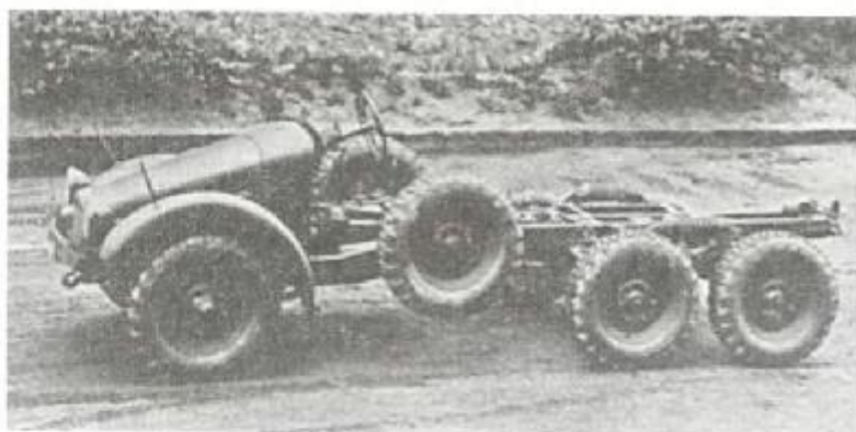
Вполне прогрессивное для своего времени шасси «Крупп» L2 Н 143
