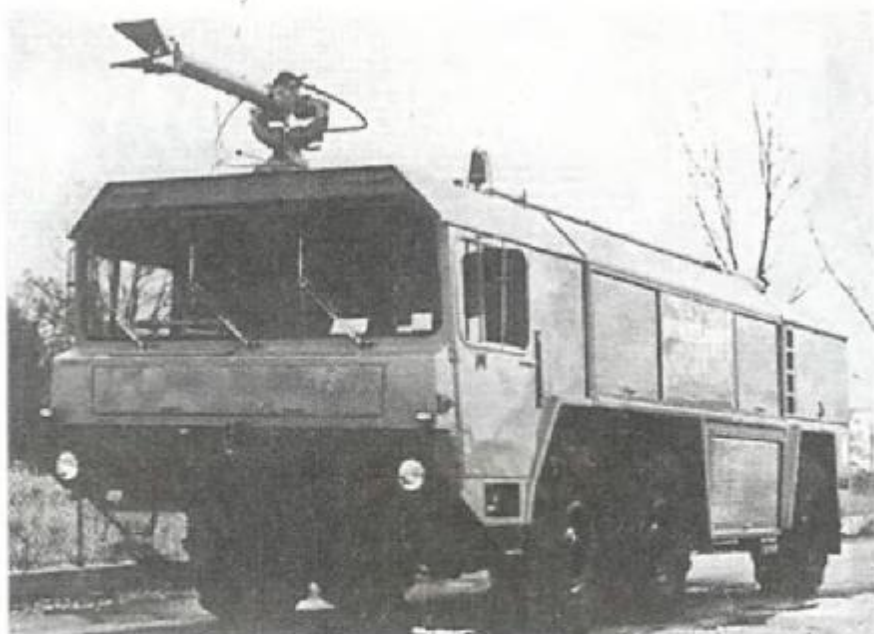
Пожарный автомобиль 3500 «Фаун» 6 х 4, с воздухоохлаждаемым дизелем ВО «Дойц». 3500 л воды, 750 кг порошка для пожаротушения, 400 л средства для пенообразования. Кузов и оборудование: «Рабочее сообщество Бахерт/Циглер».
