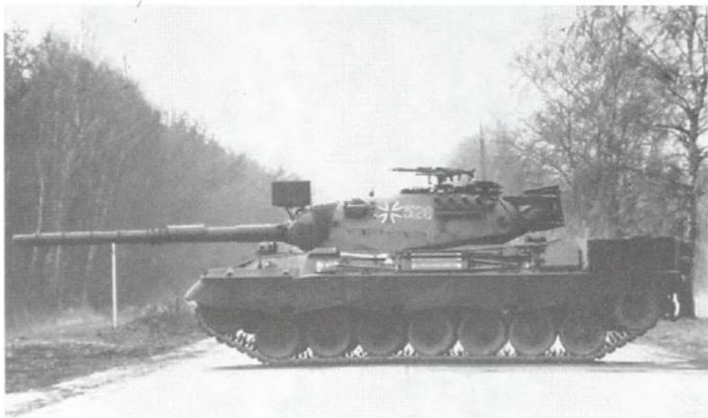
Основной боевой танк «Леопард 1 А 1». Переоборудование 1972–1974 гг. (фартуки, заключение ствола в кожух)
