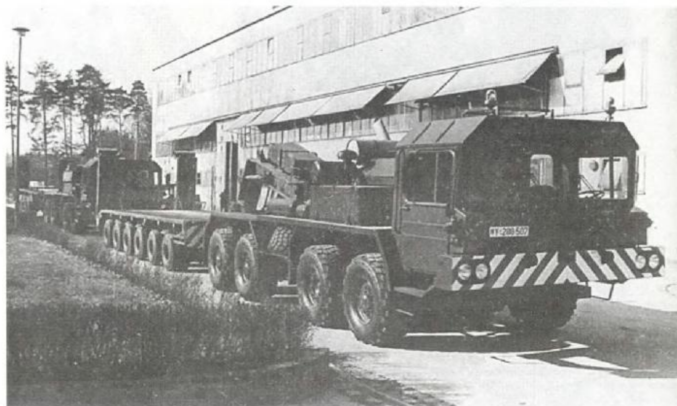
Тяжелый автопоезд 55 т с тягачом «Фаун» (8 х 6), дизель ВО с ТН «Дойц» 525 л. с., а также 12-колесным прицепом (колеса со сдвоенными шинами), хотя и выглядит похожим на автомобиль-тяжеловоз «Слон», однако технически он выполнен значительно более просто, а потому соответственно и более дешевый.
