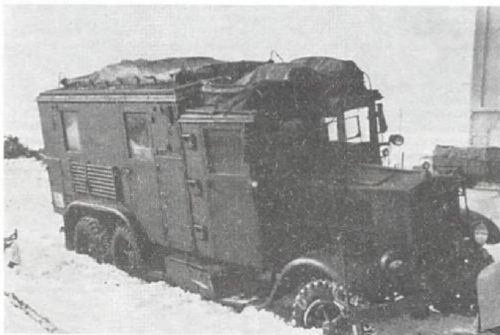
«Мерседес-Бенц» LG 3000 – средний грузовой автомобиль повышенной проходимости грузоподъемностью 3 т (1935–1936 гг.).
