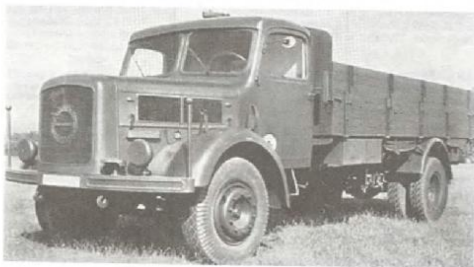
Грузовой автомобиль «Клёкнер-Дойц-Магирус» GS 145 поставлялся вначале главным образом в имперскую трудовую повинность, а затем использовался в вермахте. Эта модель была продукцией совместного производства сотрудничавших в Бюро унификации во Франкфурте фирм «Магирус», «Хеншель» и «Заурер».
