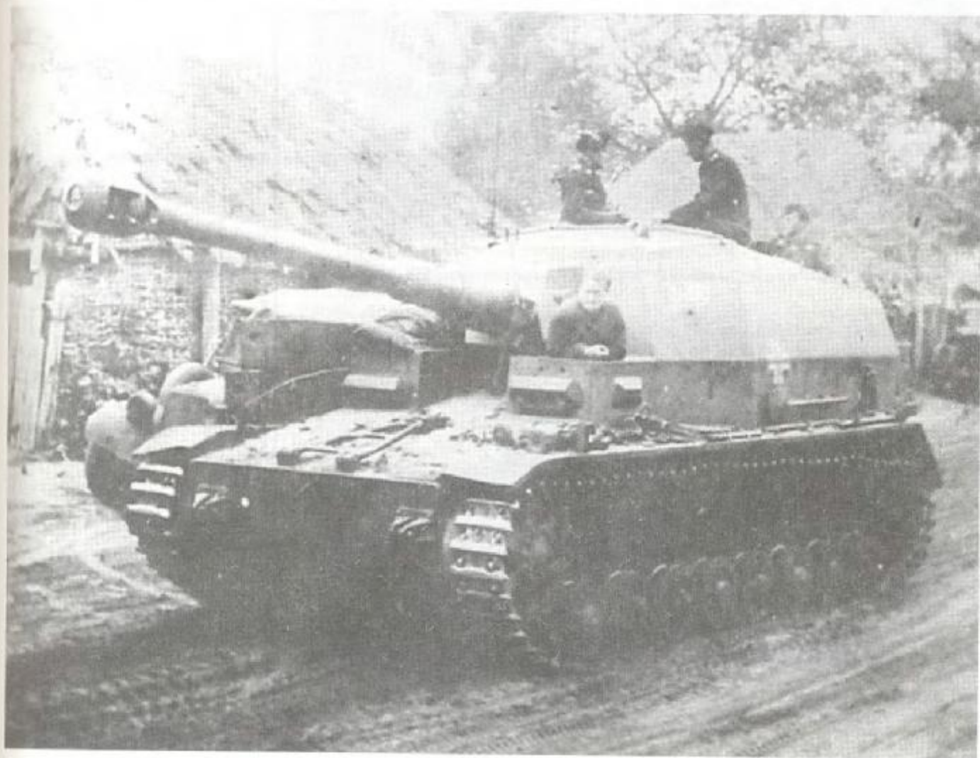
105-мм орудие на танковом шасси IVa (изготовлено только в двух экземплярах)
