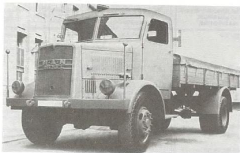
Автомобиль MAN L 4500 A, выпускался с 1940 по 1944 г. Грузоподъемность 4,5 т, с приводом на все колеса. Отличался солидностью и необычайной надежностью.
