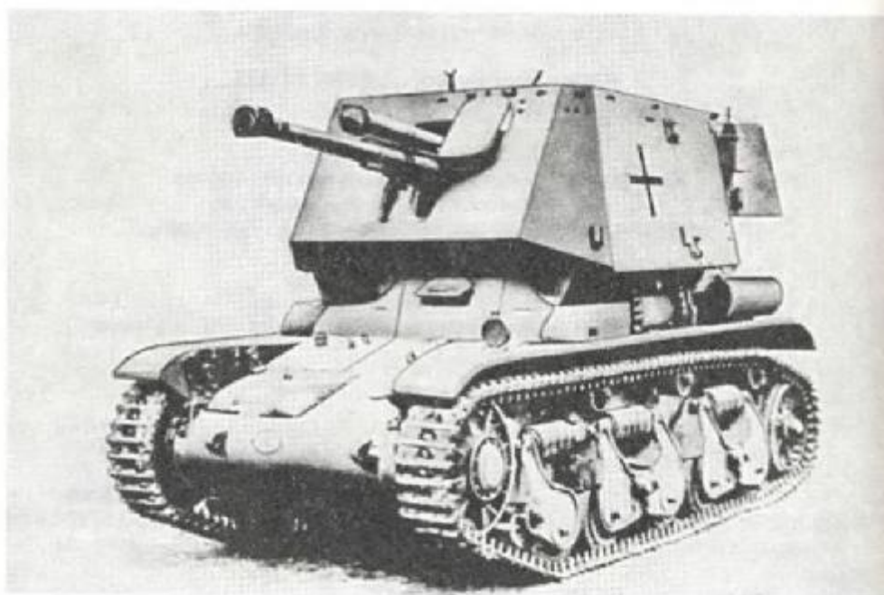
47-мм пушка 4,7 cm Pак (f) на шасси танка «Рено» R 35 (Франция)
