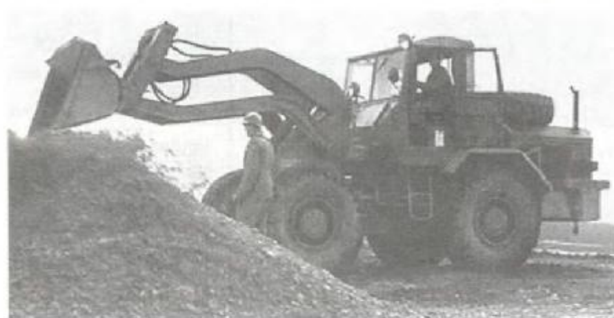
Из-за своего разностороннего применения довольно высоко ценится в бундесвере машина для полевых работ, называвшаяся прежде полевой машиной для перевалочных работ. Речь идет о погрузчике с поворотной стрелой SL 225 фирмы «Гатра» (Любек). Погрузчик поступил в бундесвер в 1961 г. Было приобретено около 300 машин. Для привода погрузчика служит дизель «Дойц» мощностью 130 л. с. с воздушным охлаждением. Погрузчик с поворотной стрелой весит более 14 т, он развивает усилие подъема 4 т и толкающее усилие в 11 т. Полный привод, рулевое управление всеми колесами, скорость 55 км/ч. На неровных дорогах, особенно на старых автобанах, во время движения машину раскачивает, и раскачивание это может достигать угрожающих размеров. Поэтому при длительных маршах погрузчик по возможности стараются перевозить на низкорамном прицепе.
