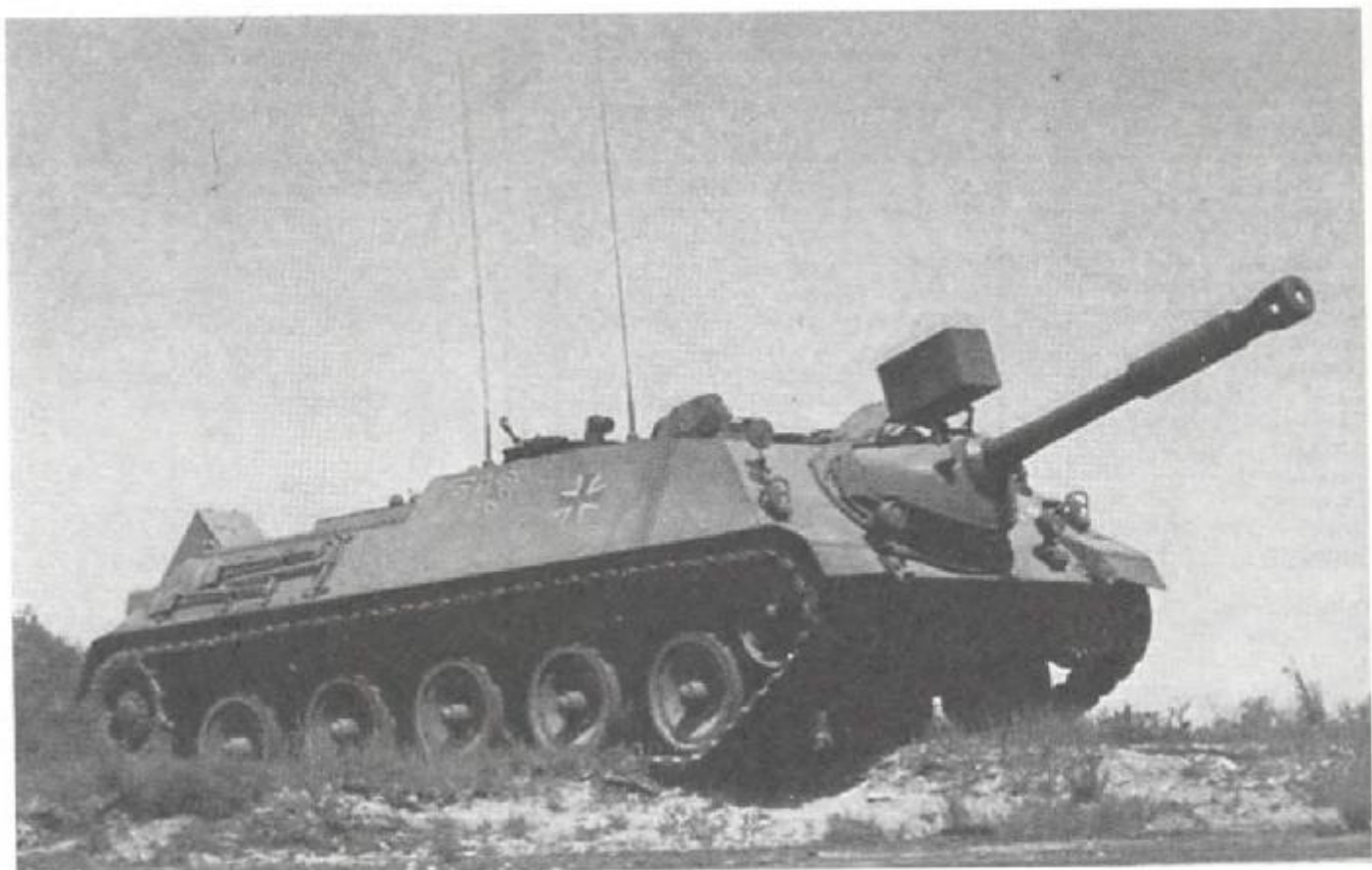
Пушечный истребитель танков (пушка 90 мм) 1966–1967 гг.
