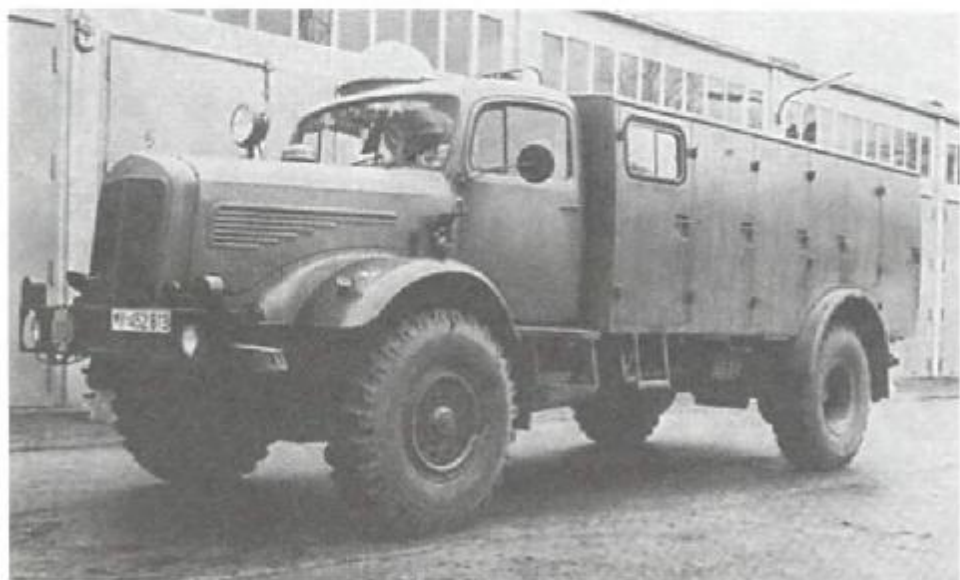
«Мерседес-Бенц» LG 315/46 в качестве пожарного автомобиля на 2400 л воды в составе бундесвера. Кузов и оснащение изготовили фирмы «Мец» или «Бахерт». Бак на 2400 л воды, пожарный насос 1600 л/мин, экипаж 5 человек. Внешне почти аналогичной конструкции был также пожарный автомобиль на 1500 кг порошка для пожаротушения.
