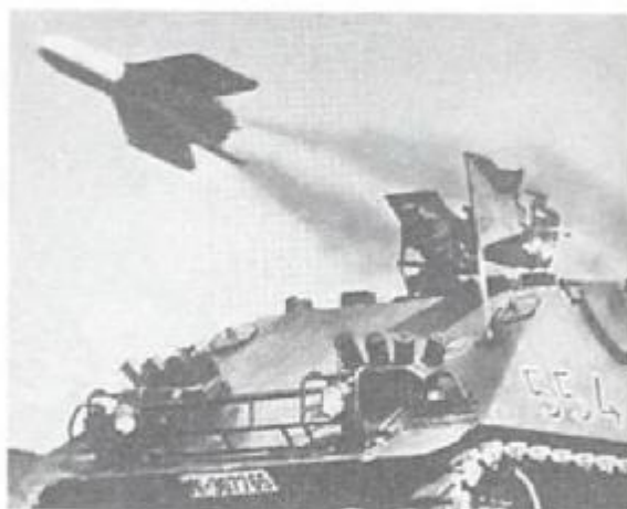
Ракетный истребитель танков HS 30 в момент пуска противотанковой управляемой ракеты SS-11.
