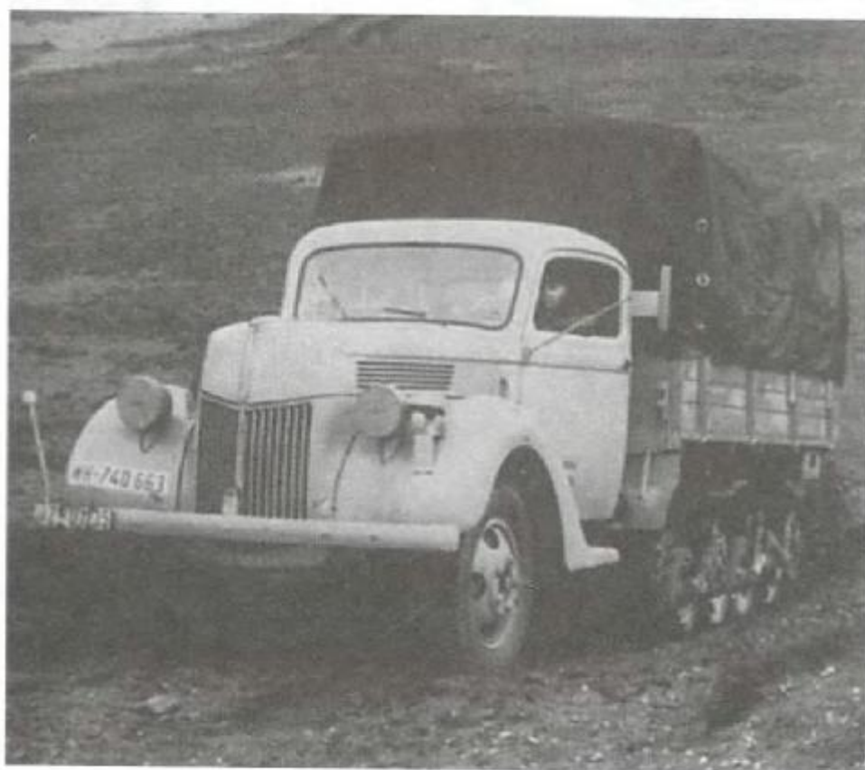
Грузовой автомобиль на гусеничном ходу «Мул» в качестве автомобиля с бортовой платформой и как санитарная машина.
