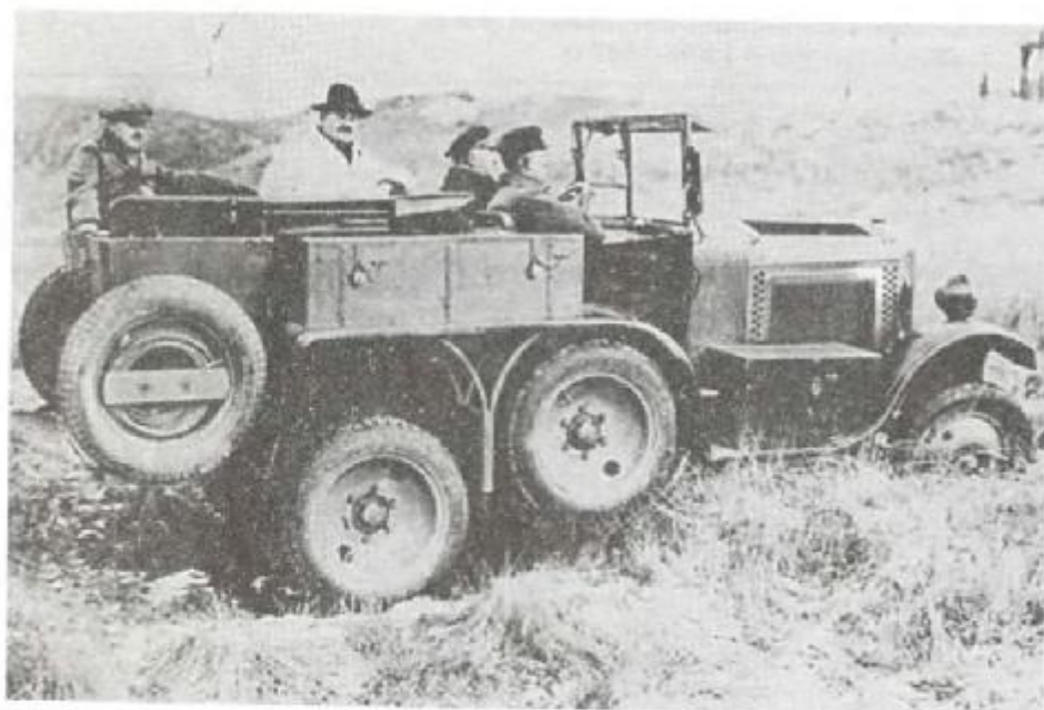
«Хорх 8» тип 40, автомобиль повышенной проходимости, прототип 1926 г.
