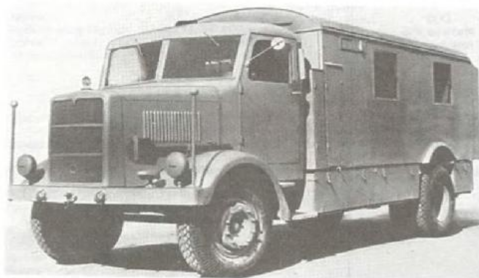
Автомобиль MAN L 4500 S (1943 г.) в качестве автомашины-мастерской или для запасных частей с отделением для размещения команды.
