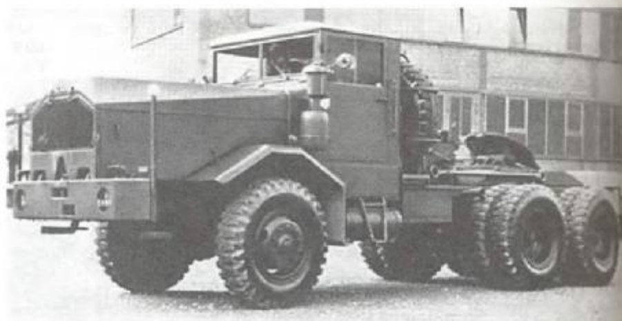
«Фаун» L 912/45 А был тяжелым грузовым автомобилем на 15 т груза, оснащенным дизелем V 12 системы «Дойц».
