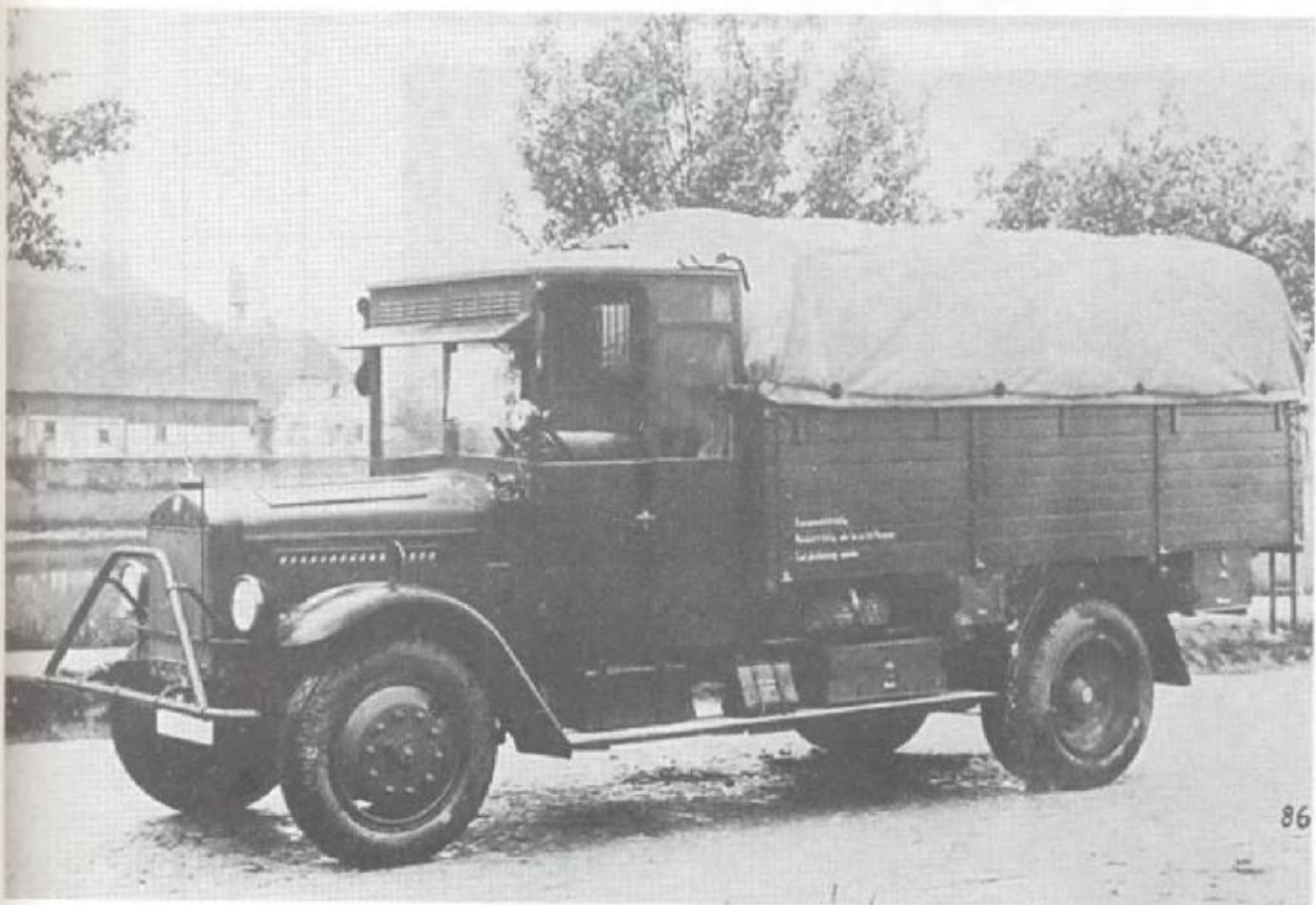
Командный автомобиль райхсвера «Мерседес-Бенц» тип L 3000, грузоподъемность 3 т.
