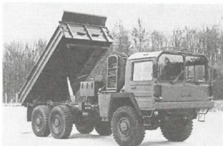
Грузовой автомобиль повышенной проходимости 7 т (6 x 6) MAN N 4530 Самосвал с трехсторонней разгрузкой с 1977 г.
