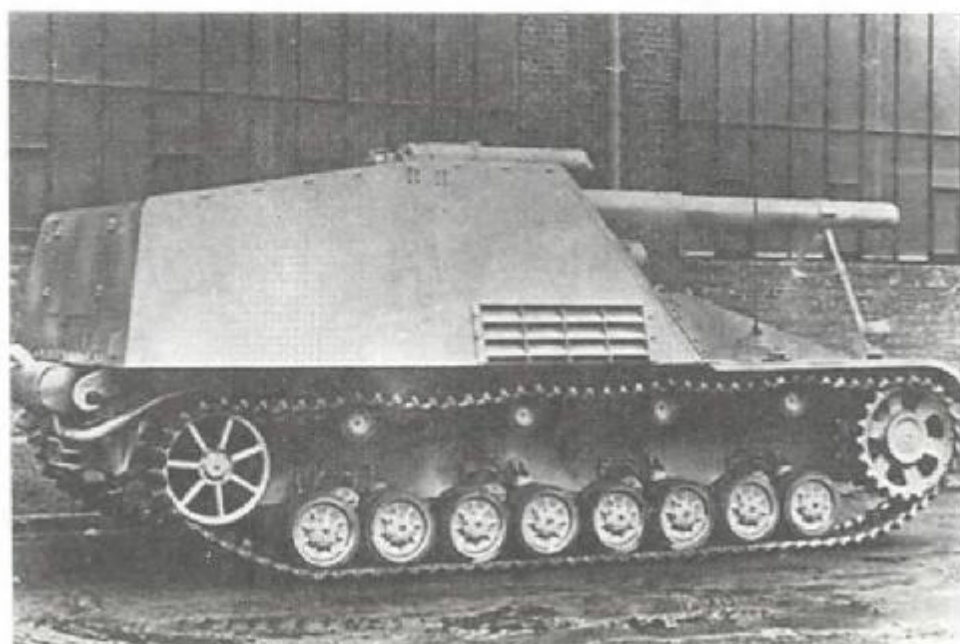
«Гуммель» 150-мм гаубица на шасси III/IV. Главное оружие в артиллерий- ских полках.
