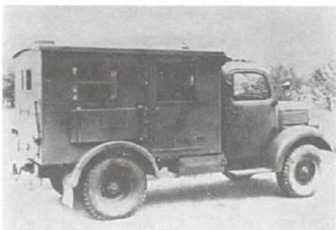
«Мерседес-Бенц» тип L 1500 A с кузовом для радиооборудования
