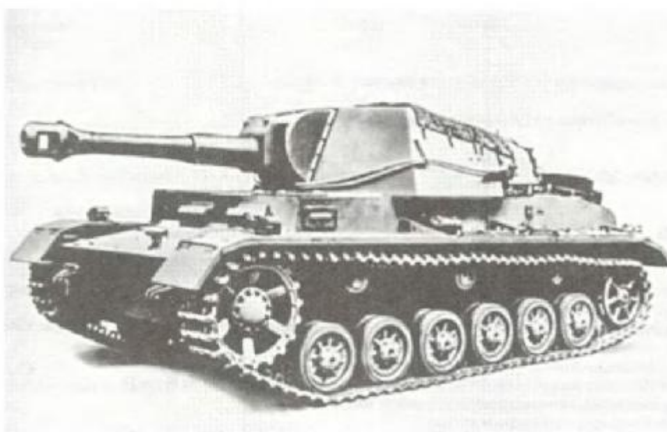
105-мм легкая полевая гаубица 10,5cm le. F.H 18/1 на шасси Gw. IVb (изготовлено 8 единиц)
