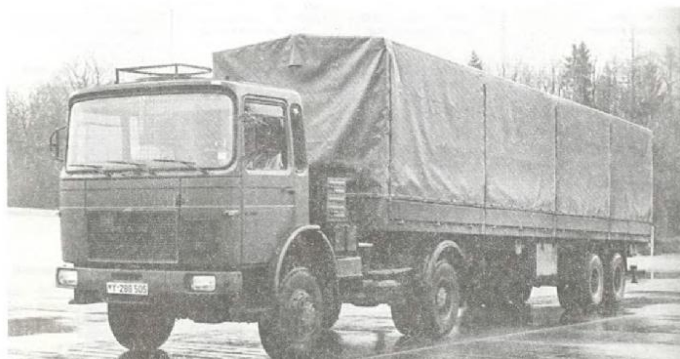
Автопоезд в составе седельного тягача с полуприцепом 15 т (4 x 4 + 2 x 0) MAN 15.240 FAS. Седельный тягач и полуприцеп с бортовой платформой
