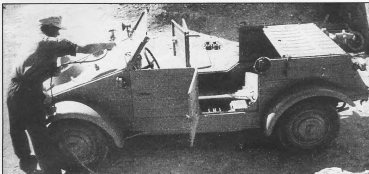
VW 82 во время камуфлирования. Краска наносится при помощи пульверизатора. Поскольку с автомобиля сняты брезентовая крыша и сиденья, можно рассмотреть любопытные детали, например держатели винтов. Южная Италия, весна 1944 года.
