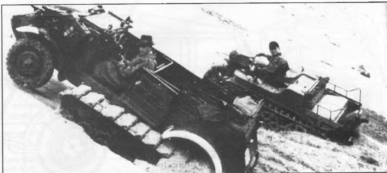
Полугусеничный кюбельваген Тип 155 во время сравнительных испытаний с NSU Kettenkrad, начало 1943 года, Шварцвальде.
