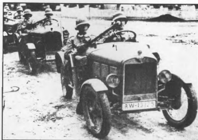
Один из первых автомобилей рейхсвера - BMW Dixi 3/15. В 1928-30 годах рейхсвер закупил почти 300 этих легких автомобилей, приводившихся в движение 4-цилиндровым мотором рабочим объемом 743 см 3 и мощностью 15 л.с.
