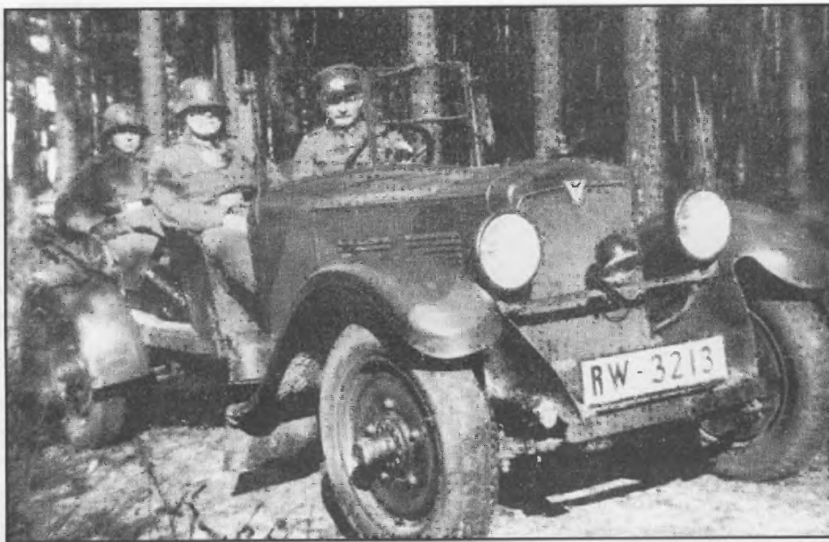
Adler Favorit, один из первых автомобилей класса кубельваген, выпускавшийся в 1929-1932 годах. Хорошо видны характерные сиденья, похожие на бочки.
