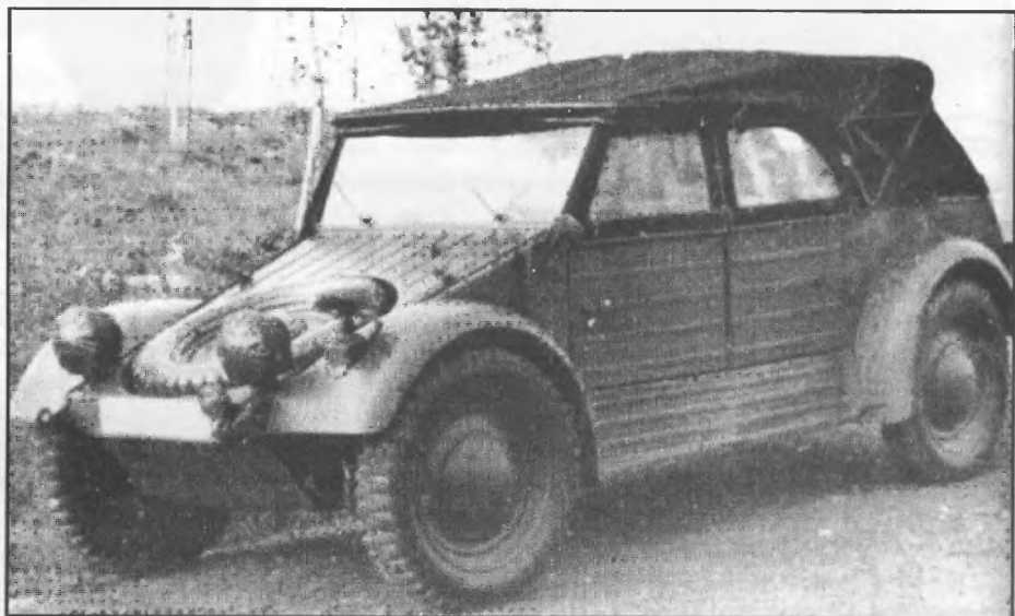
В начале 1939 года Тип 62 получил новый кузов. Этот прототип еще отличается от серийного кубельвагена двумя особенностями: маской двигателя и расположением запасного колеса.
