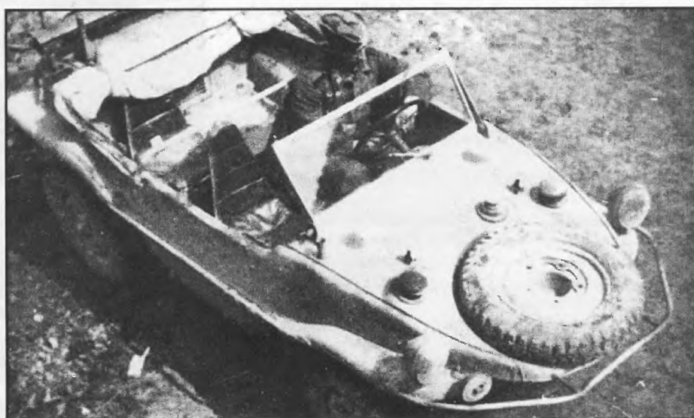
Швиммваген из разведывательной части, Румыния, весна 1944 года. Хорошо видны две горловины топливных баков (2x25 л), расположенные позади запасного колеса. По середине видна горловина маслобака.
