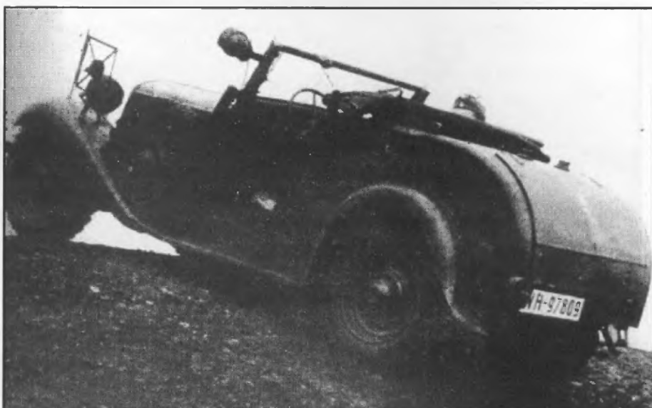
BMW 309 приводился в движение четырехцилиндровым мотором рабочим объемом 845 см 3 и мощностью 22 л.с. В 1934-1935 годах вермахт получил около 1000 таких автомобилей.
