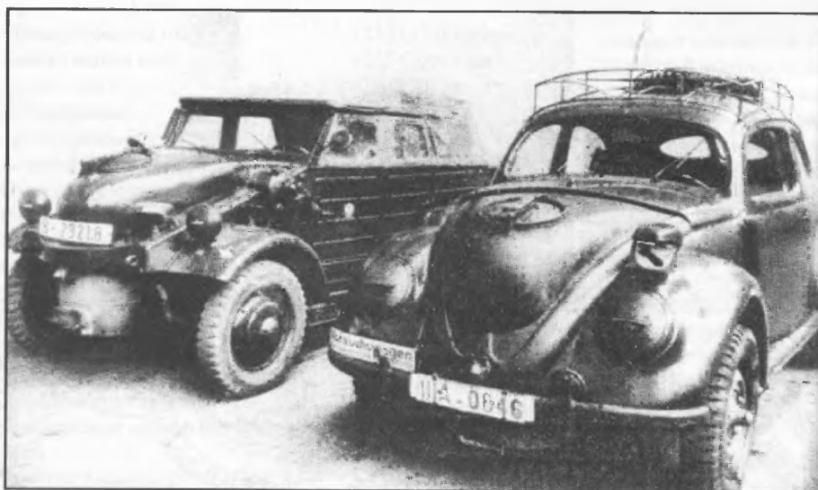
Два Фольксвагена, оснащенные газогенераторами. Обратите внимание на характерную вздутую крышку капота, под которой собственно и располагался генератор. Слева кюбельваген Тип 283, а справа внедорожный «Жук» Тип 230.
