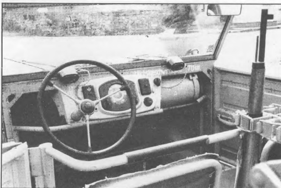
Приборная доска кубельвагена Тип 82. В центре виден спидометр, по бокам контрольные лампочки и замок зажигания. Обратите внимание на рулевое колесо с клаксоном и стойку для винтовок.
