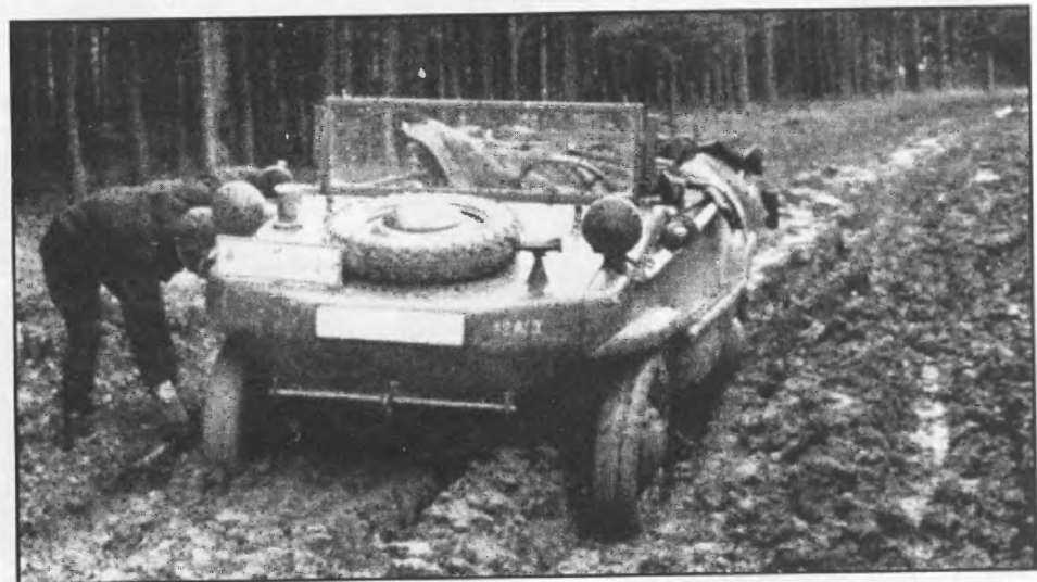
Третий прототип «длинного» Schwimmwagena Typ 128 во время испытаний на бездорожье на полигоне Вюнсдорф.
