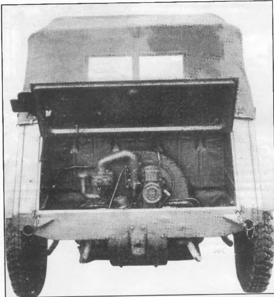
Силовое отделение. Видны: слева воздушный фильтр, подающая труба, в середине карбюратор Solex, под ним распределитель, справа расположен генератор, соединенный ремнем с валом двигателя.
