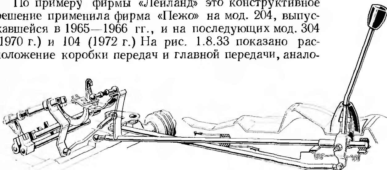
Рис. 1.8.34. При поперечном расположении коробки передач перемещения рычага переключения передач должны быть изменены на перпендикулярные, как показано на примере автомобиля «Пежо-104»
