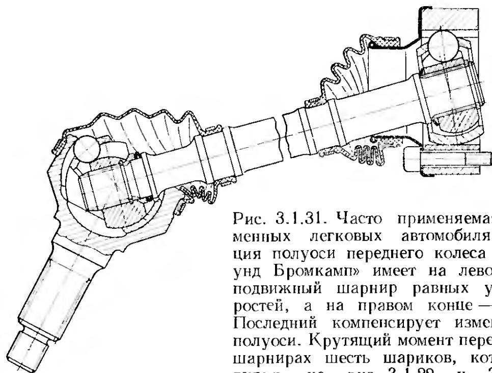
Рис. 3.1.31. Часто применяемая на современных легковых автомобилях конструкция полуоси переднего колеса фирмы «Лер унд Бромкамп» имеет на левом конце неподвижный шарнир равных угловых скоростей, а на правом конце — подвижный. Последний компенсирует изменение длины полуоси. Крутящий момент передают в обоих шарнирах шесть шариков, которые можно видеть на рис. 3.1.22 и 3.1.53—3.1.55
