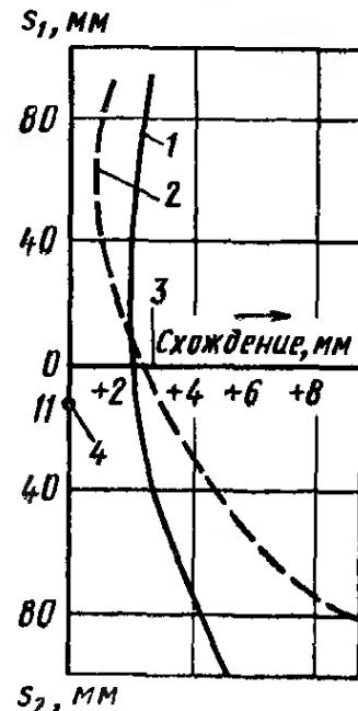
Рис. 3.10.12. Изменение схождения (для двух колес), замеренное на автомобиле «Даймлер-бенц 230» при наличии пружин в подвеске и без них (размеры указаны на рис. 3.10.6):
