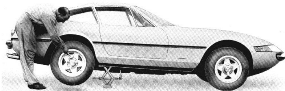
18) Sollevamento ruota posteriore con martinetto.
