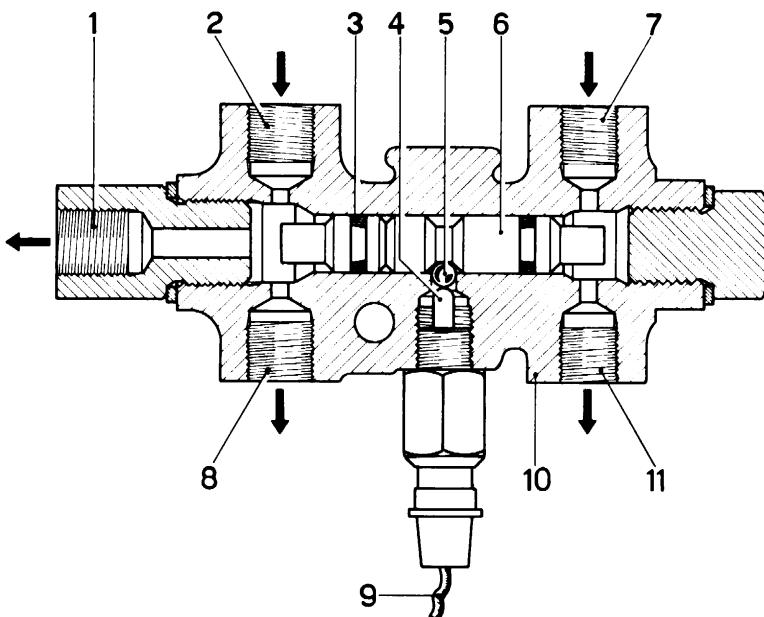
**52) Dispositivo per la segnalazione luminosa della differente pressione olio nei circuiti freno.**
