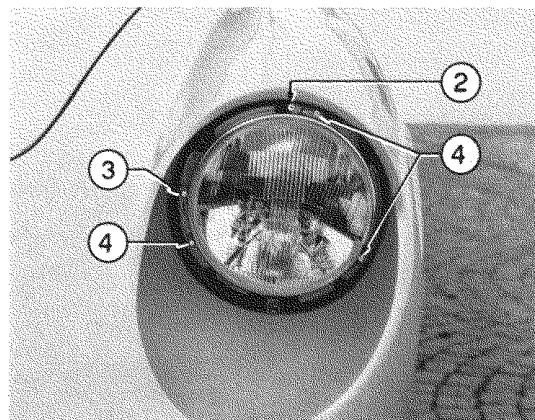
**63) Viti di orientamento e fissaggio.**
