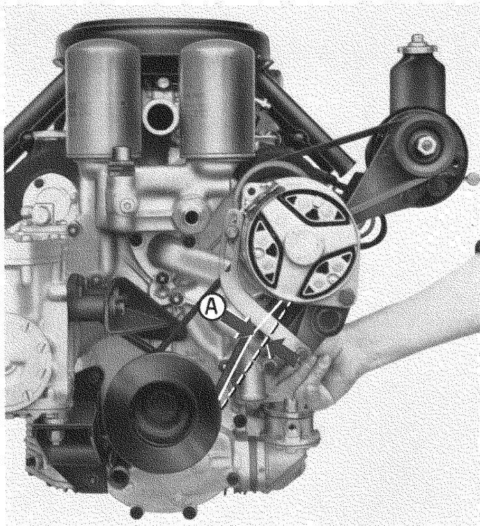
35) Controllo tensione della cinghia comando alternatore.
