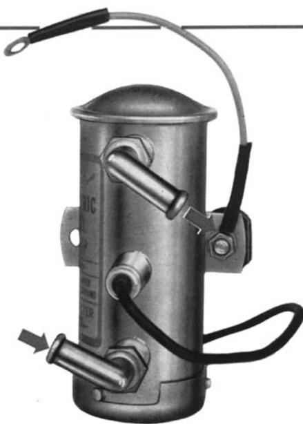
25) Pompa elettrica ausiliaria BENDIX.
