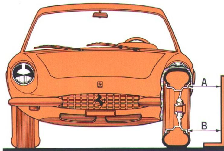
46) Controllo dell'inclinazione delle ruote posteriori.
