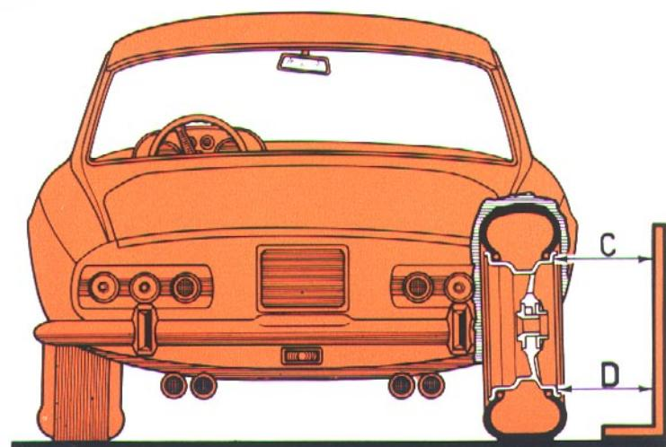
**Valori dell'inclinazione a carico statico della ruote anteriori (fig. 45) (Teorico = + 1°)**
