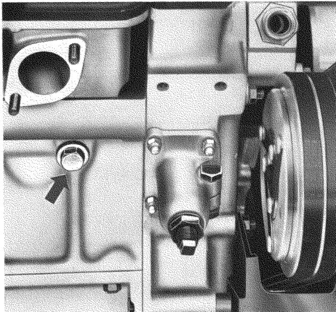
**8) Scarico acqua dal basamento.****8) Décharge eau du carter-moteur.****8) Cylinder block drain
