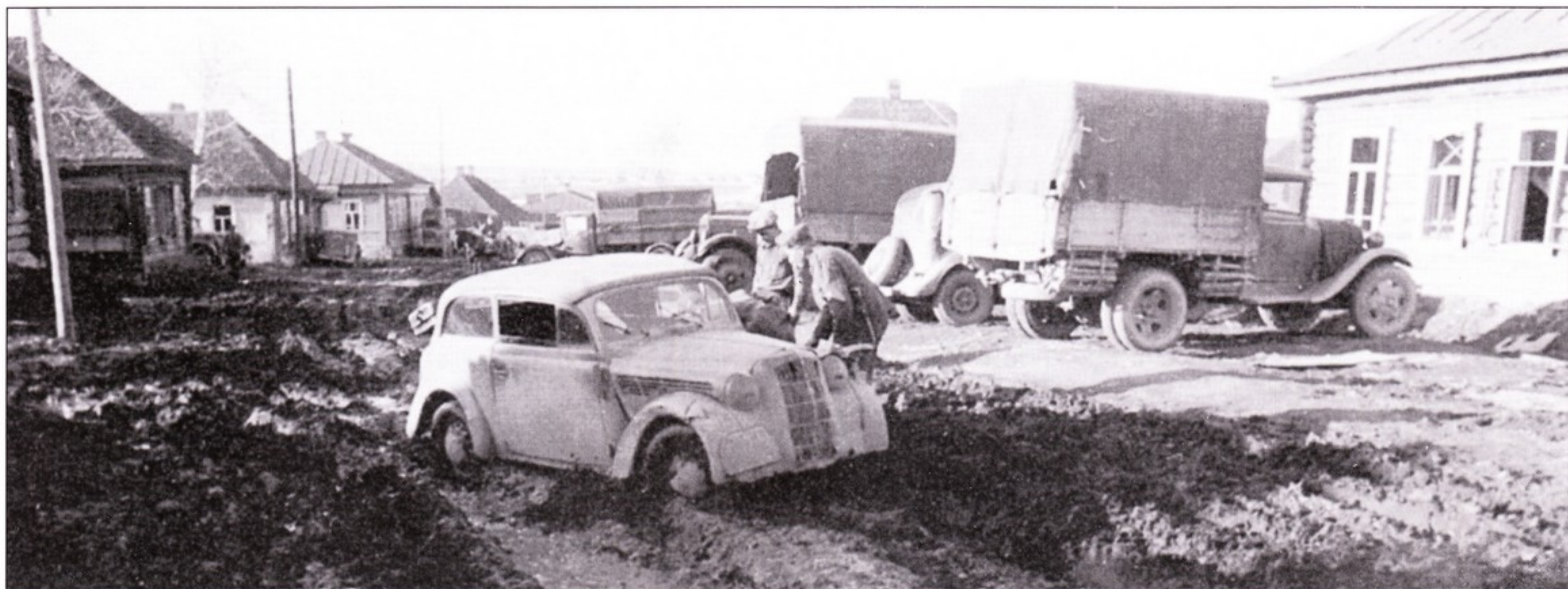
На Опеле «Кадет» стоял небольшой 4-цилиндровый мотор мощностью 23 л.с. Опелек засел на центральной улице населенного пункта Selo.
