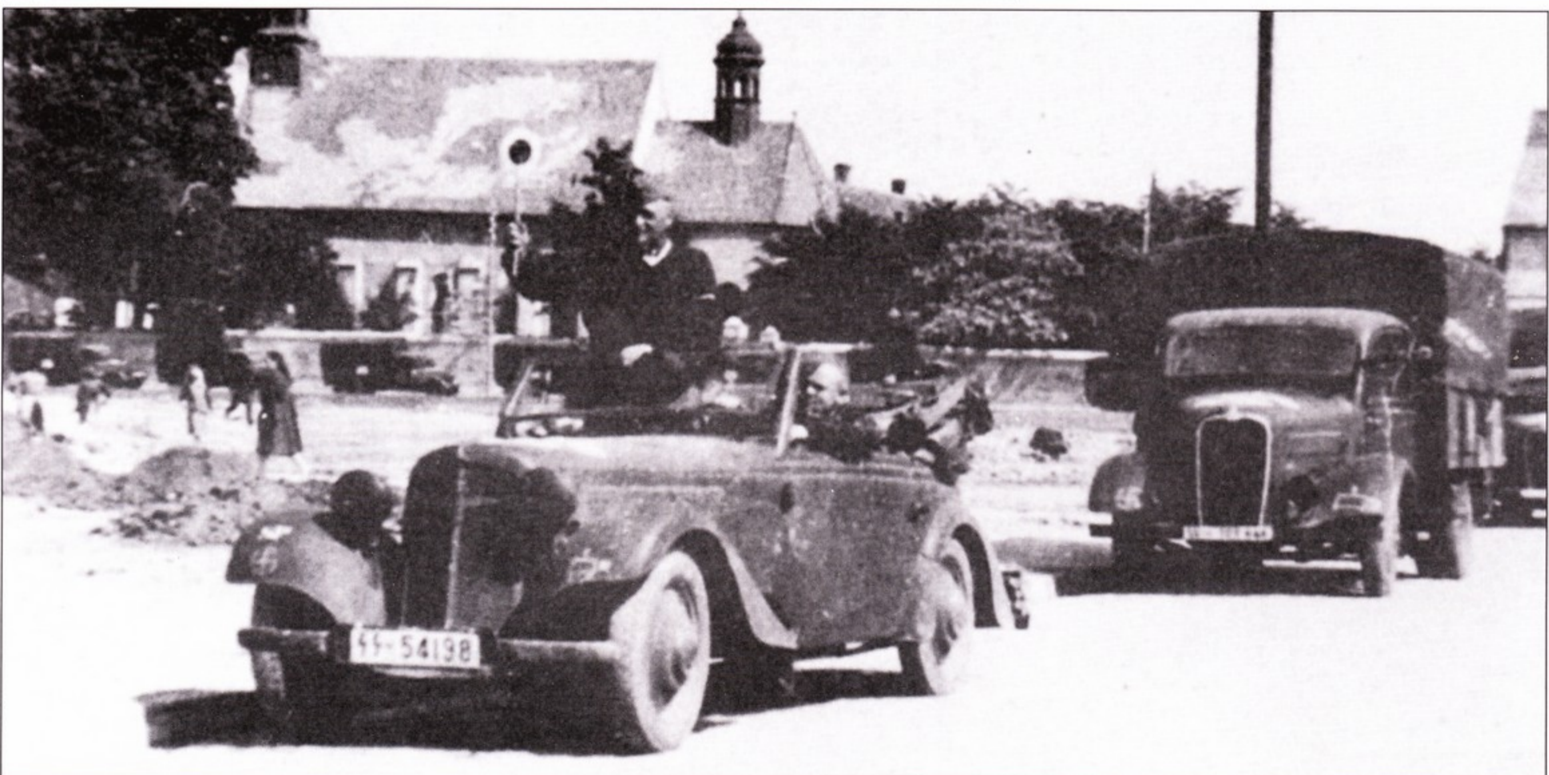
Маленький Адлер «Триумф Кабриолет» (строился с 1936 г.), оснащенный 1-литровым 4-цилиндровым мотором мощностью 25 л.с., также призвали на военную службу. На фото - машина 5-й танковой дивизии СС «Викинг».
