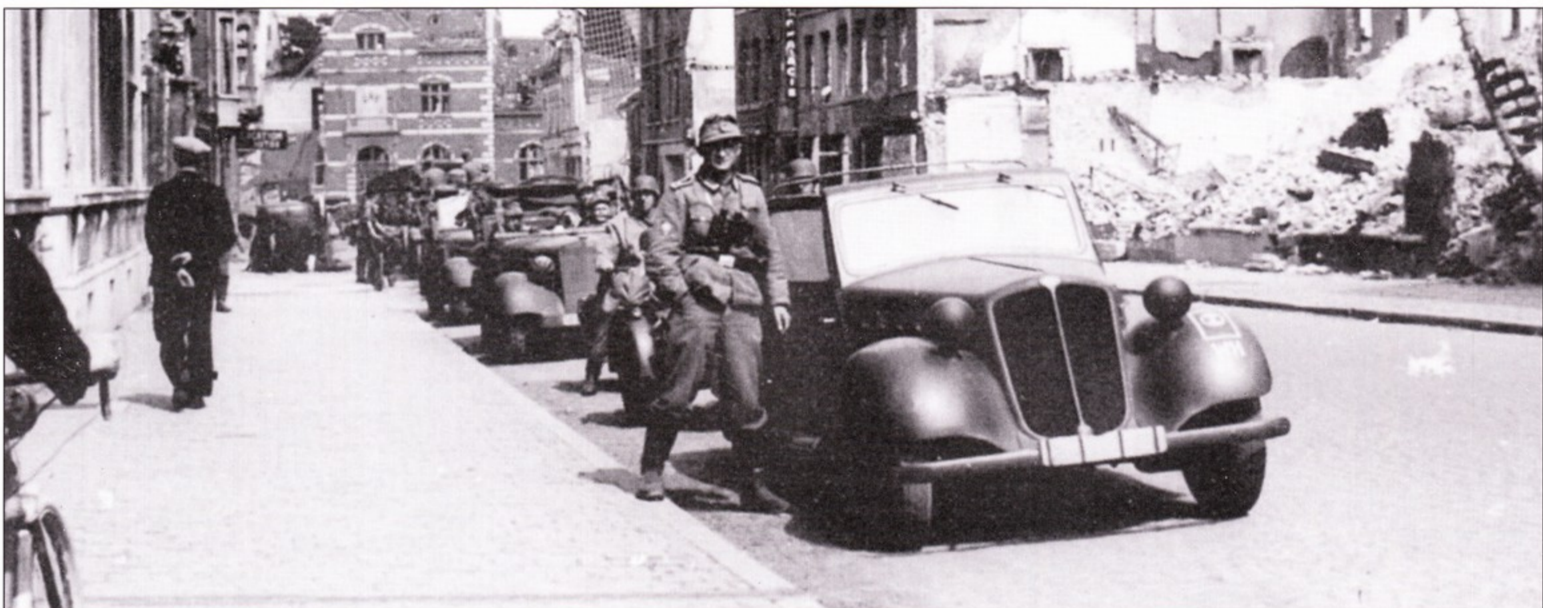
Еще один раритет - Ганза-1100, продукт фирмы Ганза-Ллойд унд Голиаф-Верке-Боргвард унд Текленборг унд Симанович. Автомобиль (из 402-го велосипедного батальона) оснащен 4-цилиндровым мотором мощностью 28 л.с.
