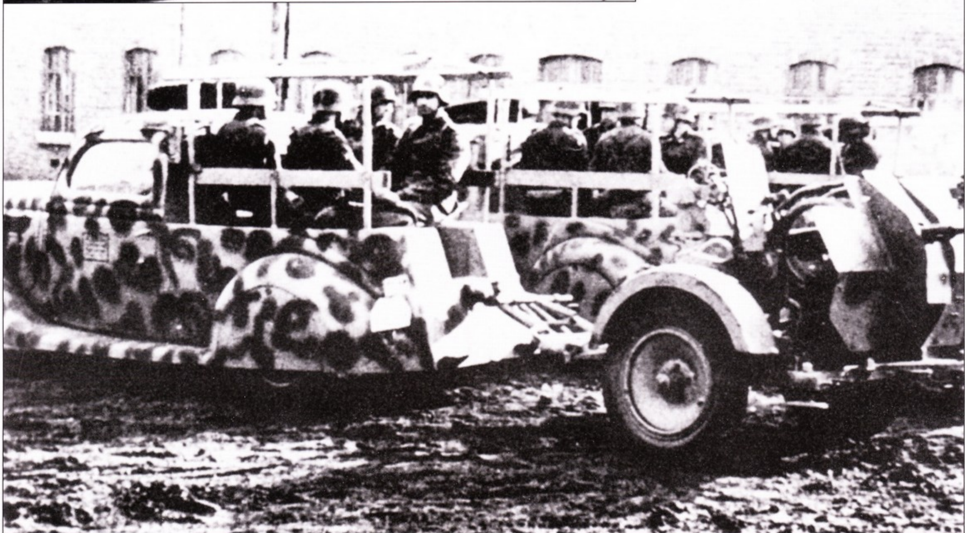
Форд V-8 1937 - 1939 г.г. двухдверный конвертируемый из 52-й истребительной эскадры, заднее крыло - закрытое, что очень непрактично.
