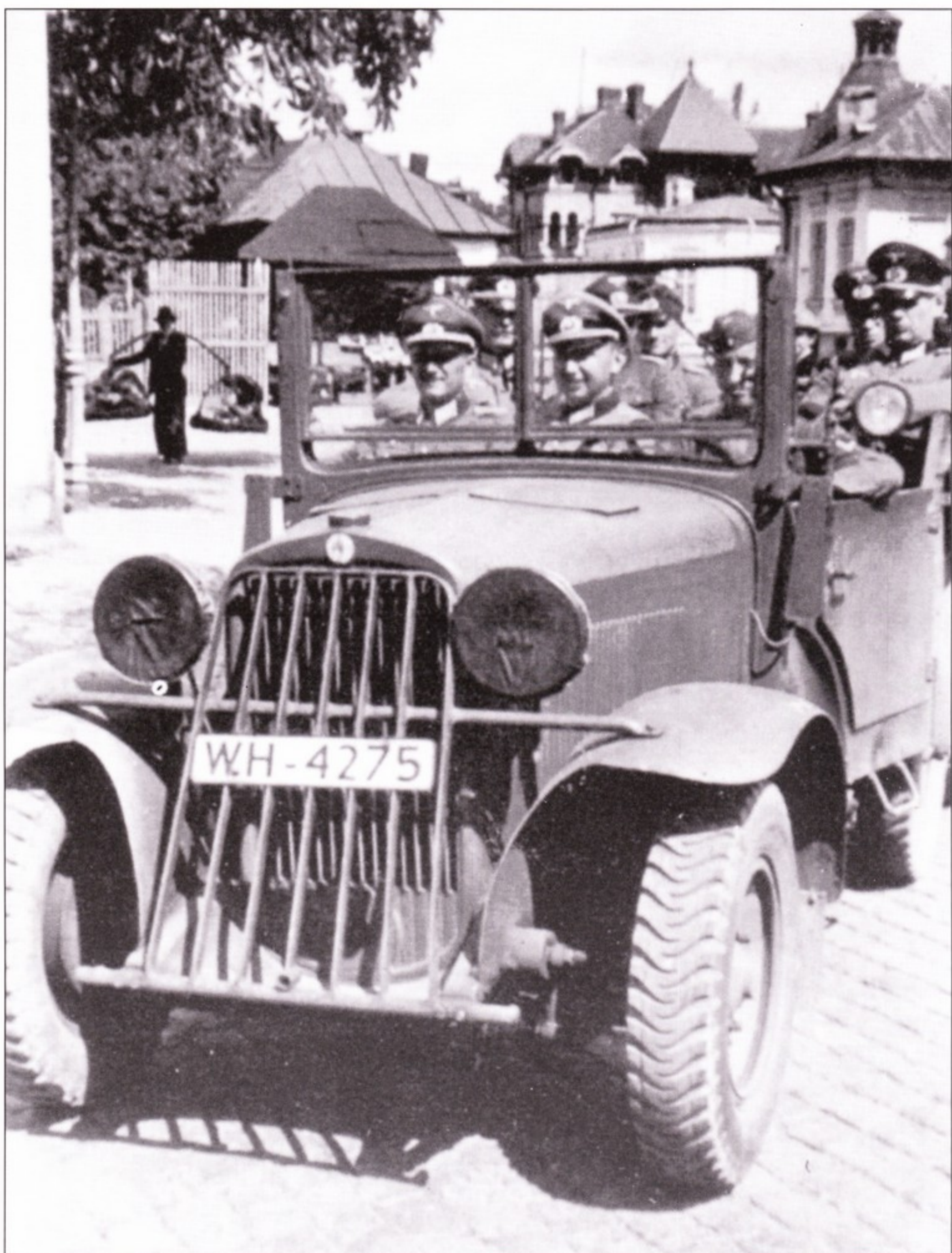
Шкода Супер 903 - командирское авто с 6-цилиндровым мотором мощностью 73 л.с. В вермахте такие машины использовались ограниченно.
