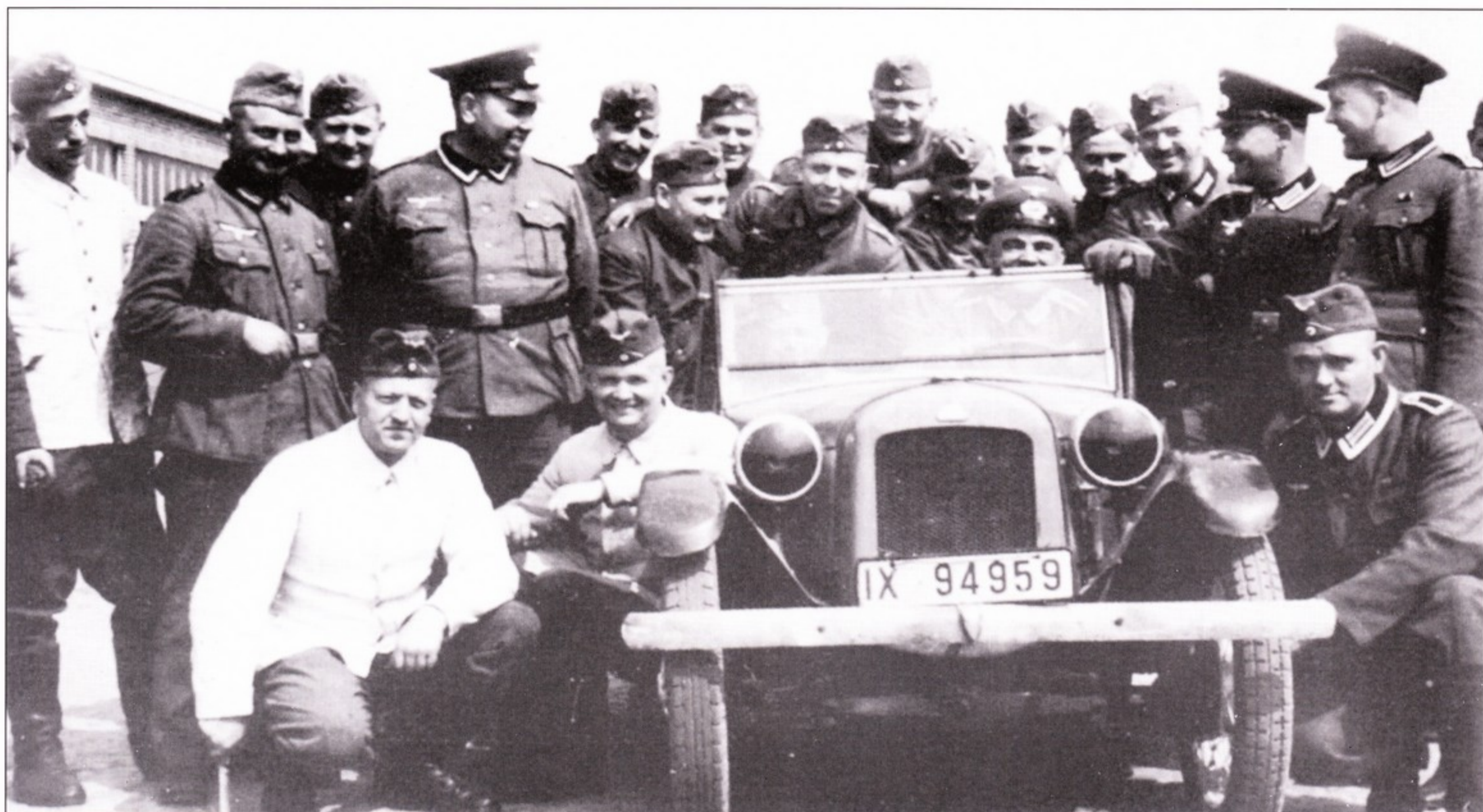
Какой контраст с обширным мерсом фюрера: самый маленький легковой автомобиль вермахта DIXI 3/15 постройки 1927 г. На машинке стояли 4-цилиндровый моторчик мощностью 15 л.с., а весил образец автотранспортной техники всего 700 кг. Солдаты 6-го саперного батальона очень несерьезно относятся к чуду германского автомобилестроения 20-х годов.
