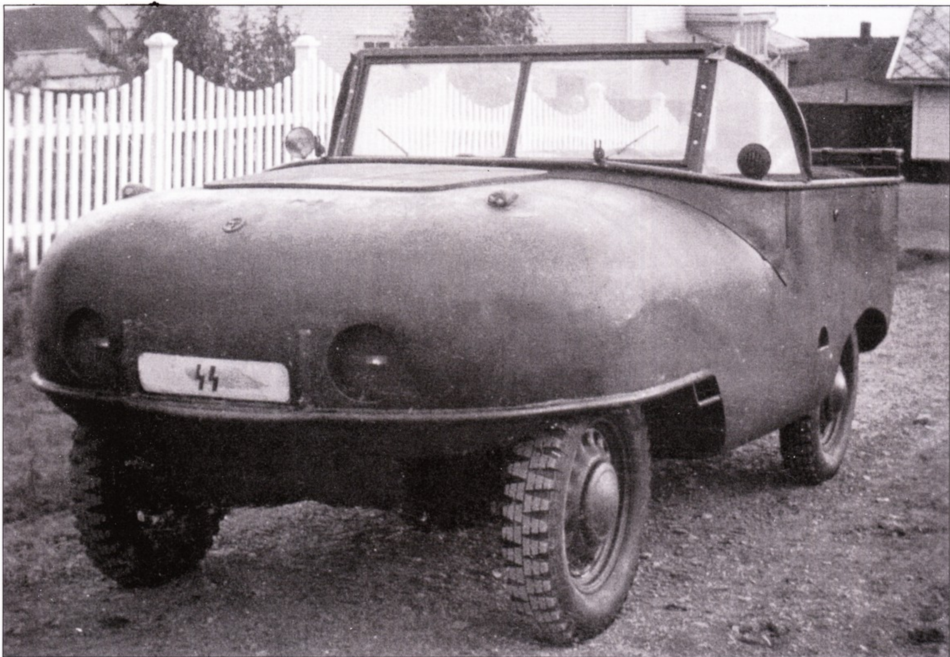
Прототип амфибии Trippel SG-6, 1929 г. Прототип отличается отсутствием дверей и вентиляционных щелей. Двигатель и колеса машины - производства фирмы Адлер.
