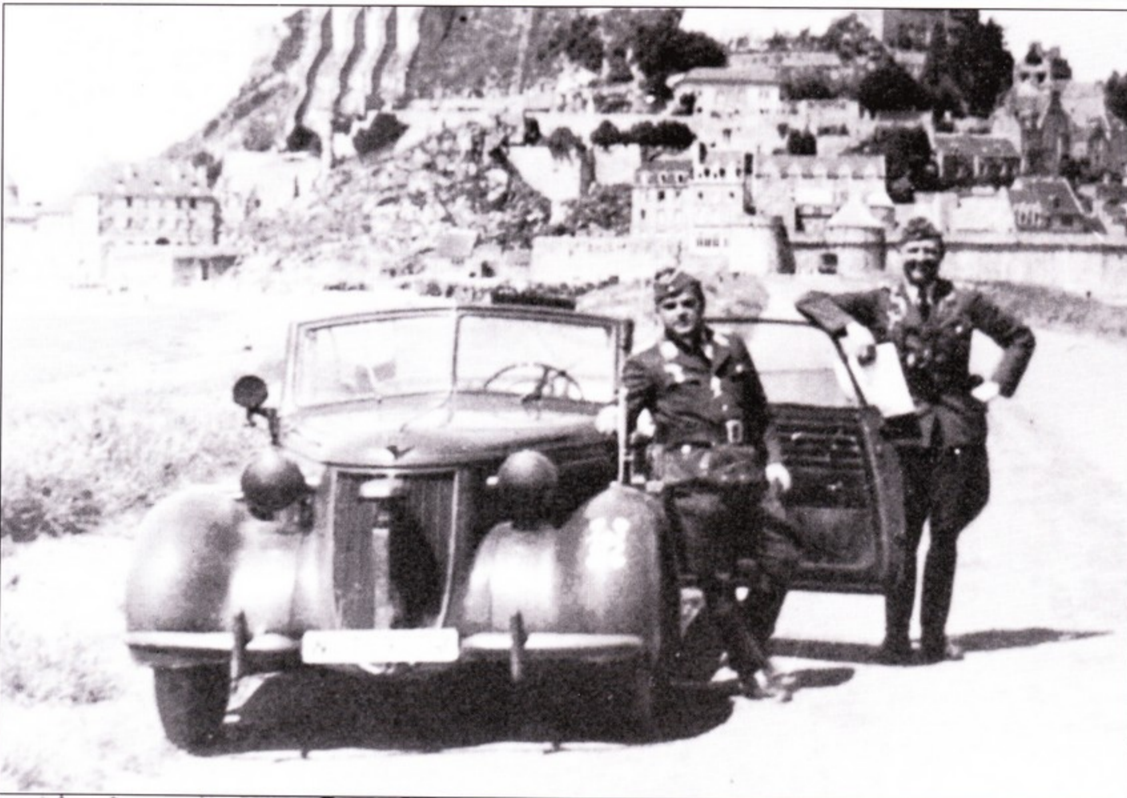
Вандерер W 23 подразделения люфтваффе (номерной знак начинается с «WL» - люфтваффе), Мон-Сен-Мишель, Франция. Автомобиль оснащен 6-цилиндровым двигателем мощностью 62 л.с., серийно строился в 1937 - 1941 г.г.
