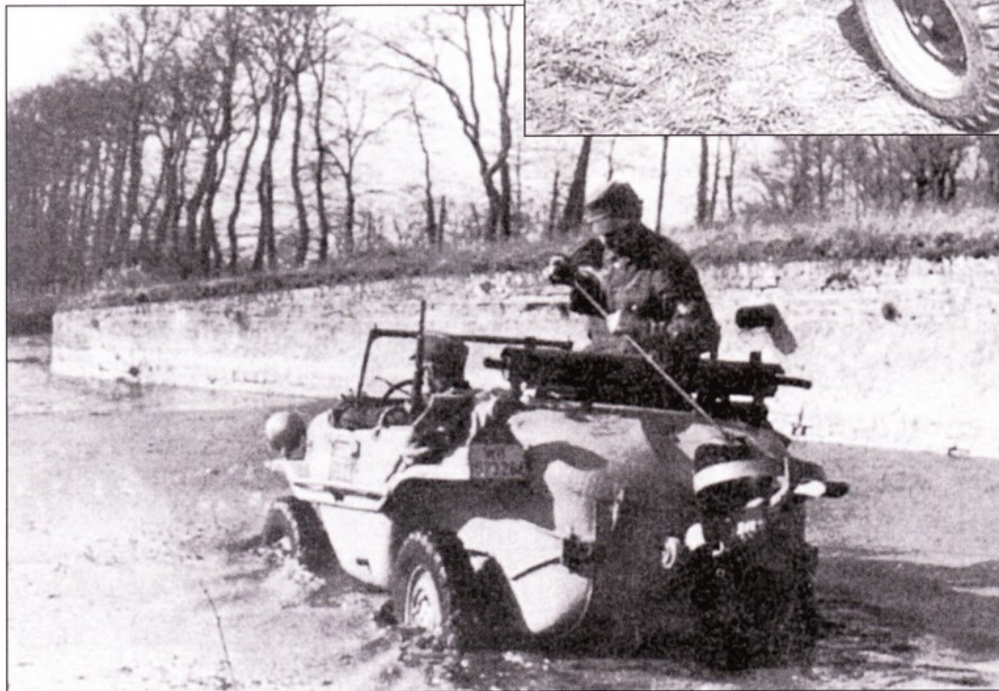
le.Pkw-K2 Тур 166 «Schwimmwagen». Подготовка к опусканию гребного винта.
