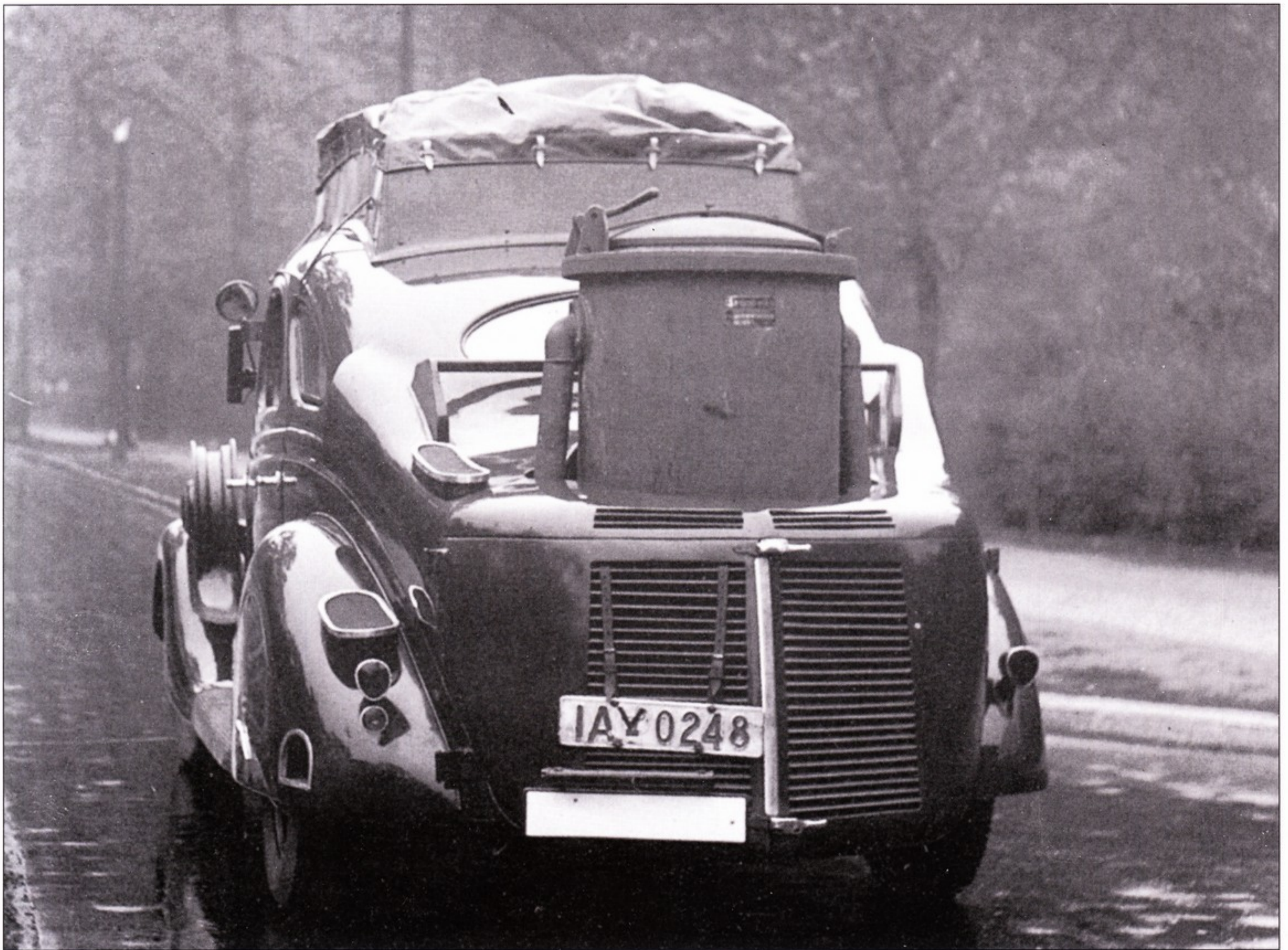
Прототип четырехдверного седана Форд V-8 «специал» модель 38 с установленным в задней части газогенератором. На крыше смонтирован багажник для дров, на которых работал газогенератор. Хорошо виден номерной знак с «галкой» красного цвета.
