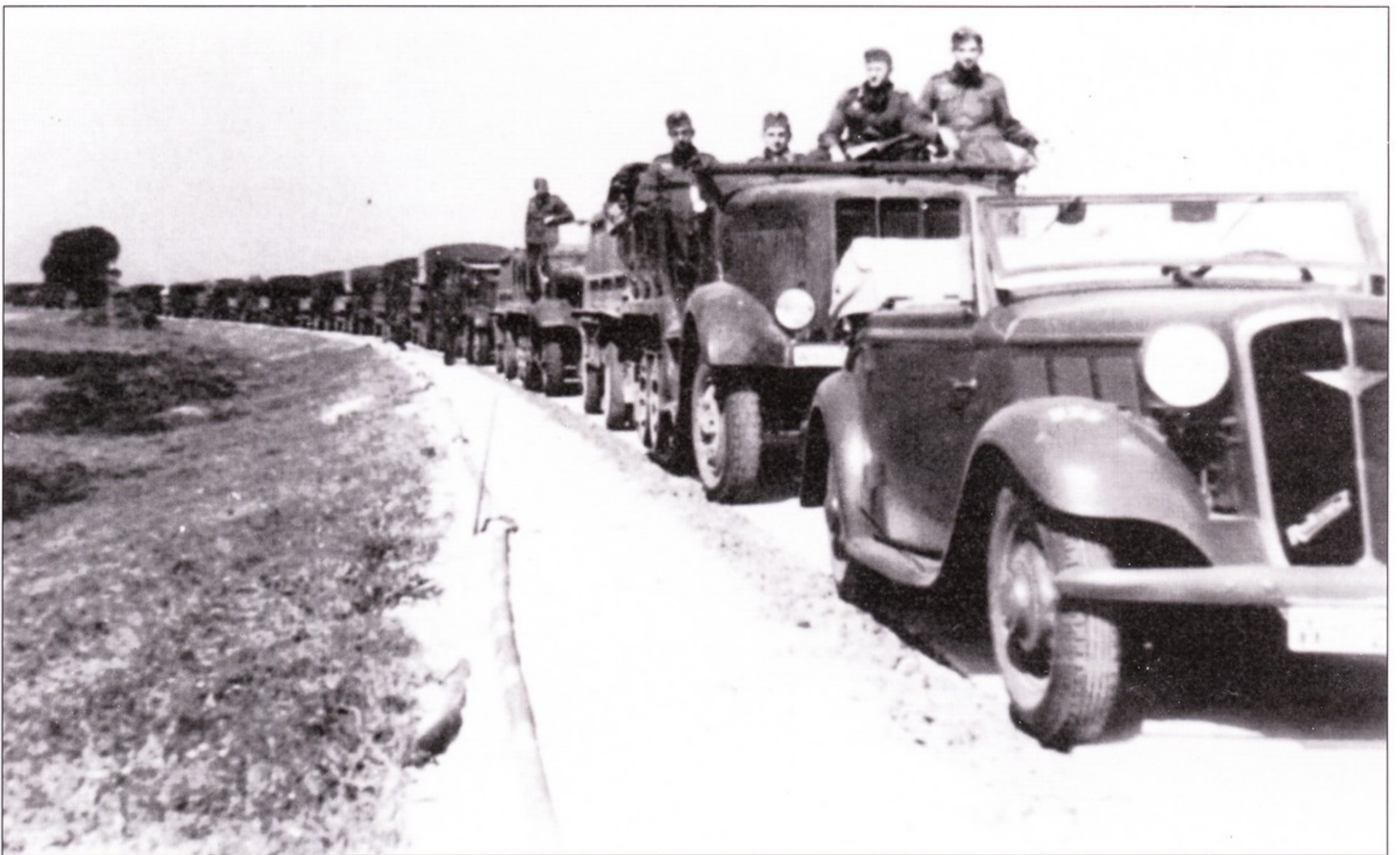
Легковые автомобили фирмы Ганомаг ныне почти забыты. Выпускались они небольшими сериями. На фото - Ганомаг «Рекорд» конвертируемый, обычно на таких авто перемещались командиры взводов поитонно-мостовых подразделений. На «Рекорде» стоял 4-цилиндровый мотор мощностью 32 или 35 л.с., серийно эти машины выпускались в 1934 - 1938 г.г. Также известен дизельный «Рекорд» - первый дизельный легковой автомобиль в мире.
