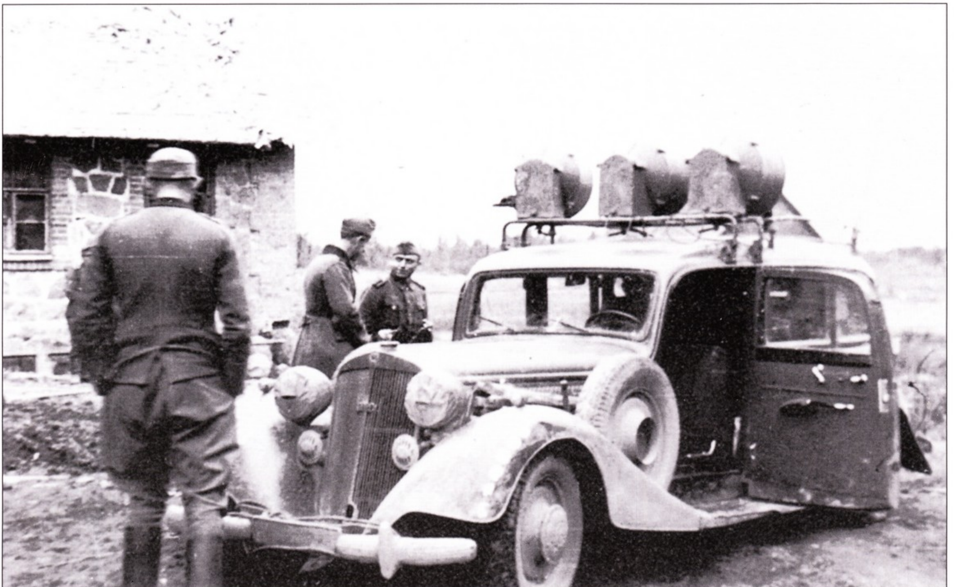
Реквизированный автомобиль производства фирмы Хорьх. Хорьхи нравились военным своими мощными двигателями. На фото - Хорьх 830 VL, оснащенный громкоговорителями, из 621-й пропагандистской роты 18-й армии, северная Россия. Кузов - пультмановский лимузин. Данный автомобиль оснащен двигателем V8 мощностью 82 л.с. или мощностью 92 л.с.
