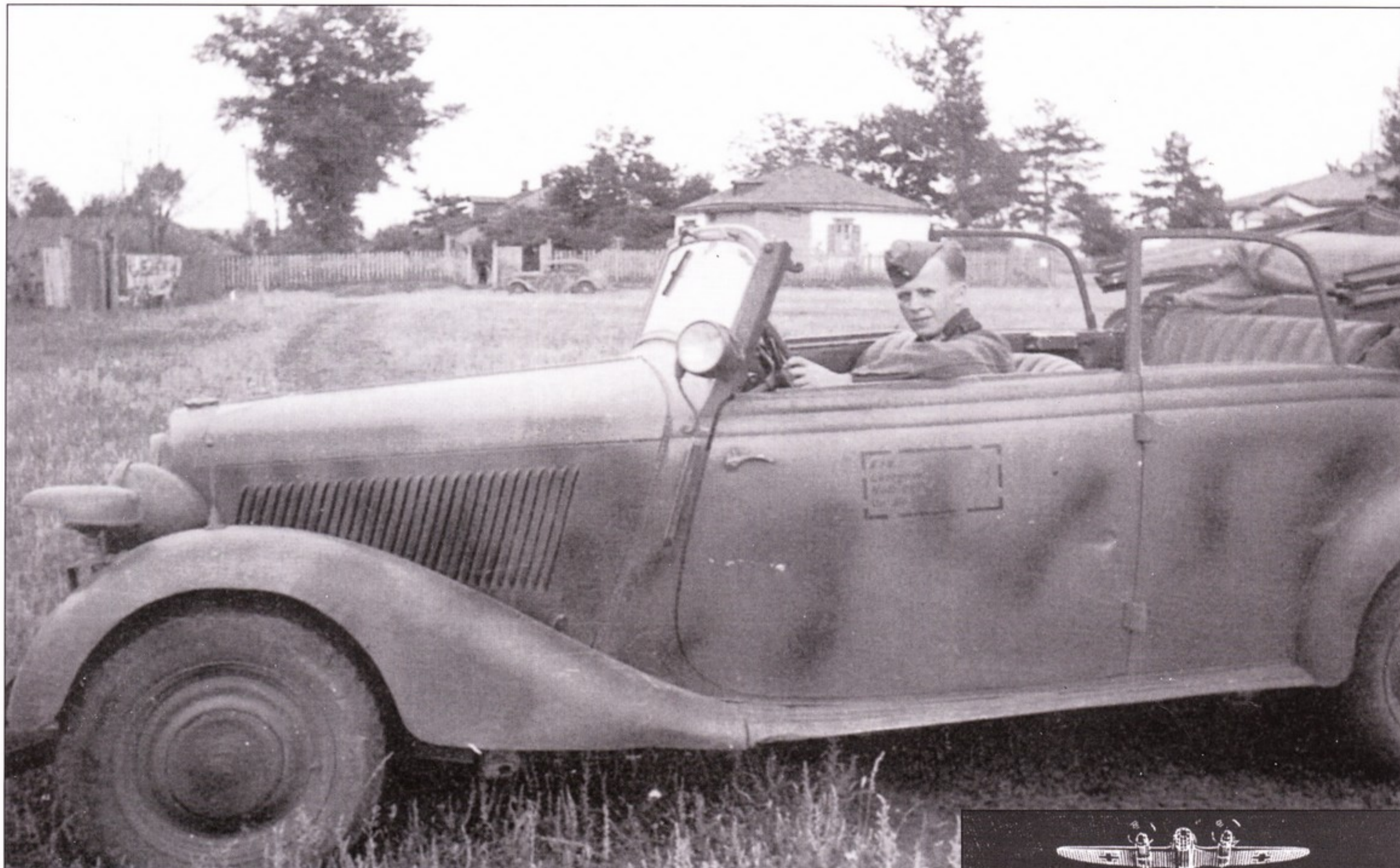
Даймлер-Бенц АГ: Мерседес-Бенц тип 170V кабриолет В из 3-й истребительной эскадры, Восточный фронт, 1943 г. Машина оснащена 4-цилиндровым двигателем мощностью 38 л.с. Эти авто нашли самое широкое применение.
