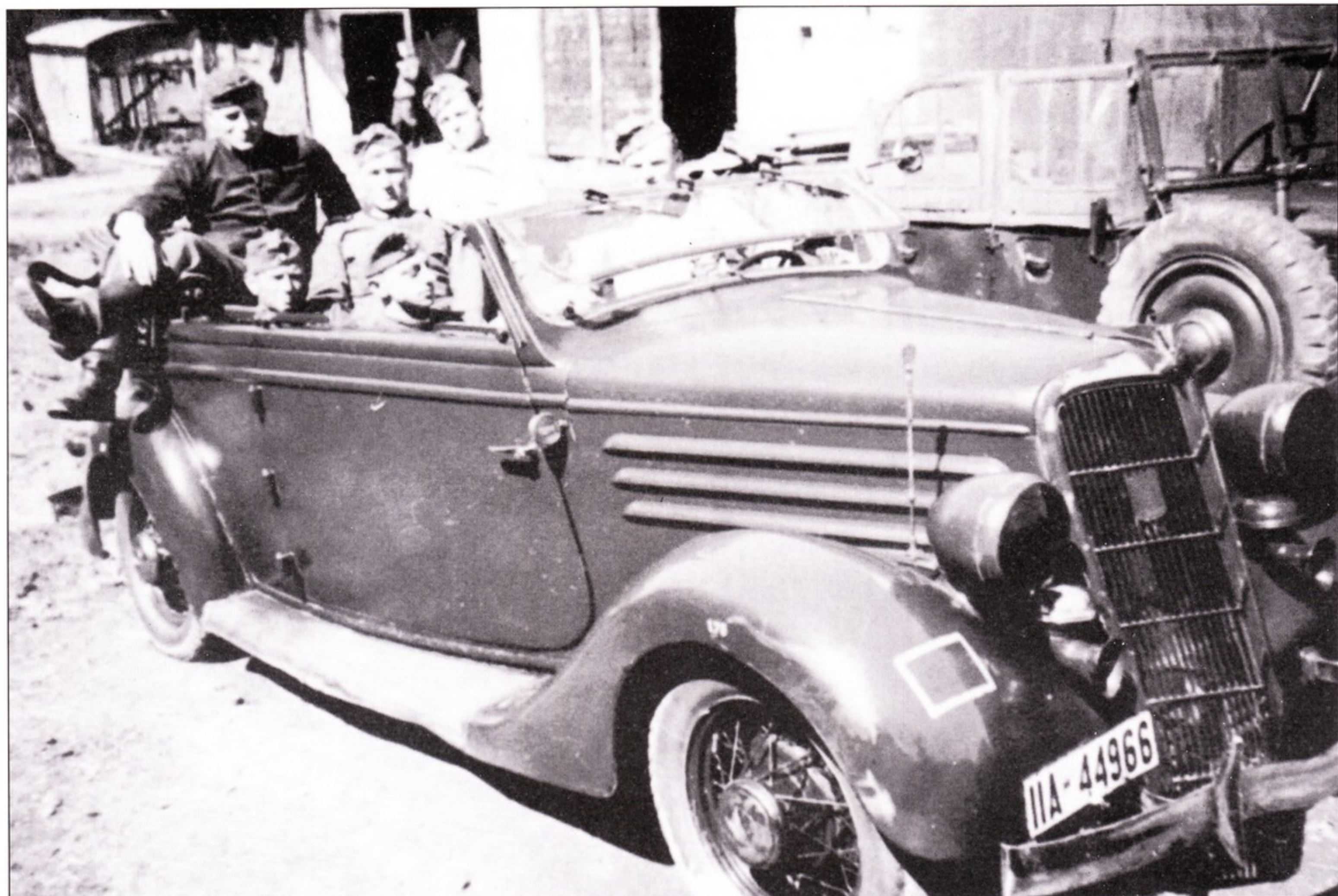
Форд V-8 конвертируемый, модель 48, пятиместный, постройки 1935 - 1936 г.г. На машине стоял 8-цилиндровый двигатель мощностью 90 л.с.
