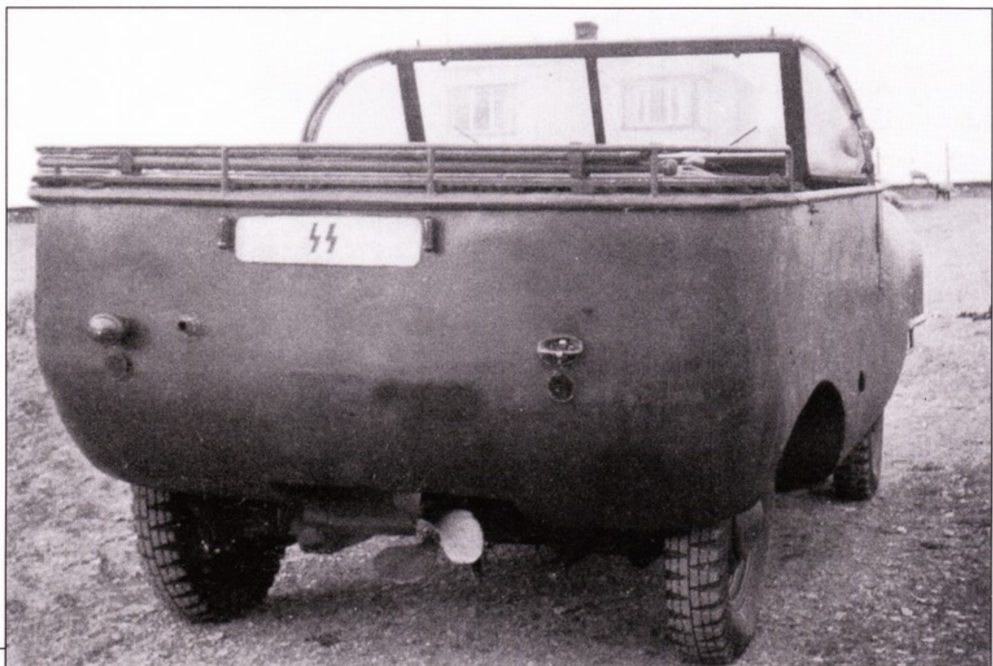
Прототип амфибии Trippel SG-6, 1929 г. Прототип отличается отсутствием дверей и вентиляционных щелей. Двигатель и колеса машины - производства фирмы Адлер.
