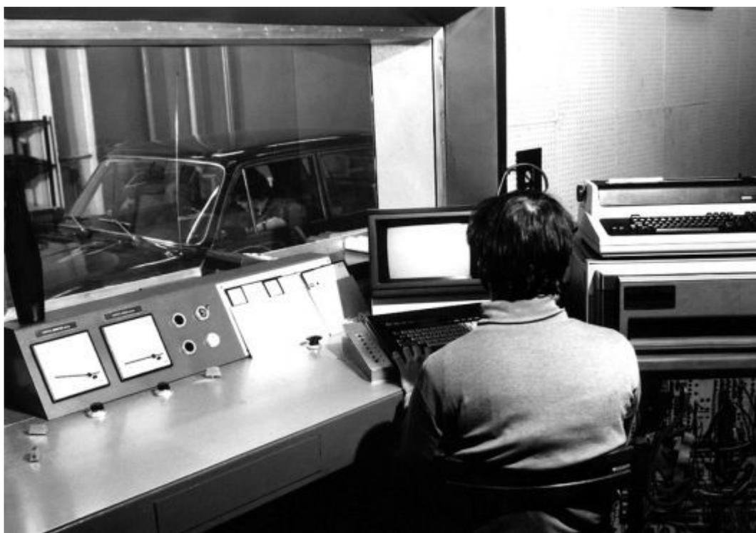
*Испытания ВАЗ-21031 в динамометрической камере УГК.*
