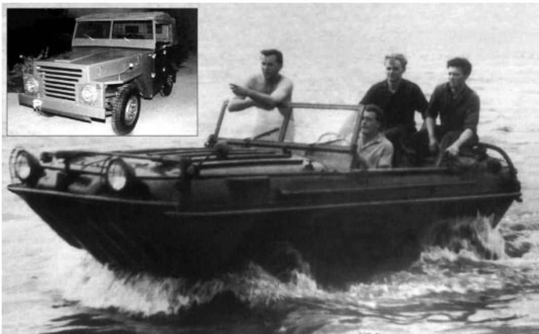
*Послевоенная опытная амфибия P2S на базе армейского джипа P2M (ГДР). Заметно выше ГАЗ-46.*
