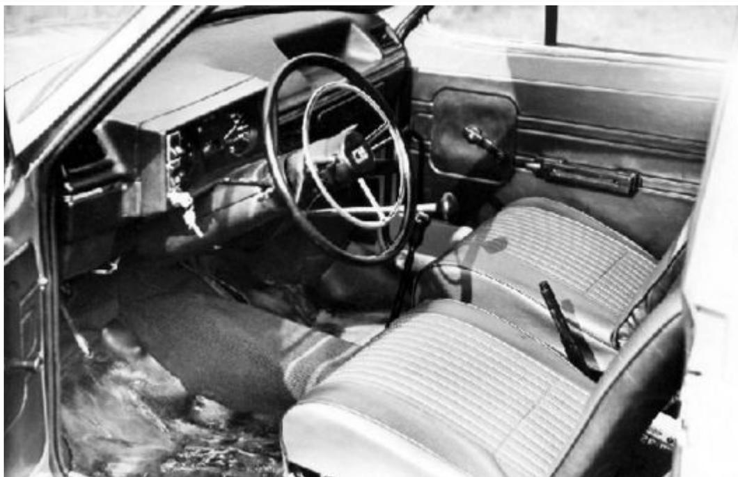
*Два примера рабочего места водителя с ручным управлением различного типа (внизу, правда, не «Оак», но органы управления те же).*
