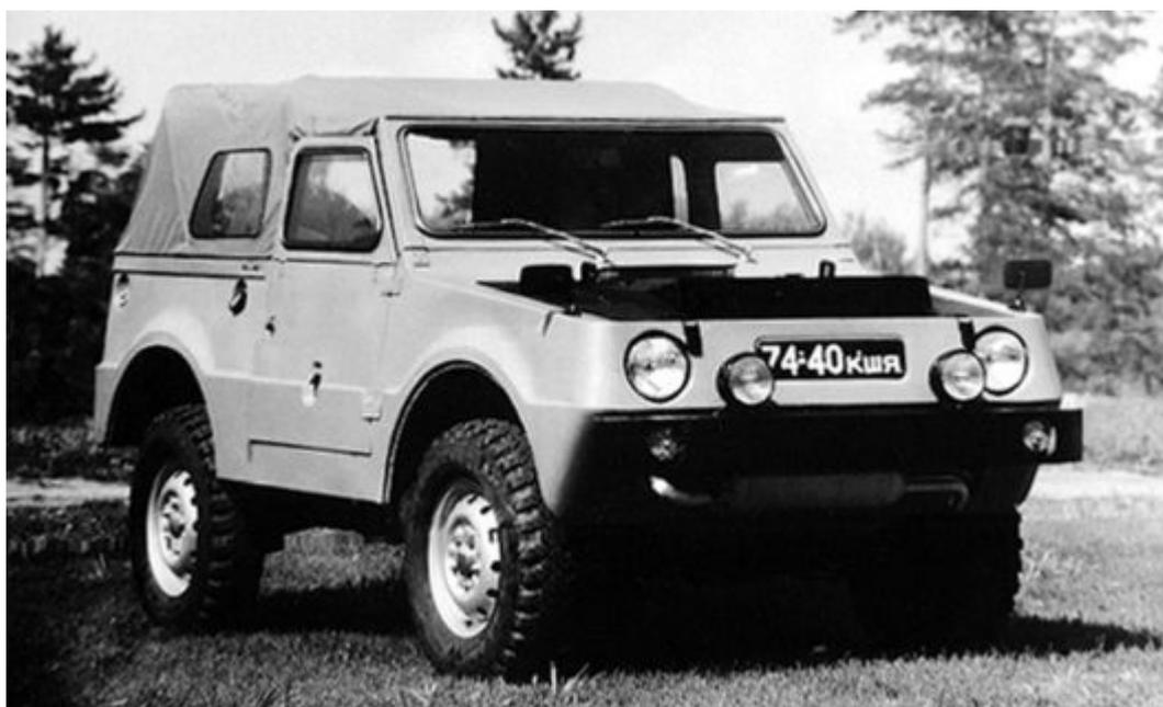
*Так выглядели первые образцы вазовской амфибии. На снимке - образец № 2, отличающийся от первого лишь дополнительными боковыми окнами в задней части тента. Машина подготовлена к плаванию (щиток волноотражателя откинут вперёд, передний воздухозаборник закрыт номерным знаком).*
