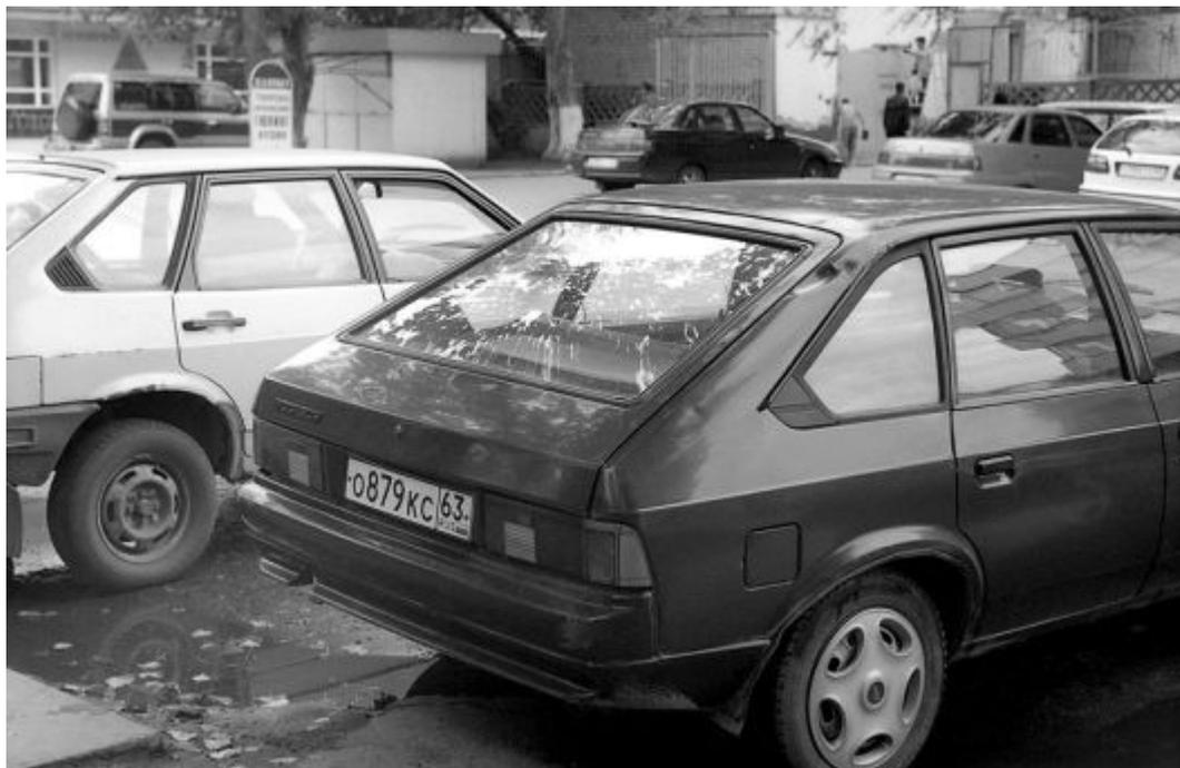
*Две однотипные машины, два задка, два решения. На «Москвиче-2141» (внизу) очистка стекла задней двери не требуется - оно просто не загрязняется. Всё дело, похоже, в аэродинамике.*
