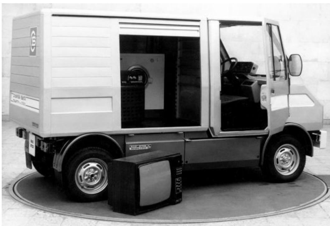
*Электромобиль-фургон ВАЗ-2702 в окончательном виде (дизайнер Г. Грабер). Основное назначение - перевозки в службе быта.*
