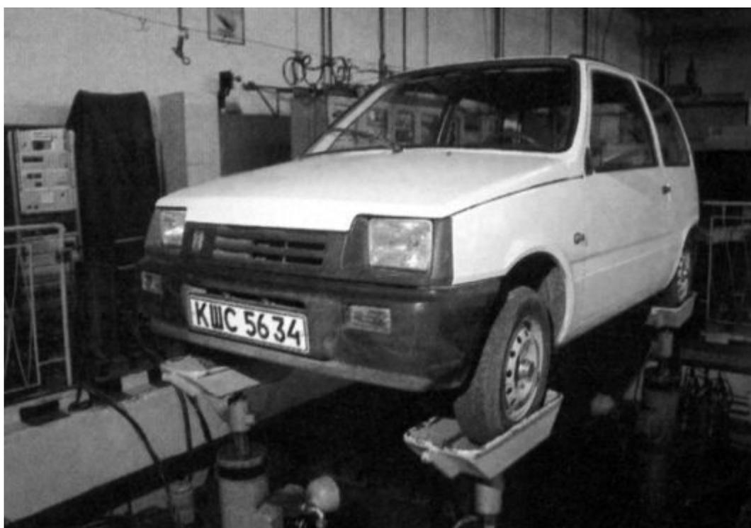
*Испытания на иммитаторе дорожных условий «Schenk».*
