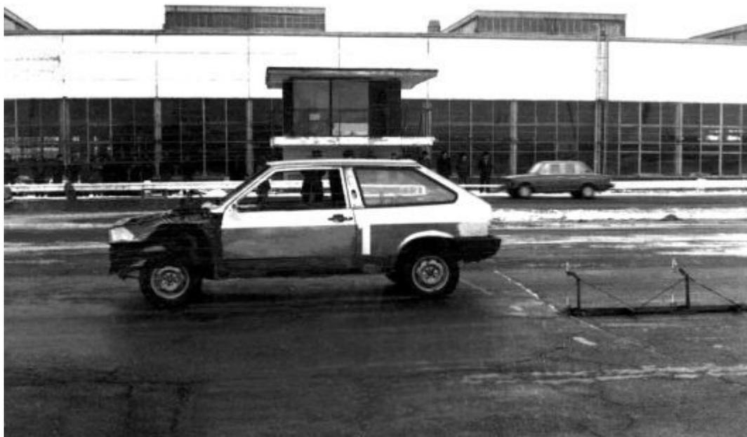
*Автомобиль ВАЗ-2108, подготовленный для удара сзади, на треке ВАЗа.*
