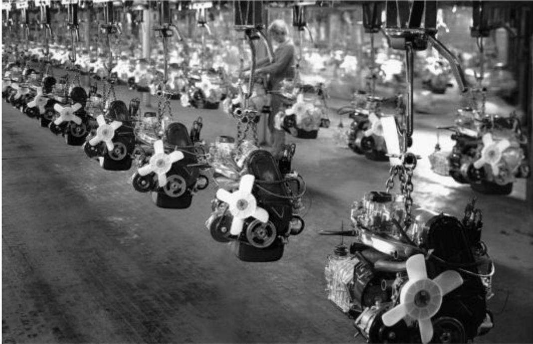
*Двигатель ВАЗ-2105 с плосkozубчатым резиновым ремнём на конвейере. Хотя продержался он недолго, но дело своё сделал - без этого неоценимого опыта создание двигателя ВАЗ-2108 с подобным ремнём наверняка бы затянулось.*
