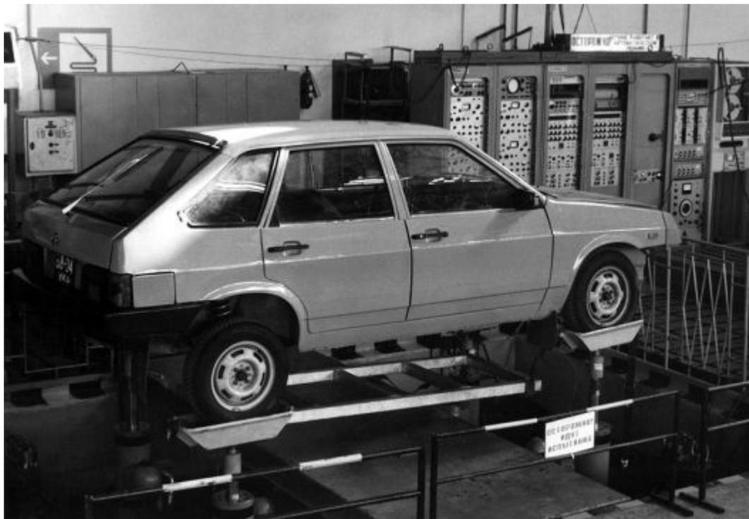
*Через иммитатор дорожных условий «Schtnk» были пропущены прототипы и трёхдверника, и пятидверки.*
