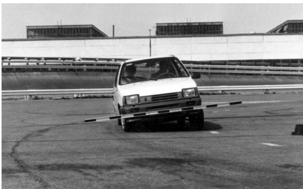
*Испытания на заводском треке. Определяется крен кузова.*
