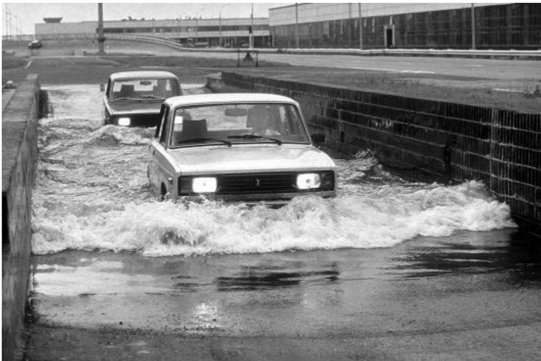
*Испытания ВАЗ-2105 на водонепроницаемость в глубоководной ванне трека ВАЗ.*
