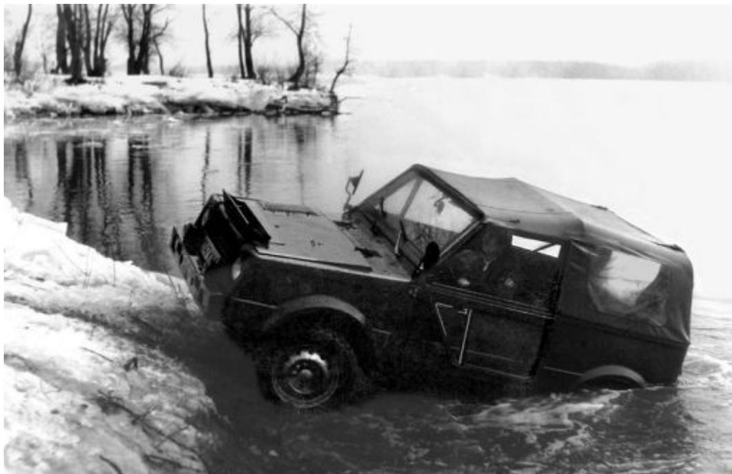
*Работы на плаву на доработанных образцах серии 400 продолжались до поздней осени. Велась доводка конструкции воздухозаборника, волноотражателя и системы откачки. В итоге всё заработало как надо.*
