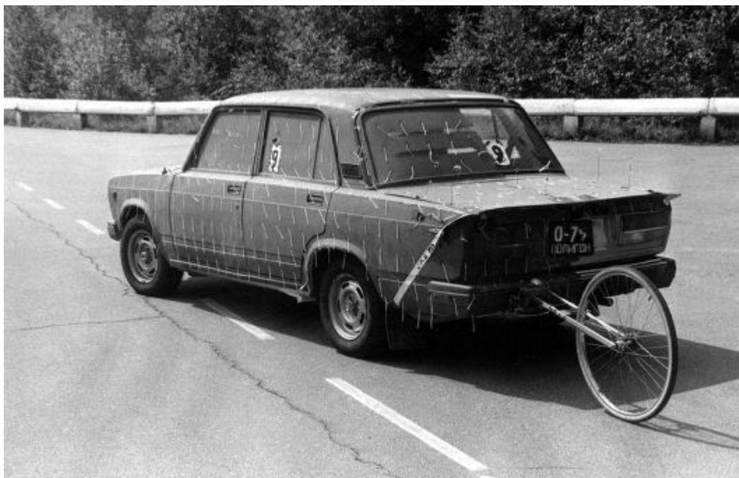
*Испытания ВАЗ-2107 с задним спойлером.*
