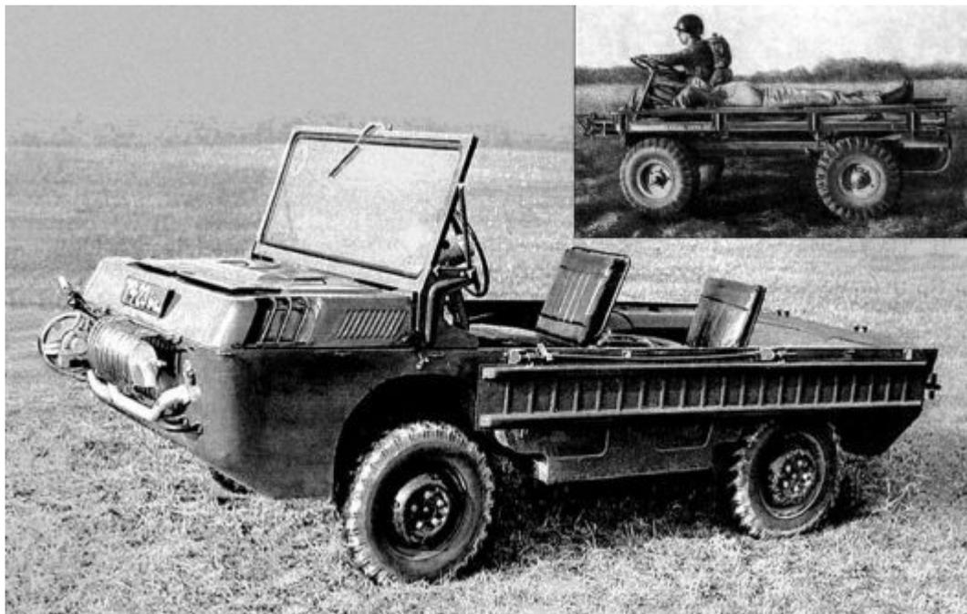
*Небольшими партиями в Луцке выпускался плавающий ЛуАЗ-967 (ТПК - транспортёр переднего края). Вверху справа - его натовский прототип Willys M274 («механический мул»). В отличие от ТПК, он не плавал.*
