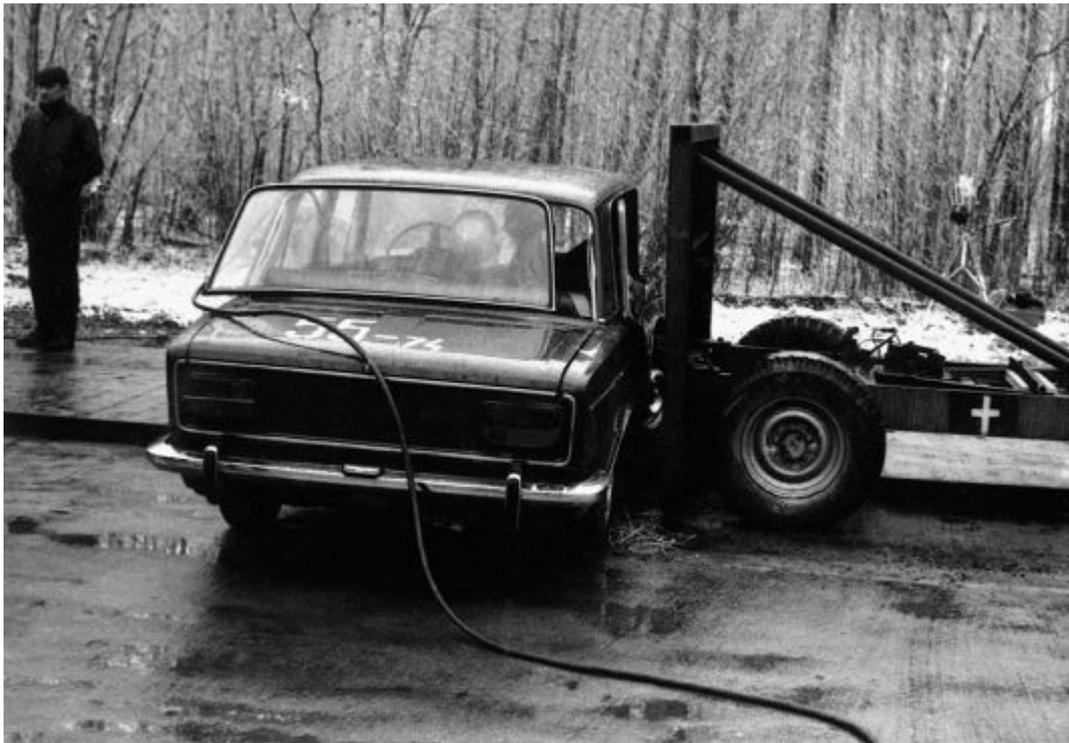
*Испытания на удар сбоку.*
