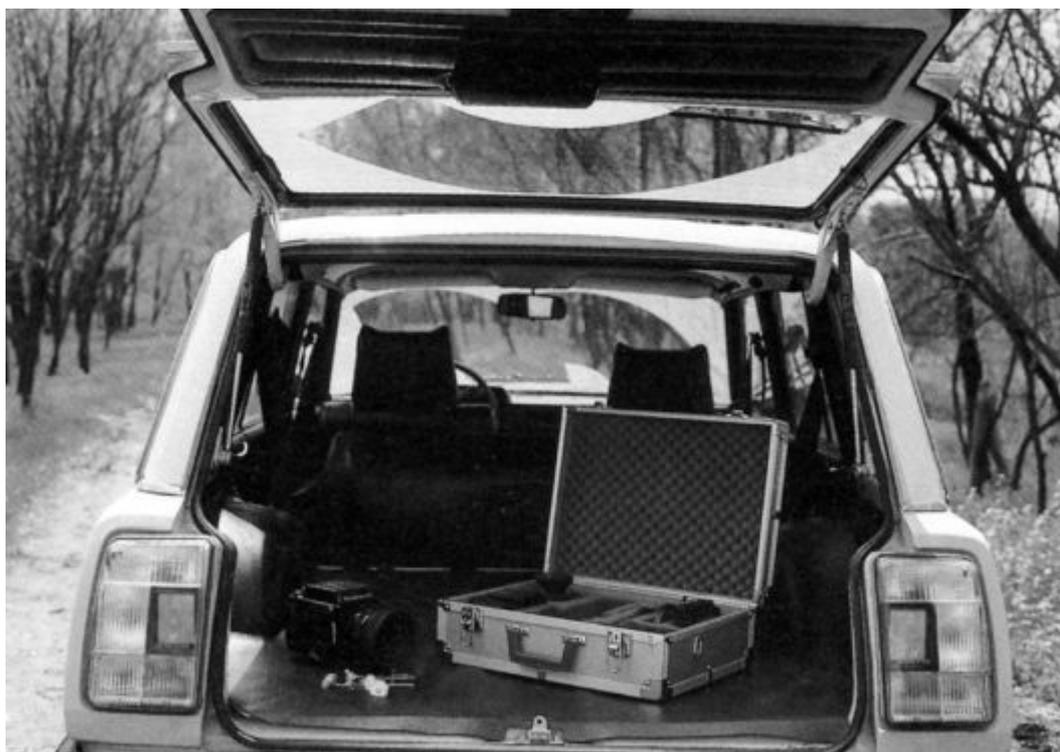
*Ширина проёма задней двери в нижней части ВАЗ-2104 (внизу) стала несколько меньше из-за выступающих в проём фонарей. Однако фактически ширина грузового отсека определяется расстоянием между колёсными арками, поэтому реального ухудшения не произошло.*
