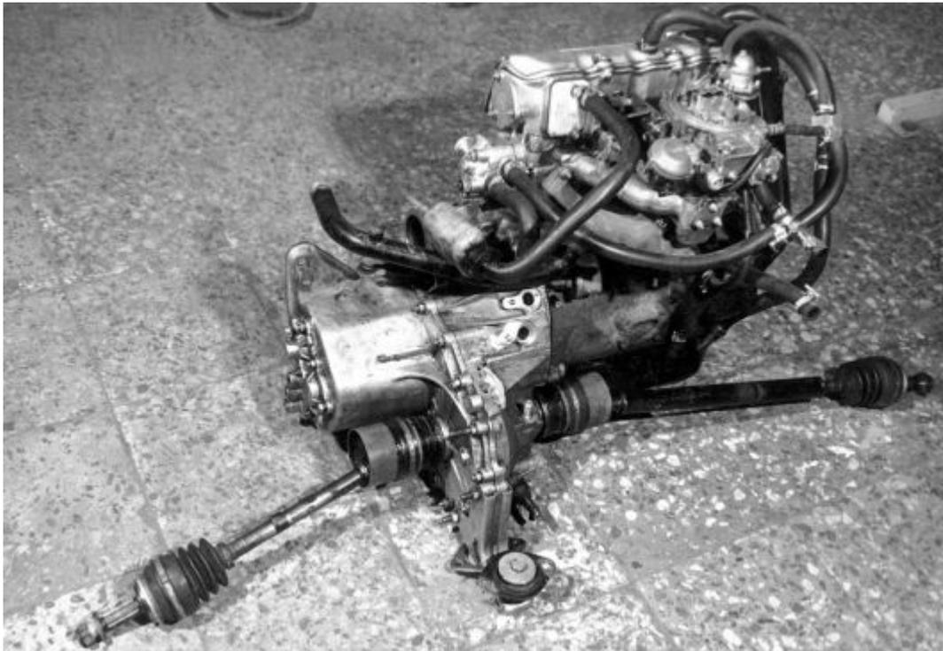
*Единый силовой агрегат автомобилей нового семейства (различия лишь в литраже применяемых двигателей).*
