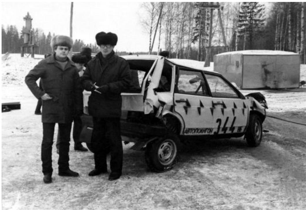
1985 год, автополигон. ВАЗ-2109 после ударов спереди и сзади.
