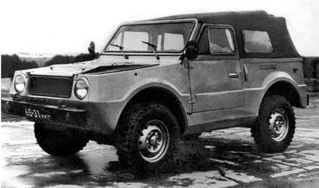
*Образец второй серии на шинах ВЛИ-6. Установлены боковые зеркала от ГАЗ-53, замки дверей временно заменены на серийные вазовские.*
