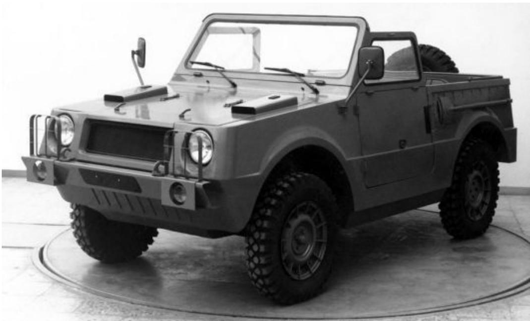
*Полноразмерный деревянный макет внешних форм (даже колеса вырезаны из дерева!).*
