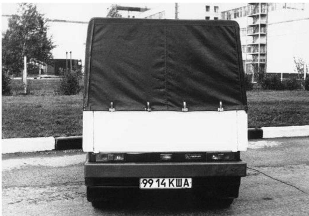
*Бортовой вариант грузового электромобиля ВАЗ-2702.*
