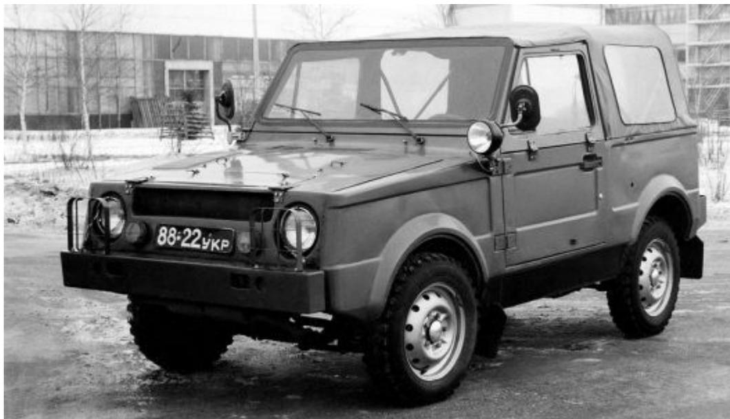
*Образец третьей серии, доработанный испытателями (уменьшен передний воздухозаборник, на дверях введены «форточки») - прообраз серии 400.*
