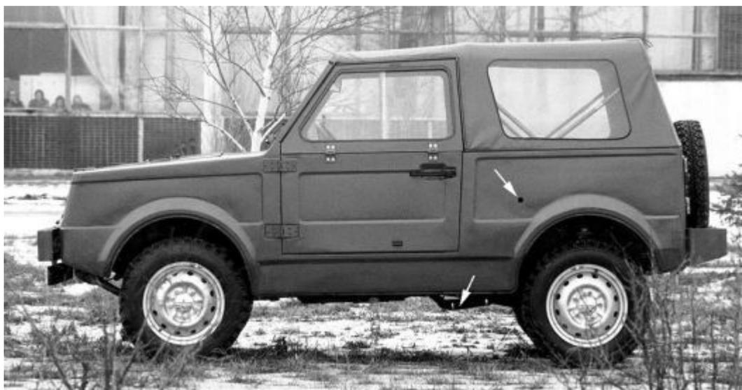
*Но «кудряшовский» вариант оказался предпочтительнее. Образцы третьей серии стали заметно компактнее. От последующих их можно отличить по отсутствию «форточек» - стёкла были сдвижными. Да еще откачка воды производилась только из трансмиссионного отсека. На борту видно выходное отверстие, а под днищем - соединительный шланг, оторвать который на бездорожье проблем не составляло. Такая «откачка» не прошла.*
