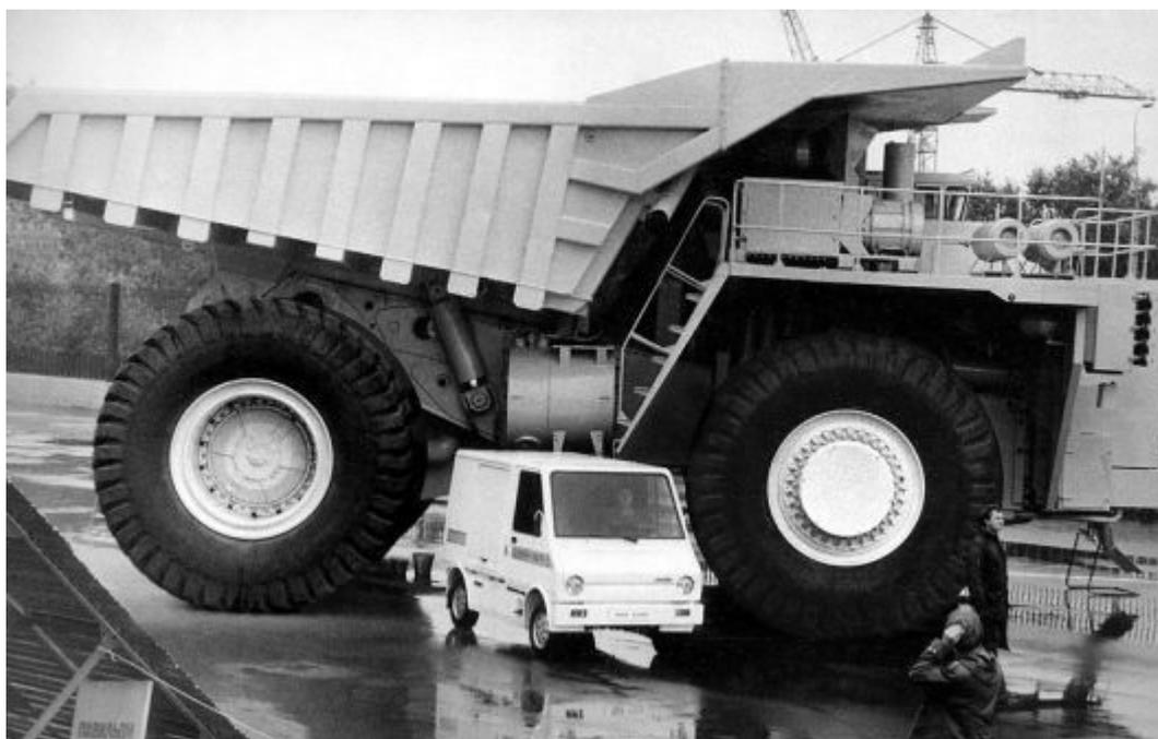
*На выставке «Автопром-84». Это не просто снимки на тему «Давид и Голиаф». Огромный БелАЗ - тоже электромобиль, только комбинированного типа дизель-генератор и мотор-колёса).*
