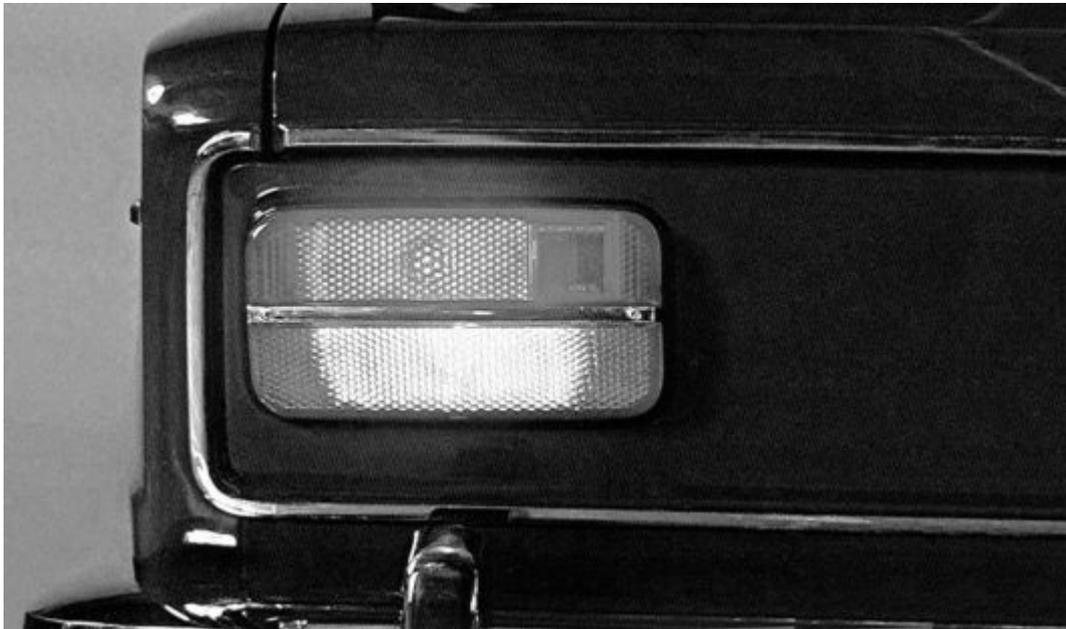
*Задние фонари на 2103 были крупными, хорошо различимыми. Указатель поворота сначала располагался сверху фонаря, затем, уже в ходе производства, по технологическим причинам был перенесён вниз (как на снимке).*
