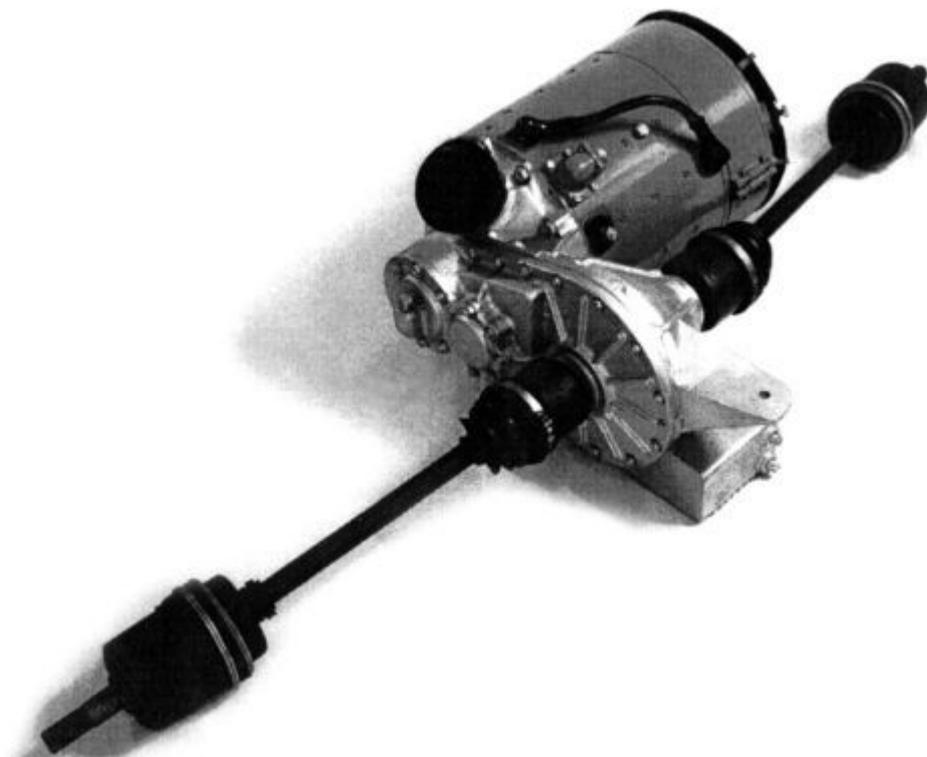
*Силовой агрегат электромобиля с двигателем ПТ-125 (внизу - с подсоединёнными валами привода ведущих колёс).*
