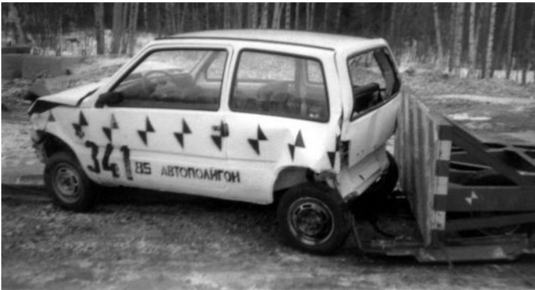
*Ещё удар! Ту же машину (задок-то цел) ударили сзади специальной тележкой.*
