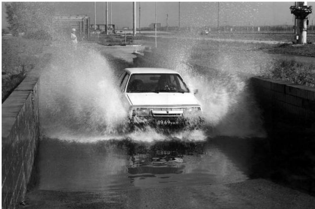
*Испытания в глубоководной ванне заводского трека.*
