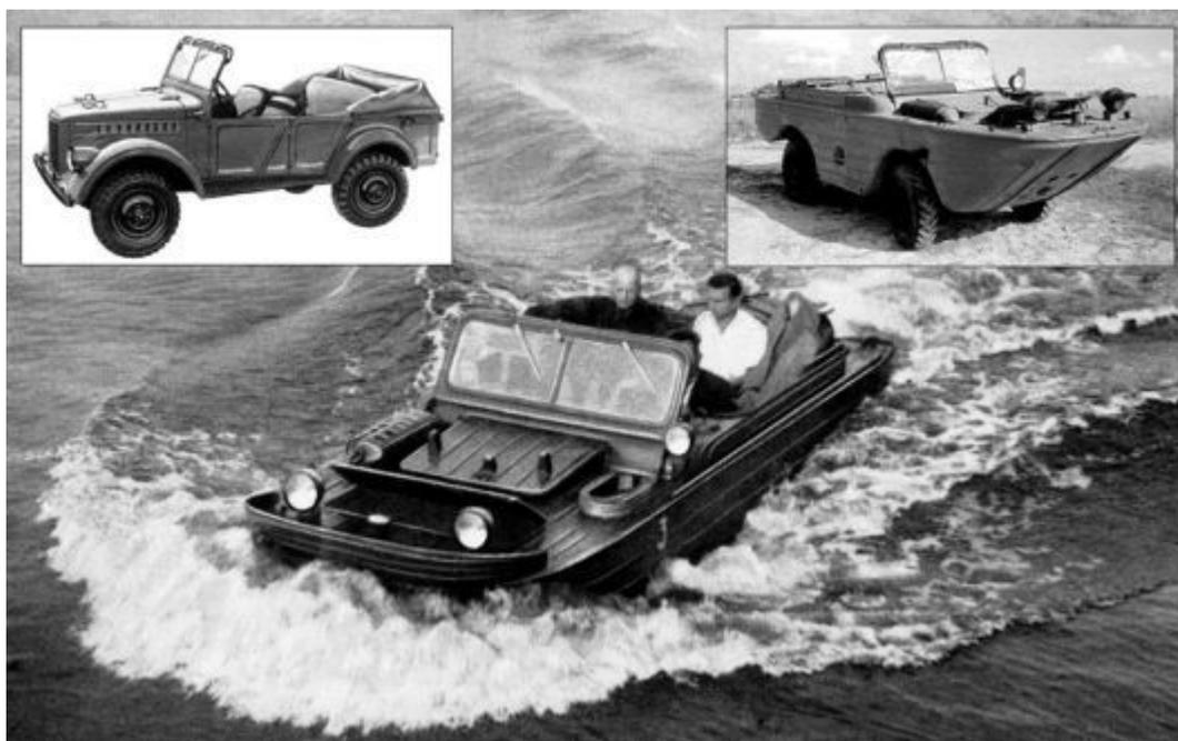
*ГАЗ-46, послевоенный аналог Ford GPA, выполненный на агрегатах ГАЗ-69 (вверху слева), получился не столь компактным и заметно более тяжёлым.*
