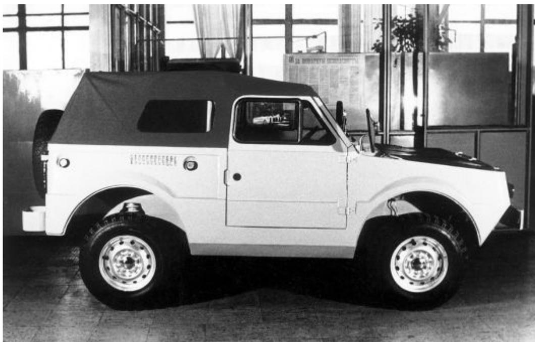
*Образцы вышли из цеха на «технологических» шинах ВлИ-5 (несоразмерность с арками очевидна). Опытные шины ВлИ-6 будут установлены позднее.*
