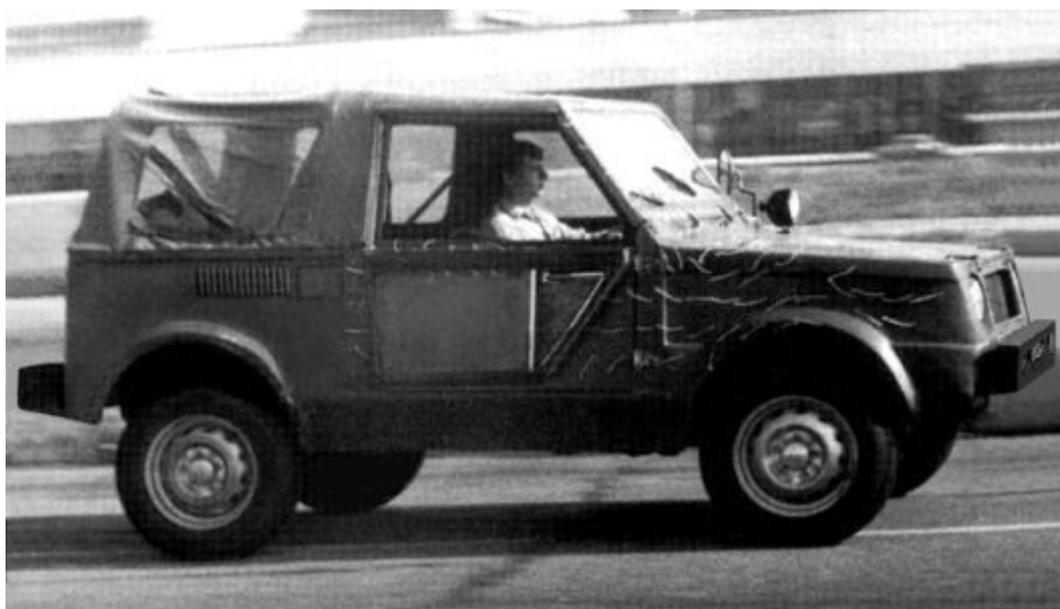
*Доработка третьей серии в разгаре. Уже введены форточки в откидных рамках боковых дверей. Для определения оптимальных размеров переднего воздухозаборника (он явно велик) проводятся визуальные аэродинамические испытания на заводском треке с приклееными ленточками.*
