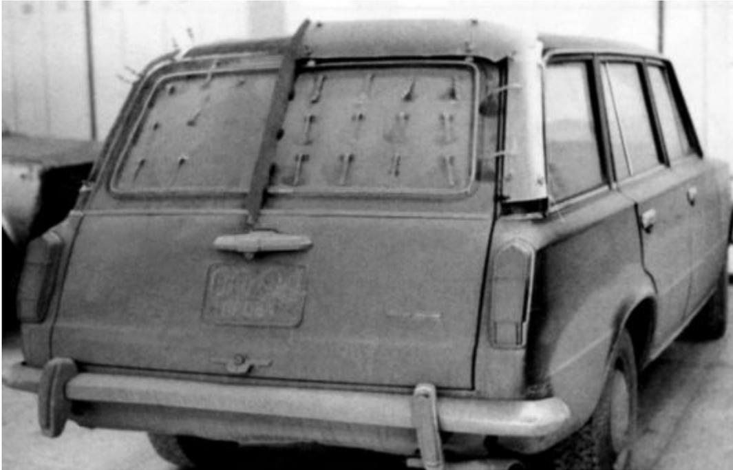
*На ВАЗ-2102 очистки стекла задней двери не было (впрочем, как и на его прототипе FIAT-124 Familiare). Все попытки улучшить аэродинамику задка с использованием различного вида спойлеров (на снимке) результата не дали.*
