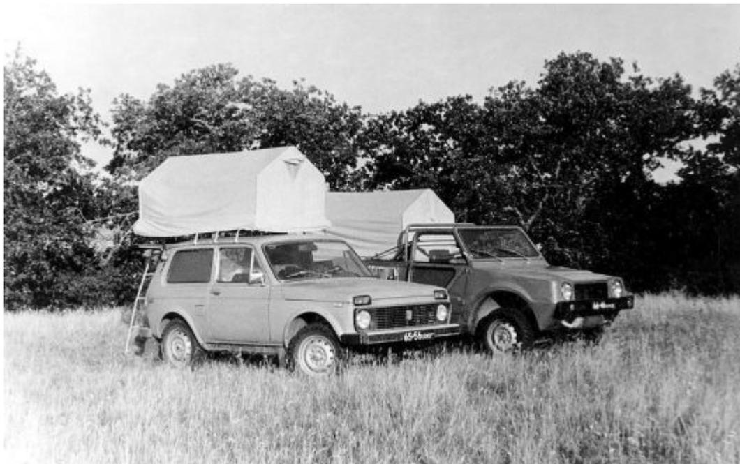
*Ходовой макет ХМ-2122 на кузове 2-й серии с шинами ВЛИ-5 с сопровождающей «Нивой» на пути в Среднюю Азию (привал в пути).*
