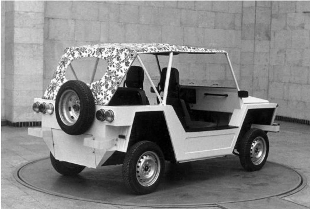
*От «бензиновых» образцов первой серии (вверху) электророллер можно было легко отличить по специальной нише для аккумулятора под запасным колесом и отсутствию выхлопной трубы.*
