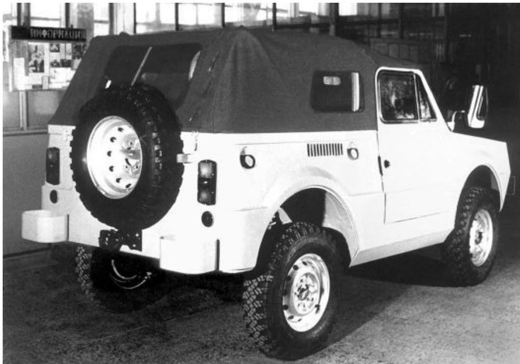
*Образец второй серии в экспериментальном цехе. От первых образцов эти машины легко отличить по переднему воздухозаборнику и решёткам выброса воздуха на бортах. Бросаются в глаза несуразно большие камазовские зеркала.*
