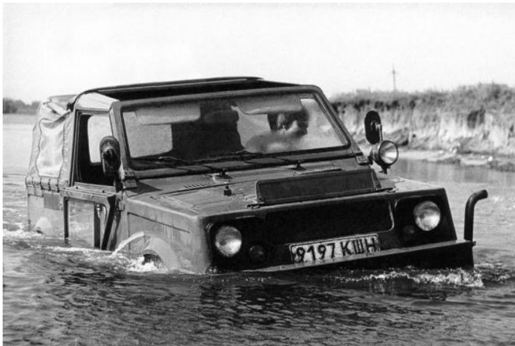
*При длительной работе на плаву (ресурс) приходилось выводить выхлоп в сторону выше ватерлинии.*
