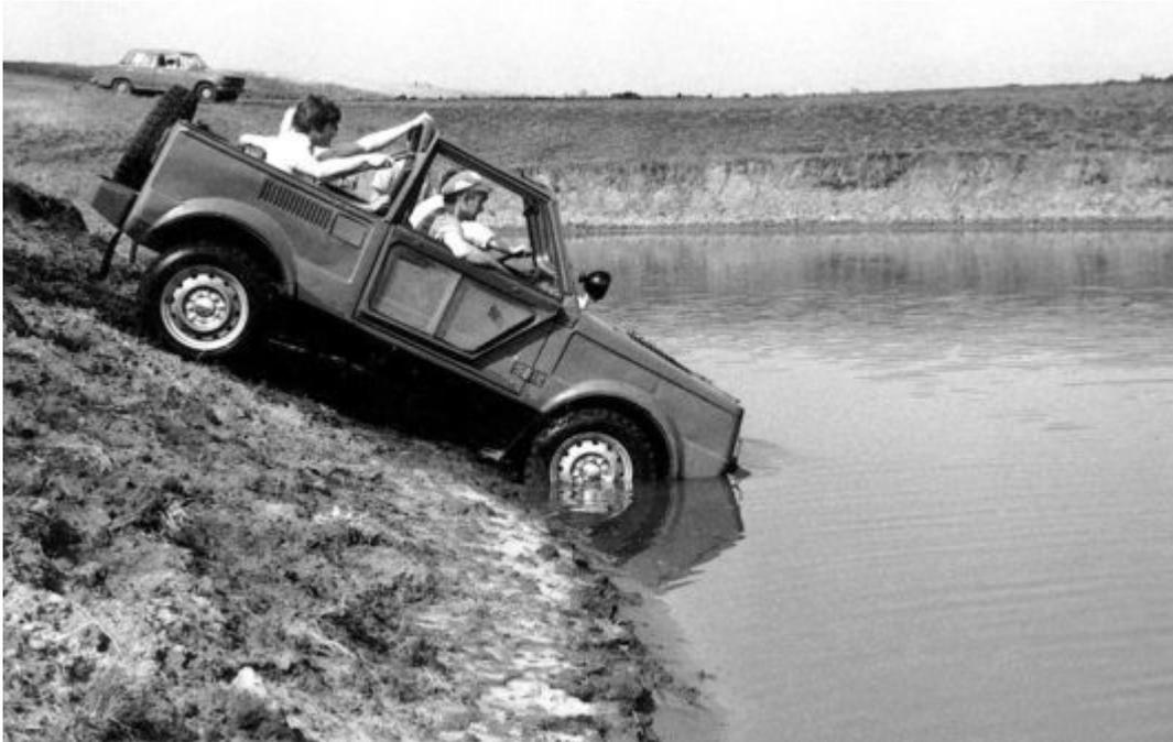
*Одна из главных задач на испытаниях образцов третьей серии - как поплывёт машина на «маленьких» колёсах ВЛН-5?*
