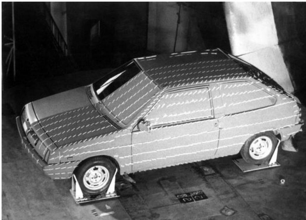
*Продувка автомобиля ВАЗ-2108 в аэродинамической трубе ЦАГИ, 1980 г.*
