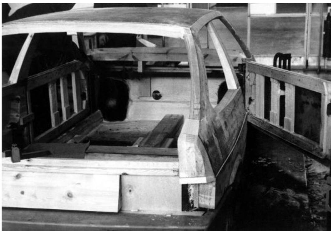
*Идёт изготовление деревянного демонстрационного макета.*
