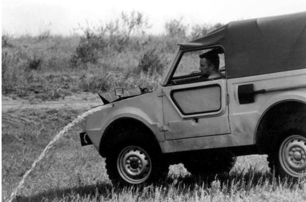
*После плава - откачка попавшей внутрь воды (герметичность этой машины всегда остав-ляла желать лучшего).*
