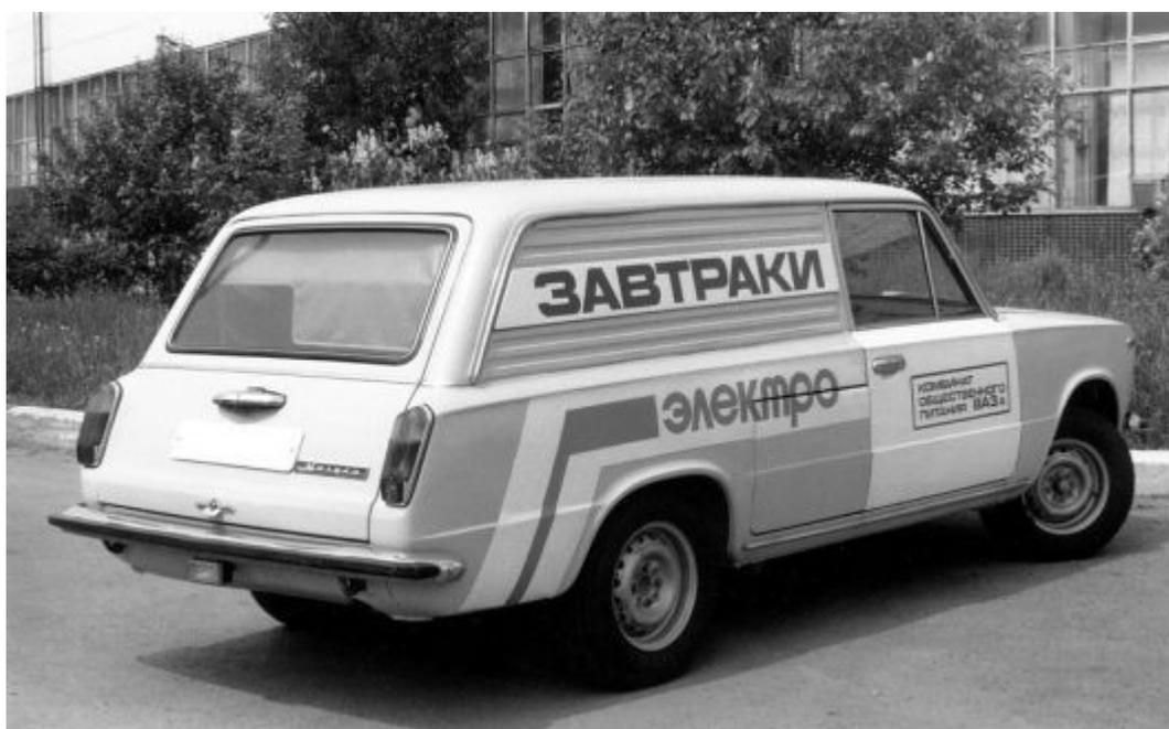
*Вариант с алюминиевой рамой (нагрузки на несущий кузов оказались за пределами) и никель-цинковыми батареями стал именоваться ВАЗ-2801.*
