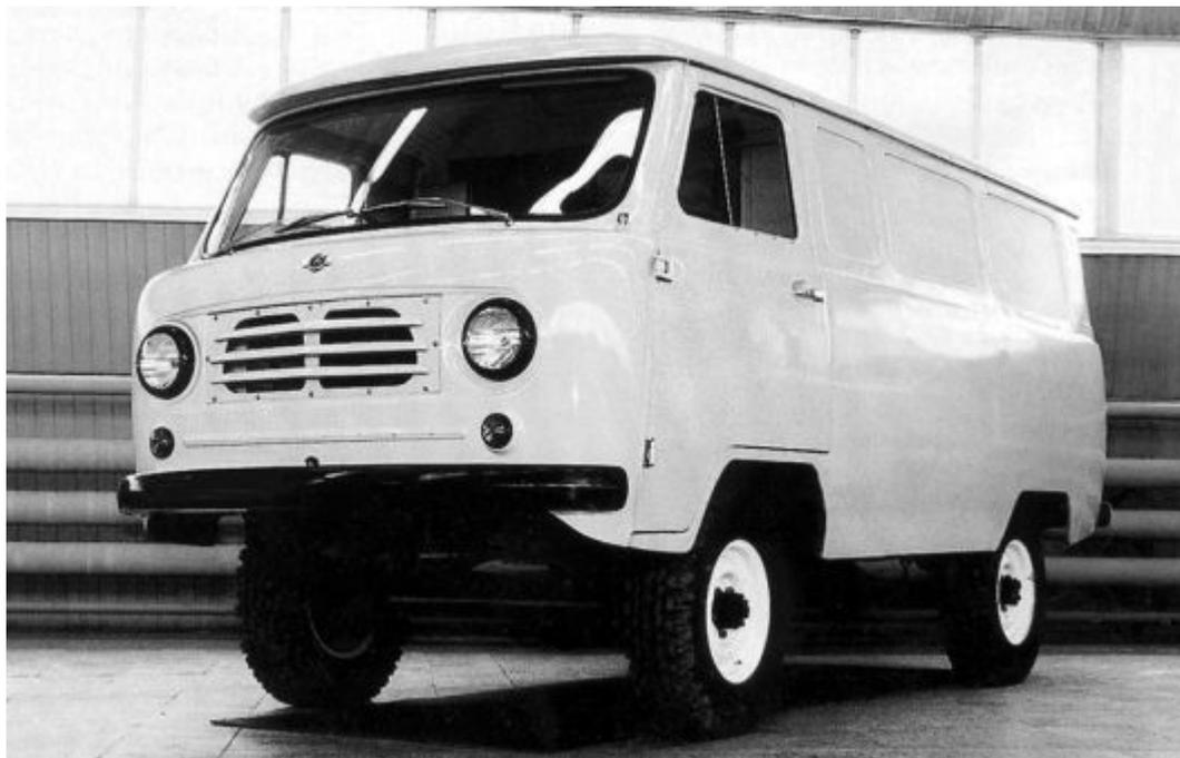
*Электрофургон разработки НАМИ-УАЗ на базе УАЗ-450 (1959 г.).*
