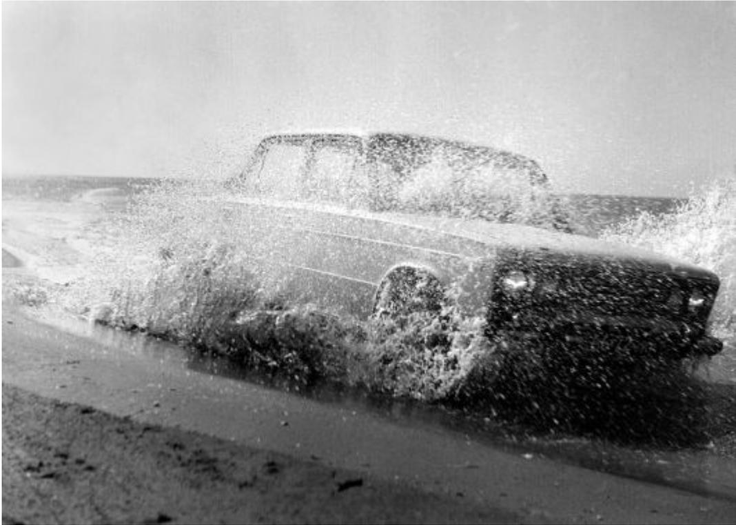
*Коррозионные испытания в районе г. Батуми.*
