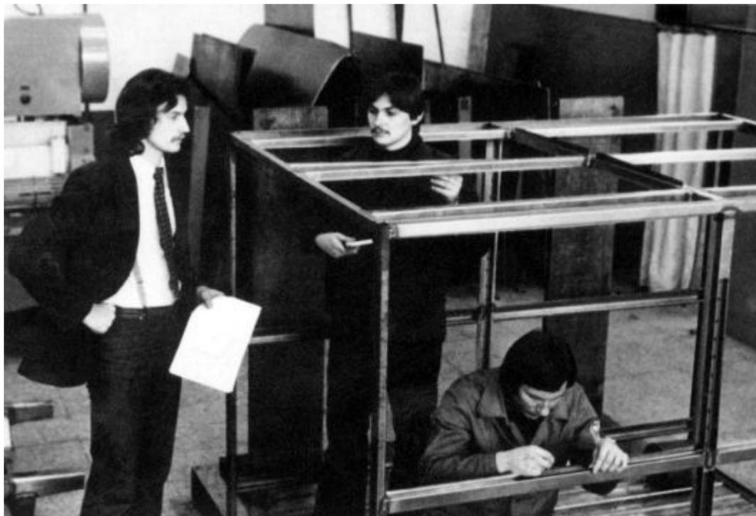
*Сварка каркаса кузова-фургона (С. Синельников, А. Мень, В. Князьков).*
