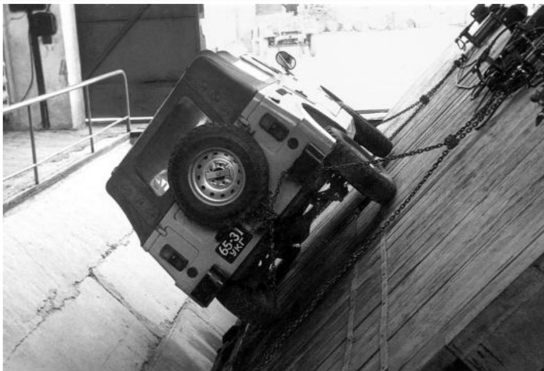
*Образец второй серии на поворотной платформе в Бронницах (определение угла поперечной устойчивости).*
