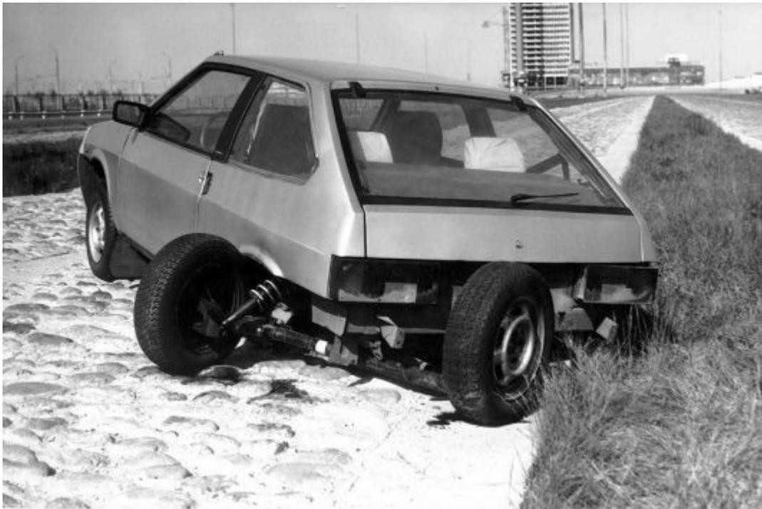
*Испытания опытных образцов никогда не проходят гладко. На булыжнике заводского трека (хорошо ещё, что не на дороге) развалилась задняя подвеска.*
