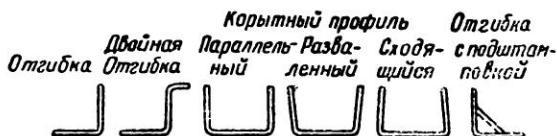
Фиг. 179. Усиление края детали отгибкой.
