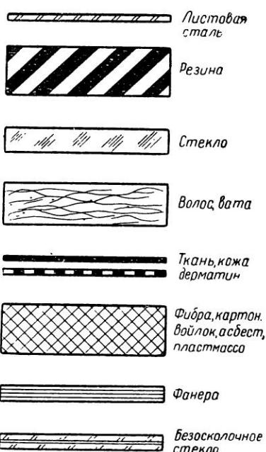
Фиг. 282. Штриховка деталей кузова в разрезах и сечениях.
