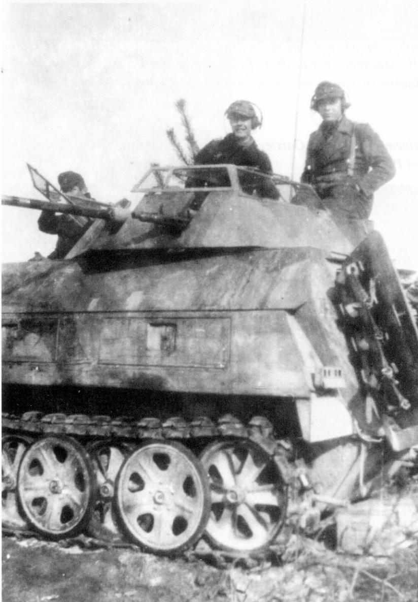
*Ardennen 1945. Mittlerer Schützenpanzerwagen Sd.Kfz. 251 Ausf. D mit Drilling 15 mm MG 151/15, einer elektrisch betätigten Waffe, die eigentlich für den Flugzeugeinbau entwickelt wurde. Der Wagen verfügte anscheinend über eine gepanzerte Fahrerkabine und eine offene Waffenplattform wie z.B. das Sd.Kfz. 251/17. Nach der Typenübersicht könnte es sich um ein (teilgepanzertes) Sd.Kfz. 251/21 (Drilling) handeln. Rechts ein amerikanischer MG-Drehkranz.*
