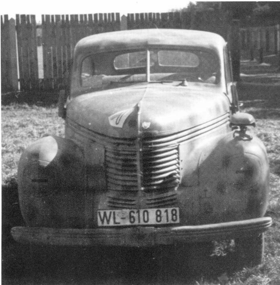
Eine liebevoll abgetarnte Opel Kapitän Limousine des J.G.3 (Udet). Am linken Kotflügel das Zeichen für leichte Jagdstaffel. In den Scheinwerfern die sechseckigen Tarneinsätze. Am Tarnscheinwerfer erkennt man die Gummikappe mit Halteband zum Verschluß des Befestigungsfußes, falls jemand ( warum sollte er?) den Scheinwerferkopf abnimmt.
