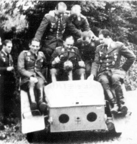
Ein dreirädriger Scheuch-Schlepper der insbesondere zum Rücktransport von gelandeten, stark explosionsgefährdeten Raketenjägern, Me 163 entwickelt wurde. Hier mit Angehörigen des Flak Rgt. 155, einer Einheit, die die V1 verschöß.
