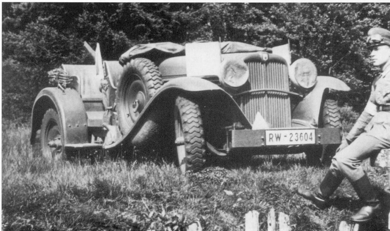
Aus einem Album der 5./J.Pz. Rgt.(1934-35): Ein **Stoewer M 12** Kübelwagen, der in nur etwa 500 Exemplaren von 1935 - 36 gebaut wurde. Er hatte einen 8 Zyl., 3,0 l, 60 PS - Motor. Auf dem Bild ist er als Schiedsrichterfahrzeug bei einem Manöver eingesetzt.
