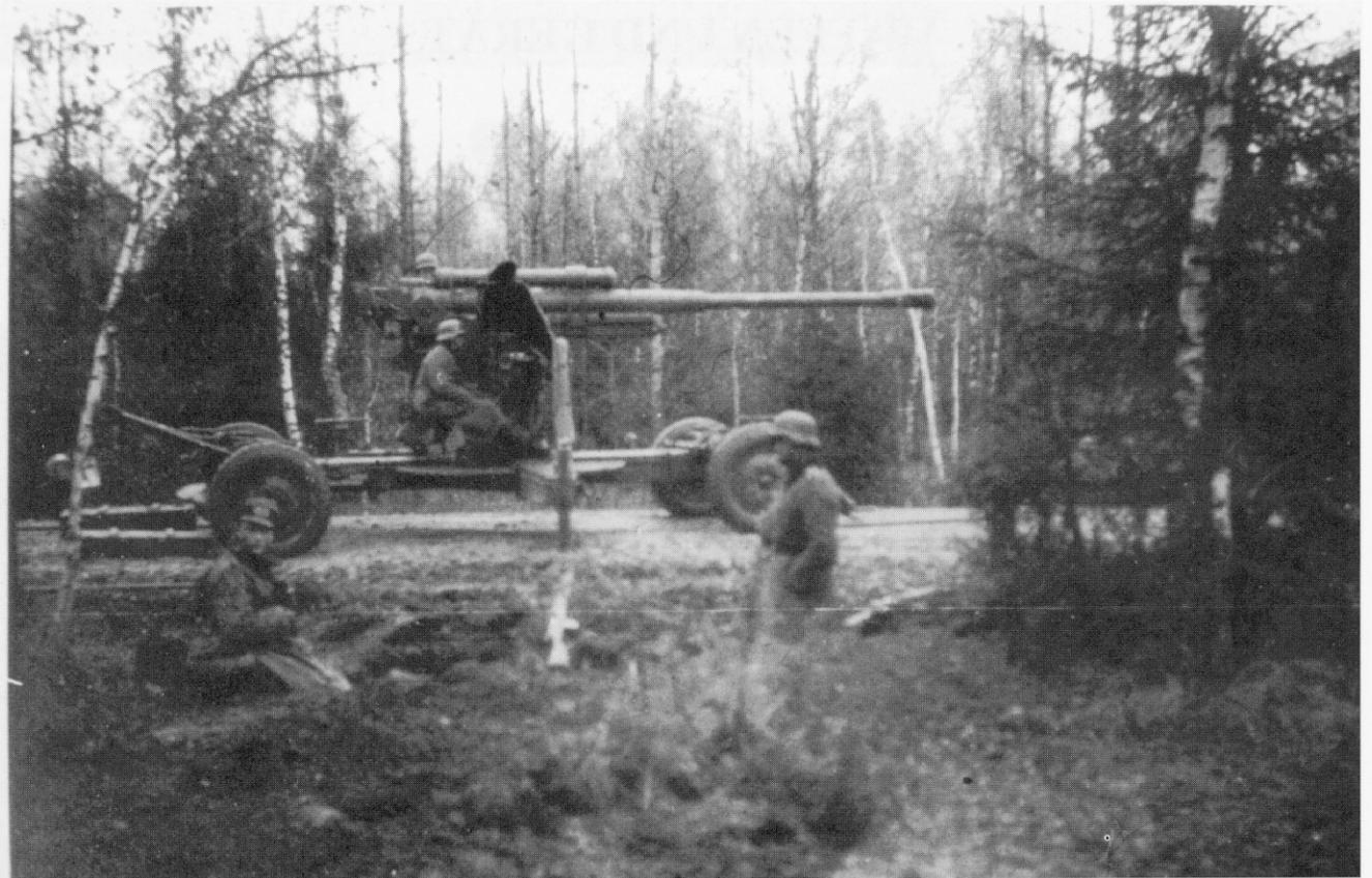
Um 2 Tonnen (5,1 to 3,1 to) leichter als die deutsche Acht-Acht, aber fast die gleiche Schußhöhe (ca. 10,5 km) und Mündungsgeschwindigkeit (800/830 m/sec.) : die russ. 8,5 cm Flak M 39. Hier mit Schutzschild, von der Lafette schießend. Westlich Moskau, 1941, 7. I. D.
