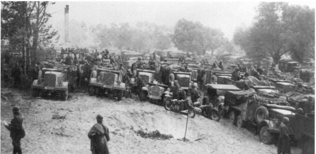
*Dichtgedrängt stehen **Einheits-Diesels** des Schützenregiments 2 der 2.Pz.Div. im Raum Tarnow 1939. Der Einheits-Diesel war durch seinen 6-Rad-Antrieb sehr geländegängig, hatte aber ein hohes Eigengewicht und war wegen des fehlenden Panzerschutzes nur eine Übergangslösung für den Transport der Schützen/Panzergranadiere bis zur Umrüstung auf Schützenpanzerwagen.*
