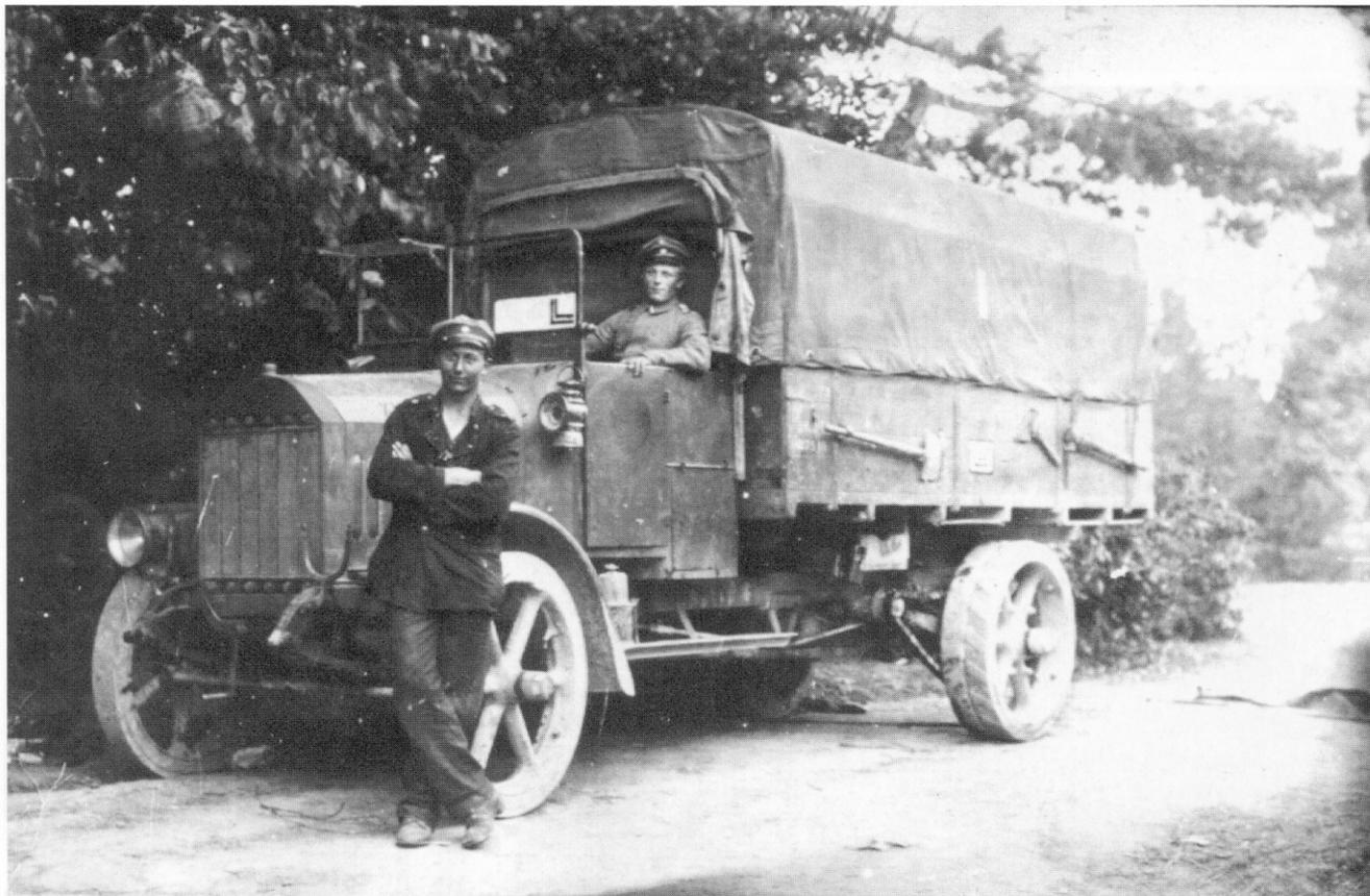
Vollgummireifen waren eine harte Angelegenheit für die Insassen und auch für den Wagen selbst - aber immer noch sanfter als die Ersatzbereifung aus Stahlfedern, die bei Kriegsende eingeführt wurde. Den Lüftungsschlitzen nach dürfte es sich um einen **Stoewer-Lkw** handeln.
