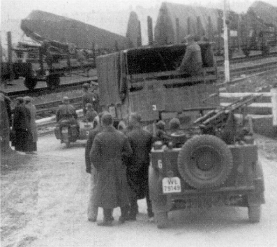
Italien 1943, Bahntransport von sorgfältig abgedeckten Lastenseglern DFS 230. Die Rumpfe liegen auf einem bisher unbekanntem 1-achs-Anhänger. Mit großer Wahrscheinlichkeit stehen diese Segler im Zusammenhang mit dem Einsatz auf dem Gran Sasso am 12.9.43. Im Vordergrund ein Truppenluftschutzkraftwagen (Kfz.4) mit Einheitsfahrgestell I für 1. Pkw. (leichter Einheits-Pkw) Die MG 34 in Zwillinglafette 36 sind bedenklicherweise unbesetzt.
