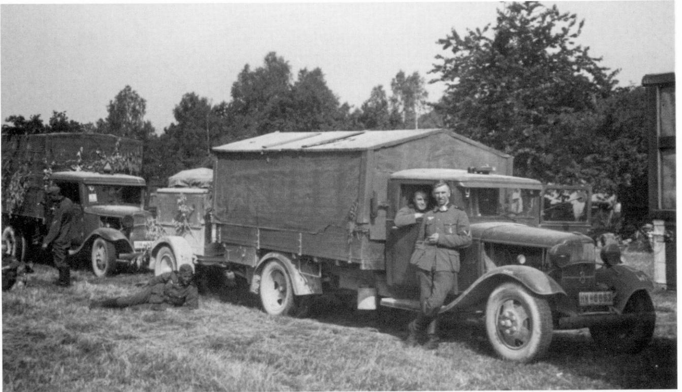
*Eingezogene Fahrzeuge mußten insbesondere bei den Rückwärtigen Diensten den Bedarf an Lastkraftwagen decken. Im Bild zwei Wagen einer Nachrichteneinheit, deren Ladefläche feldmäßig ausgebaut wurde. Es handelt sich um **Ford BB** Ausf. 1932 mit dem typischen, gebogenen Scheinwerferträger. Interessanterweise erkennt man am Kühler eine „8“, was auf einen V-8-Motor hinweist - obwohl der BB normalerweise einen 4-Zyl. - Reihenmotor hatte.*
