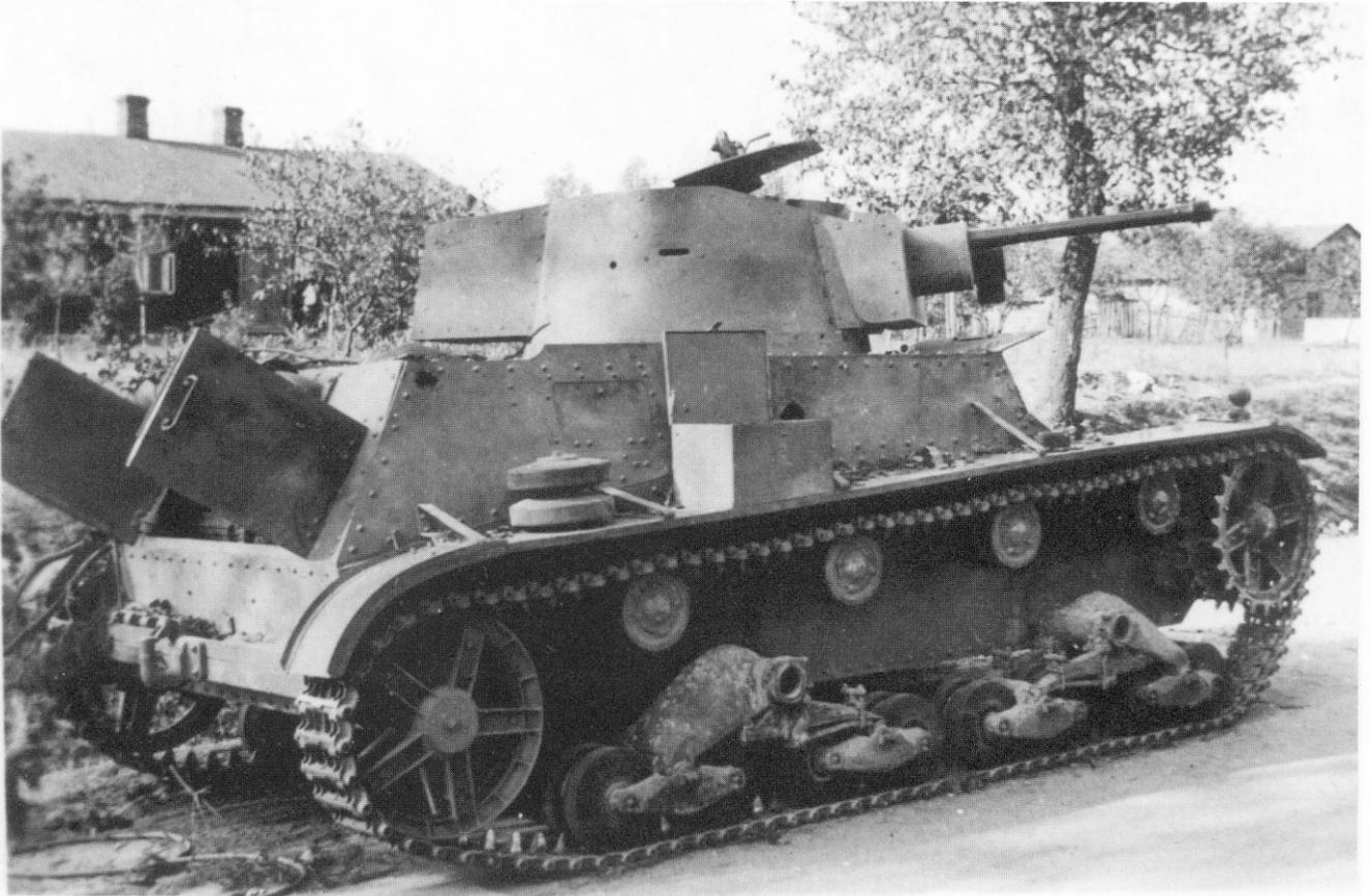
*Polnischer 7 TP (späte Ausführung), ein leichter Panzerkampfwagen mit einer 3,7 cm Bofors Kanone und einem 110-PS-Saurer-Dieselmotor.*
