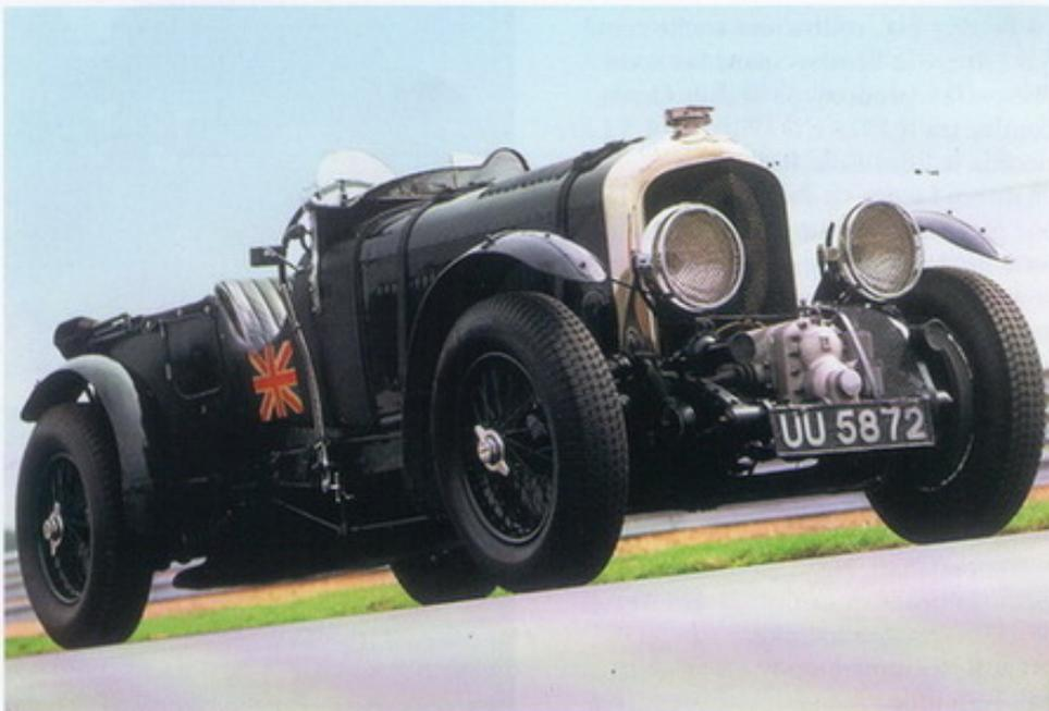
1. Una 4,5L Blower, con il caratteristico compressore volumetrico davanti al radiatore
