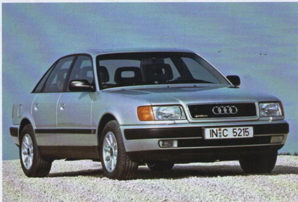
1. La linea arrotondata della Audi 100 C3 permette al modello di raggiungere valori aerodinamici da record per la categoria (Cx 0,30)
