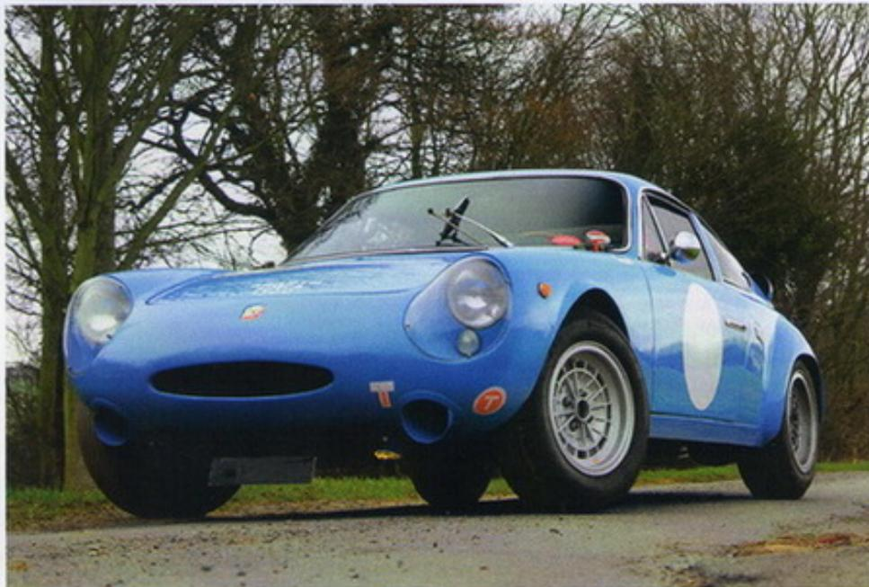
quelli esistenti tramite un sistema esterno. Tutto nuovo il motore da 1600 cc che sviluppa 155 Cv e spinge la berlinetta franco-torinese a 240 chilometri orari. Su questa macchina vengono installati anche quattro freni a disco Girling. Il peso è limitato, grazie all'adozione di parti in vetroresina, a 740 chilogrammi.
