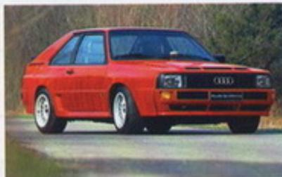
Per migliorare la competitività l'Audi realizza nel 1984 la versione Quattro Sport, modificata per migliorare prestazioni e agilità. Il motore ha testa a quattro valvole per cilindro e cilindrata leggermente ridotta a 2133 cc, per rientrare nella classe 3 litri secondo i parametri dell'epoca, e il telaio è accorciato di ben 32 centimetri. La potenza, di 306 Cv nella versione di serie, arriva in quelle da gara fino a 560.
