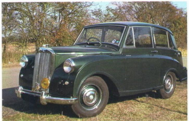
1. La Triumph Mayflower, berlina con carrozzeria monoscocca equipaggiata con un motore a valvole laterali di 1247 cc
