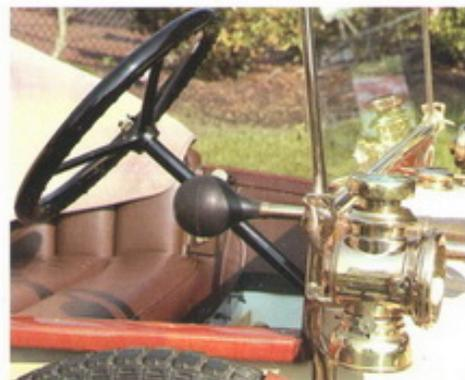
La vetturina della Stellite monta un motore a quattro cilindri di 1100 cc posizionato su un semplice telaio in legno rinforzato adotta uno sterzo a cremagliera e un cambio a due rapporti, che passa a tre nel 1915. La Stellite ha la sua maggiore attrattiva nel prezzo, poco superiore alle 150 sterline. Dopo la guerra, quando la Casa inglese ripropone lo stesso modello, nel 1919 il prezzo è quasi duplicato portando la vettura fuori mercato e di conseguenza la produzione viene sospesa.
