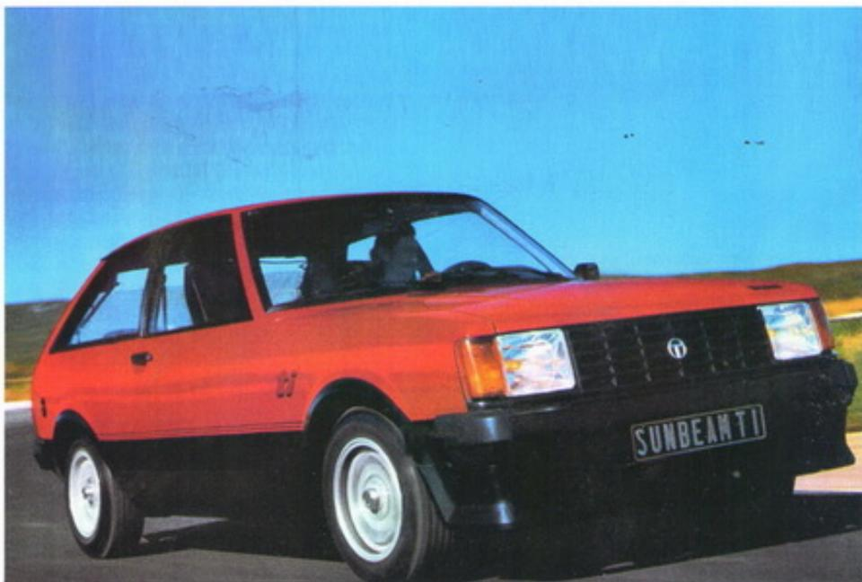
1. La Talbot Sunbeam TI, equipaggiata con un motore da 1598 cc in grado di erogare una potenza di 100 Cv
