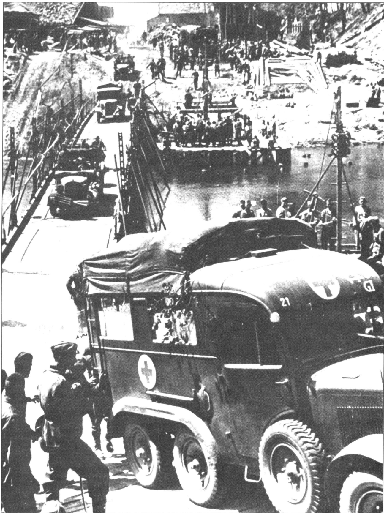
1941 год, Восточный фронт. Подразделения 1-й танковой дивизии форсируют реку по наведенному мосту. На переднем плане санитарный фургон (Kfz. 31) на шасси Steyr 640 (6×4). На крыше фургона тактический знак роты несамоходных противотанковых орудий и цифра «21» - первая машина второго взвода. Хорошо видно, как немецкие водители придерживаются интервала движения в колонне.
