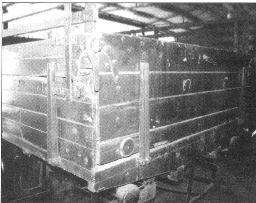
Боковой и задний борта и дверь кабины грузовика L.gl.Lkw Steyr 1500A.
