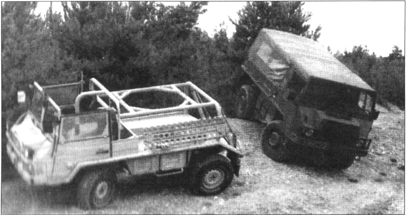
Steyr-Daimler-Puch Pinzgauer (4x4), слева - универсальное шасси для ракетных, пулеметных и артиллерийских установок, справа - тентованный грузовик для перевозки личного состава.
