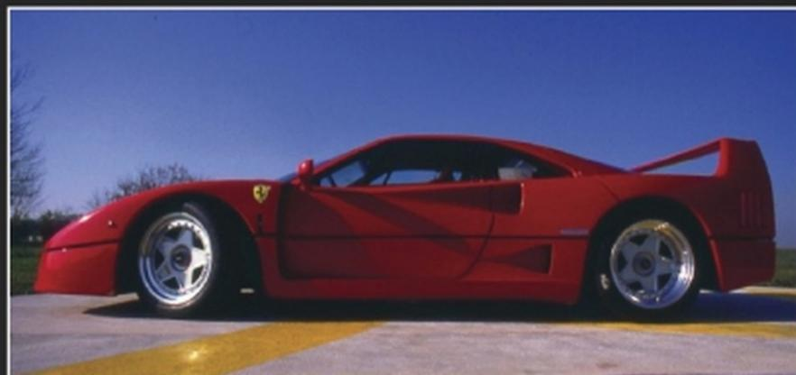
Comme la Porsche 959, la F40 dispose d'une garde au sol réglable qui s'abaisse automatiquement de 13 à 11 cm à partir de 120 km/h. La hauteur de caisse peut être rehaussée de 2 cm pour les manœuvres difficiles.
