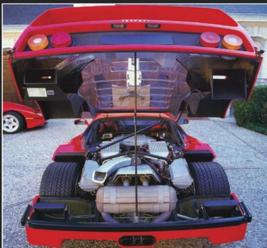
Pour stabiliser la F40 à 478 ch, les motoristes ont travaillé sur un compromis entre le V8 de la 288 GTO (400 ch) et celui de la 288 GTO Evoluzione (650 ch). Notez la tige tenant le capot ouvert: elle est réalisée en alliage d'aluminium.
