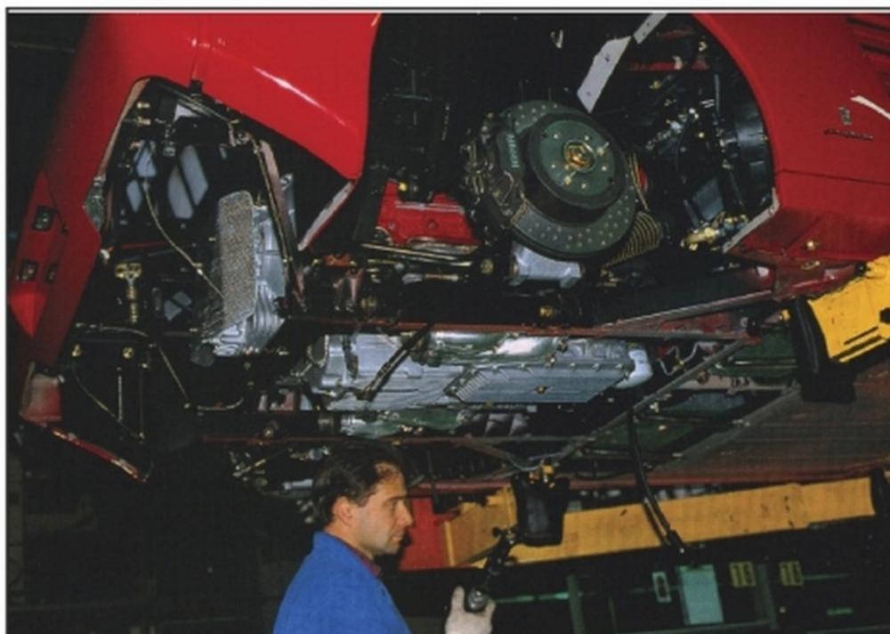
Sur la 512 TR, le bâti multitubulaire supportant moteur et suspension n'est plus boulonné, comme sur la Testarossa, mais soudé pour résoudre les problèmes de rigidité.
