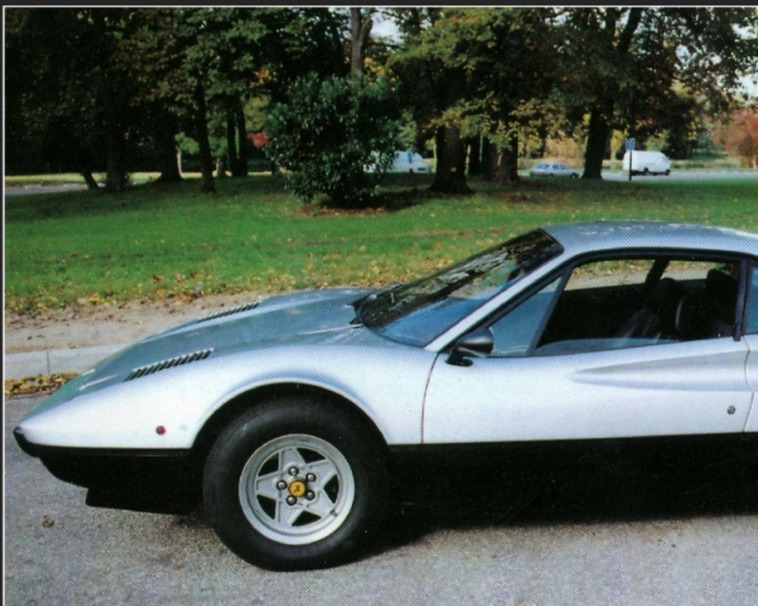
Chute de puissance catastrophique en 1980. Équipé de l'injection à la place des carburateurs, le V8 passe de 255 à 214 ch. La vitesse maxi atteint péniblement 230 km/h au lieu de 250 km/h.
