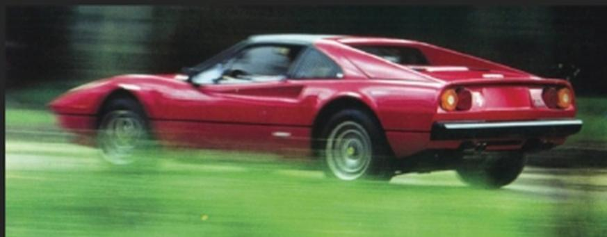
Plus pointue que la 308 GT4 à cause d'un empattement raccourci de 21 cm, la 308 GTB requiert une certaine expérience. Jusqu'à la fin 1976, il y avait pas mal de différence entre deux voitures identiques sortant d'usine, au niveau des tolérances de réglages des trains roulants.
