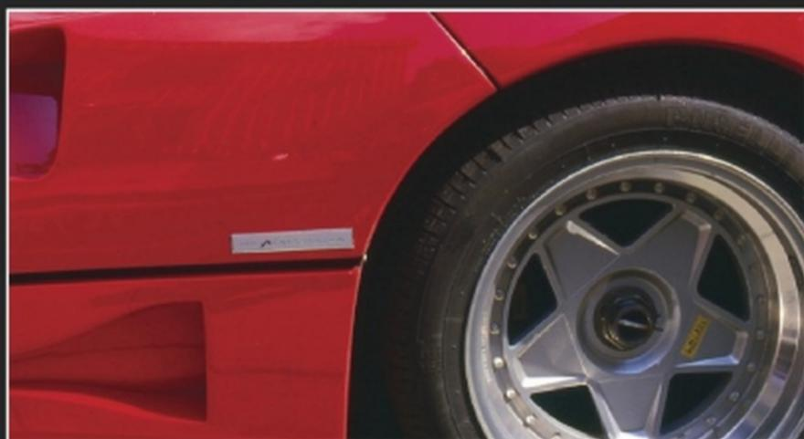
La F40 a été développée autour du Pirelli P Zero unidirectionnel, validé à Nardo jusqu'à 350 km/h. Ensuite, trois homologations ont été retenues par l'usine: Michelin MXR, Bridgestone RE 71 et Goodyear Eagle GSA. L'équilibrage des roues se fait par des contrepoids adhésifs spéciaux. L'usine recommande une pression spécifique au-dessus de 300 km/h.
