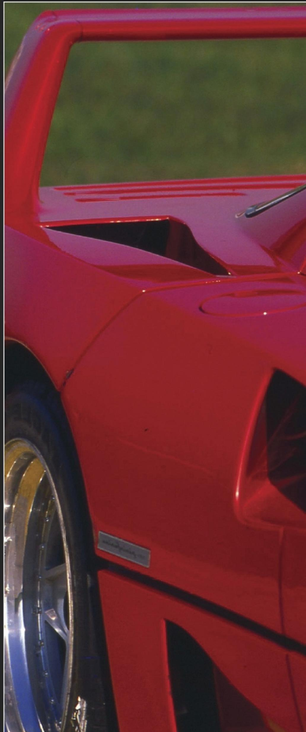
De nombreuses prises d'air NACA (capot AV, flancs, passages AR) conduisent l'air de refroidissement aux différents radiateurs et échangeurs.
