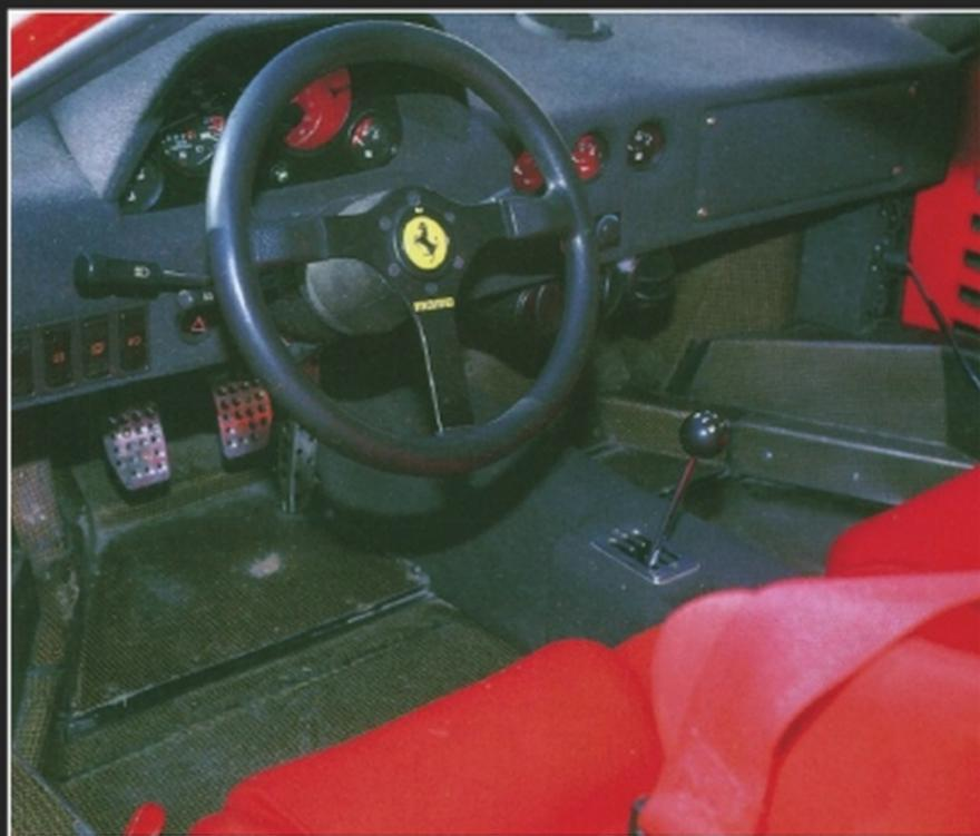
L'usine laissait le choix au client: boîte à synchros ou boîte à crabots. Cette deuxième solution – réservée à la conduite en circuit – n'était pas envisageable en utilisation routière.
