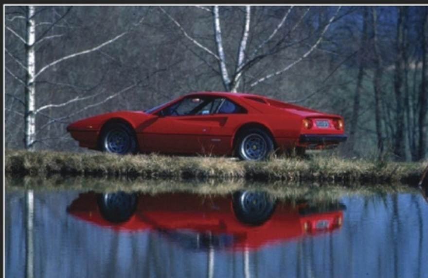
Empattement réduit de 21 cm par rapport à la 308 GT4 mais moteur V8 3 litres identique. La 308 GTB sort au Salon de Paris 1975 avec une coque polyester (1 090 kg). Il en sera fabriqué 808 exemplaires, avant que Scaglietti puisse fournir des coques acier (1 150 kg) à partir de mars 1977.
