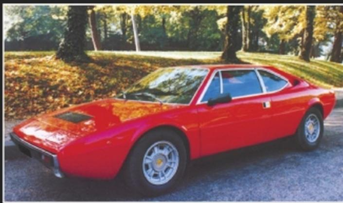
En 1976, l'usine sort une version 1 991 cc double-arbre de 170 ch, uniquement pour le marché italien. Il s'agit d'éviter la taxe sur les grosses cylindrées débutant à partir de 2 litres. Aucune modification extérieure mais 170 ch et 220 km/h au lieu de 255 ch et 250 km/h.
