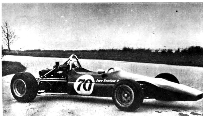
Автомобиль формулы 3 «Эстония-18» с двигателем ВАЗ-2101. У этой последней модели (конструктор К. Кеель) Таллинского завода дисковые тормоза, отлитые из магниевого сплава колеса и кузов из стеклопластика
