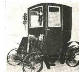
RENAULT FRÈRES TYPE 1900 MOTEUR DE DION 3,5 H.P. (EAU) 2 000 tr./mn. VITESSE MAXIMA 30 Km./H.
