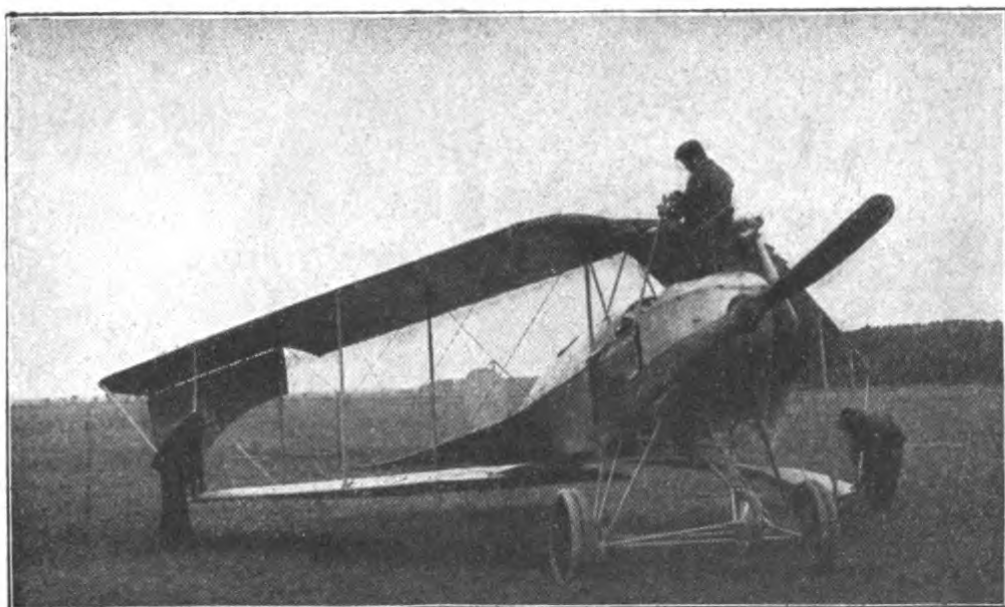
Fig. 118. Der A.-E.-G.-Zweidecker wird zusammengelegt. Flugtechnische Bibliothek, Bd. 2.
