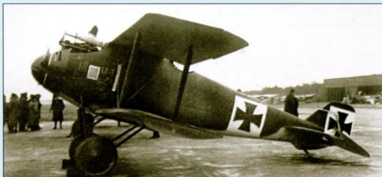
Вверху: «Роланд» D.I появился летом 1916 г. Внизу: В отличие от предшественника, у «Роланда» D.II верхнее крыло было немного приподнято над фюзеляжем
