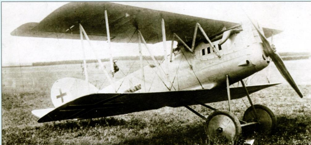
«Пфальц» D.XII представлял собой доработку модели D.IIIa с бипланной коробкой «типа SPAD»
