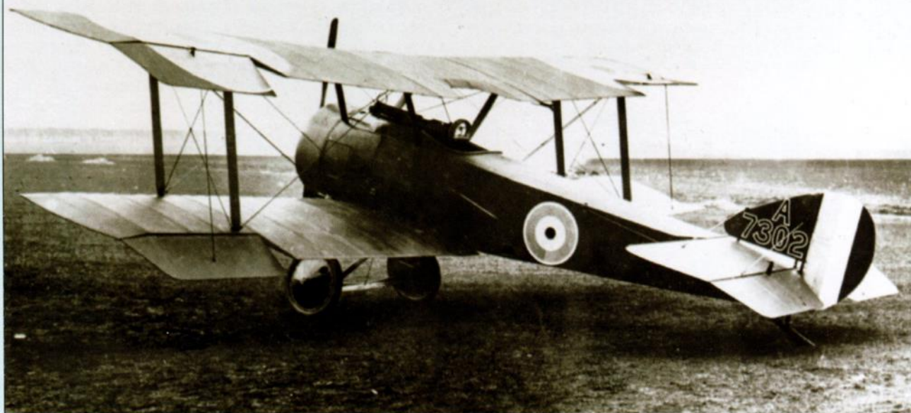
«Пап» отличался крылом относительно небольшого размаха
