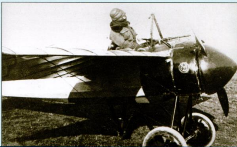
Боепитание пулемета «Гочкис» осуществлялось из жестких лент небольшой емкости
