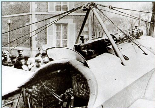
«Фоккер» E.I стал первым серийным истребителем, вооруженным синхронным пулеметом
