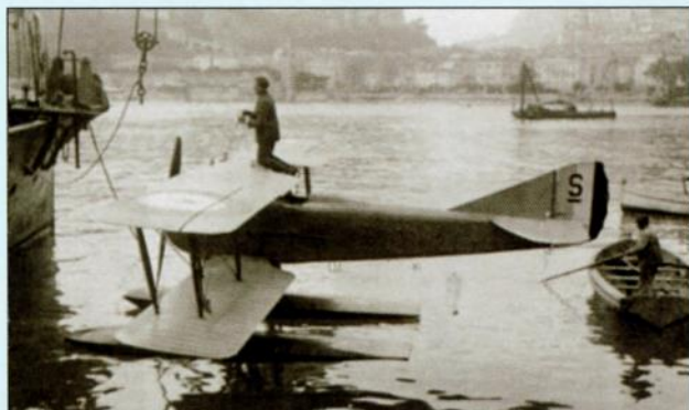
SPAD S.14 представлял собой поплавковый вариант пушечного S.12
