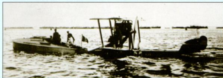
Летающая лодка «Бранденбург» W.18 строилась только для австро-венгерской морской авиации (все три снимка на с. 134)
