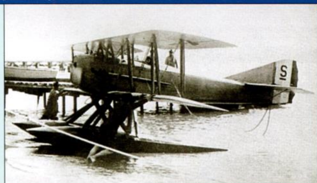
SPAD S.14 представлял собой поплавковый вариант пушечного S.12
