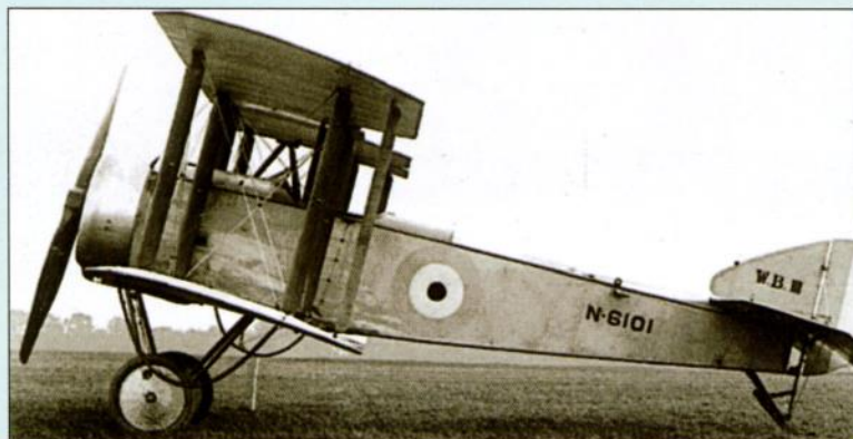
На варианте W.B.IIIF для удобства хранения на авианосце складывалось крыло и убиралось шасси
