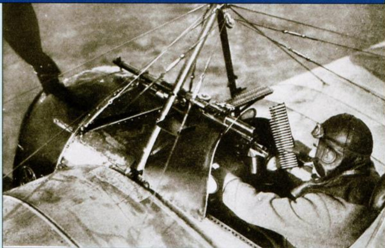
Боепитание пулемета «Гочкис» осуществлялось из жестких лент небольшой емкости
