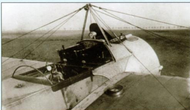
Вооружение «Фоккера» E.IV состояло из пары синхронных пулеметов «Шпандау»
