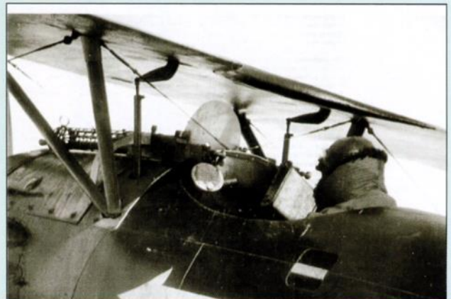
Вооружение SSW D.III состояло из пары синхронных пулеметов
