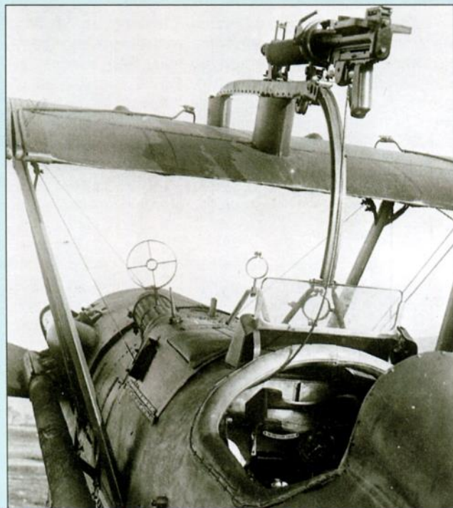
Вооружение SE.5a: синхронный «Виккерс» и «Льюис» над верхним крылом
