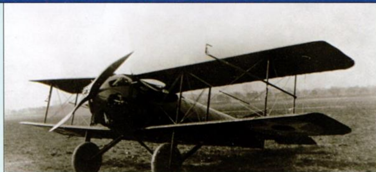
Характерной чертой «Бэнтэма» являлся стационарный радиальный мотор воздушного охлаждения
