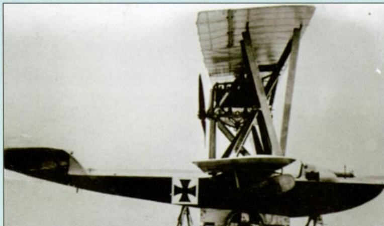
Так же, как и поплавковый KDW, «Бранденбург» СС имел звездообразные межкрыльевые стойки
