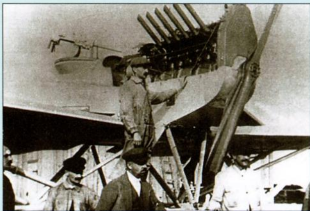
На большинстве «Бранденбургов» W.29 устанавливались моторы «Бенц» Vz.III.
