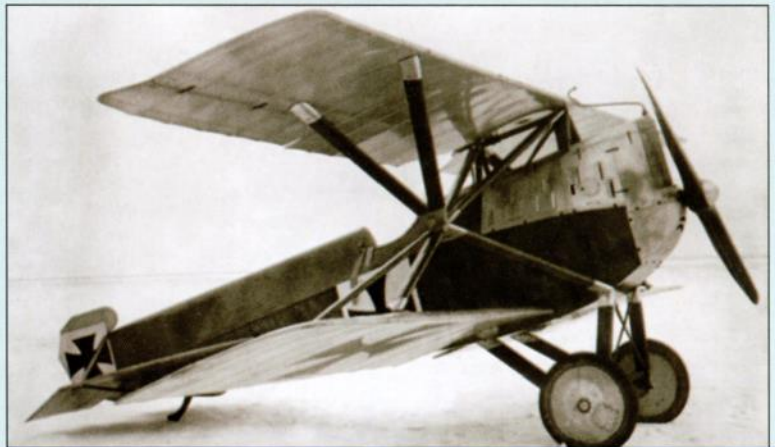
Вверху: «Ганза-Бранденбург» D.I немецкого производства не имели киля - только руль направления. Внизу: вооружение «Ганза-Бранденбург» D.I устанавливалось в характерном «гробике» - надкрыльевом контейнере
