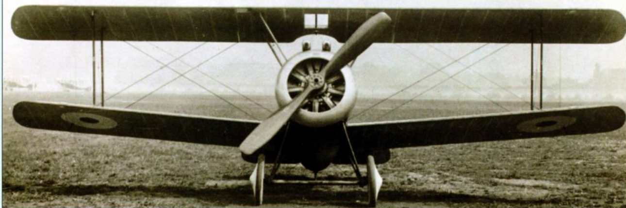
Вооружение «Кэмела» - пара синхронных «Виккерсов»
