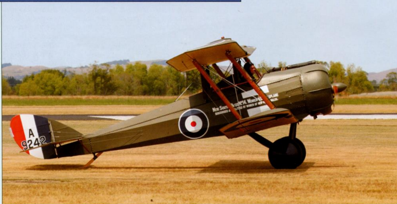
DH.5 отличался характерным «граненым» сечением фюзеляжа
