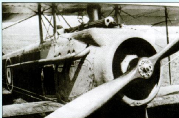
Вооружение SPAD S.7C1 - синхронный пулемет
