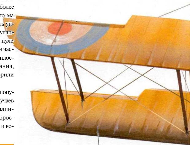
Деревянные крылья равного размаха. Элероны установлены на обоих крыльях
