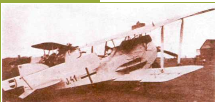
Самолет Феникс D III с дополнительным наружным топливным баком, установленным на нижнем крыле.
