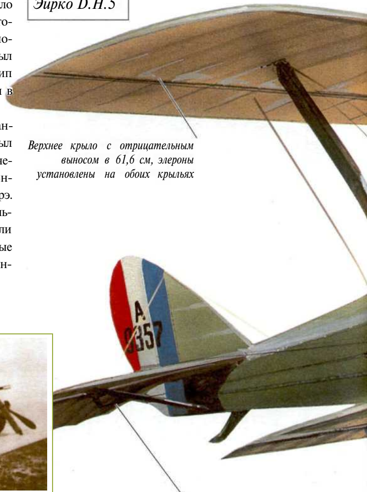
Хвостовое оперение имело металлический каркас и обшивалось полотном
