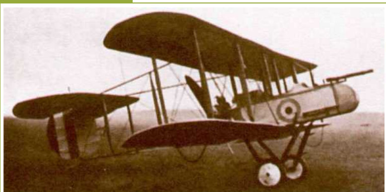
Внешне F.V.9 отличался в первую очередь отсутствием противокатажных лыж.
