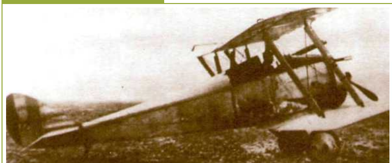
Производились самолеты с упрощенным фюзеляжем, имевшим четырехгранное сечение. Данный D.H.5, использовавшийся в летной школе, не имел синхронизатора и пулемет был выставлен под углом к горизонту.
