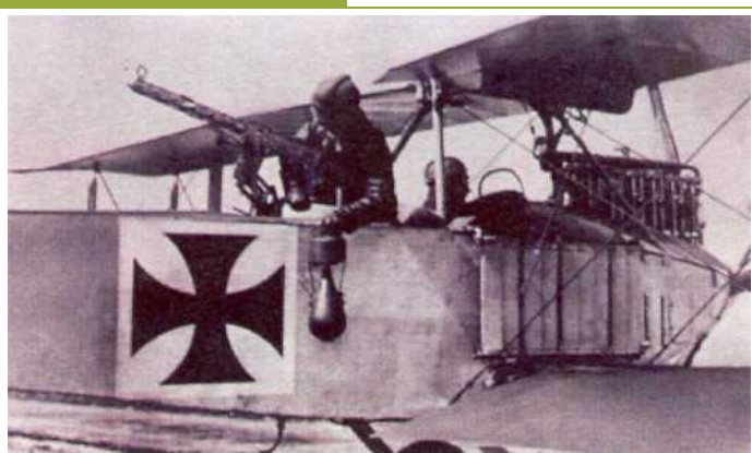
Стрелок DFW C II демонстрирует способ ручного бомбометания. Для этого на стабилизаторе авиабомбы была предусмотрена специальная ручка.
