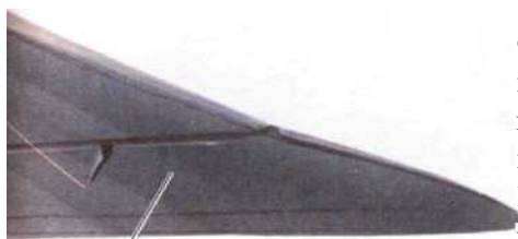
Впервые элероны были установлены (на верхнем крыле) на последних сериях модификации D III
