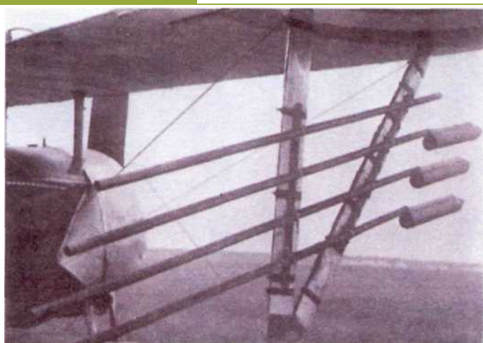
Пусковая установка ракет Ле Прие представляла собой ряд алюминиевых трубок, закрепленных на межкрыльевых стойках. В эти трубки вставлялись штыри-стабилизаторы ракет.
