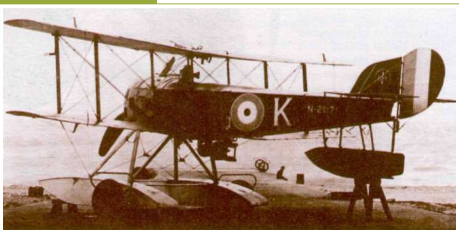
Самолет Сопвич «Бэби», вооруженный двумя пулеметами «Льюис» и авиабомбой.
