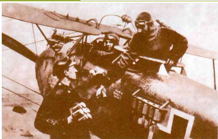
Для штурмовых атак стрелок брал в кабину ручные гранаты, связанные в пакет с одной рукоятью. Мелкие осколочные бомбы крепились на раме на бортах самолета.
