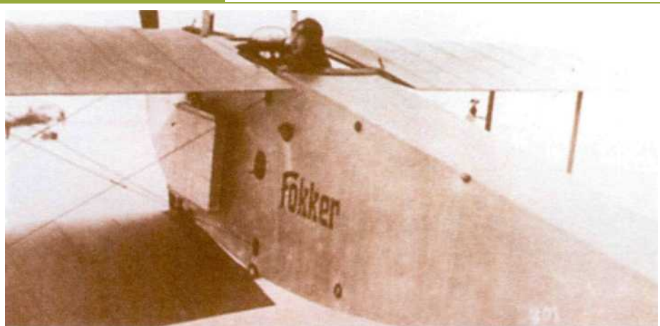
Переходным типом от D I к D II был опытный самолет M 18. Его конструктивной «изюминкой» было установленное на фюзеляже верхнее крыло. На фотографии — Э. Фоккер, обычно выполнявший первый полет при испытаниях нового самолета.
