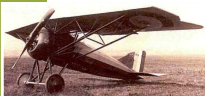
Крыло тонкого профиля было усилено множеством подкосов и расчалок.
