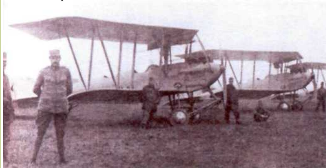
Если крылья «ллойдов» серии «В» имели ярко выраженную стреловидность, то у «С» они были почти треугольными.
