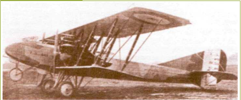
Le-4 имел противокапотажное носовое колесо, двигатели Испано-Сюиза с бочкообразными радиаторами Ламблена и турели ТО4 в кабинах стрелков.
