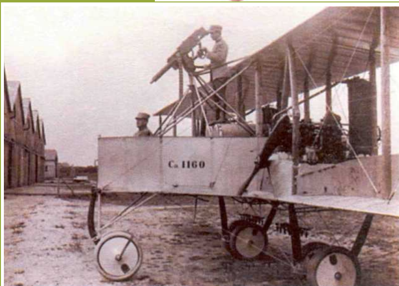
Одна подвижная пулеметная установка находилась в носовой части gondoly, задние свдвоенные (или даже строенные) пулеметы размещались на уровне верхнего крыла на специальной «этажерке» над средним мотором
