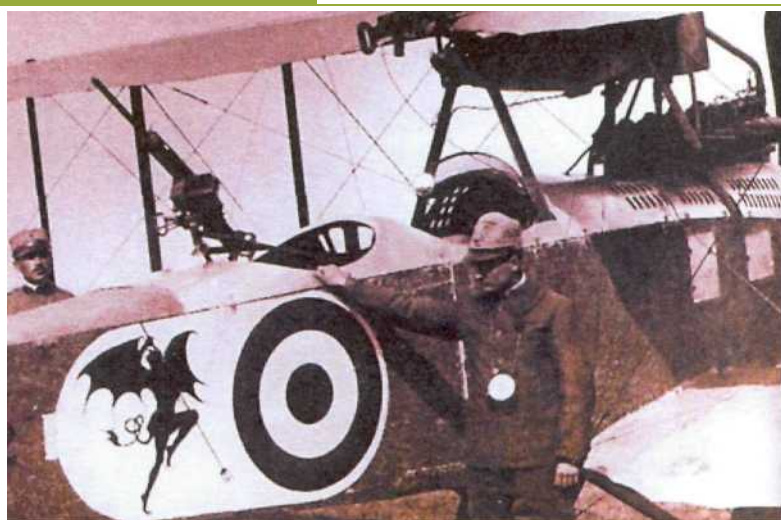
Стандартное вооружение PD включало два пулемета: курсовой надкрыльевой и оборонительный на турели в задней кабине.
