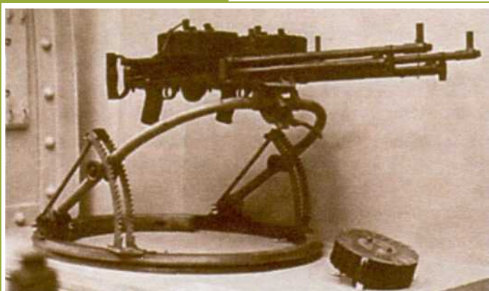
Спаренный пулемет «Льюис» на лафете Скарфа. В ходе войны пулеметы неоднократно модернизировались, увеличивалась скорость стрельбы и емкость круглого магазина.
