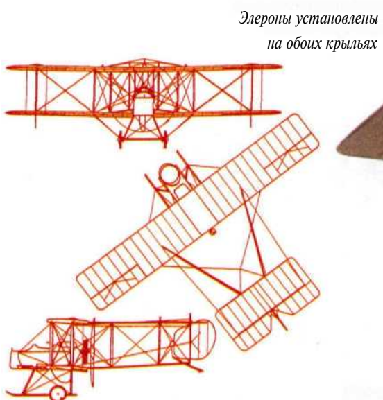
Крылья деревянной конструкции с полотняной обшивкой, двухсекционные, двухлонжеронные
