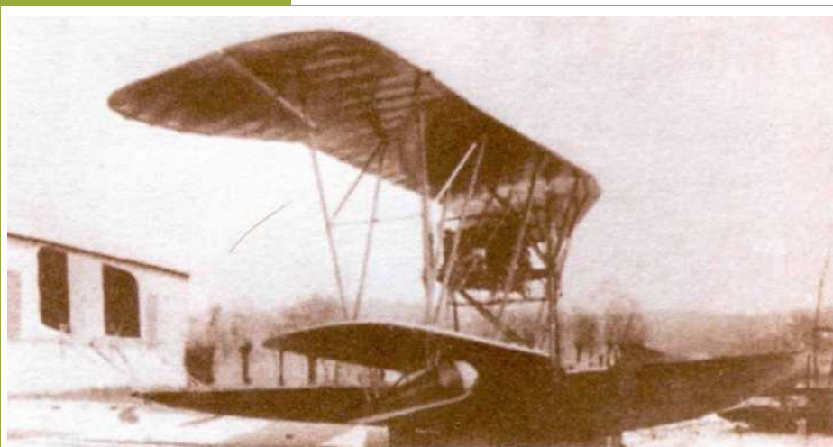
Макки L-1 внешне отличалась от Лёнера T формой вертикального оперения и конструкцией элеронов.
