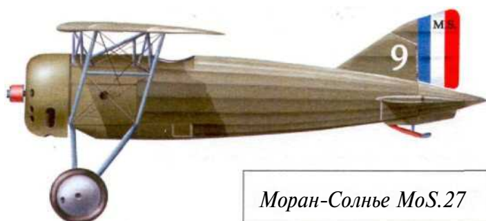
Крыло тонкого профиля было усилено множеством подкосов и расчалок.
