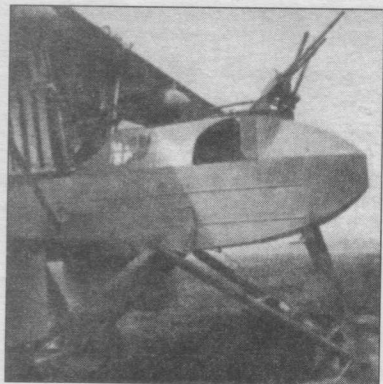
«Бреге ВМ.5». Хорошо видны кассетные контейнеры для бомб под крыльями, бензобаки под верхним крылом, радиаторы на стойках крыла и пулемет «Гочкисс» в передней кабине.
