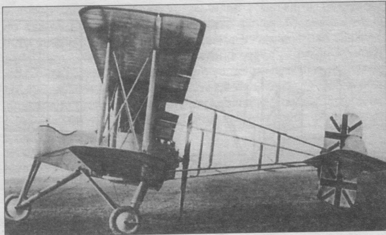
«Бреге ВМ.4» в одноместном варианте на службе 5-го крыла Королевской морской авиации, Дюнкерк, 1916 год. Самолет оснащен английским двигателем «Санбл Мохок» мощностью 168 кВт.
