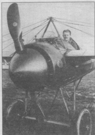
«Моран-Солнье N». Видны стальные отражатели на лопастях винта.
