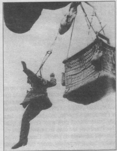
Немецкий наблюдатель покидает кабину аэростата с помощью парашюта типа Паулюс.
