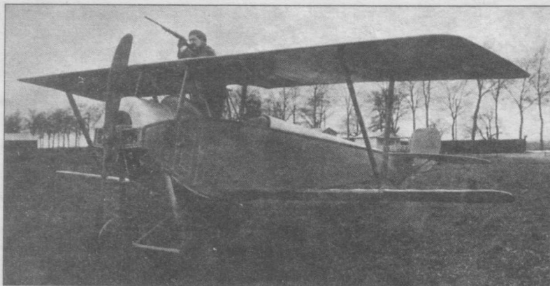
Первые попытки вести огонь с самолета. Наблюдатель стоит, упершись локтями в верхнее крыло, и стреляет из обычной пехотной винтовки типа «Лебель». Самолет «Ньюпорт 10В2», 1915 год.
