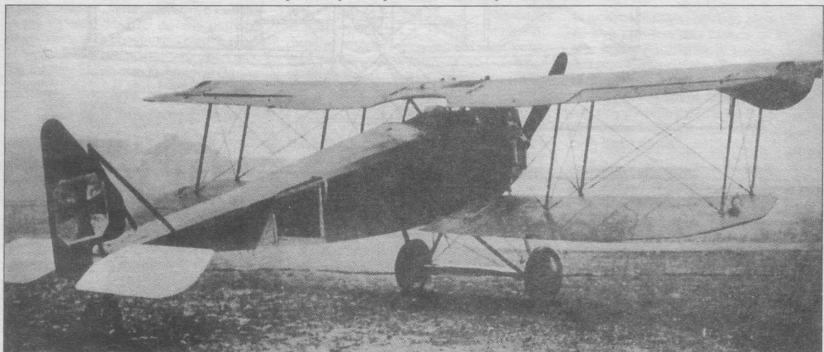
«Гальберштадт D.II» с поврежденной законцовкой крыла.
