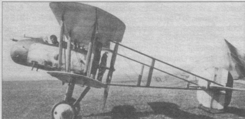
«Виккерс FB.12» с двигателем «Ле-Рон» мощностью 58 кВт.
