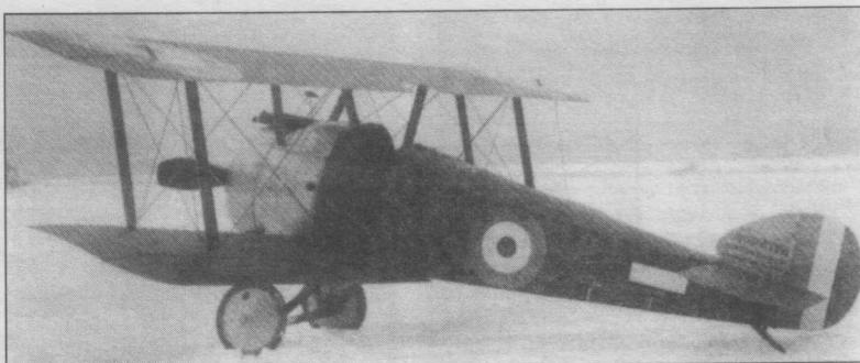
Прототип «Кемел F.1» с двигателем «Клерже» мощностью 80 кВт, декабрь 1916 года, Бруклендс.
