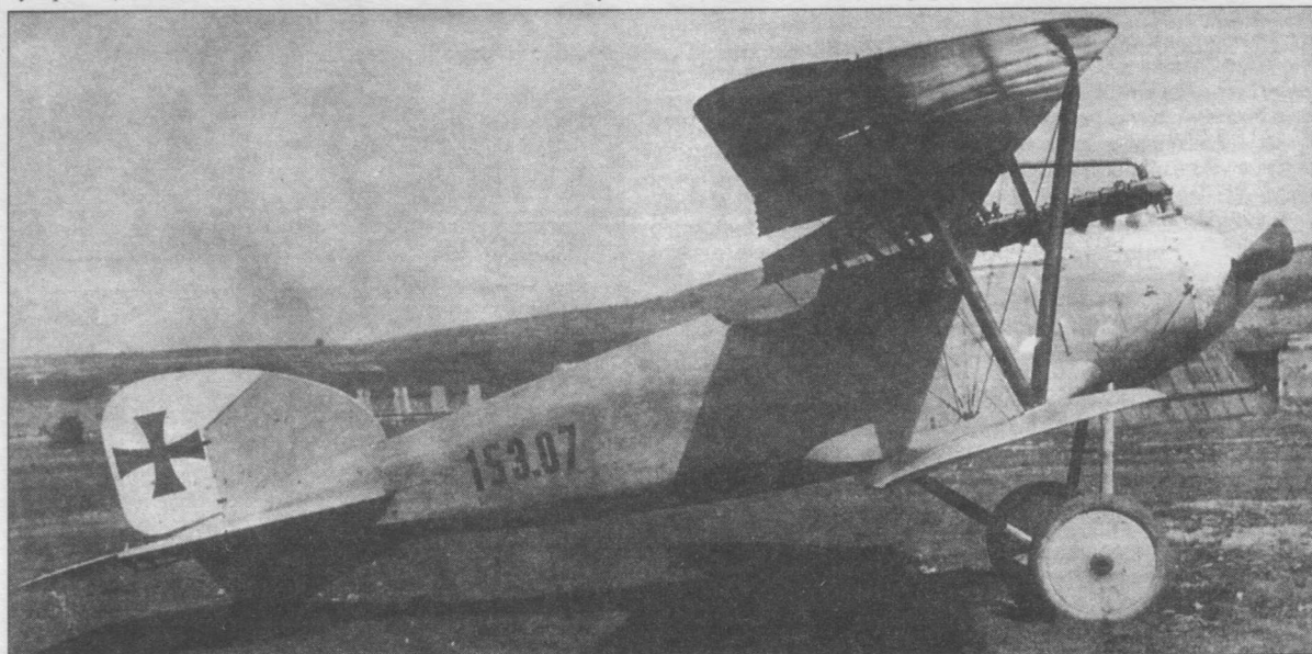
«Оффга Д.III» № 153.07 с двигателем «Австро-Даймлер» мощностью 104 кВт.
